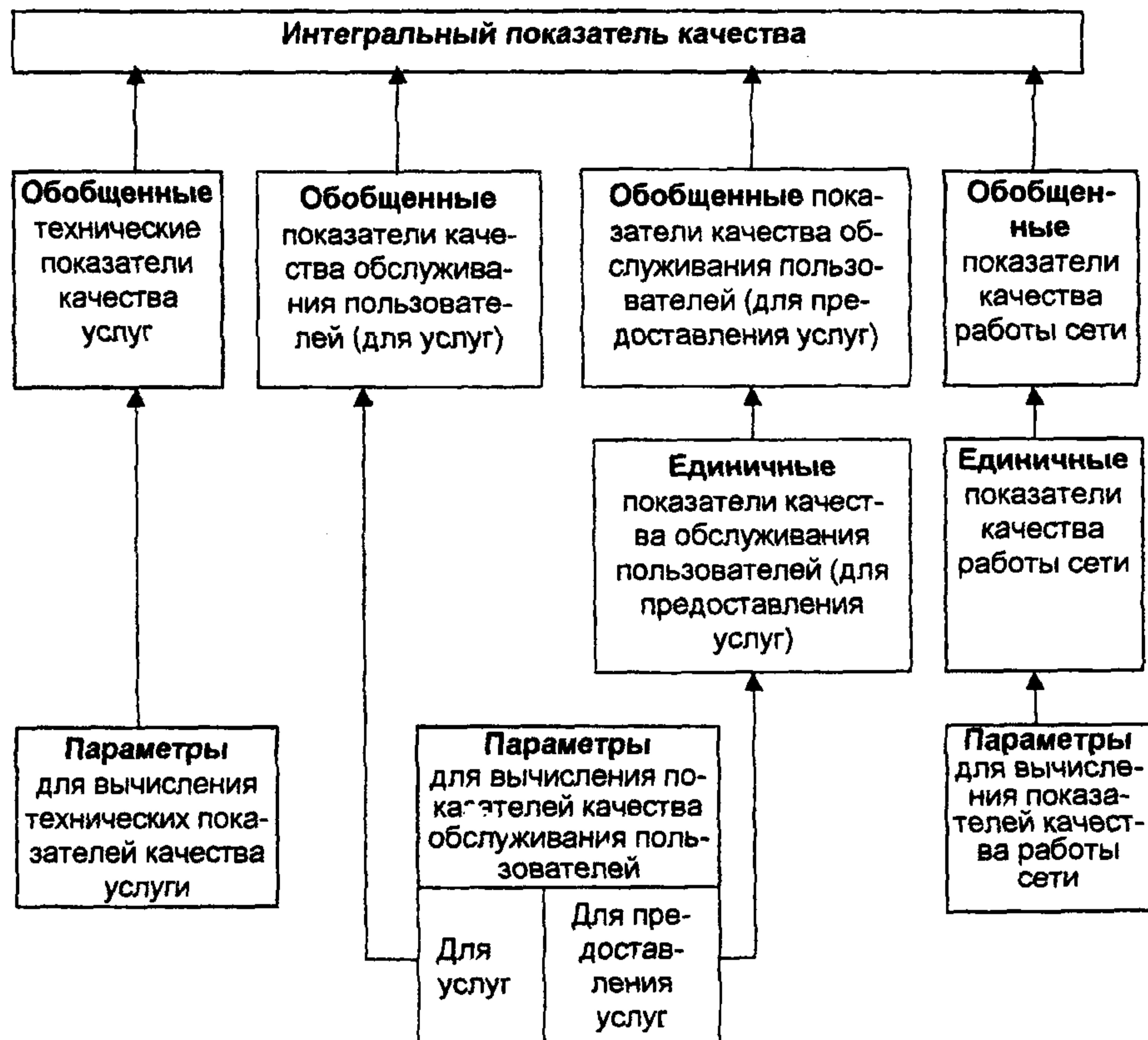
Рисунок 2 - Типовая структура системы показателей качества
