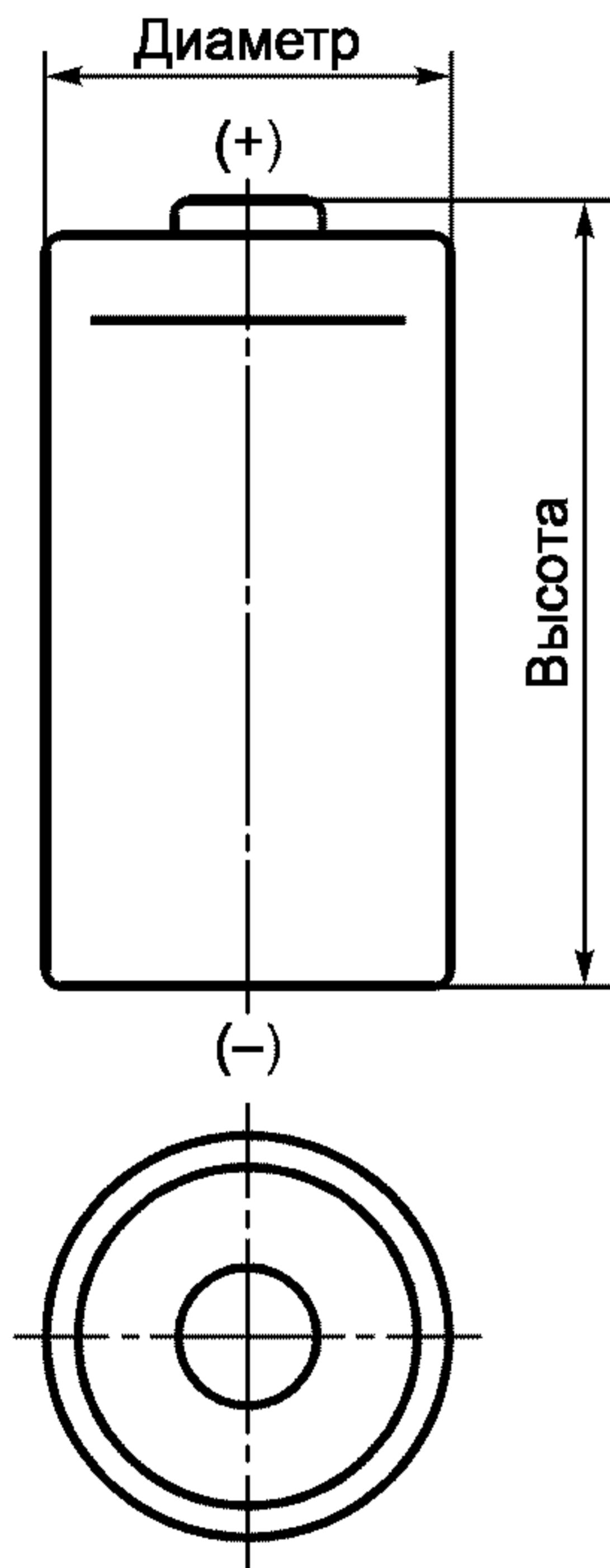
Рисунок 1 — Цилиндрический аккумулятор
