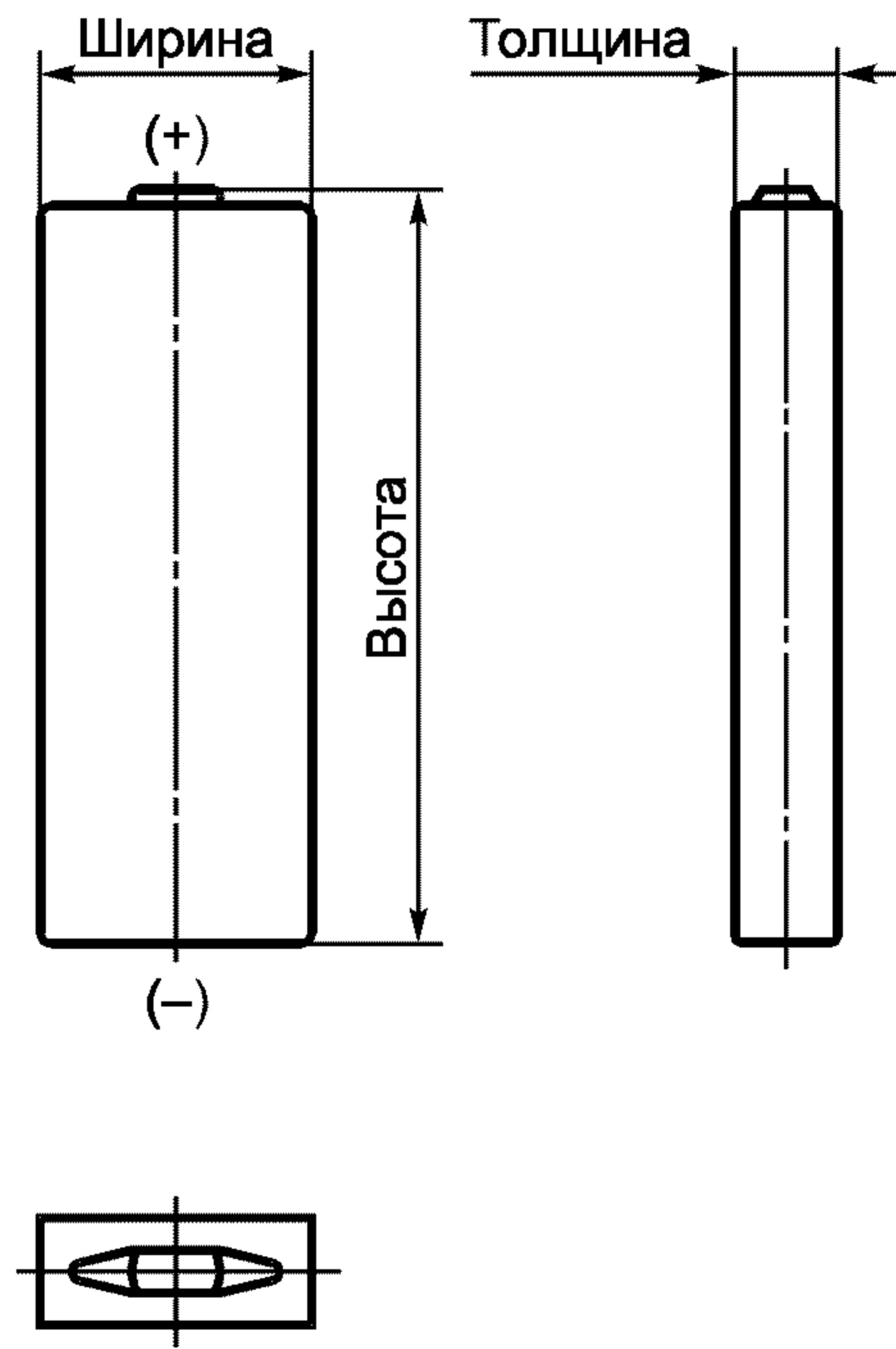
Рисунок 2 — Малогабаритный призматический аккумулятор
