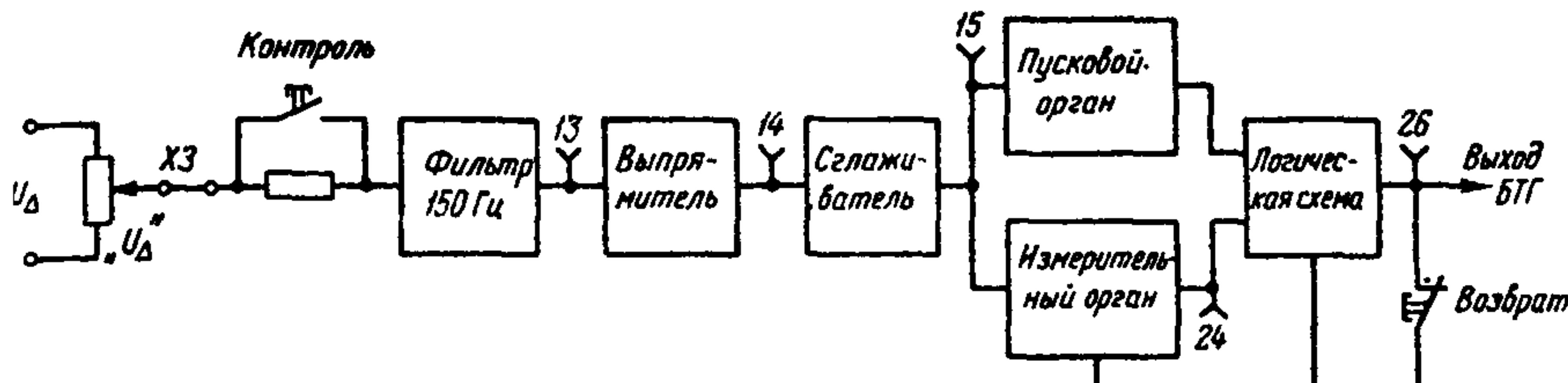
Рис.П2.2. Структурная схема БТГ блока защиты БРЭ I301.02
