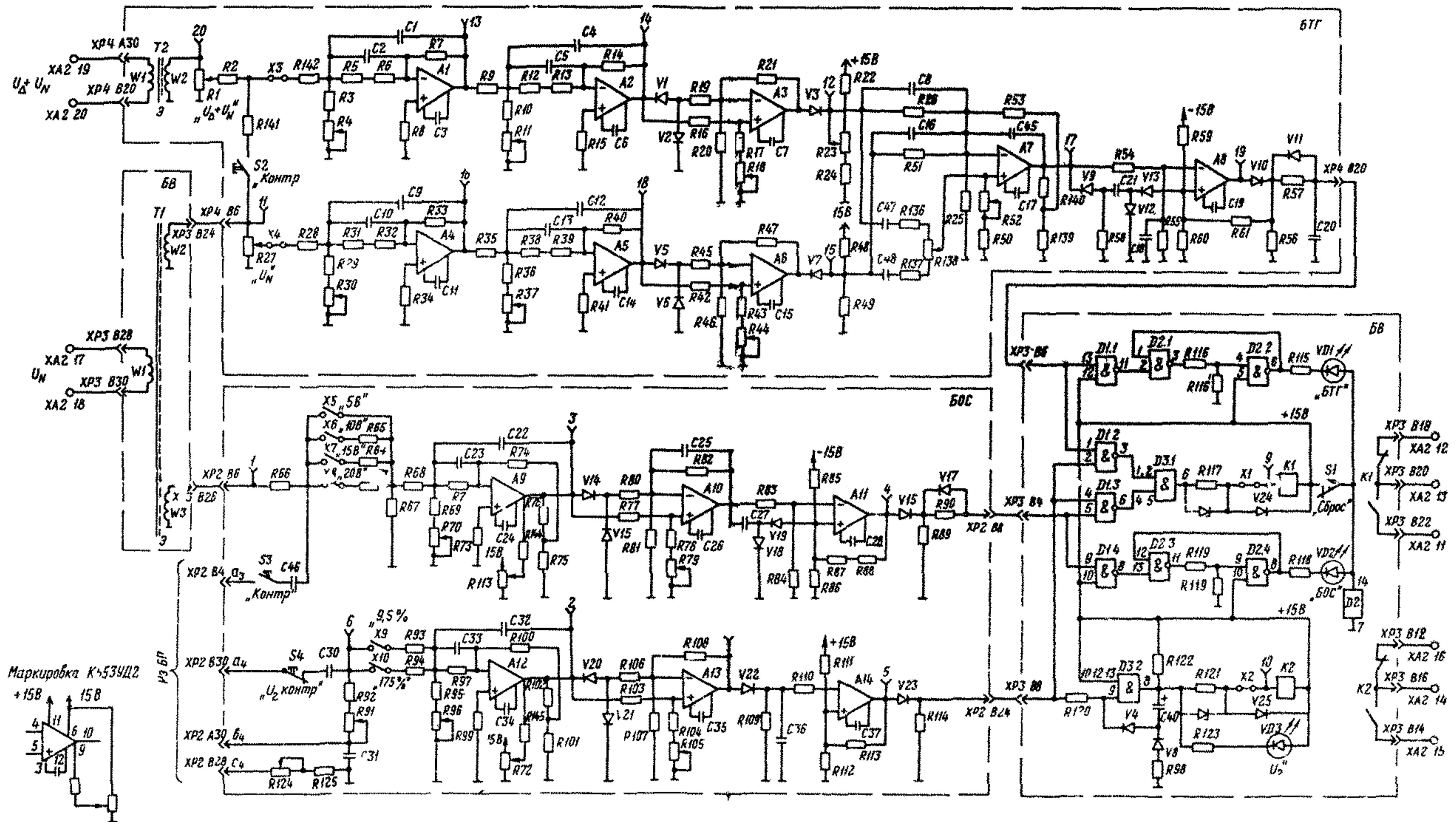
Рис.3. Принципиальная электрическая схема блока защиты БРЭ I301.01
