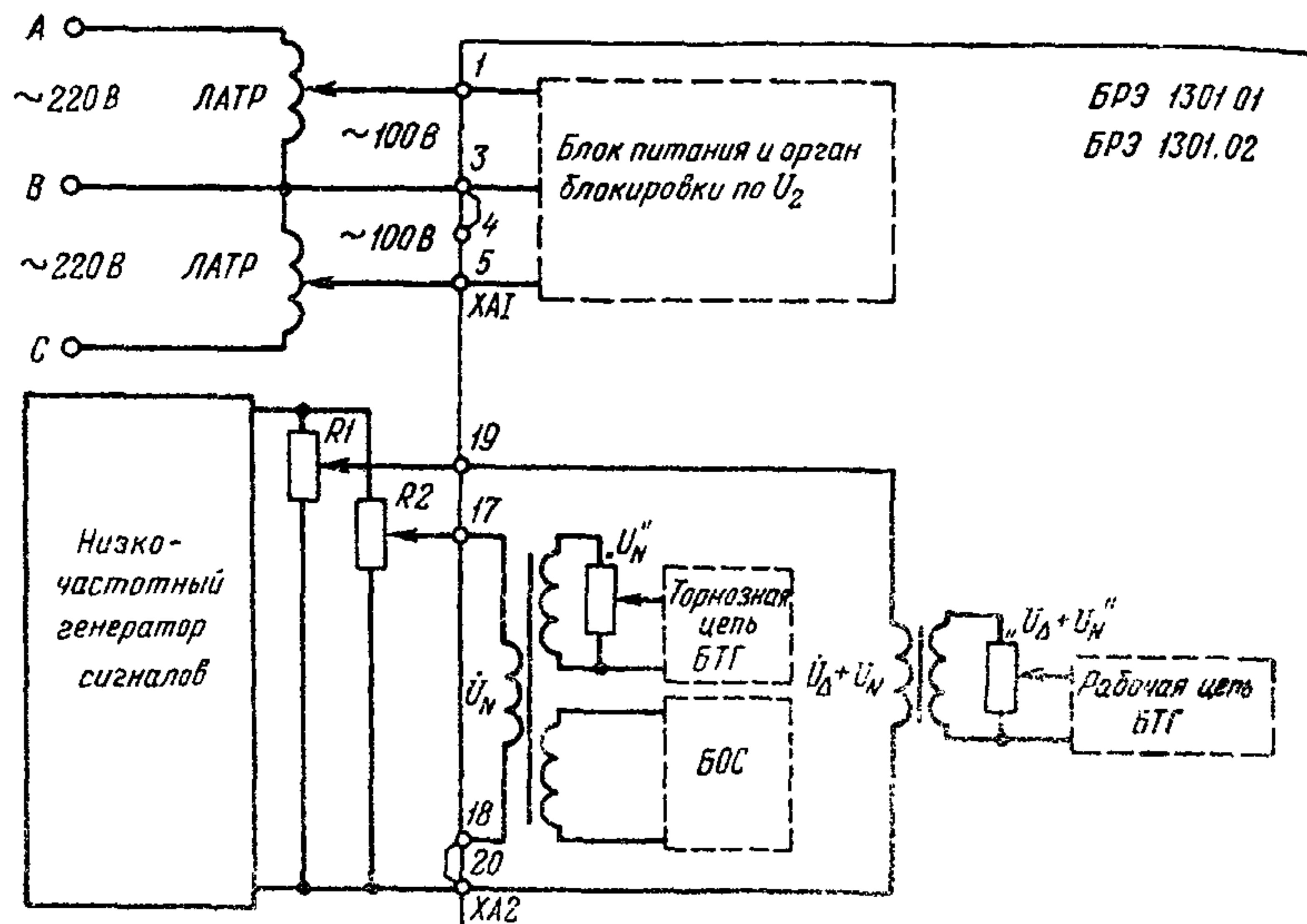
Рис.2. Схема проверки блока защиты БРЭ 1301.01 ( $R_1 = R_2 = 200-300 \Omega$ )
