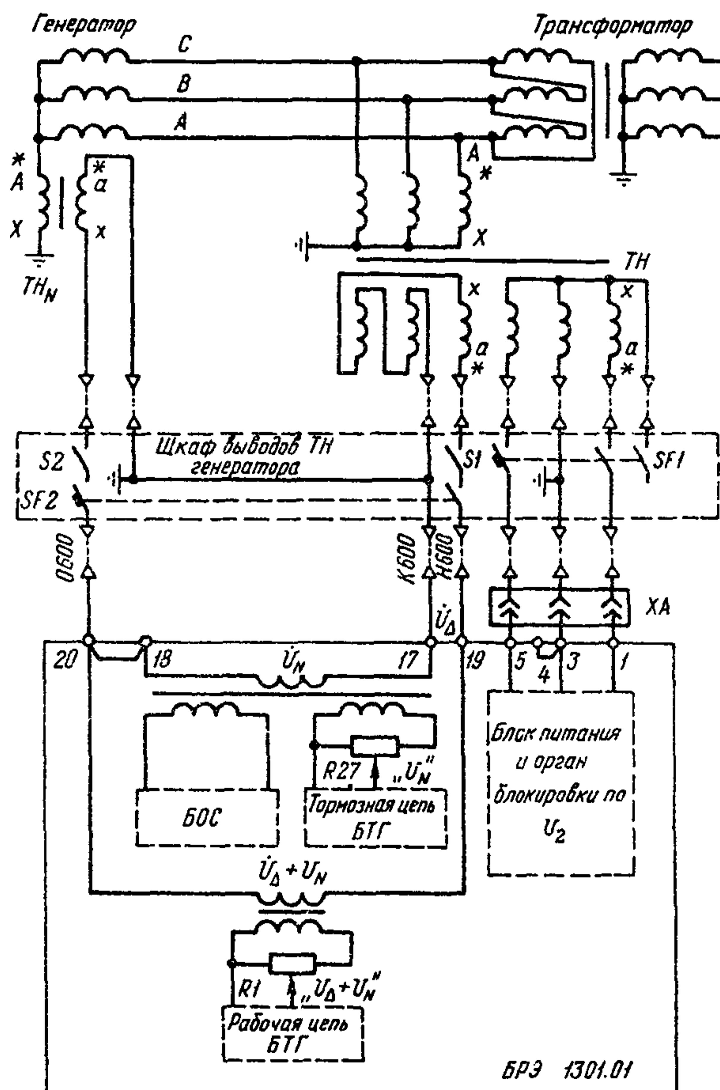
Рис.8. Схема подключения блока защиты БРЭ 1301.01 к цепям напряжения генератора энергоблока
