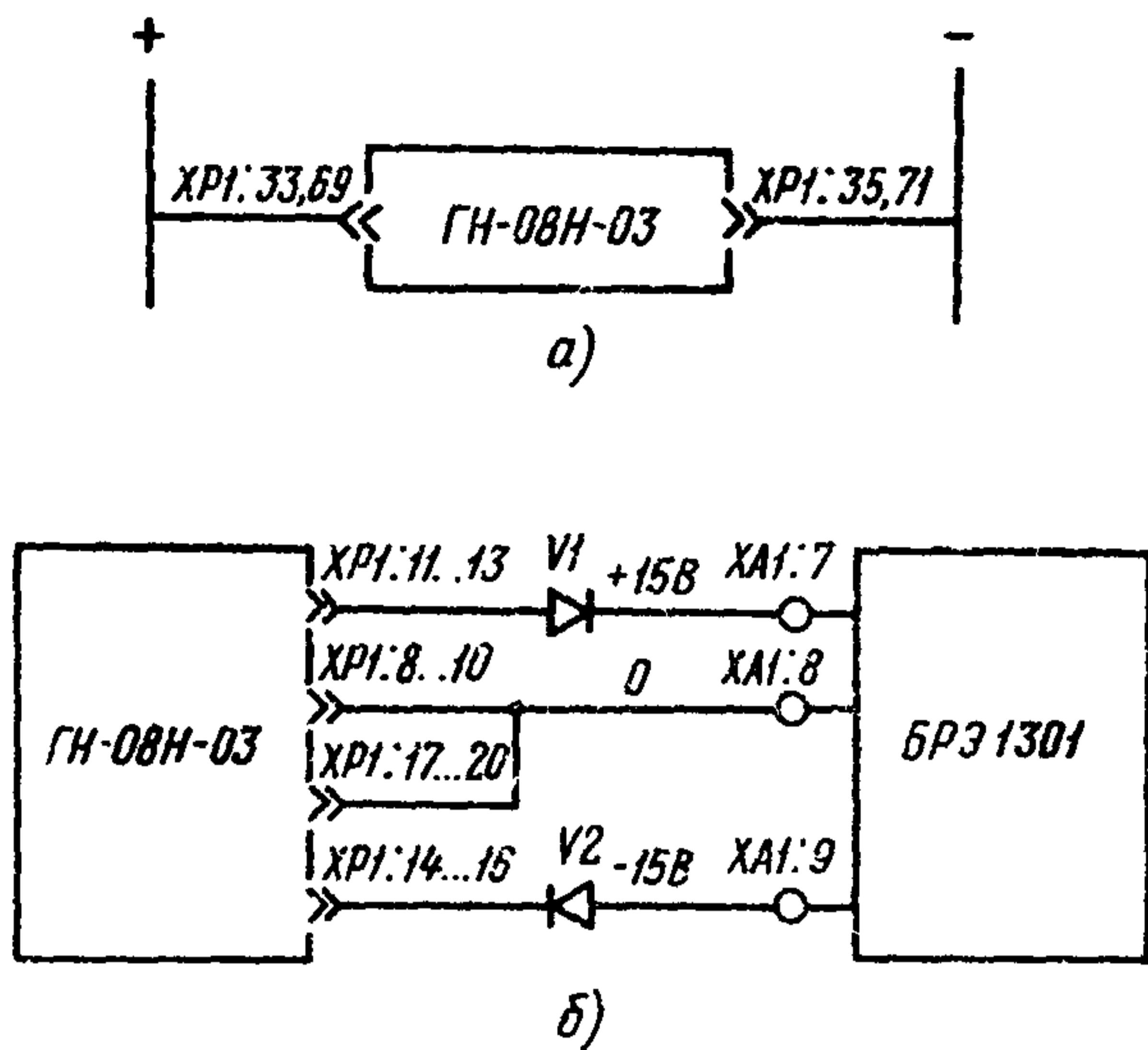
Рис.П7.1. Схема включения источника питания ГН-08Н-03:
