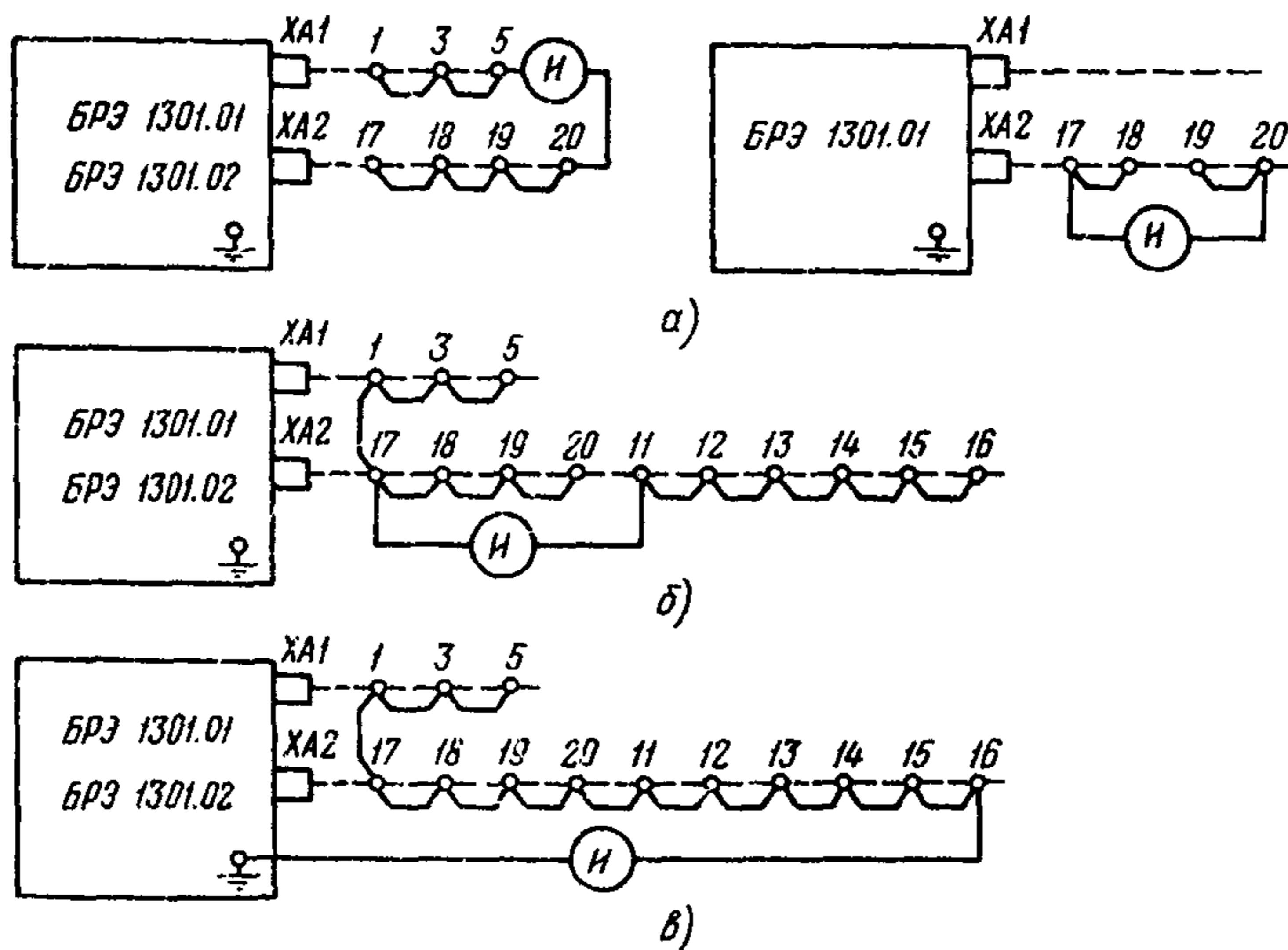
Рис. I. Схемы проверки сопротивления изоляции:
