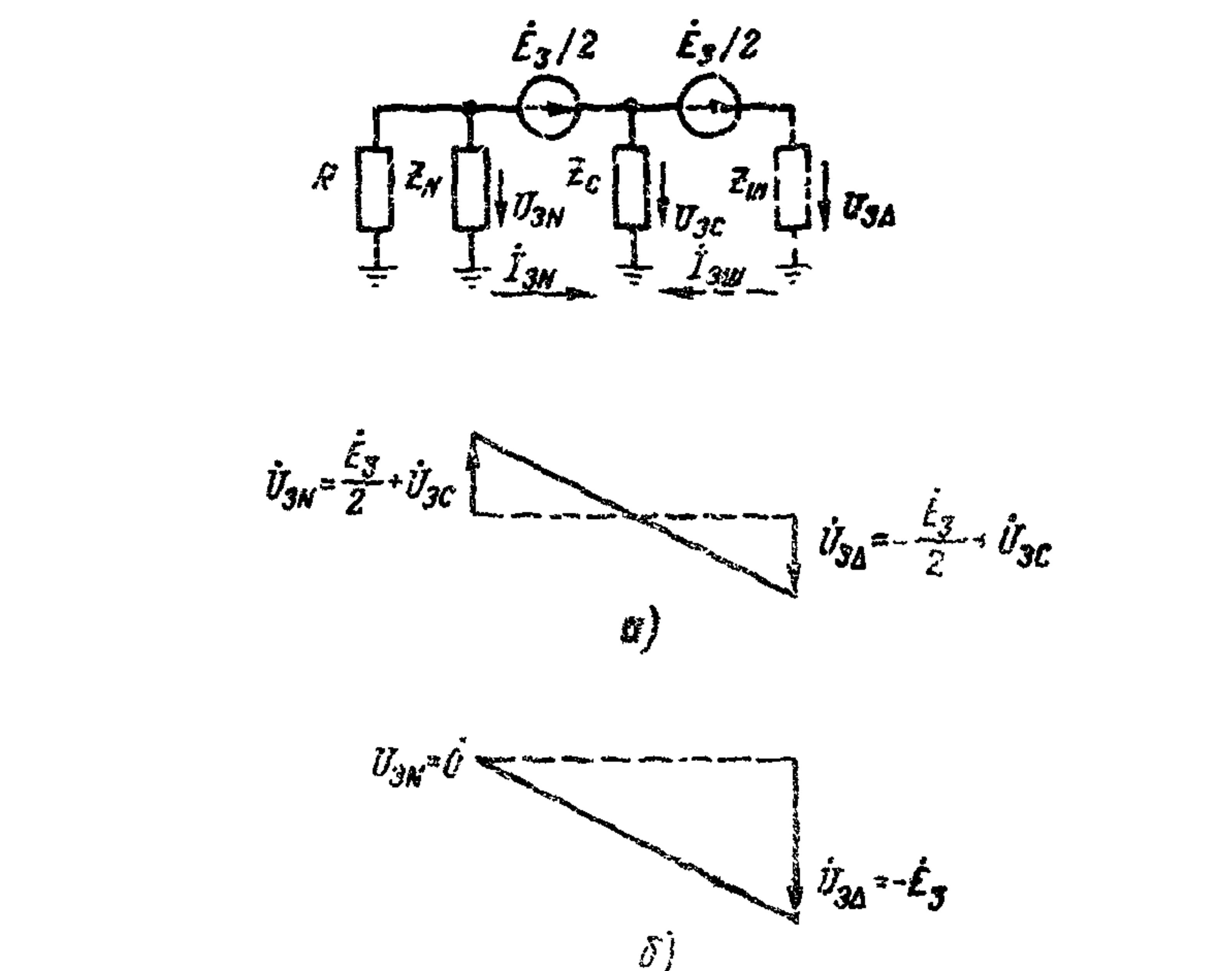
Рис.П2.3. Эквивалентная схема замещения сети генераторного напряжения блока генератор-трансформатор для составляющих третьей гармоники:
