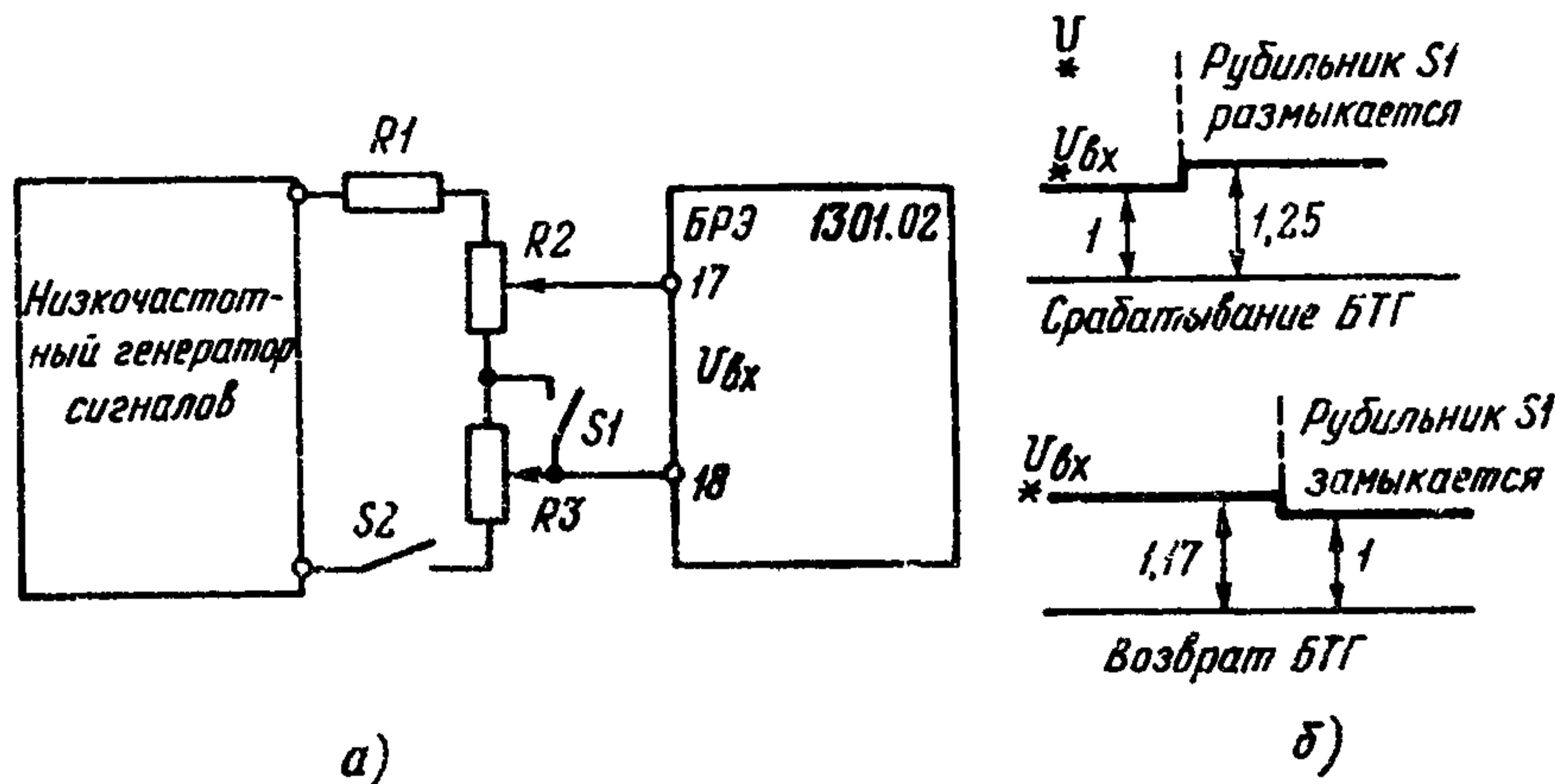
Рис.6. Схема проверки БТГ блока защиты БРЭ 1301.02:
