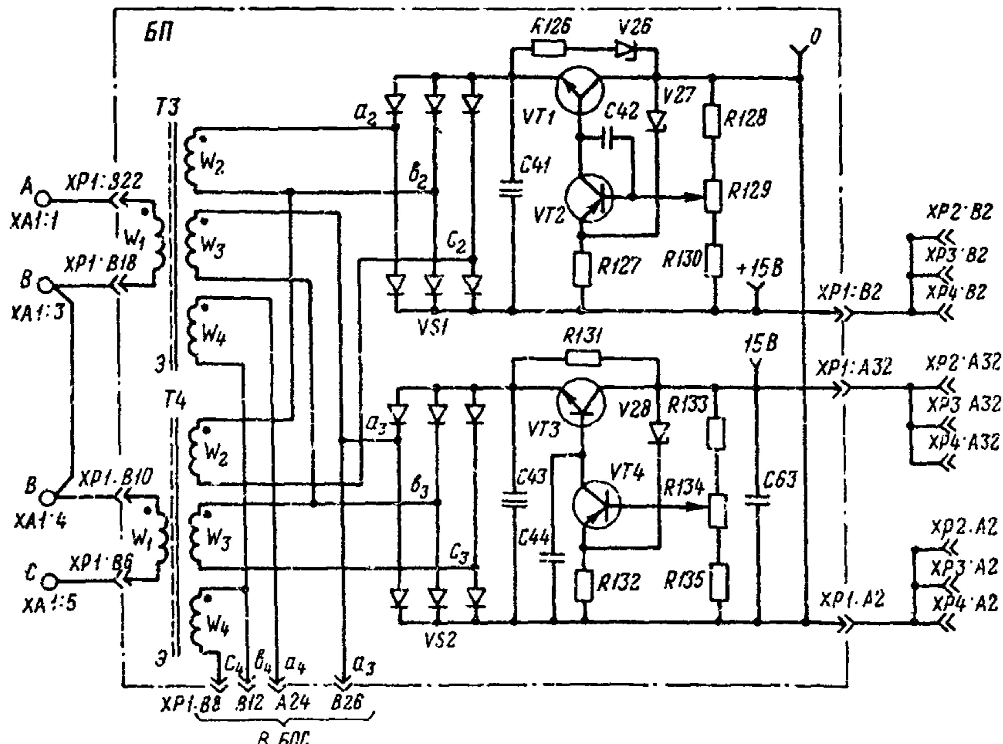
Рис.4. Принципиальная электрическая схема блока питания
