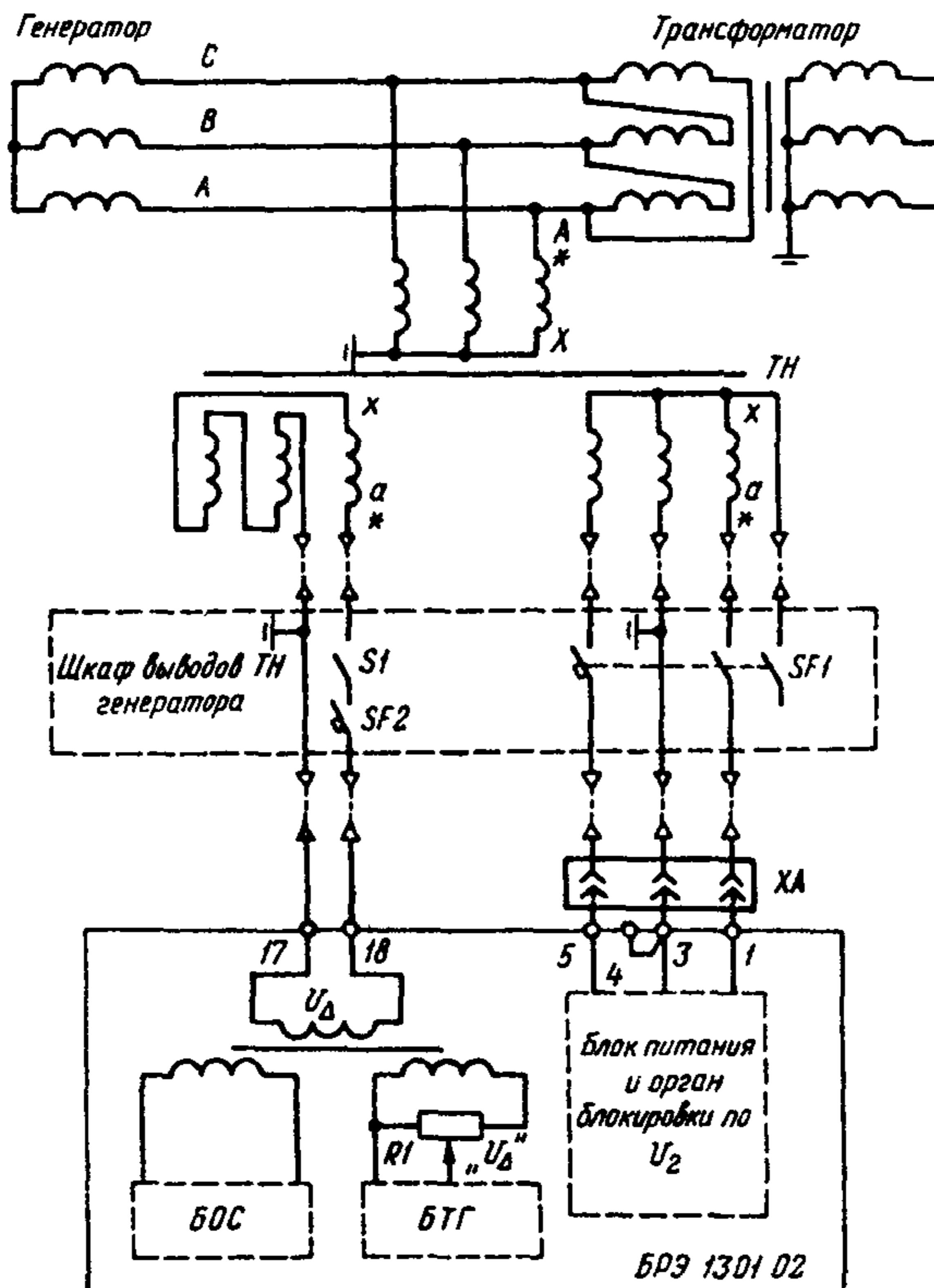
Рис.9. Схема подключения блока защиты БРЭ I301.02
