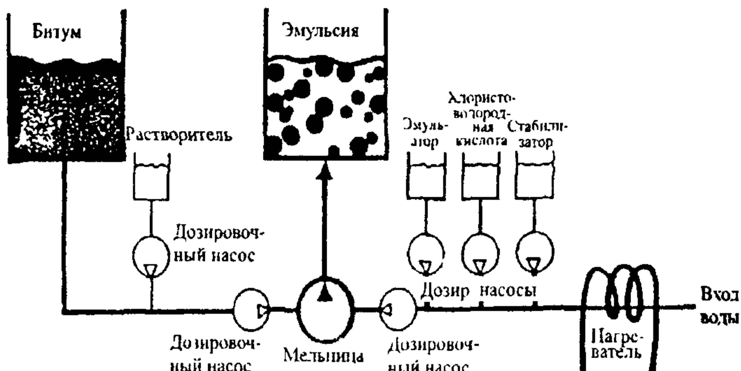
**Рис. 3.3. Принципиальная схема установки непрерывного действия**
