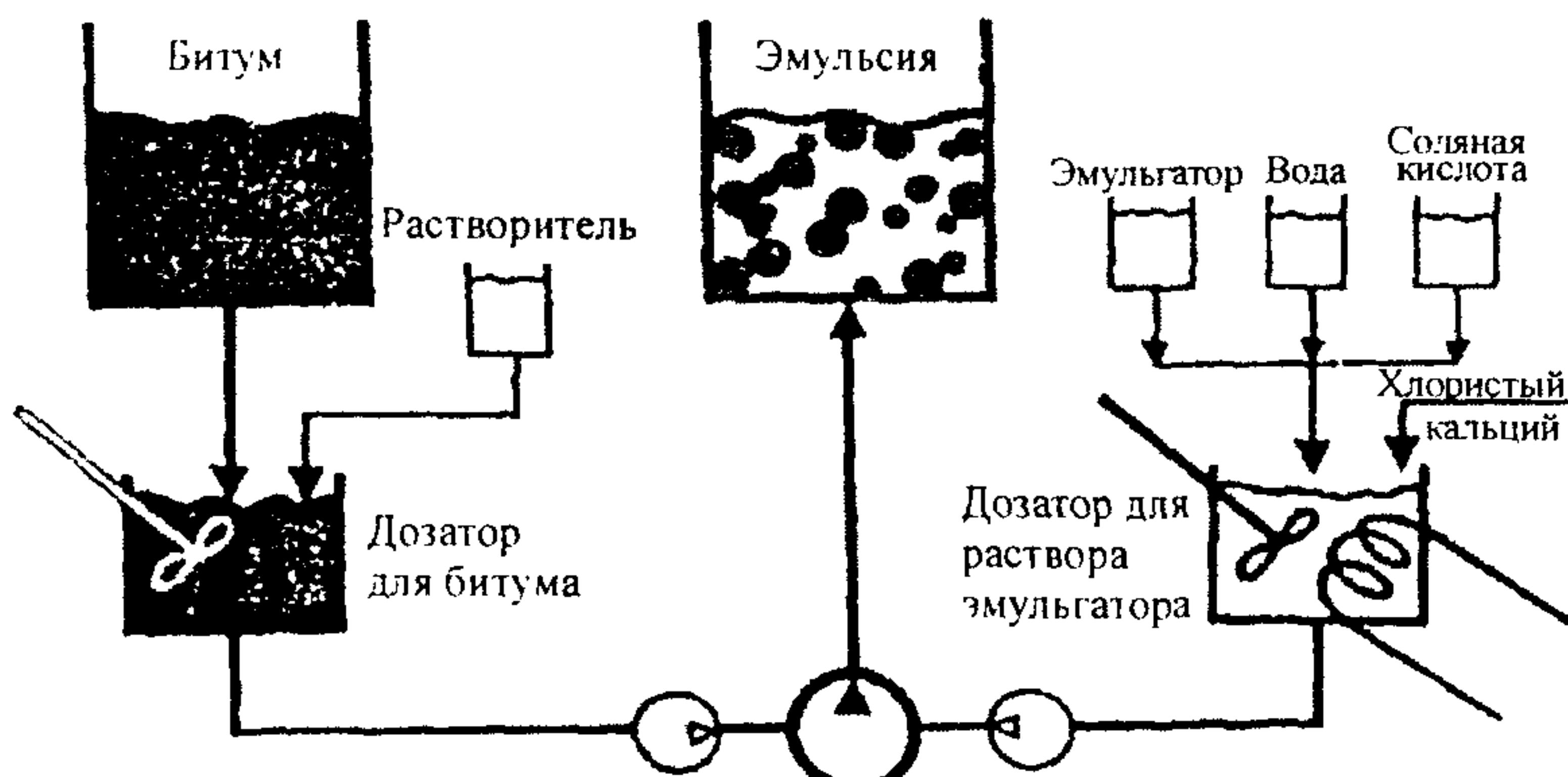
*Рис. 3.2. Принципиальная схема установки периодического действия*
