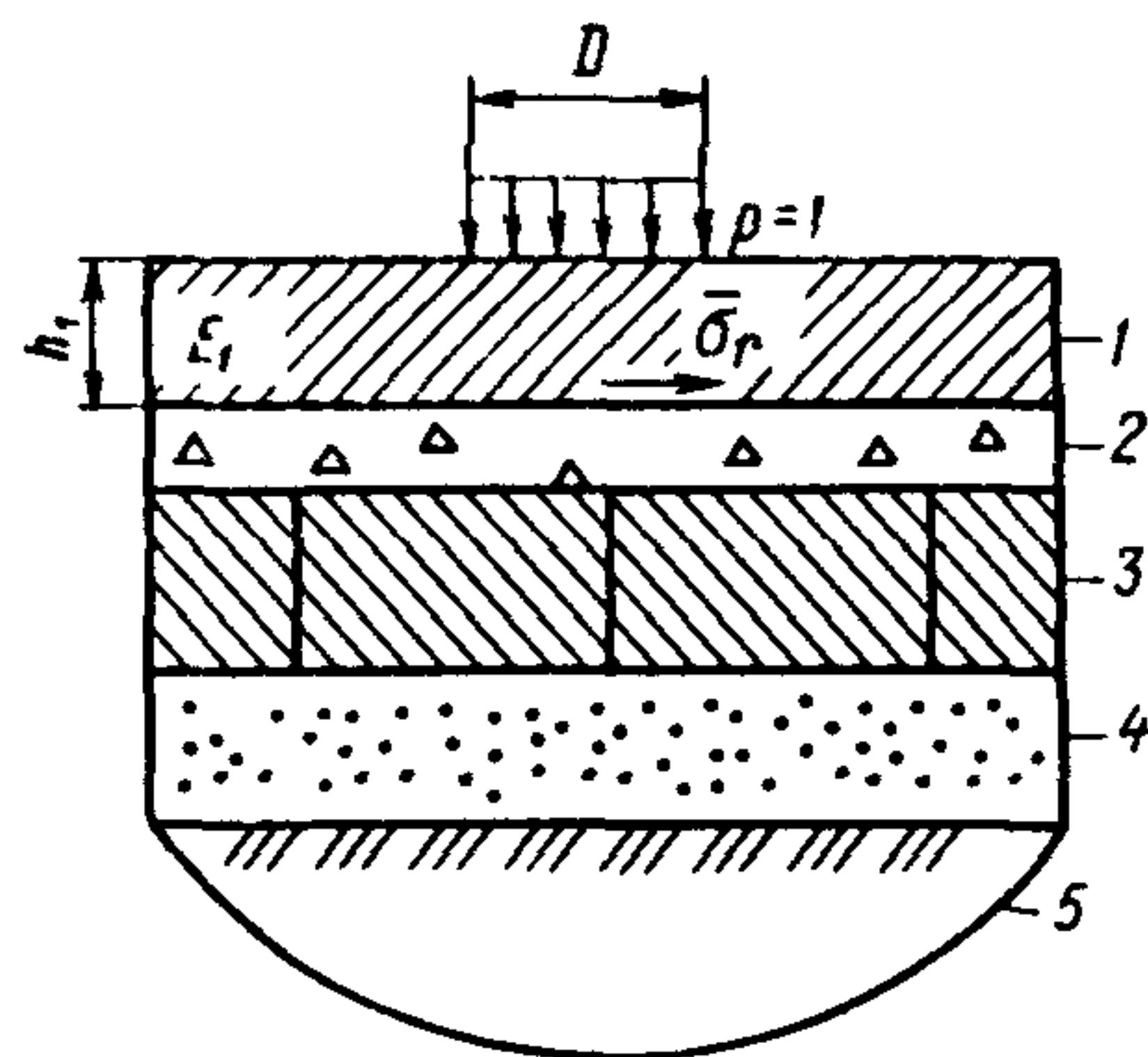
Рис.1. Расчетная схема для определения растягивающих напряжений в асфальтобетонном покрытии, расположенному на блочном основании с трещинопрерывающими слоями; 1-асфальтобетонное покрытие толщиной  $h$ , 2-трещинопрерывающий слой; 3-блочное основание; 4-нижние слои основания; 5-грунт земляного полотна;  $D$ -диаметр круга, равновеликого площади контакта колеса с покрытием;  $\sigma_x$ -растягивающее напряжение в асфальтобетонном покрытии от единичной нагрузки  $\rho=1$
