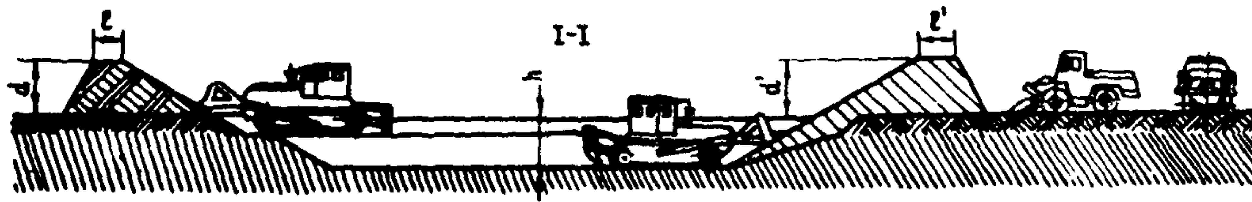
Рис.1. Технологическая схема разработки кира с использованием бульдозера :
