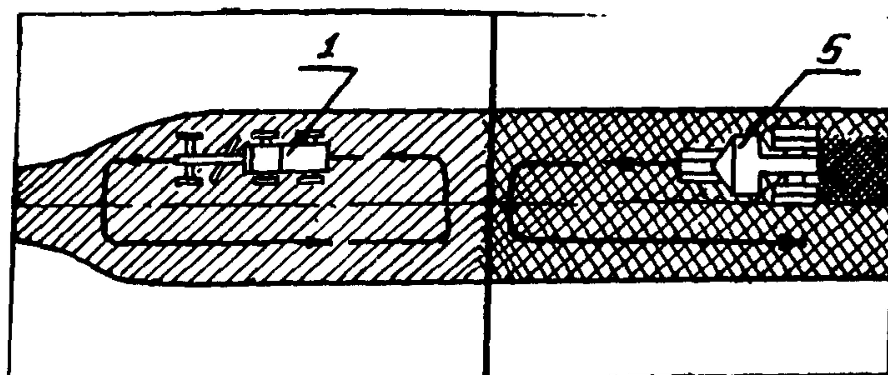
1-автогрейдер Д-557-1; 2-автомобиль-самосвал МАЗ-503Б; ПМ-130; 5-каток Д-697; 6-автогудронатор Д-640А
