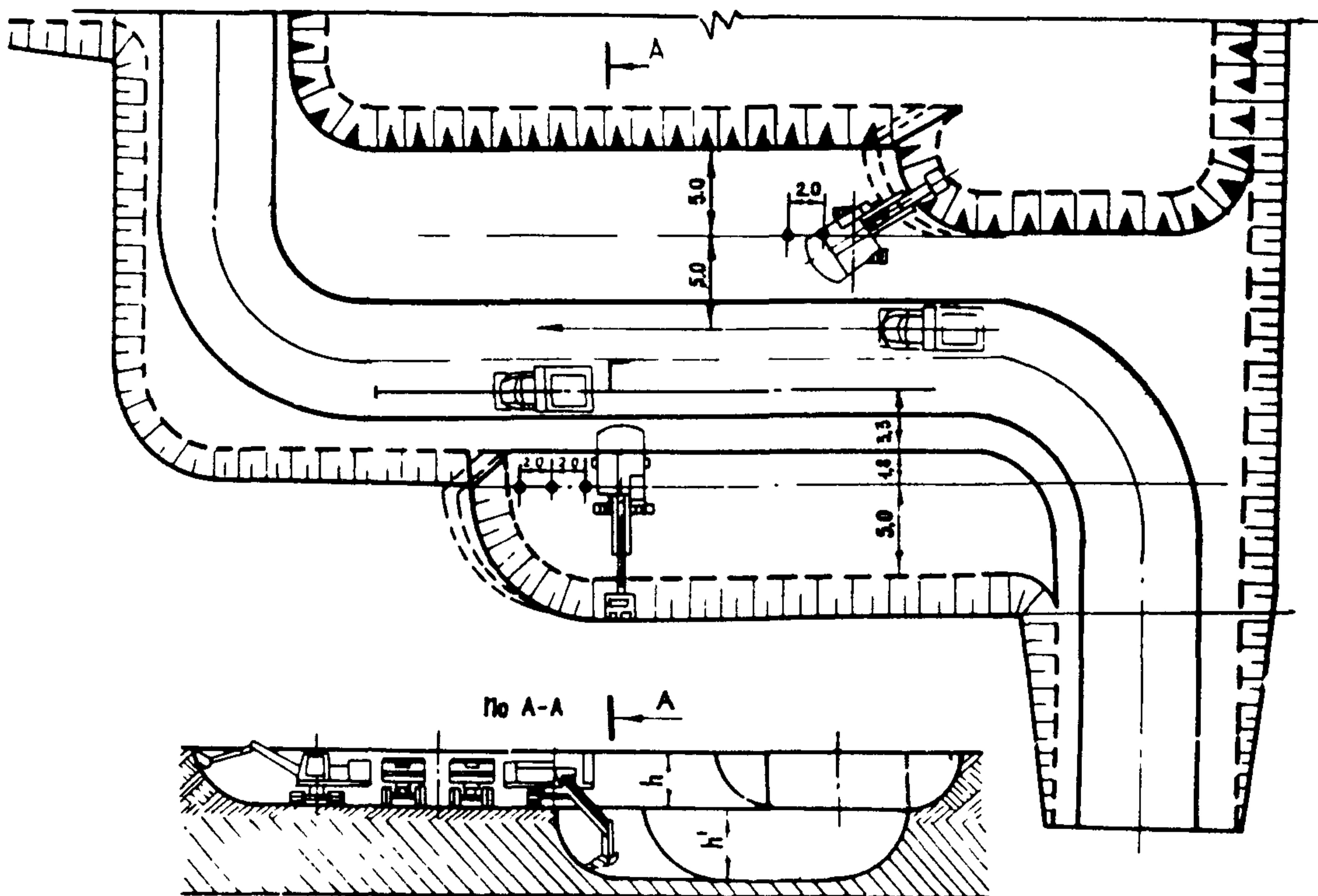
Рис.2. Технологическая схема разработки кира экскаватором с обратной лопатой:
