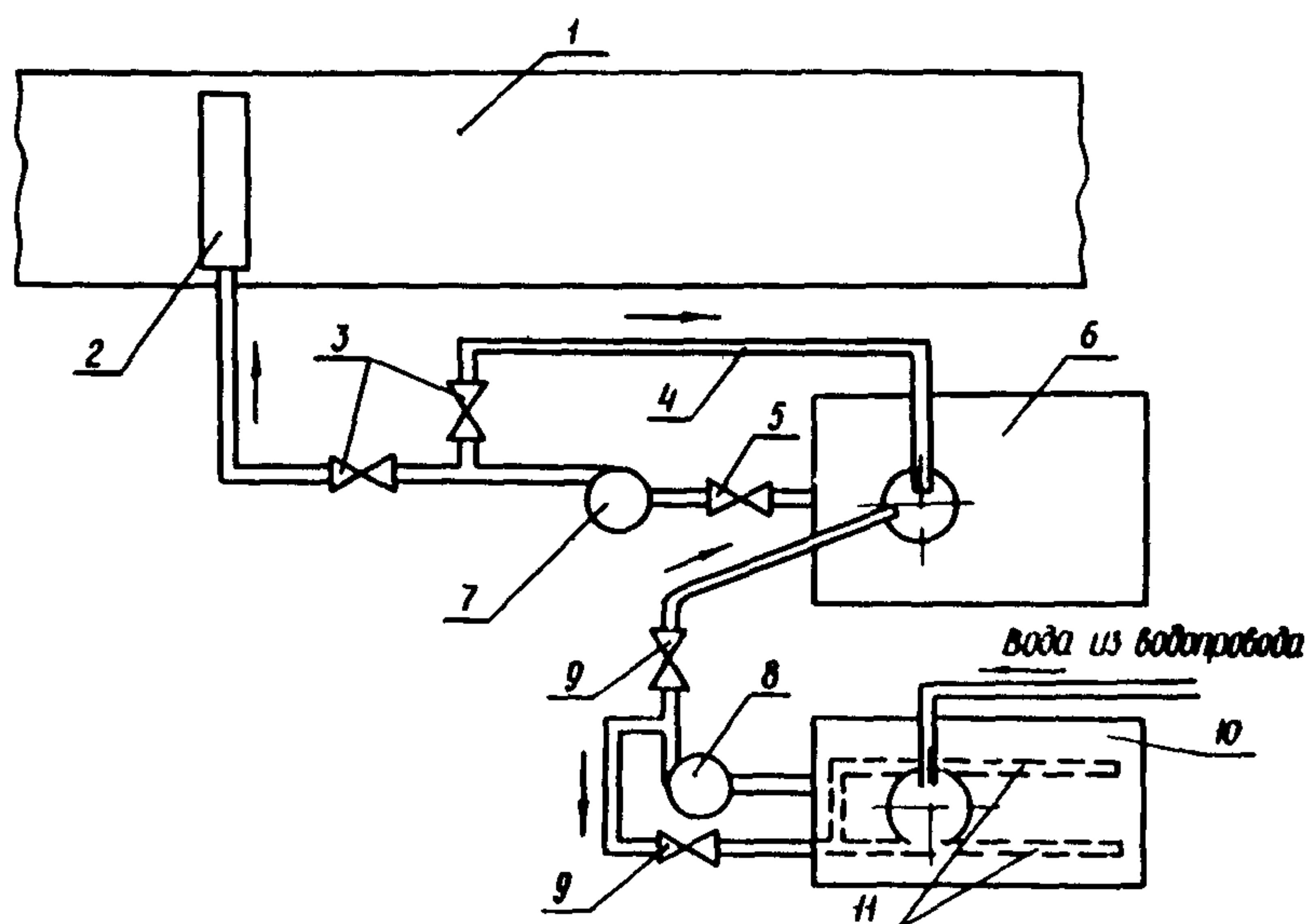
Схема узла подачи, дозирования и распределения эмульсии:
