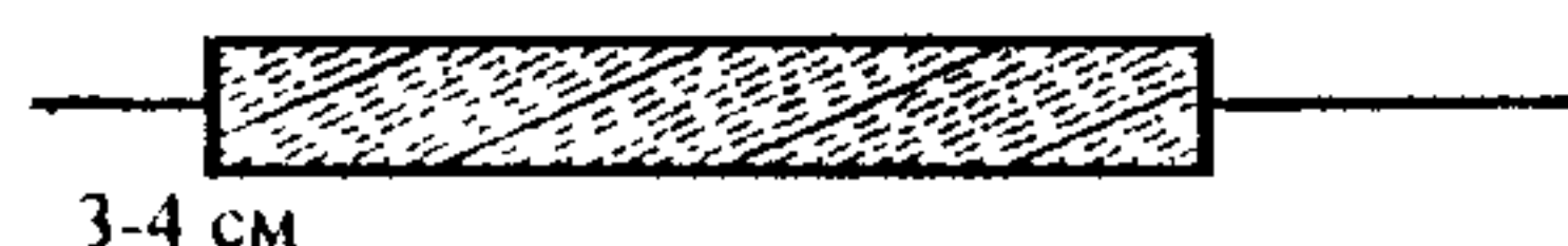
Рис.5. Укладка бетонной смеси с учетом уплотнения
