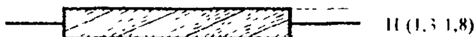
Рис.3. Заполнение выбоины ремонтным материалом с запасом на уплотнение
