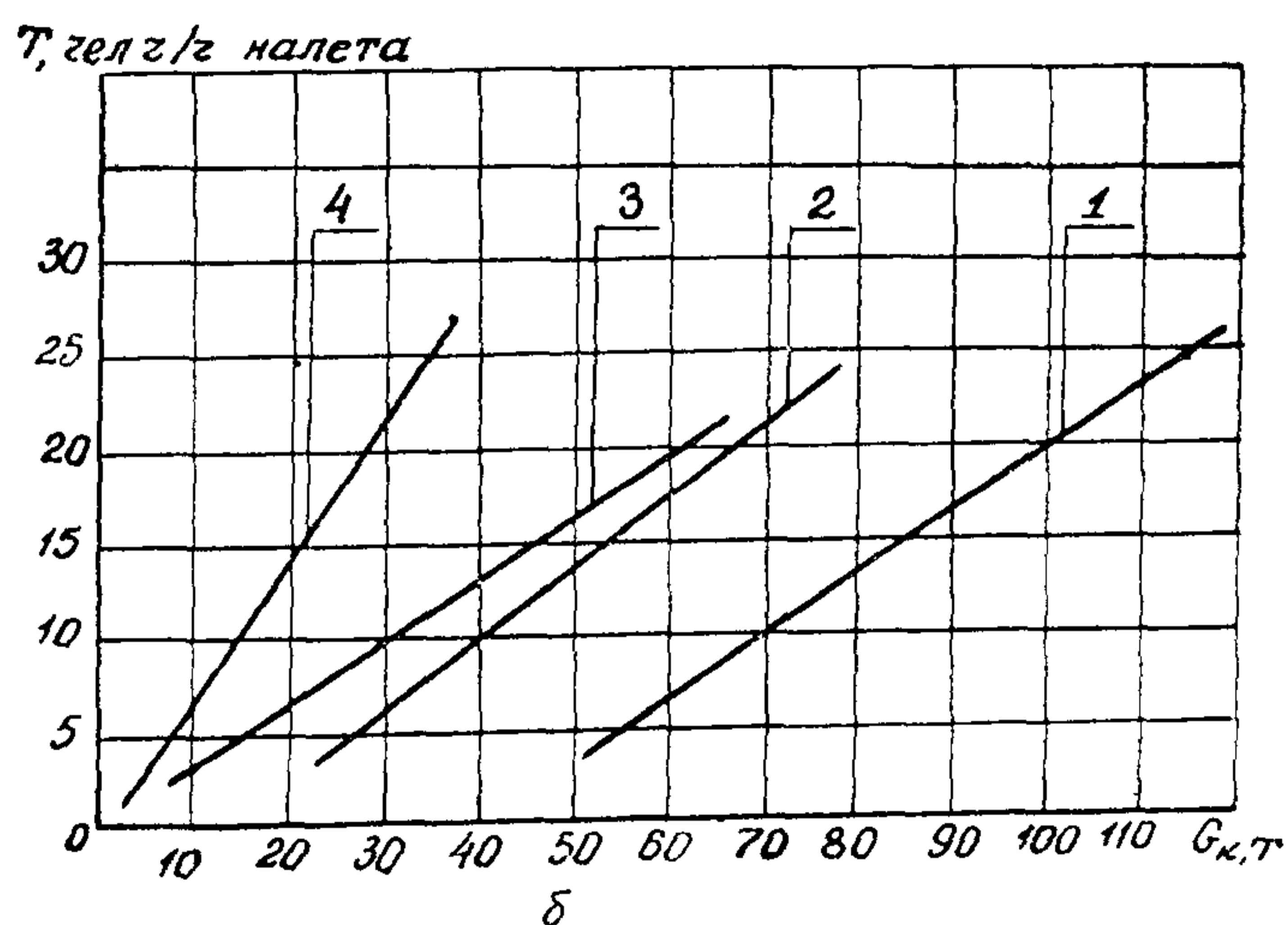
Рис. 3. Удельная трудоемкость технического обслуживания ВС в зависимости от массы конструкции вертолетов I-III классов (а) и самолетов I-IU групп (б)
