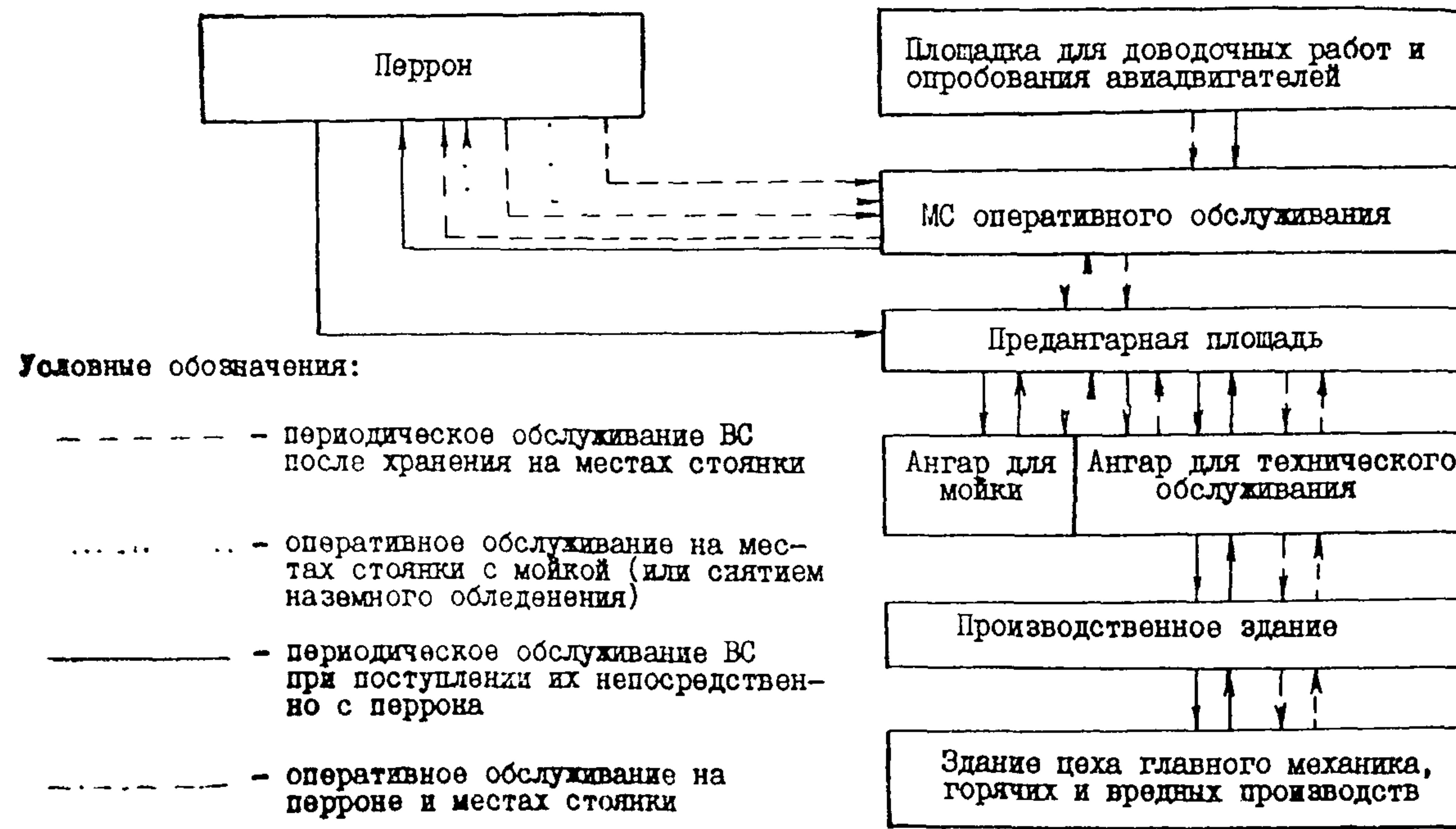
Рис. I. Схема технологической взаимосвязи зданий и сооружений АТБ I-II групп
