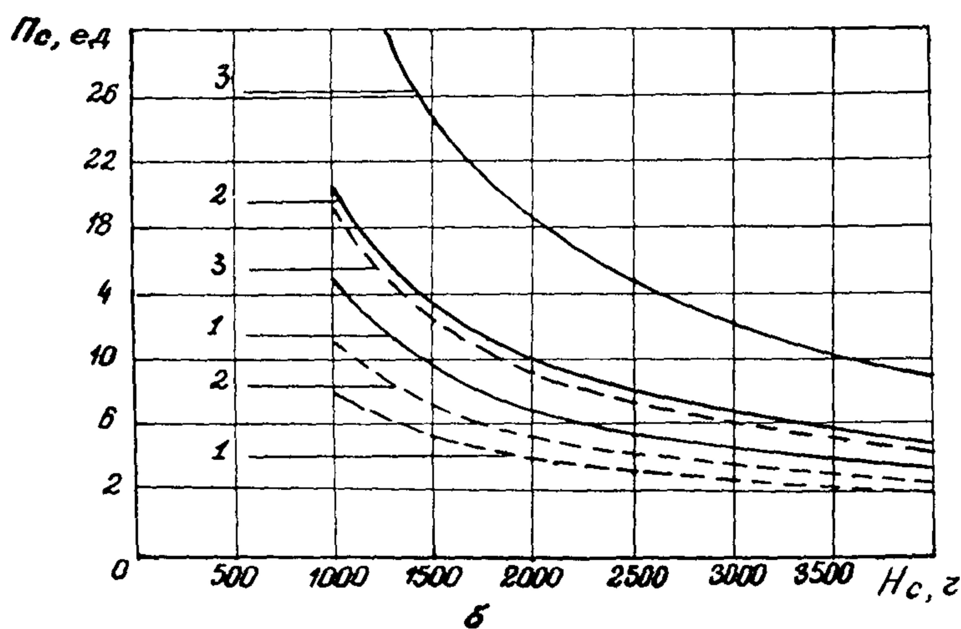
Рис. 4. Пропускная способность одного ангарного места стоянки для перспективных воздушных судов Ил-96 (1), Ту-204 (2) и Ми-26 (3): а - в АТБ, имеющей не более двух типов ВС в приписном парке; б - в АТБ с многотипным приписным парком
