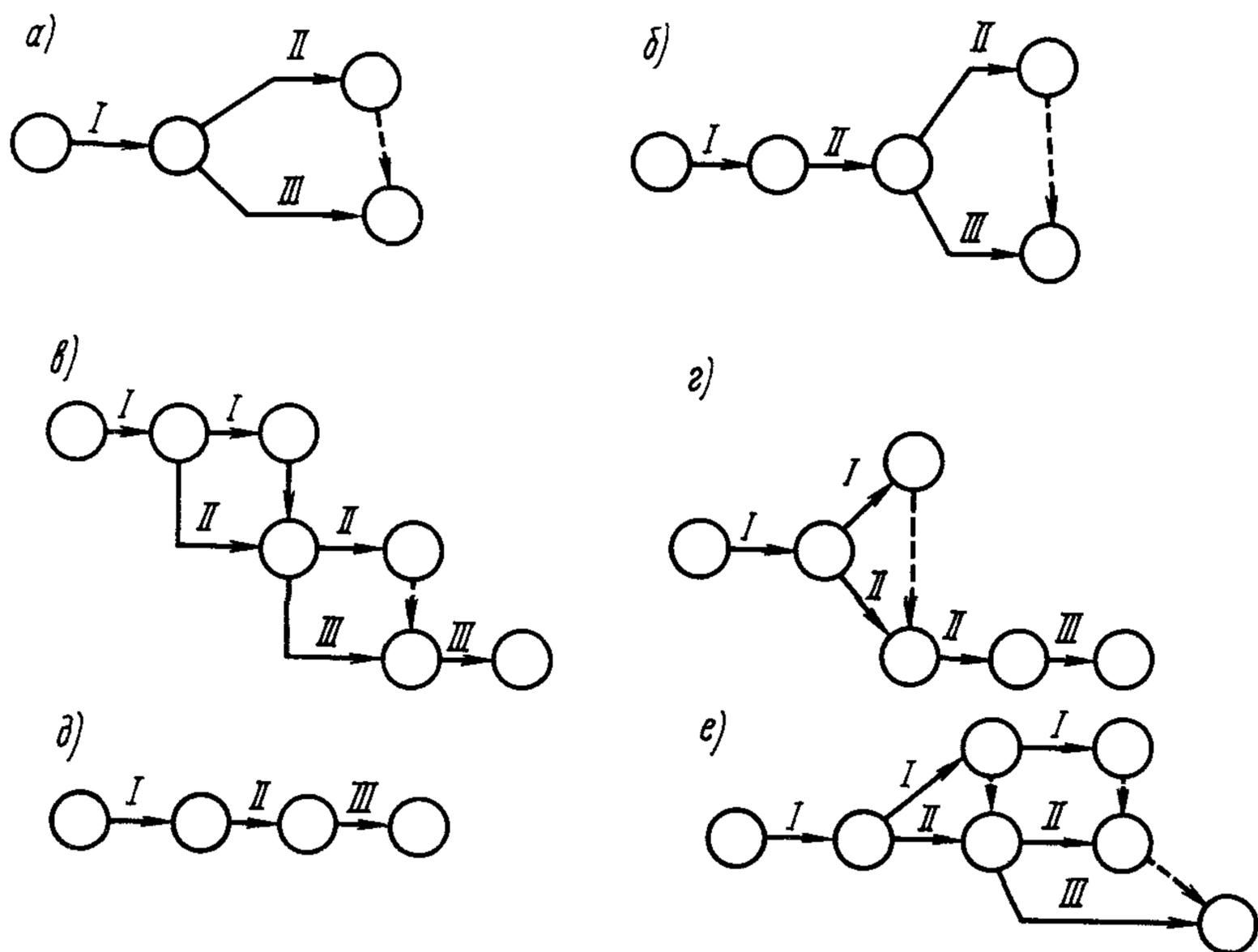
**Рис. 4. Варианты производства подготовительных работ**
