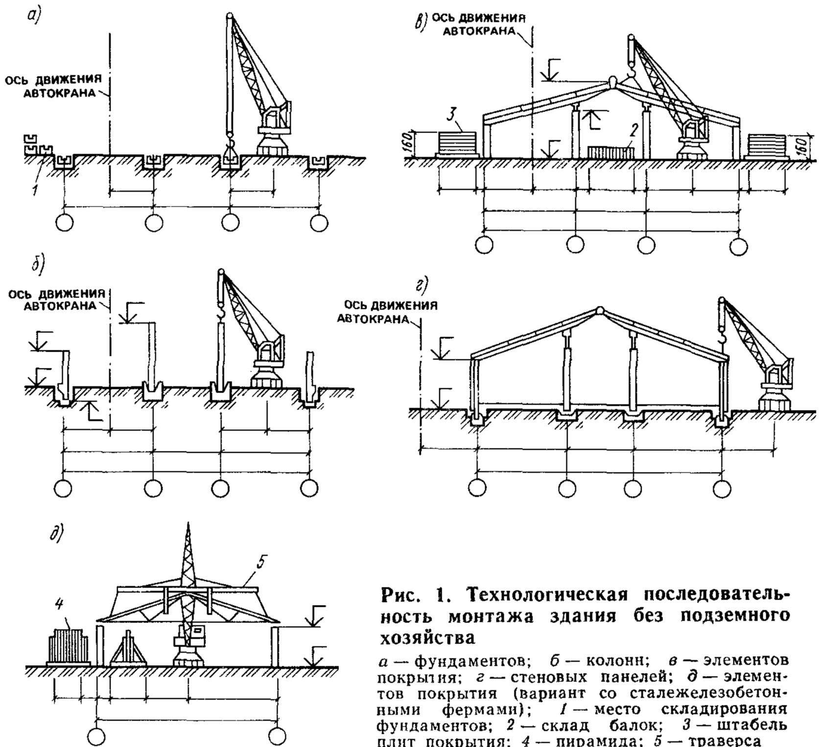
**Рис. 1. Технологическая последовательность монтажа здания без подземного хозяйства**
