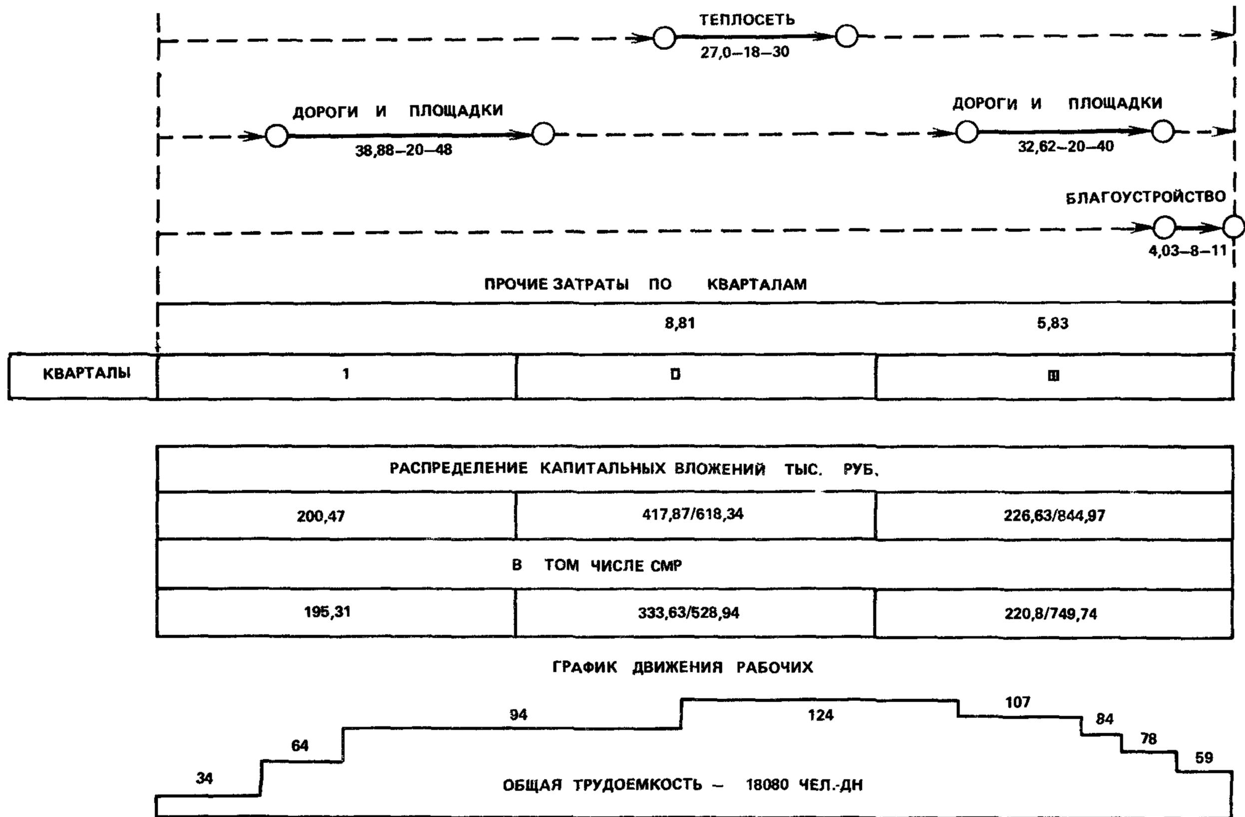
Рис. 5. Комплексный укрупненный сетевой график строительства свиноводческой фермы
