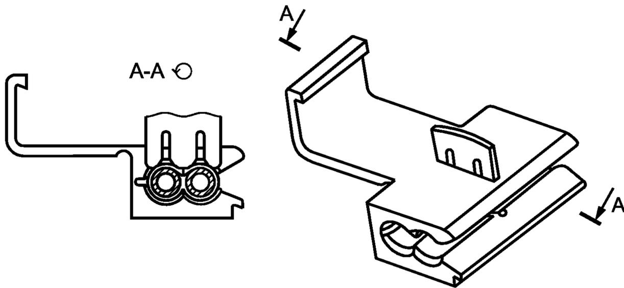
**Зажим с электропроводящим прижимным контактом в устройстве с прокалыванием изоляции соединяемого проводника**
