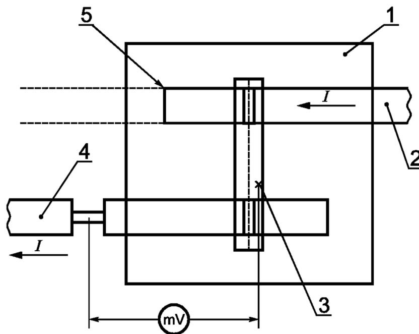
1 — зажим; 2 — проводник электрической сети; 3 — точка измерения падения напряжения; 4 — отводящий проводник с частично снятой изоляцией; 5 — отрезок проводника питающей электрической сети;  $I$  — испытательный ток, назначаемый исходя из наименьшего сечения питающего и отводящего проводников
