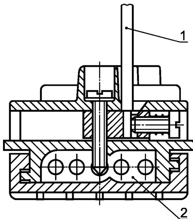
1 — соединяемый проводник; 2 — питающий проводник электрической сети
