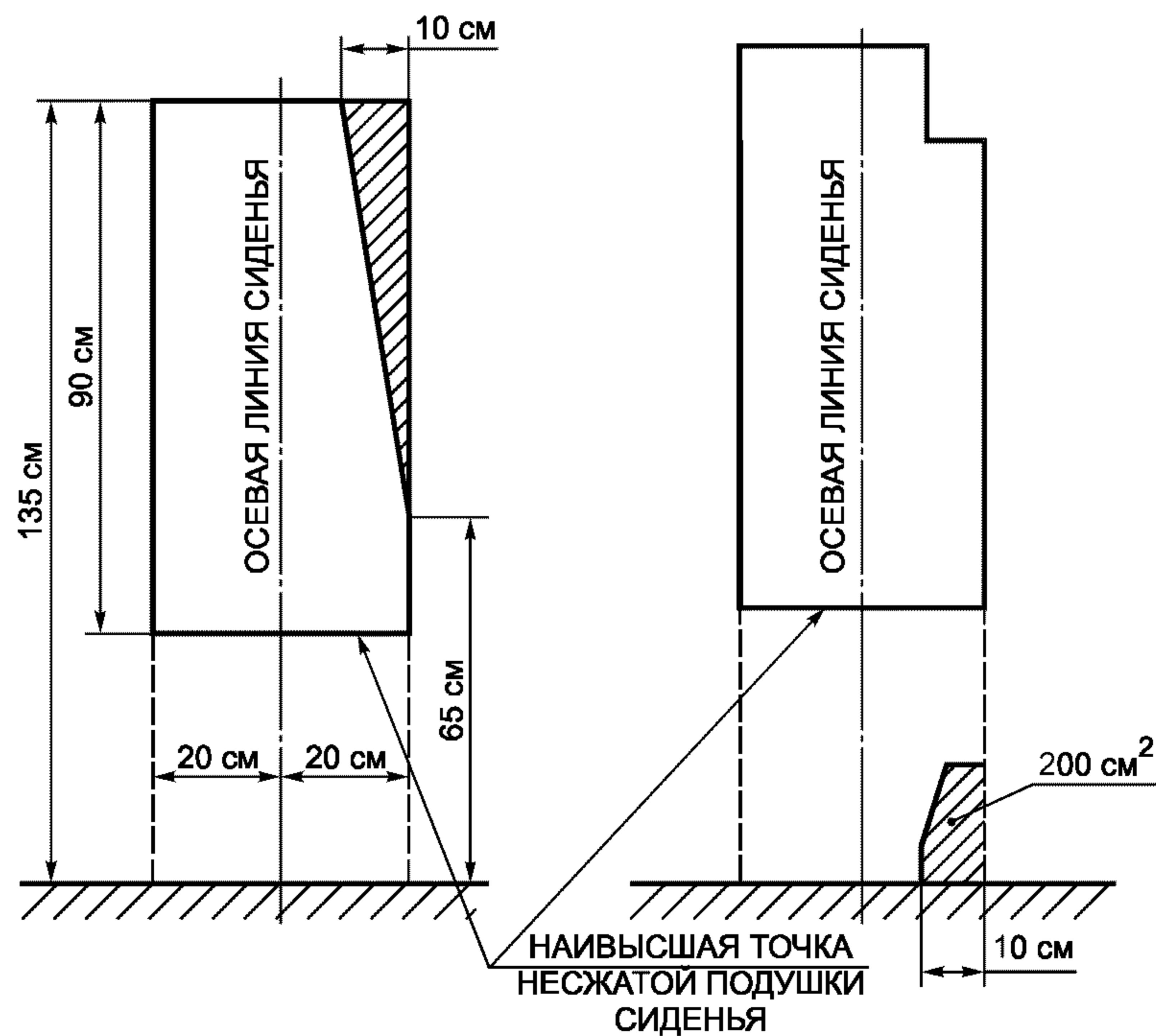
Рисунок 7 — Допустимое выступание деталей конструкции внутрь зоны сиденья
