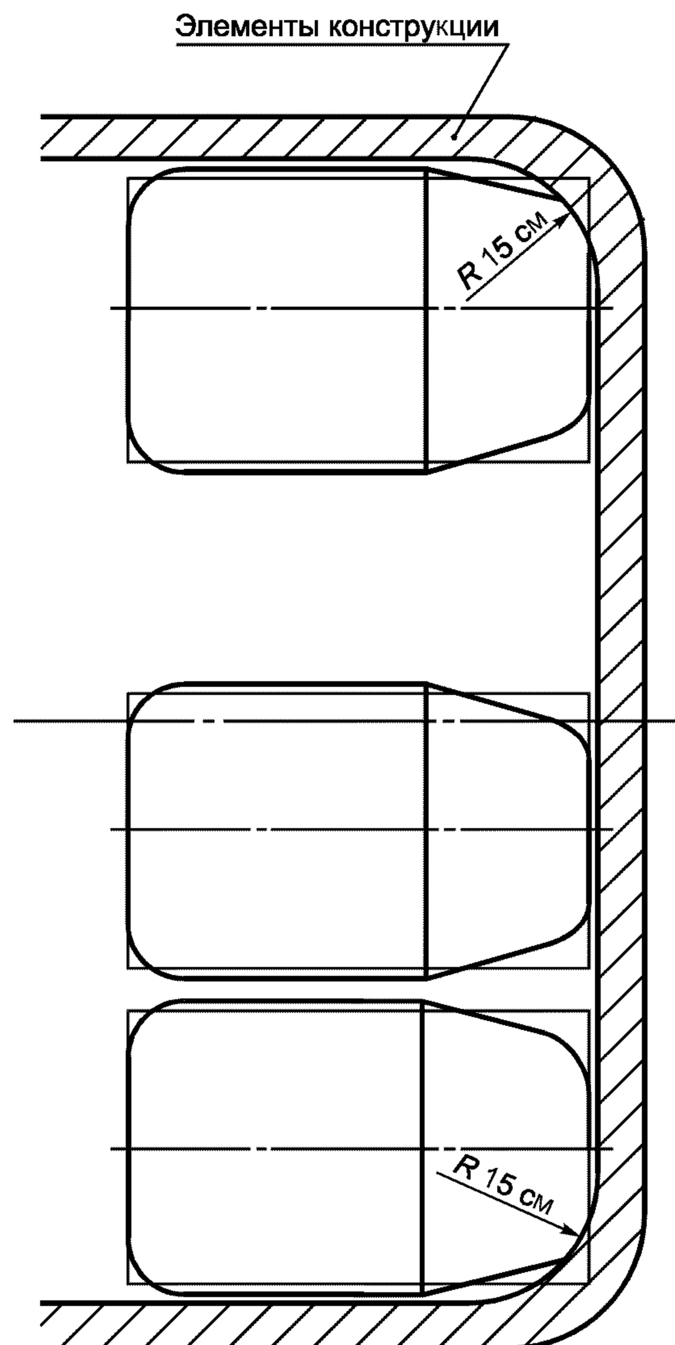
Рисунок 11 — Допустимое выступание конструкции в зону задних боковых сидений. Вид в плане зоны, предназначеннной для размещения сидений (два задних боковых сиденья)
