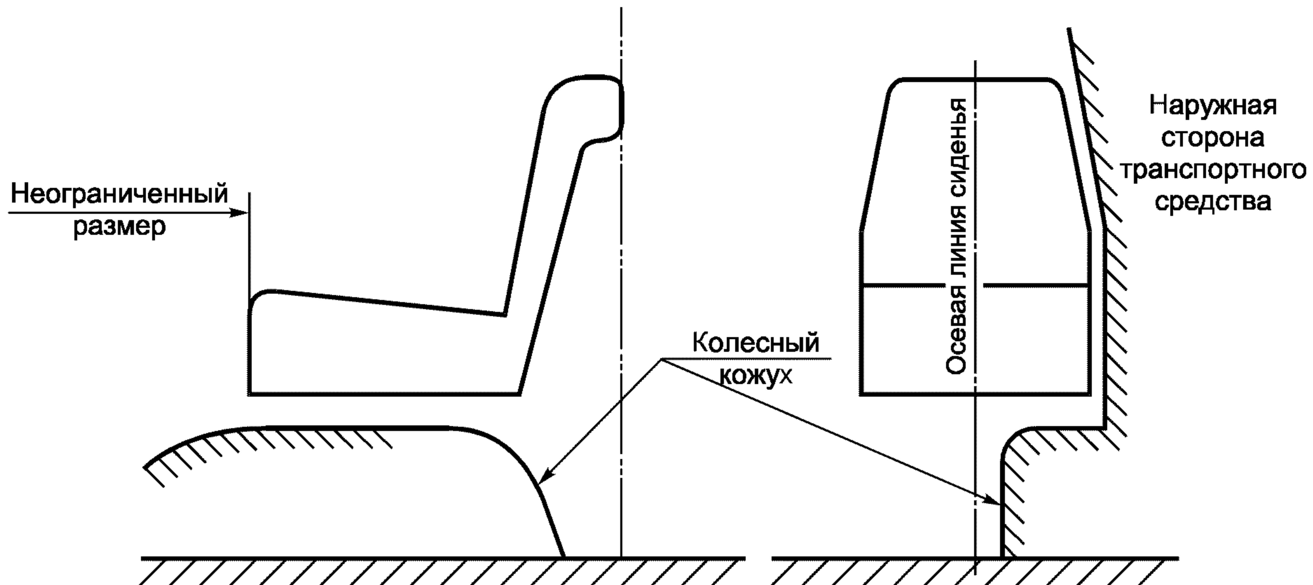
Рисунок 9 — Допустимое расположение колесного кожуха, не выступающего за вертикальную осевую линию бокового сиденья
