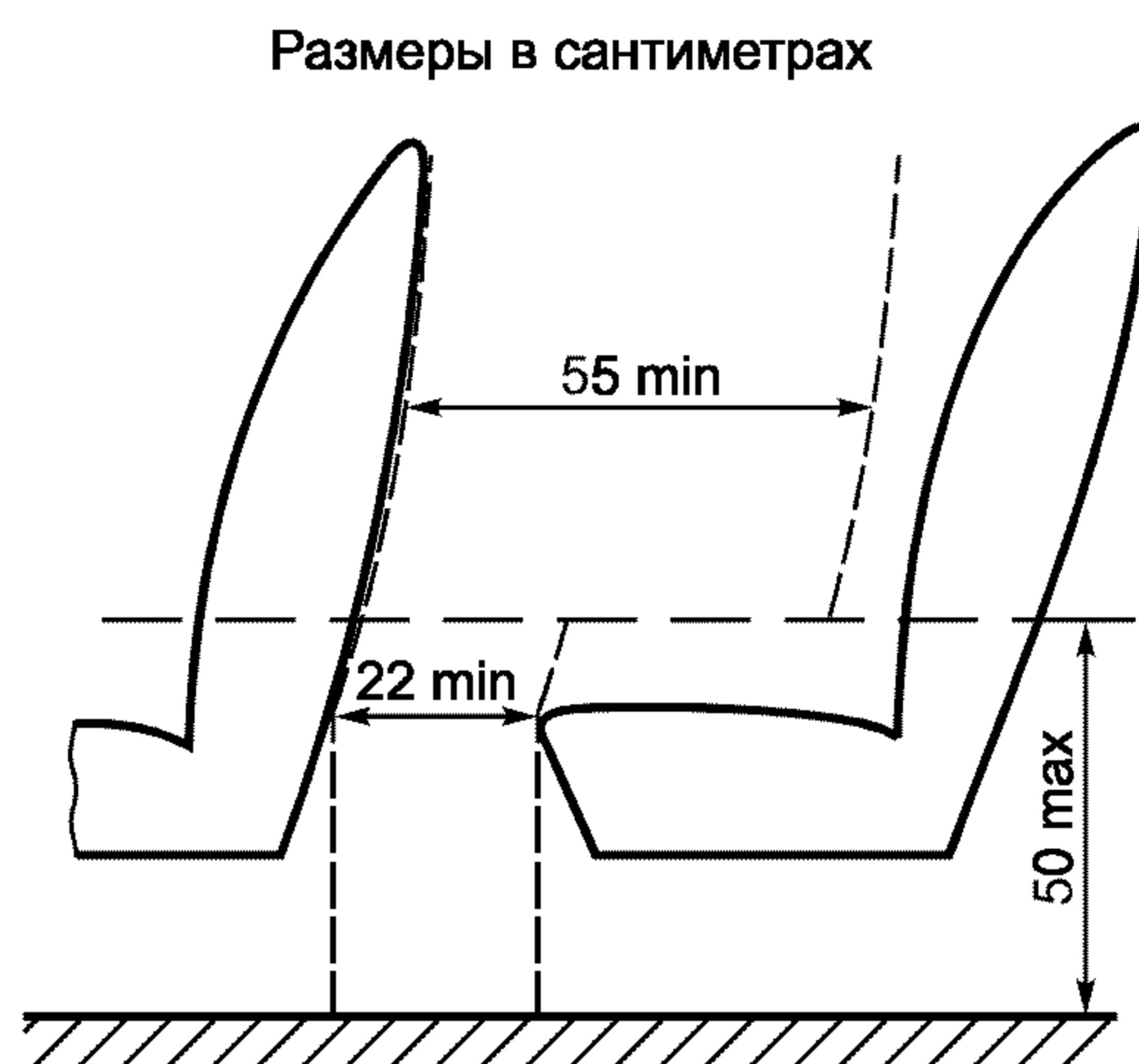
Рисунок 19 — Определение свободного доступа к двери (см. 5.7.1.10.1)
