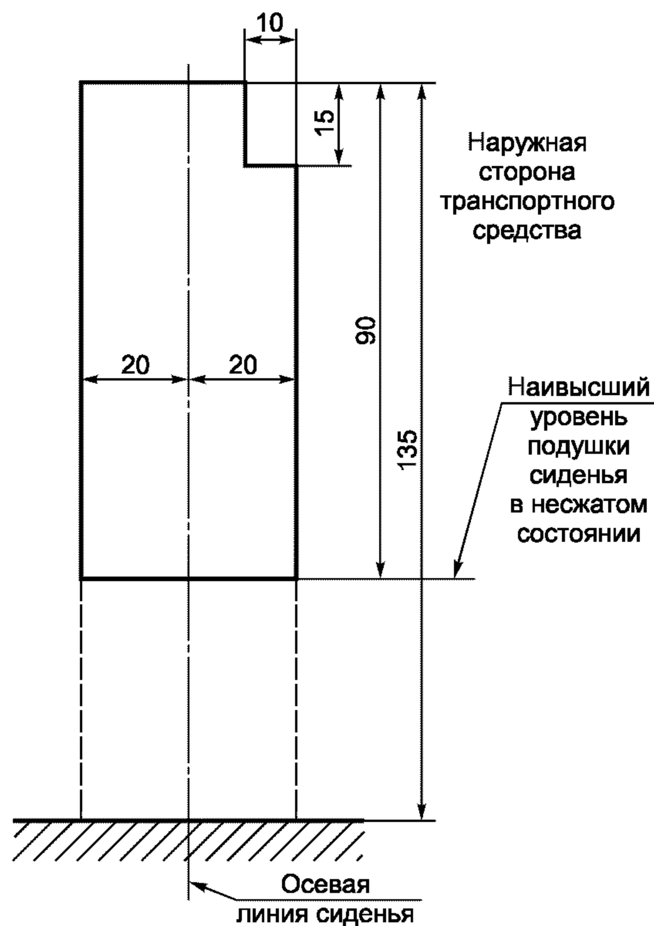
Рисунок 6 — Допустимое выступание конструкции внутрь зоны над сиденьем. Поперечное сечение минимального свободного пространства над сиденьем, размещенным возле боковой стенки транспортного средства (см. 5.7.8.1.2)
