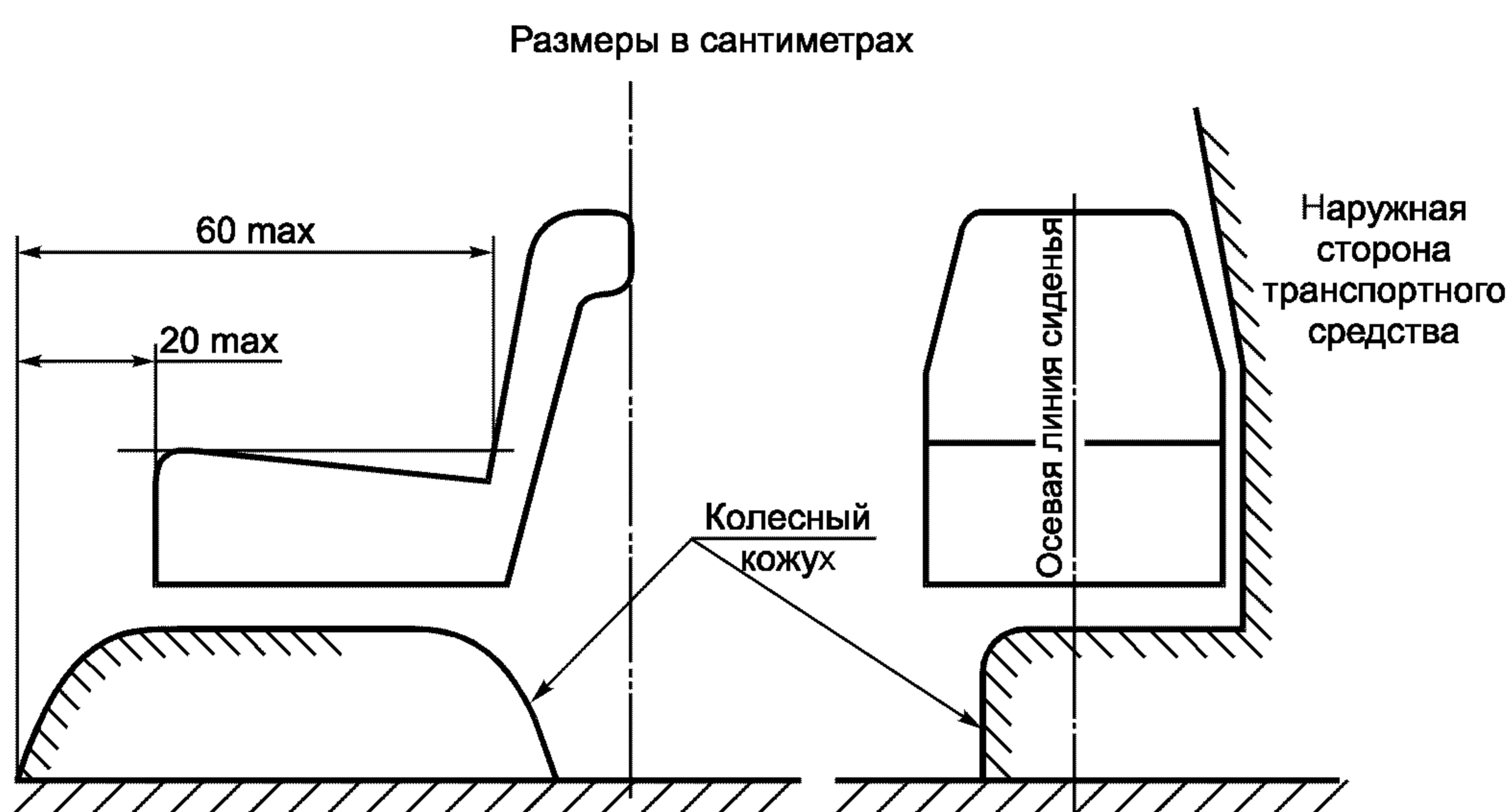
Рисунок 10 — Допустимое расположение колесного кожуха, выступающего за вертикальную осевую линию бокового сиденья
