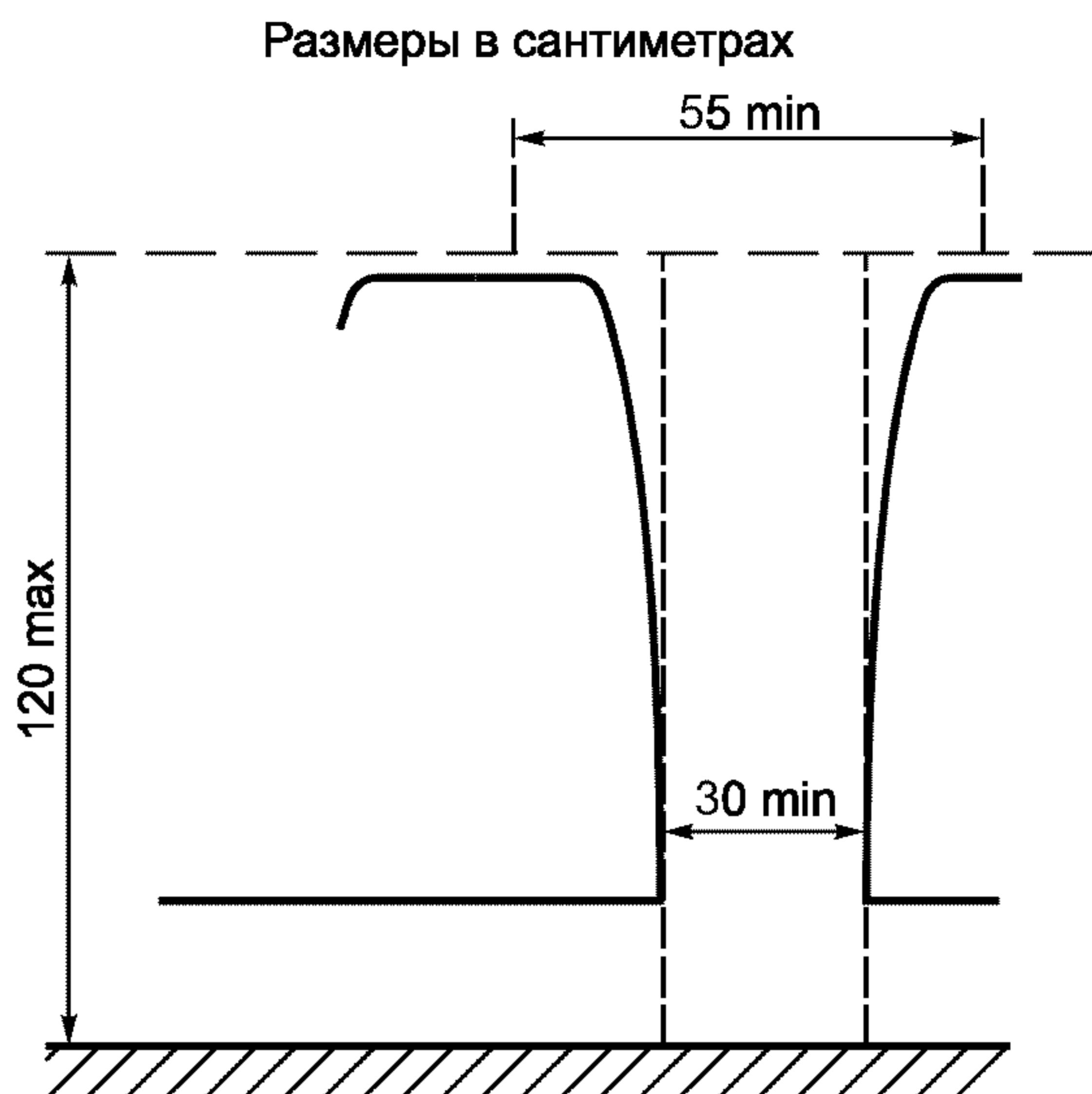
Рисунок 20 — Определение свободного доступа к двери
