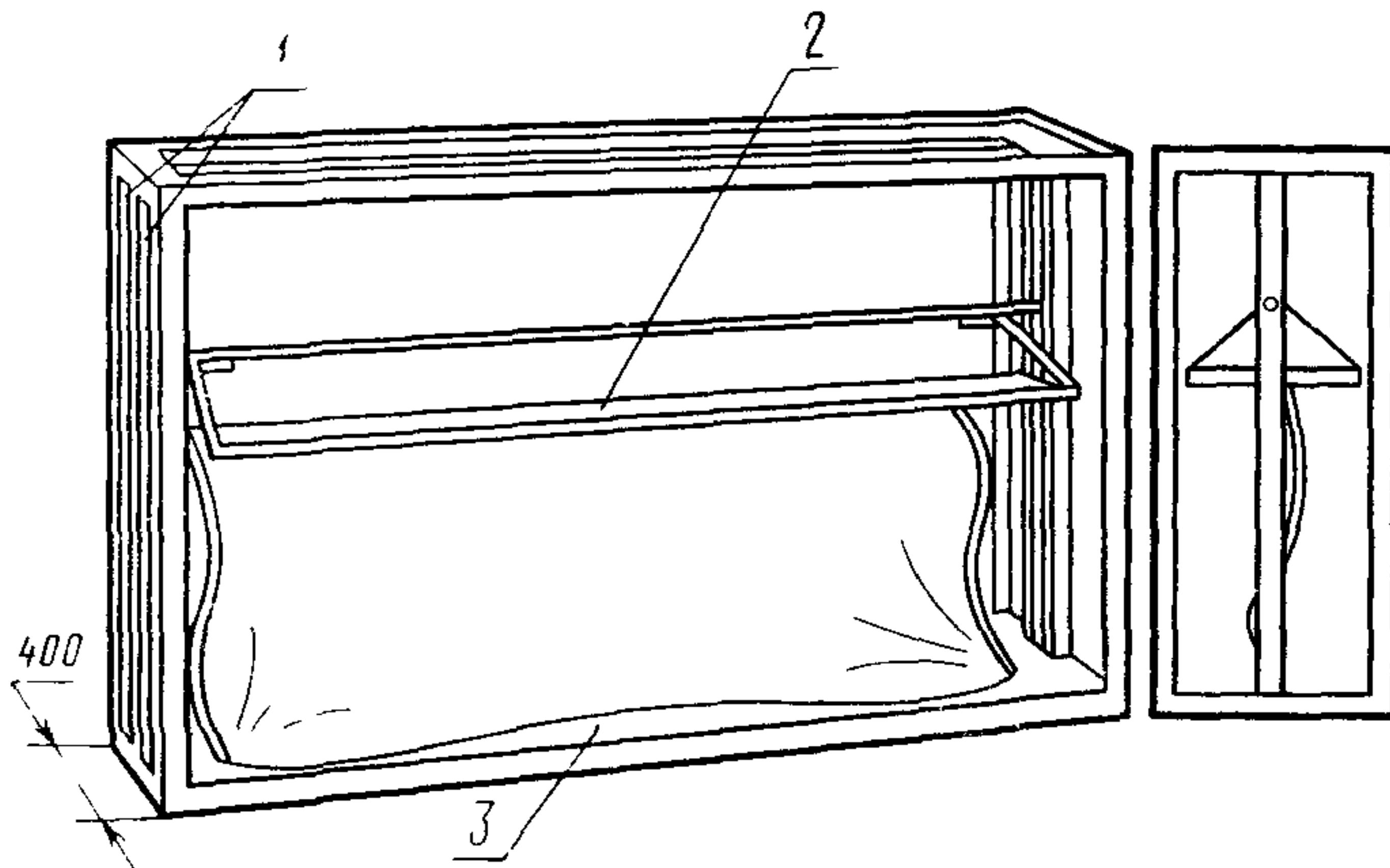
Размеры аппарата должны обеспечивать свободную (без складок) подвеску одеяла за его более длинный бок
