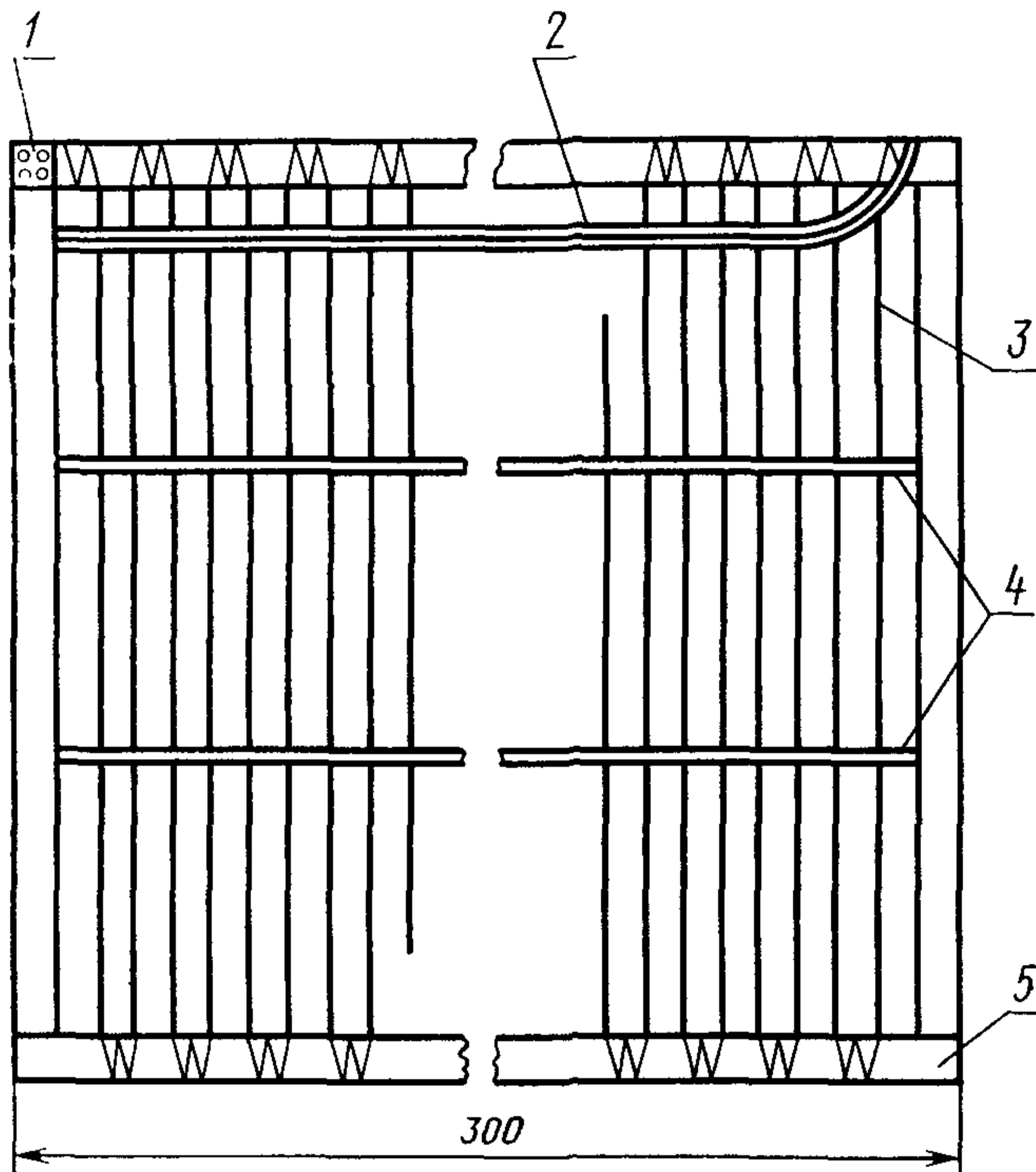
1—зажимная табличка, 2—изолированный провод, 3—проводка сопротивления (с высоким температурным коэффициентом) диаметром 0,3 мм, проложенная в промежутках, через каждые 10 мм, 4—изоляционные поддерживающие планки, 5—изолированная металлическая рамка 12×2 мм
