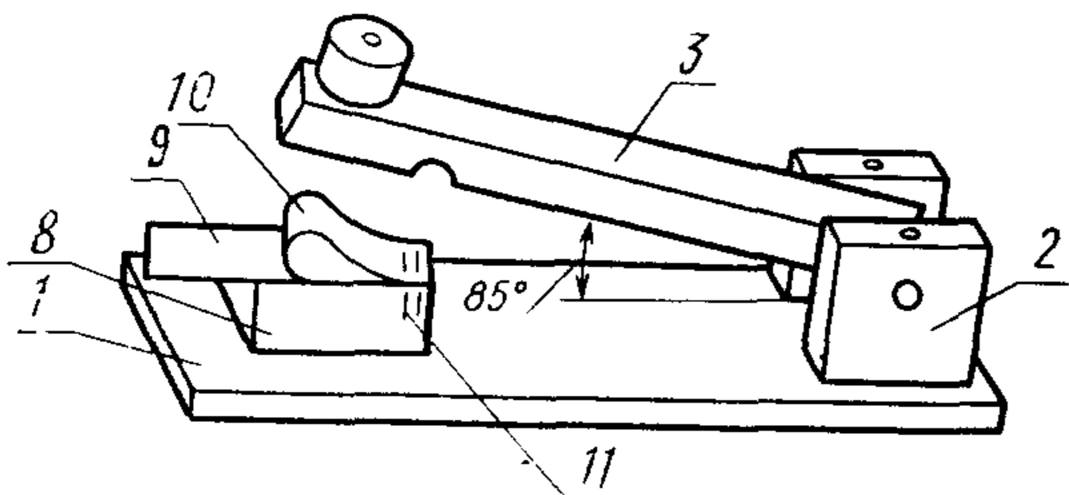
1—основание; 2—суппорт плеча; 3—плечо; 4—свободно посаженная ось; 5—смазочное отверстие; 6—уплотнение; 7—отверстие для установочного винта; 8—пятка; 9—картон, 10—образец, свободно свернутый (без морщин); 11—две сшивки
