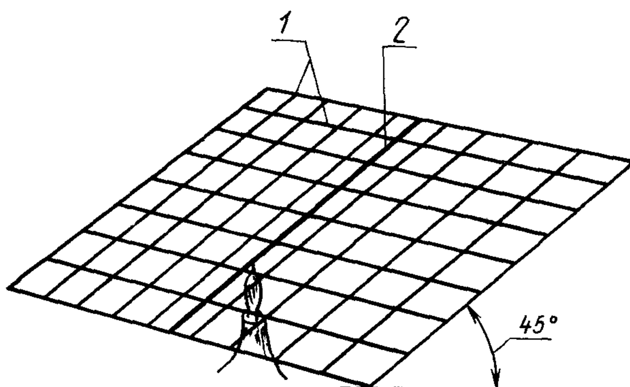
1—сетка из проволоки; 2—испытуемый образец
