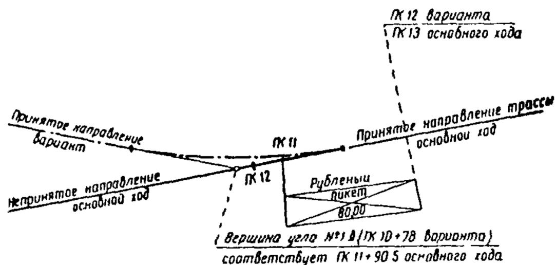
Рис. 23. Схема примыкания варианта
