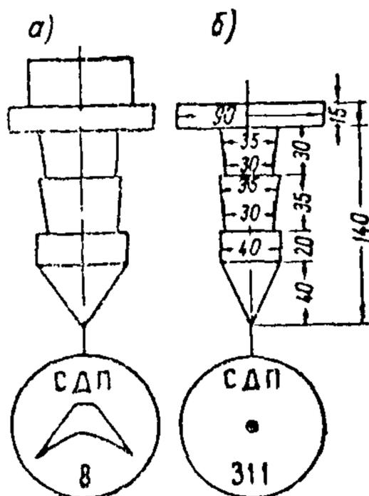
Рис. 15. Стенной нивелирный репер: а — репер; б — марка
