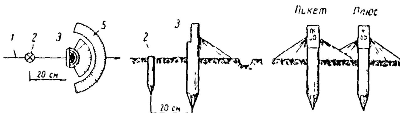
Рис 9 Закрепление пикетажа
