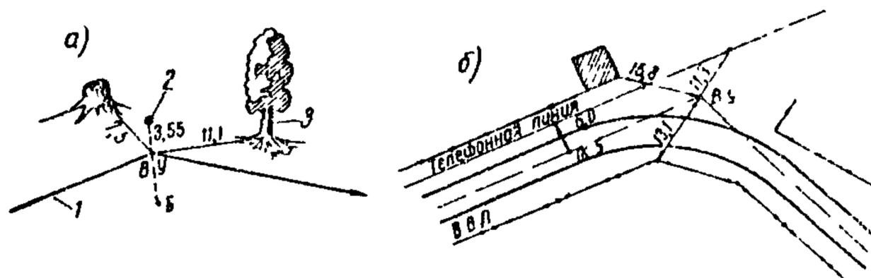
Рис. 18. Пример привязки к постоянным предметам:
