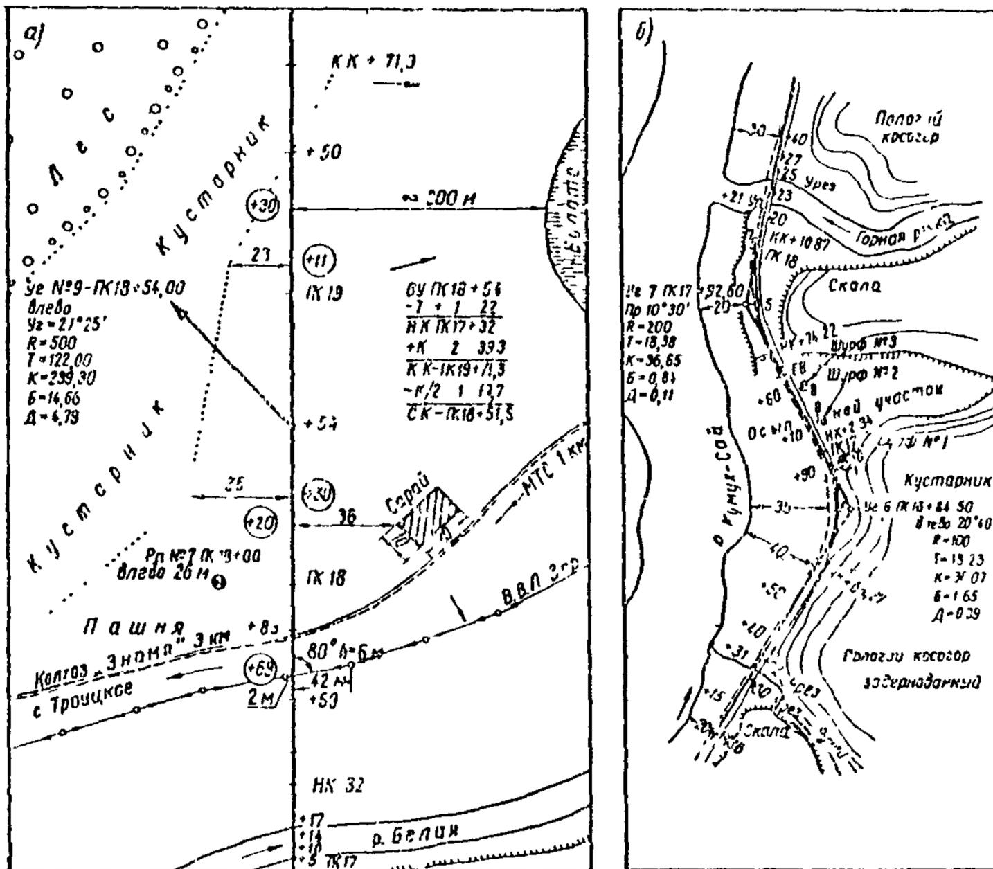
Рис. 24 Образец заполнения страницы пикетажного журнала:
