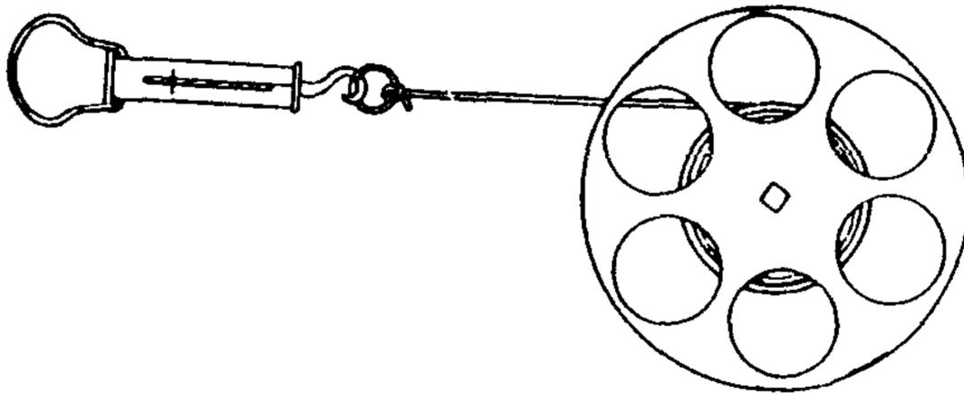
Рис. 28. Мерный прибор проволочного типа
