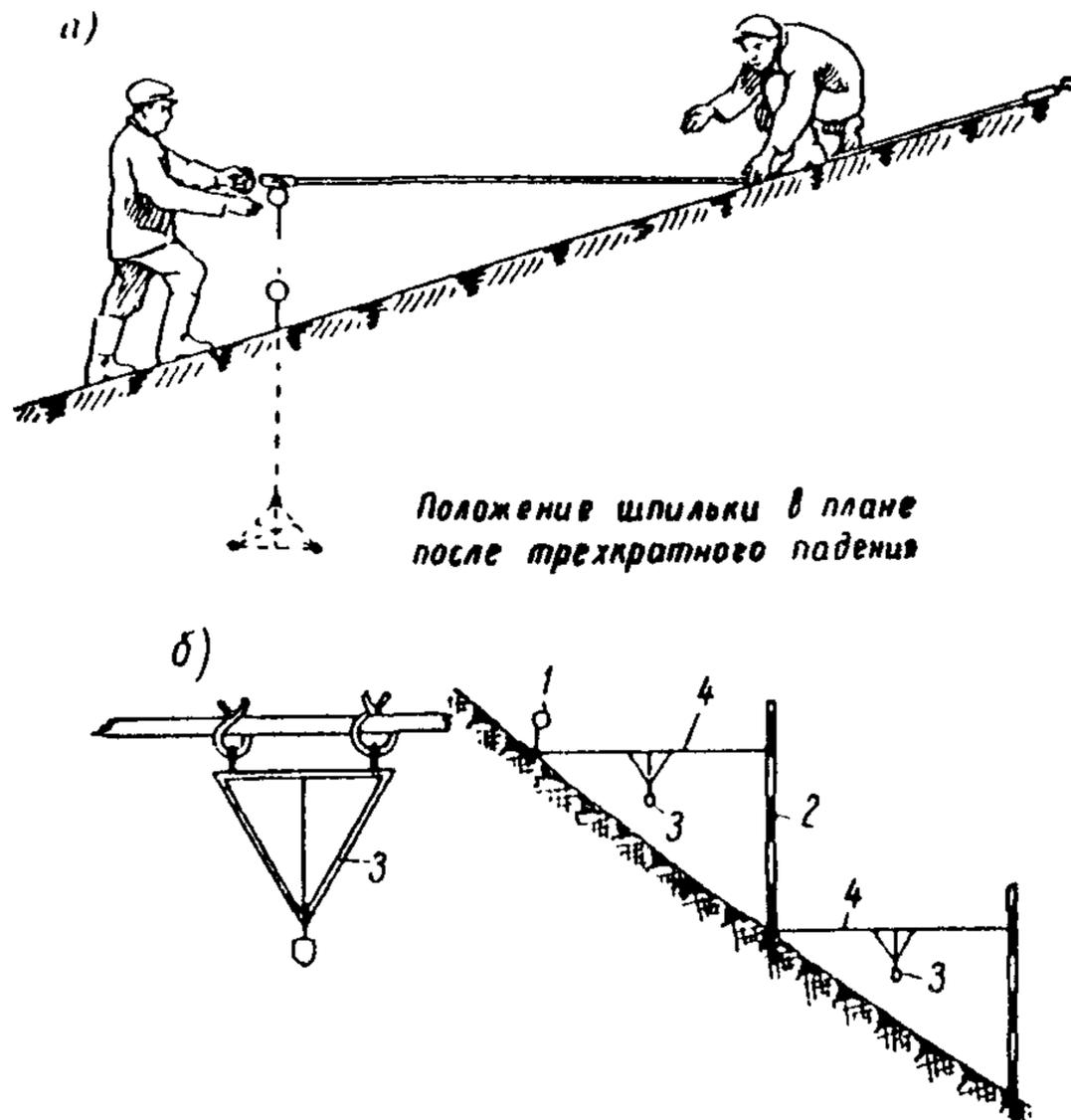
Рис. 6. Схема измерения линий горизонтальными участками:
