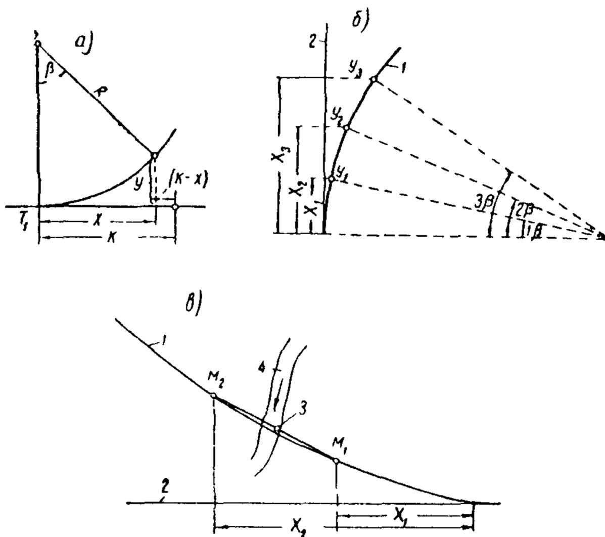
Рис. 22. Схема выноски точек на кривую:  $a$  и  $b$  — выноска пикетных точек с касательной на кривую методом ординат;  $v$  — фиксирование характерных точек на кривой:
