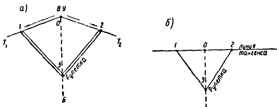
Рис. 21. Разбивка направлений с помощью рулетки:
