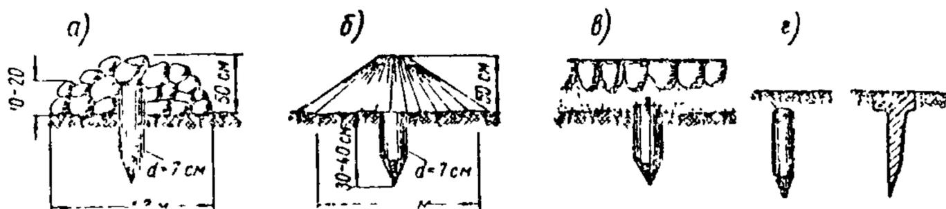
Рис. 13. Закрепление трассы в безлесной или обжитой местности:
