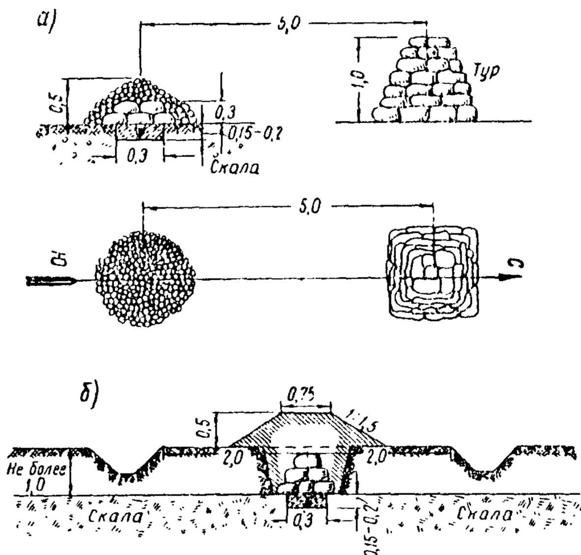
Рис. 16. Марка, закладываемая в скалу горизонтального залегания:
