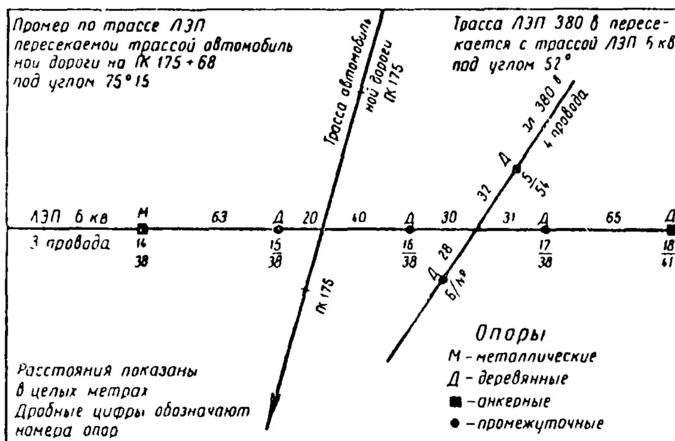
Рис. 25. Промер по трассе ЛЭП (образец заполнения журнала)
