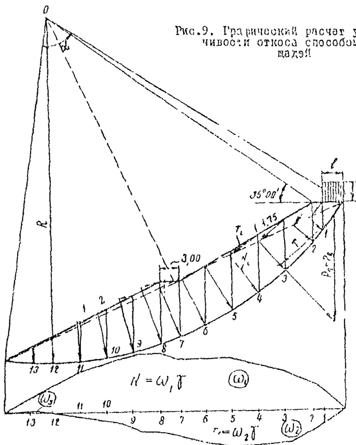
Рис. 9. Графический расчет устойчивости откоса способом площадей
