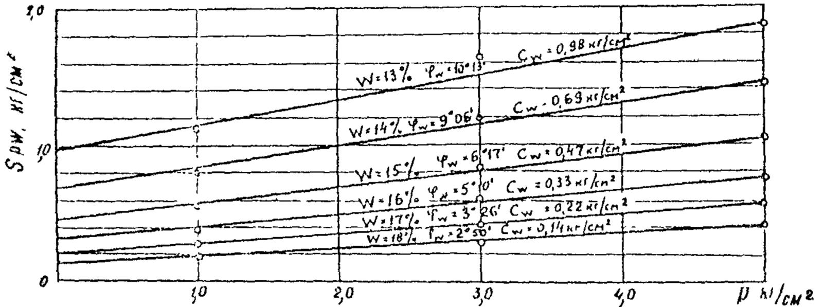
Рис.23. Зависимость сопротивляемости грунта сдвигу от нагрузки при различных влажностях
