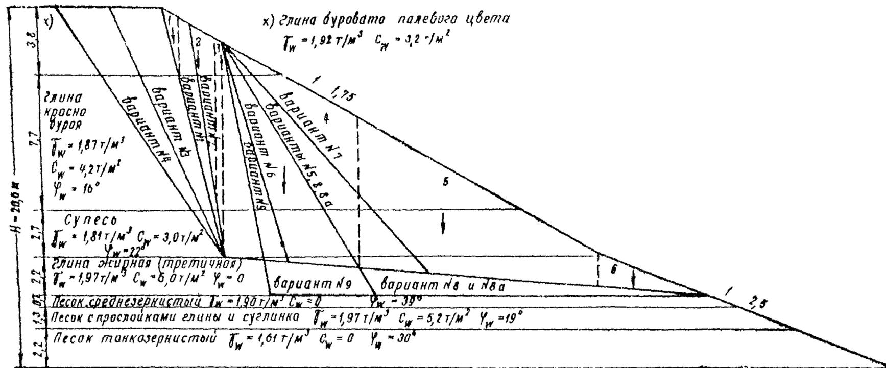
Рис. 3. Схема к расчету устойчивости откоса выемки по методу горизонтальных сил (Маслова-Берера)
