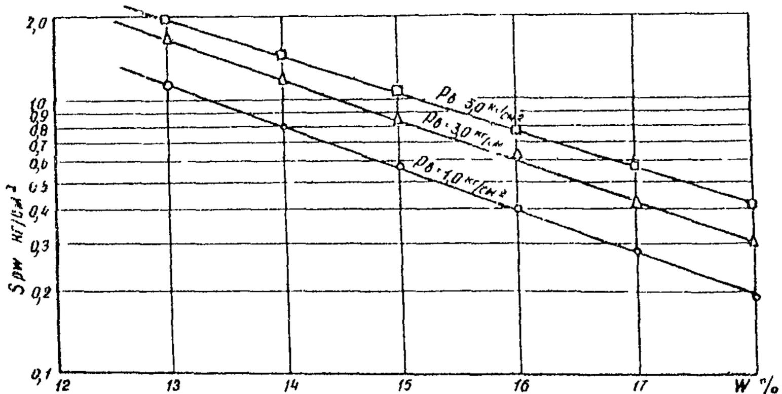
Рис. 25. Зависимость сопротивляемости грунта сдвигу от влажности при различных нагрузках (в полулогарифмическом масштабе)
