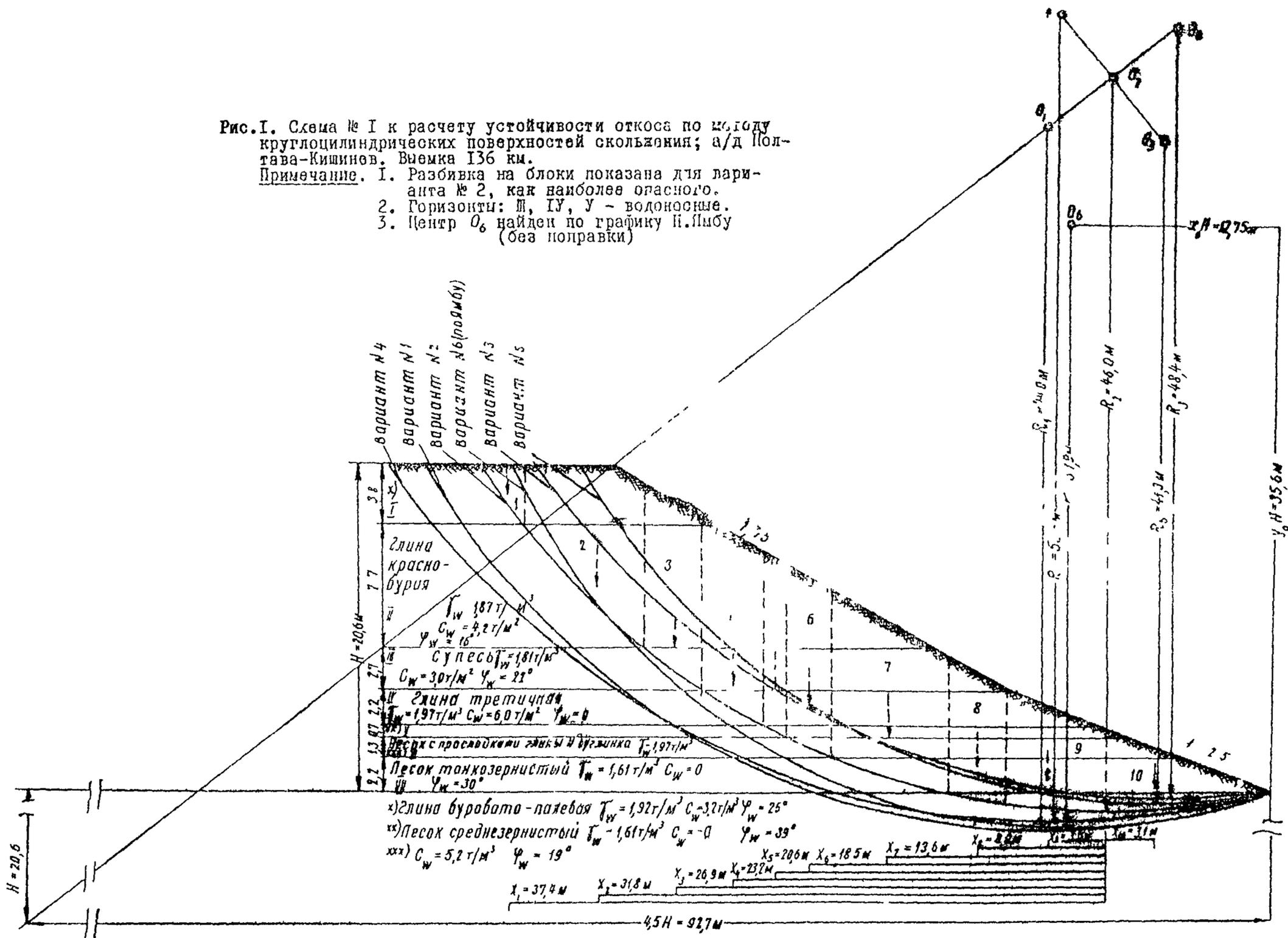
Рис. 2. Схема к расчету устойчивости откоса выемки по методу круглоцилиндрических поверхностей скольжения с применением графика Ямбу
