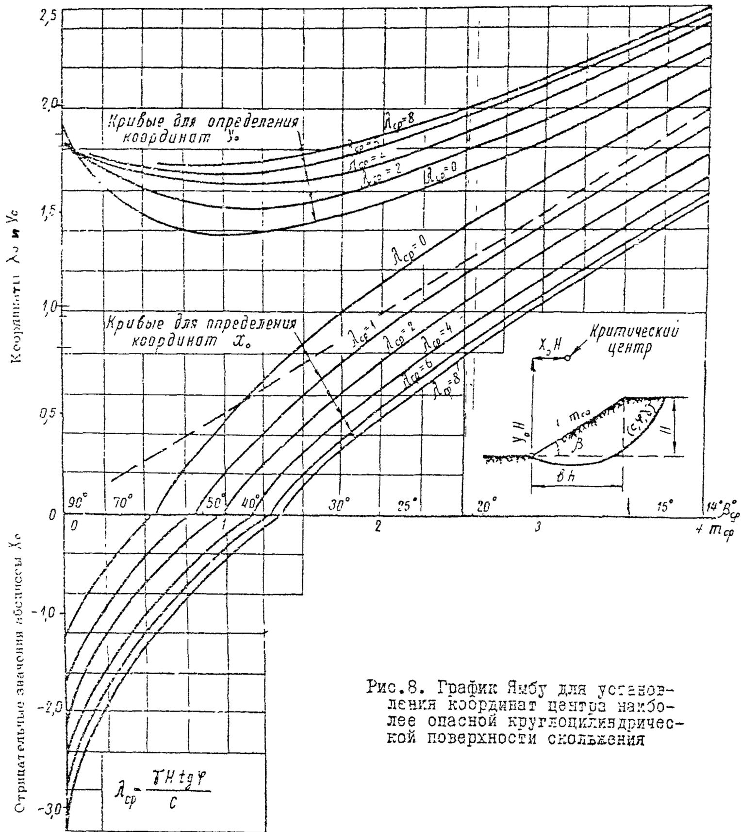
Рис. 8. График Ямбу для установления координат центра наиболее опасной круглоцилиндрической поверхности скольжения
