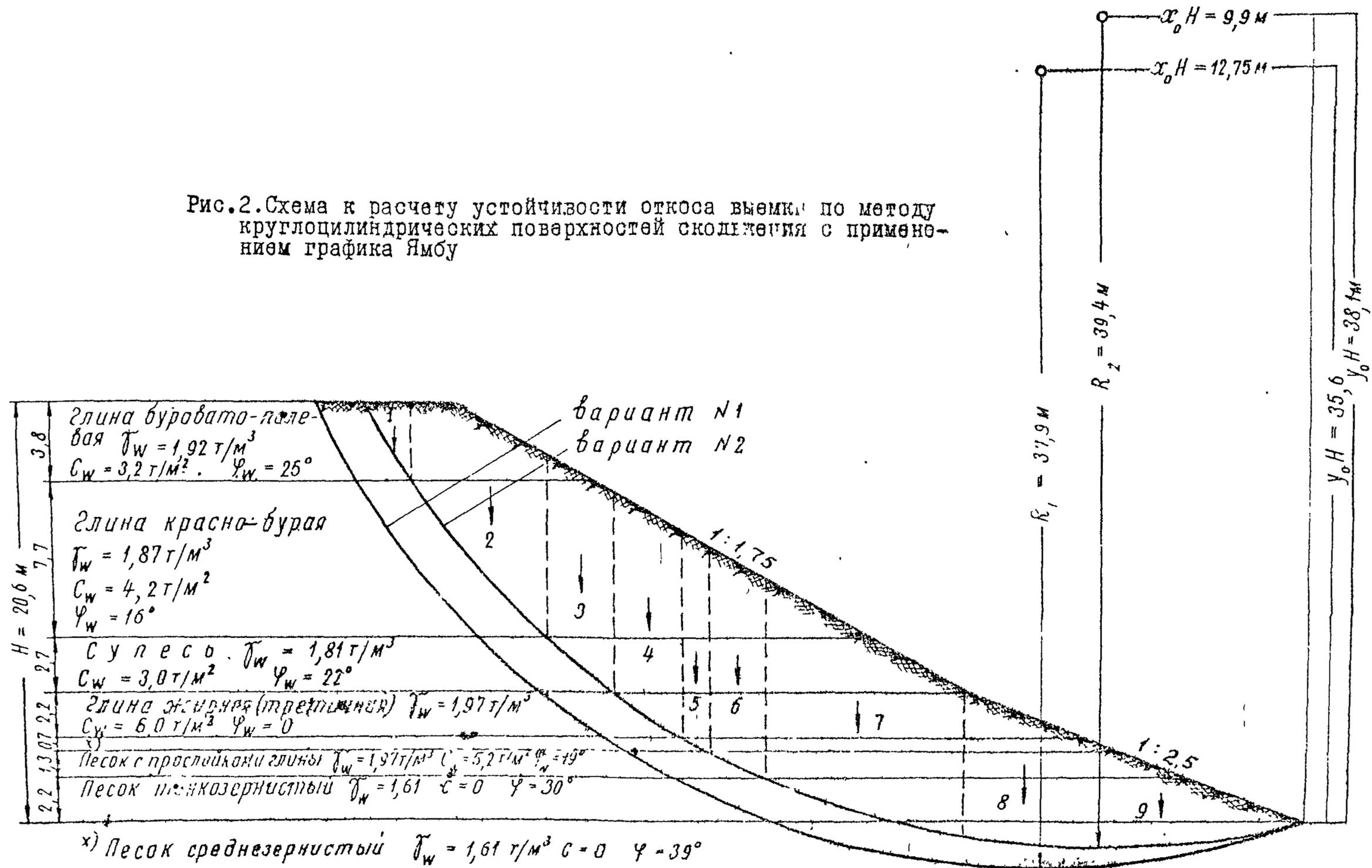
Процесс отнесения центра критической дуги скольжения, для откоса в п. 27, значительно упрощается при использовании графика Ямбу.
