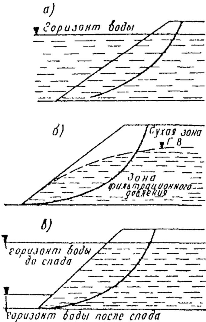
Рис. 19. Расчетные схемы при учете силового воздействия воды:
