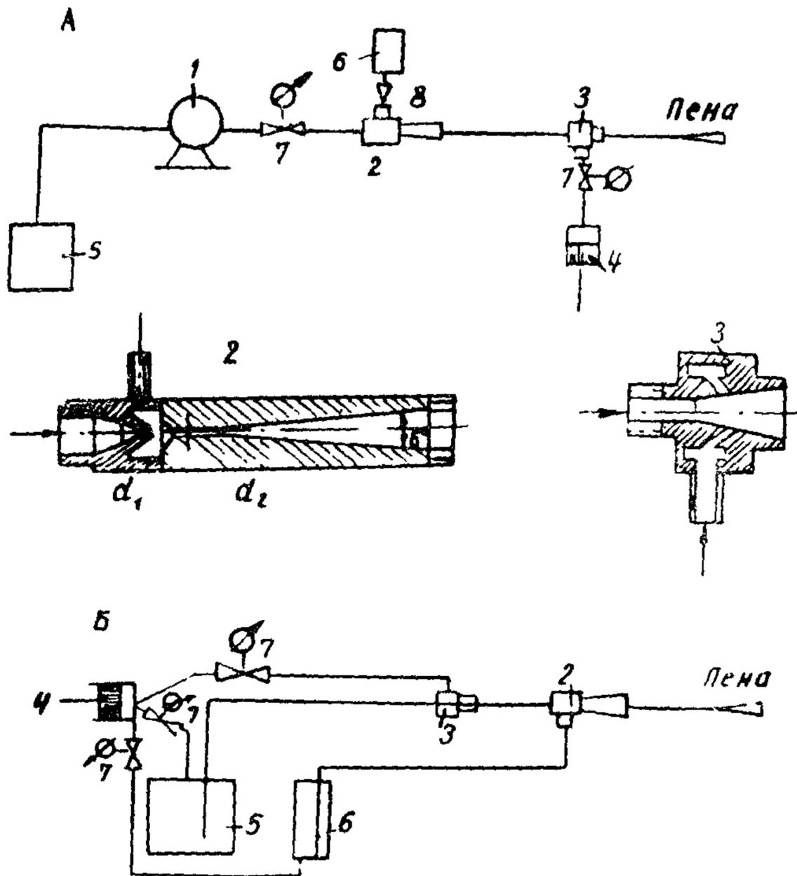
Рис.3.2. Основные схемы (А,Б) эжекционных пеногенераторов:
