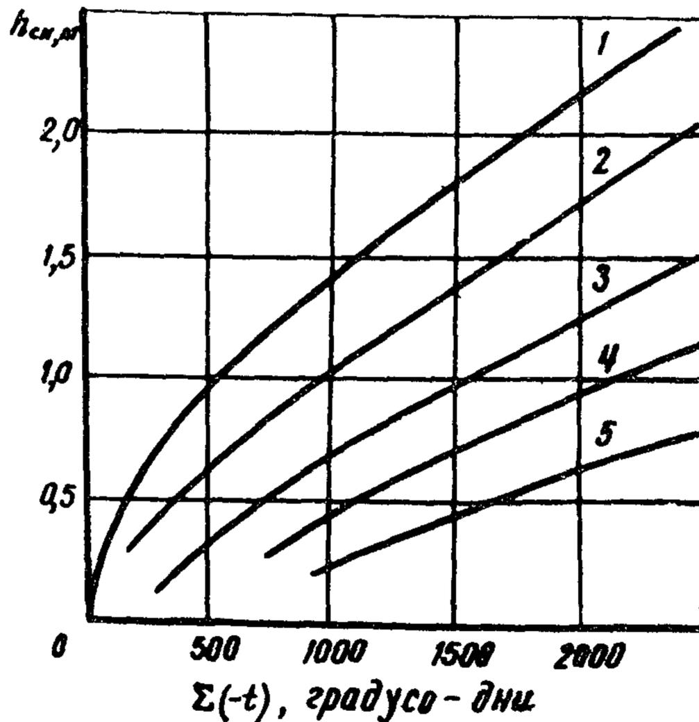
Рис.5.5. Глубина промерзания грунта без утепления (1) и под снегом или пенольдом при толщине слоя 0,2м(2); 0,2-0,4м(3); 0,4-0,6м(4); более 0,6м(5)
