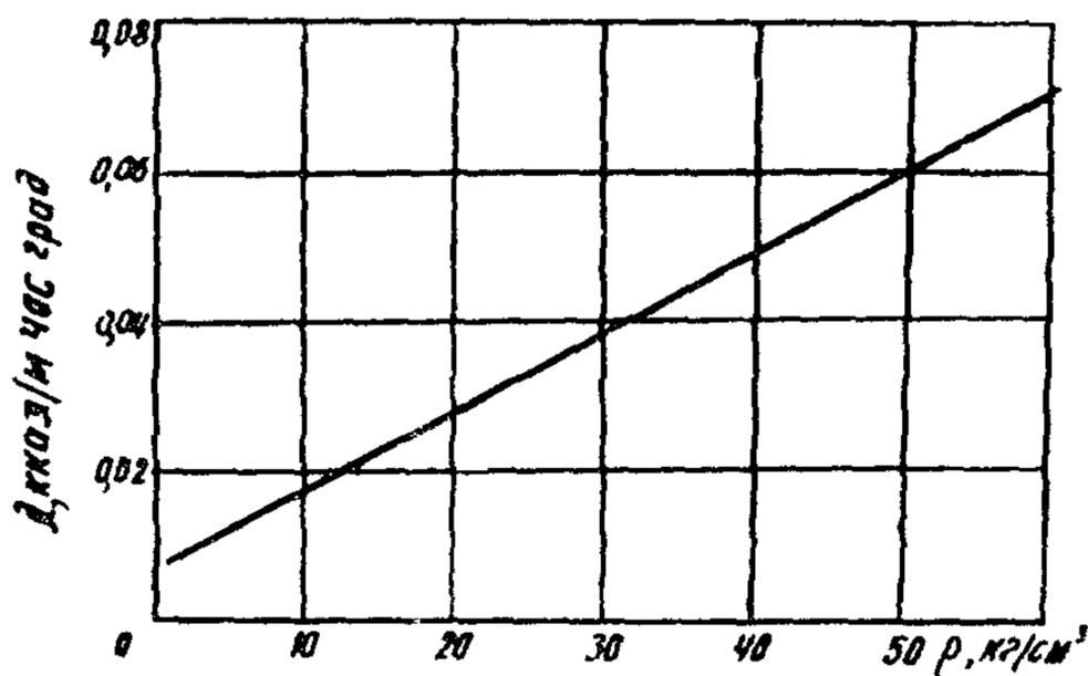
Рис.5.3. Зависимость коэффициента теплопроводности от объемной массы БТП
