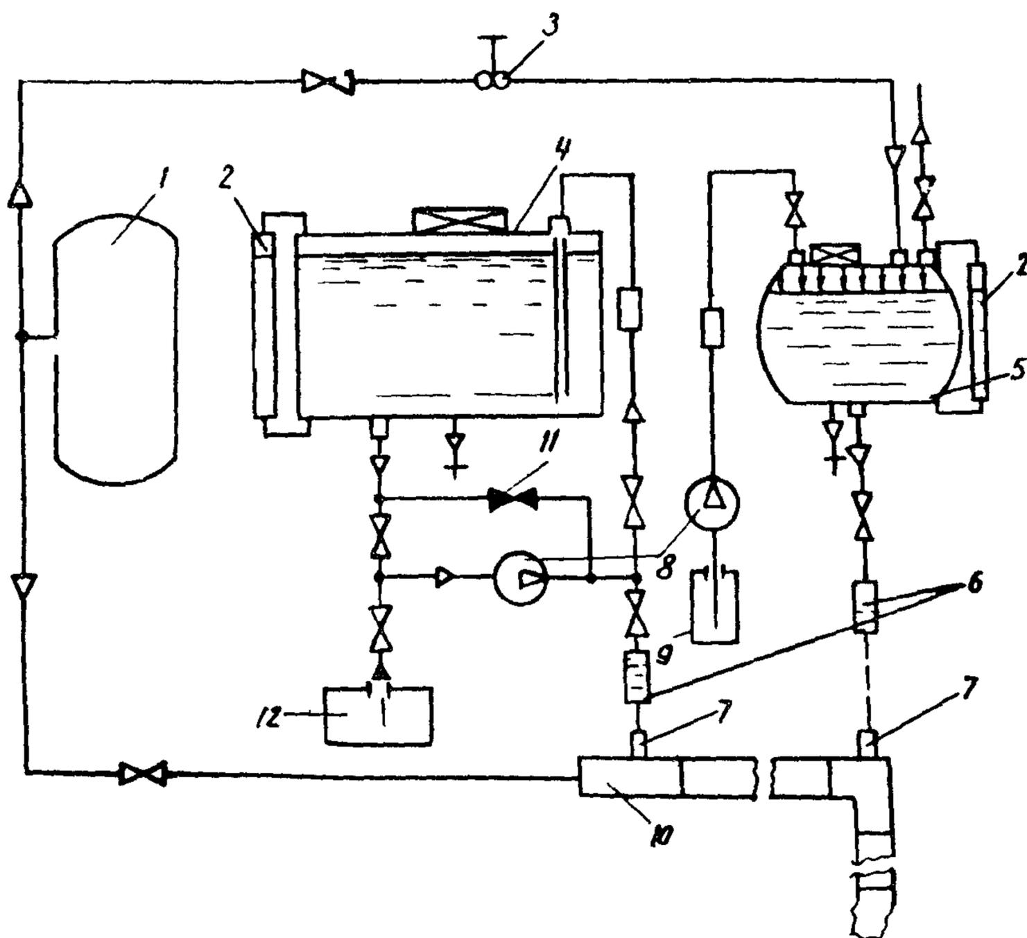
Рис 3 1. Схема пеногенерирующей установки СибНИИГиМа :
