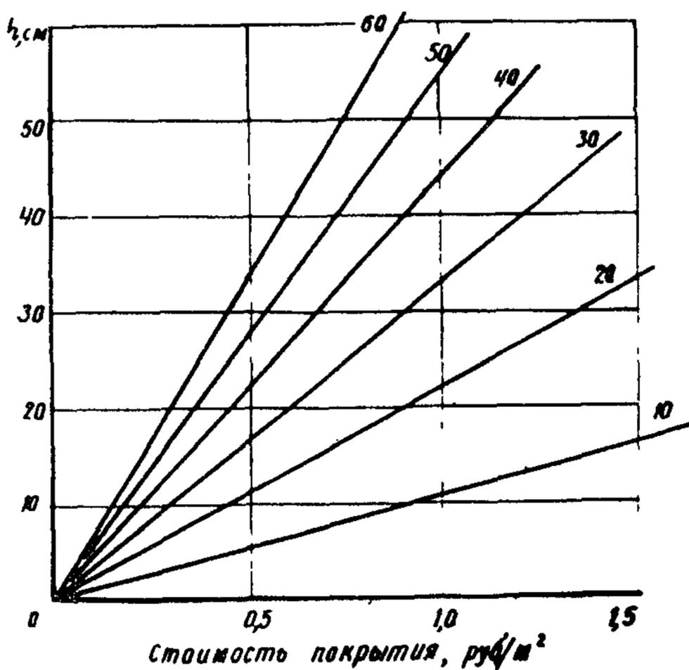
Рис.6.1. Зависимость стоимости пенопласта от толщины слоя и кратности пены (цифры на кривых — кратность пены)
