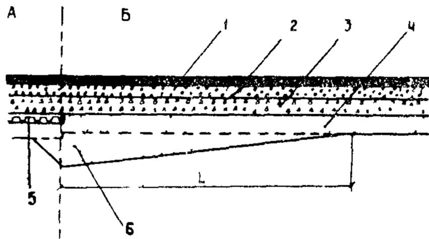
Рис.2. Сопряжение участков ( $\ell_A = 0$ ;  $\ell_B = m$ ) с помощью клиновидной конструкции из морозозащитного материала: 1-асфальтобетон I марки; 2-то же, III-IV марок; 3-щебень; 4-песок; 5-пенопласт; 6-клиновидная конструкция
