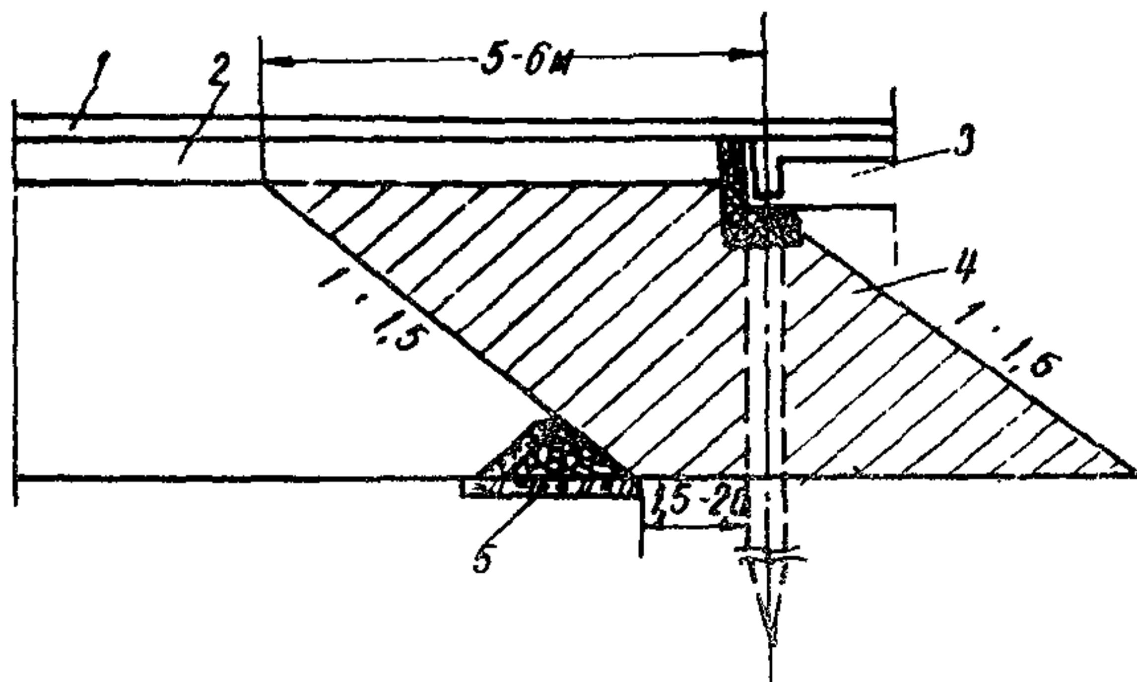
Рис.1. Конструкция земляного полотна на подходе к мосту и конусам, возводимых из цементогрунта при высоте насыпи до 3м:
