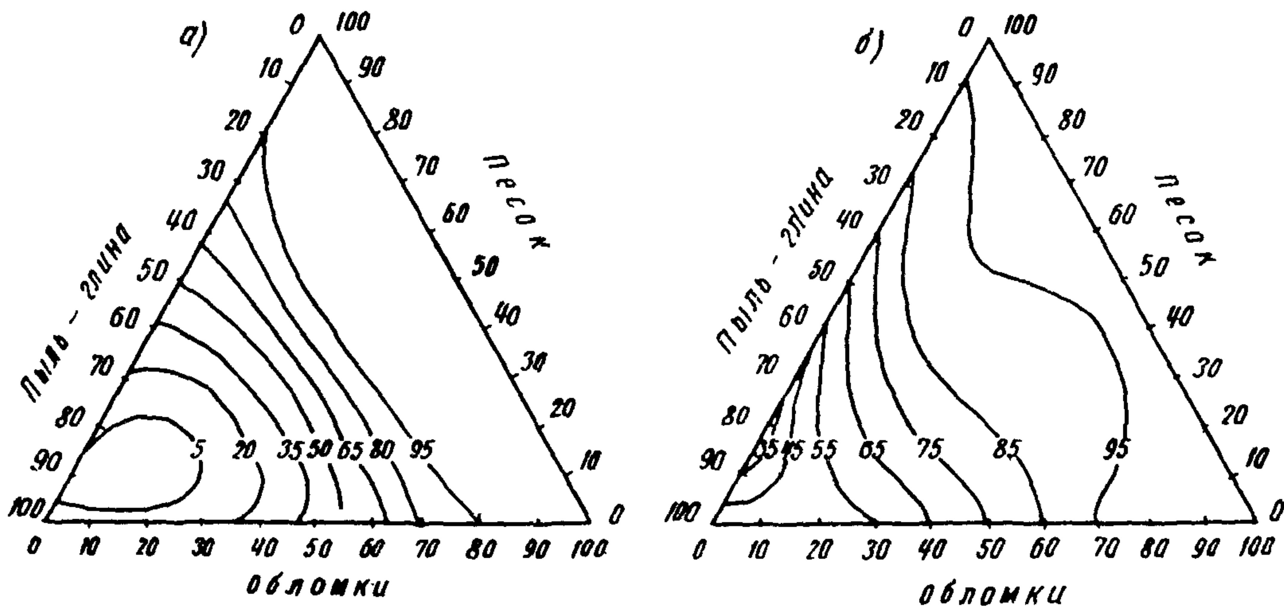
**Рис. 2. Коэффициент сдвигостойчивости крупнообломочного грунта при различной консистенции глинистого мелкозема:**
