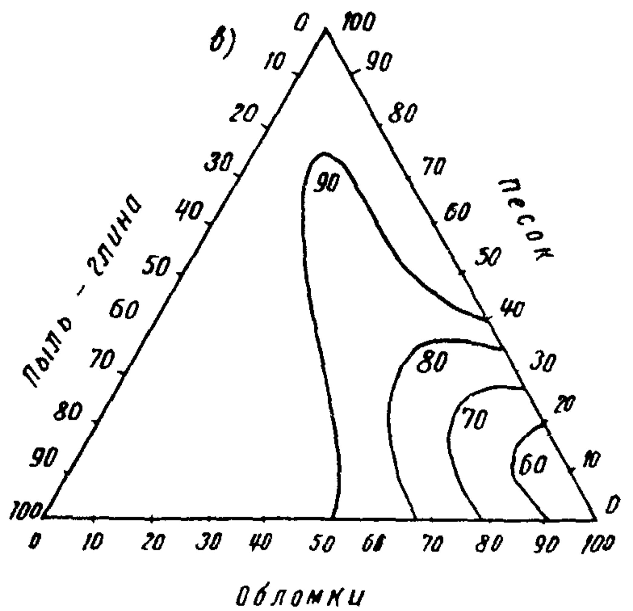
Рис. 4. Коэффициент сдвигостойчивости аргиллитовых крупнообломочных грунтов при различной консистенции глинистого заполнителя:
