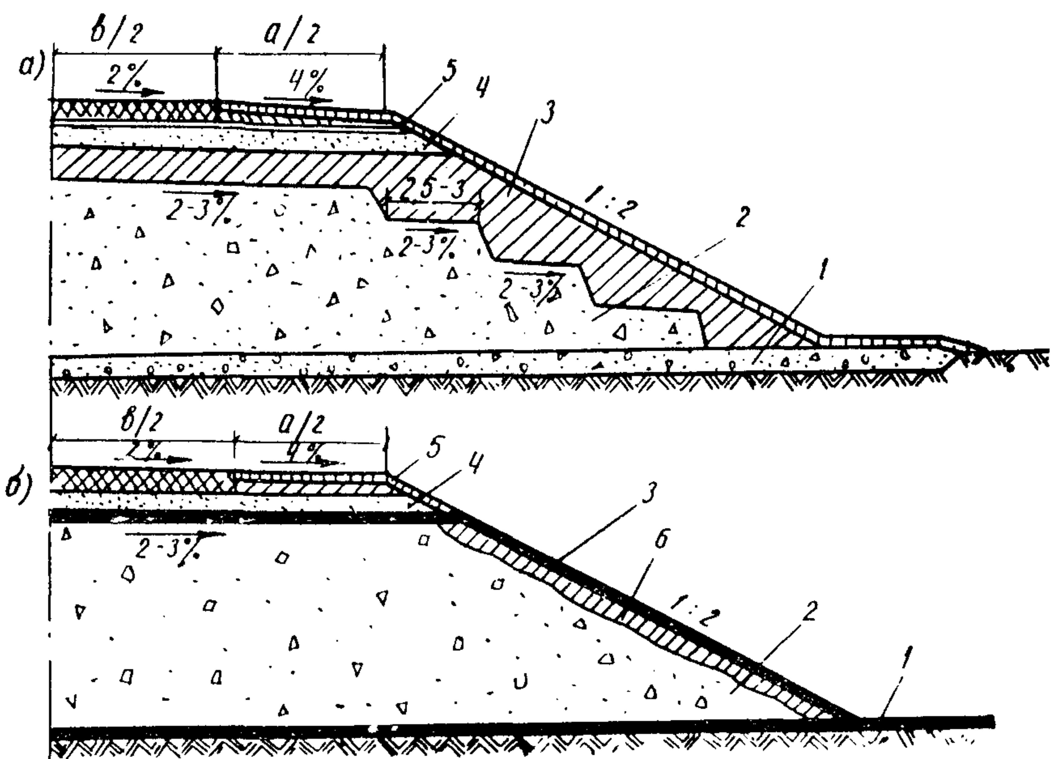
Рис. 7. Конструкция насыпи из аргиллитовых грунтов:
