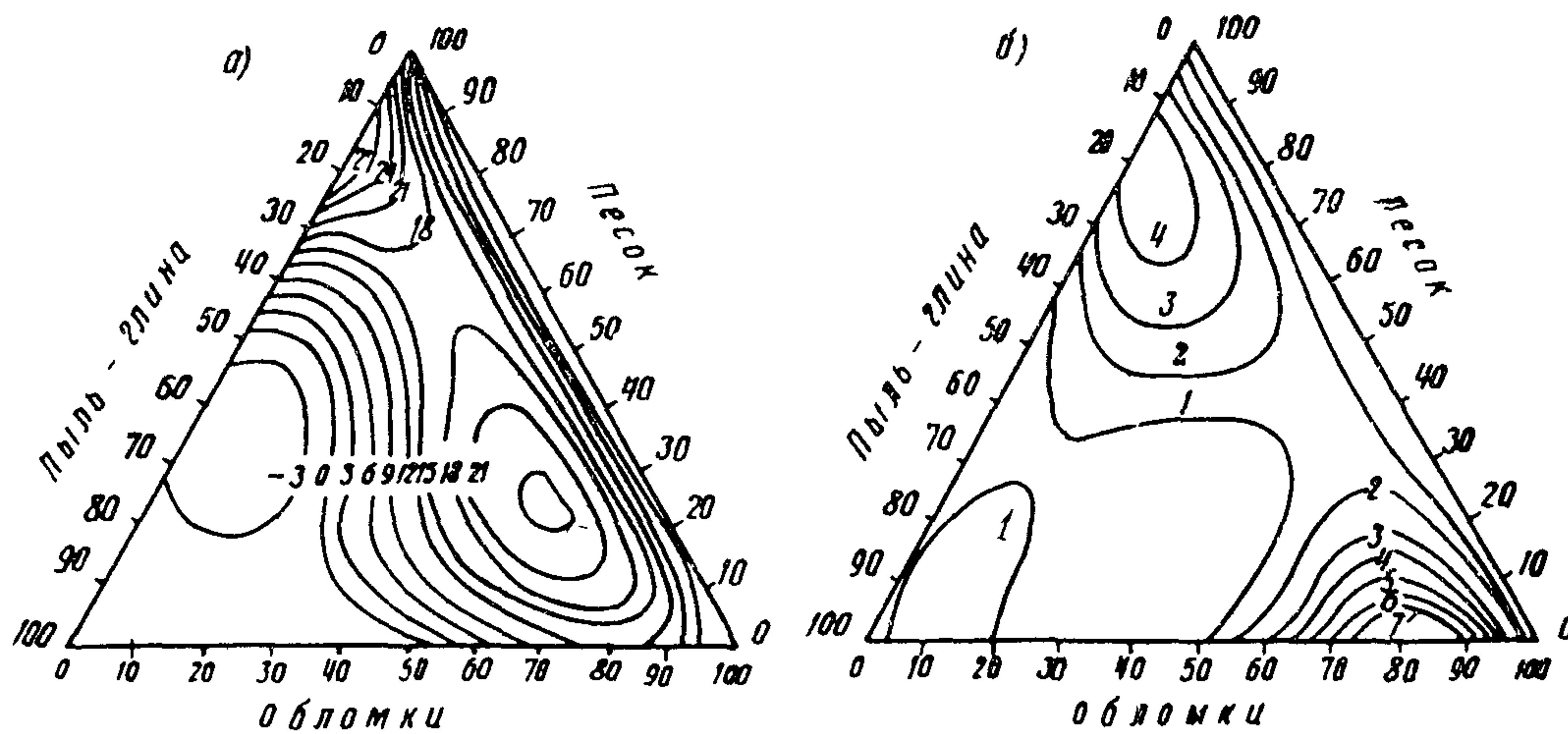
Рис. 3. Модуль просадки крупнообломочного грунта  $E_{sp}$  (мм/м) при различной консистенции глинистого мелкозема:
