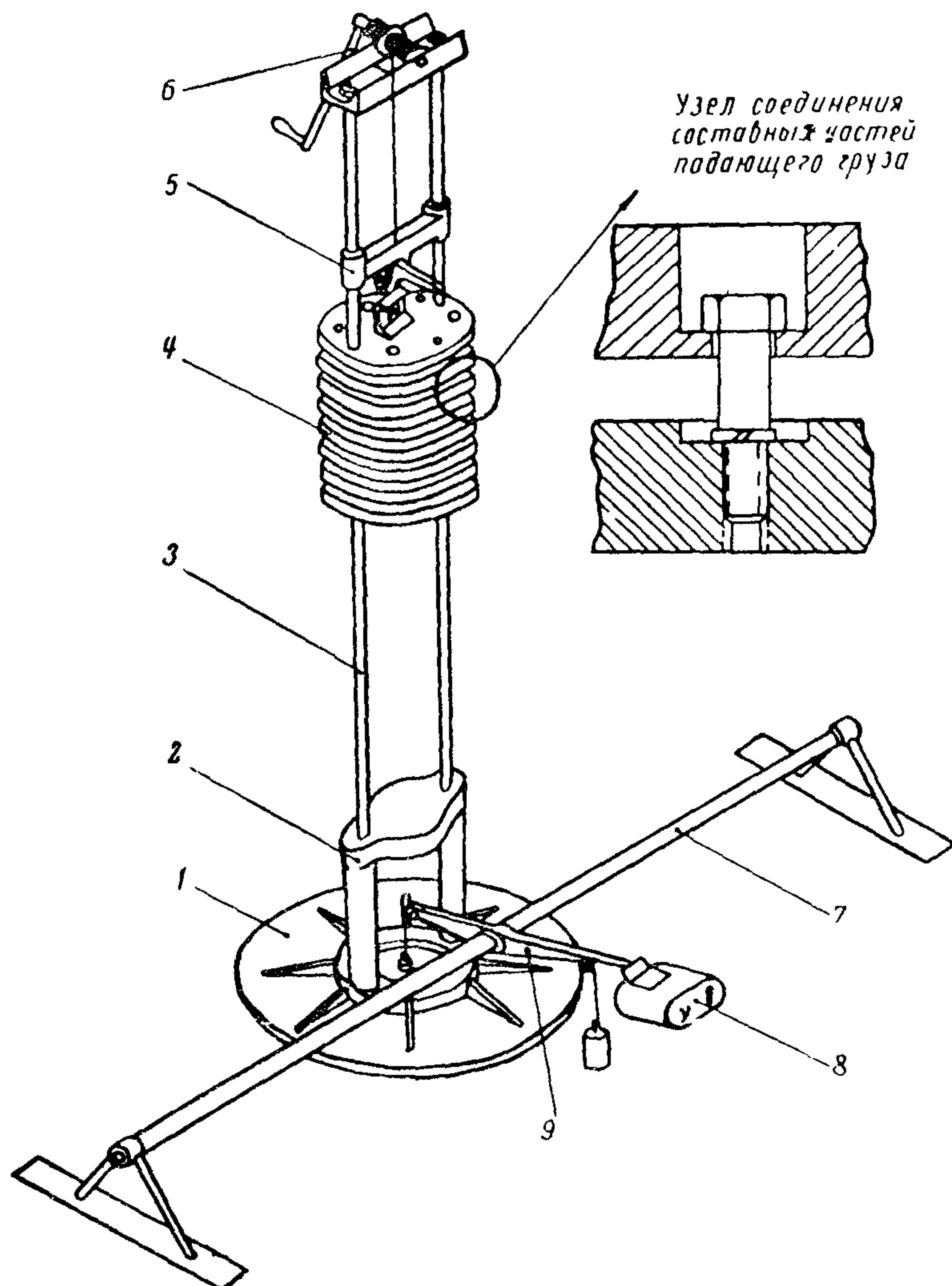
Рис. 9. Прибор для оценки степени уплотнения крупнообломочных грунтов:
