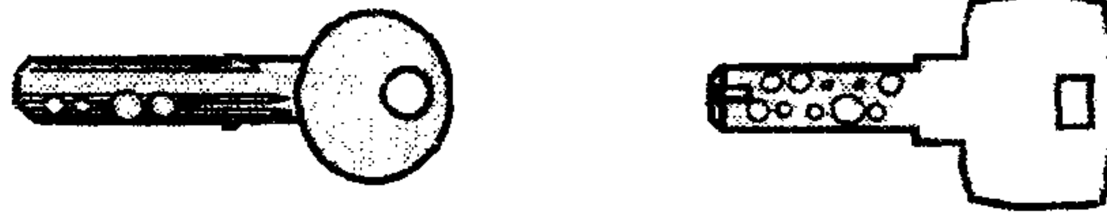
Рисунок 6 - Примеры ключей для штифтовых МС с "перфорацией": 1 - однорядного; 2 - двухрядного
