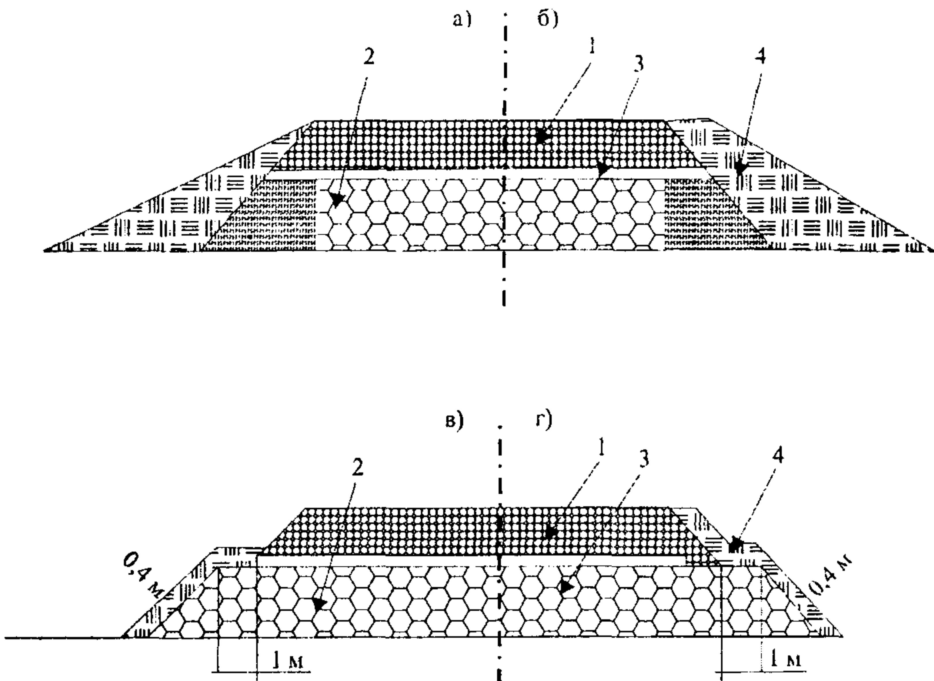
Примечание. Типы теплоизоляции откосов «а» – «г» могут применяться избирательно во всех конструкциях насыпи из мерзлоКомковатых грунтов.
