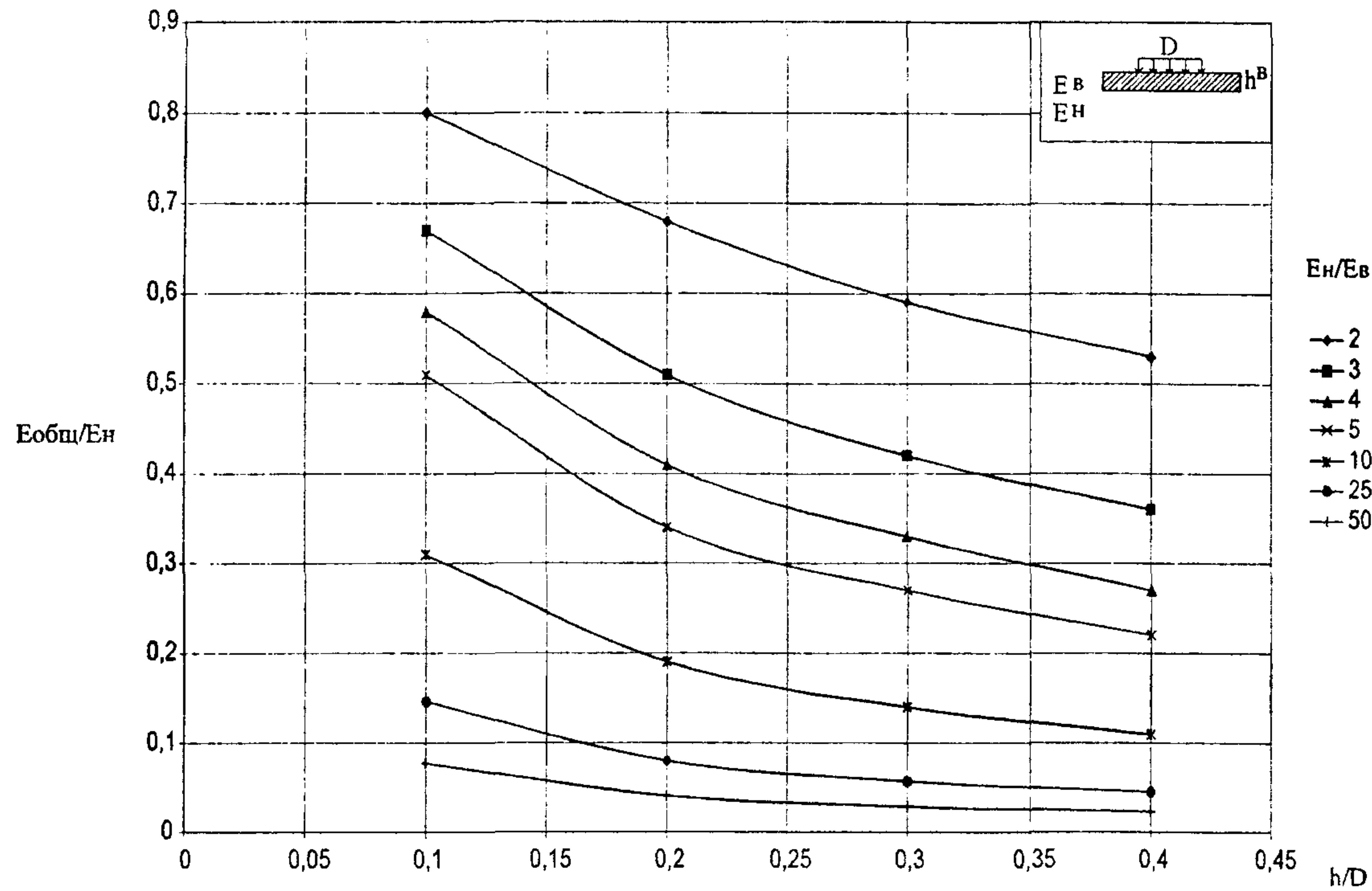
Рис. 6.2.1. Номограмма для расчета общего модуля  $E_{общ}$  двухслойной системы
