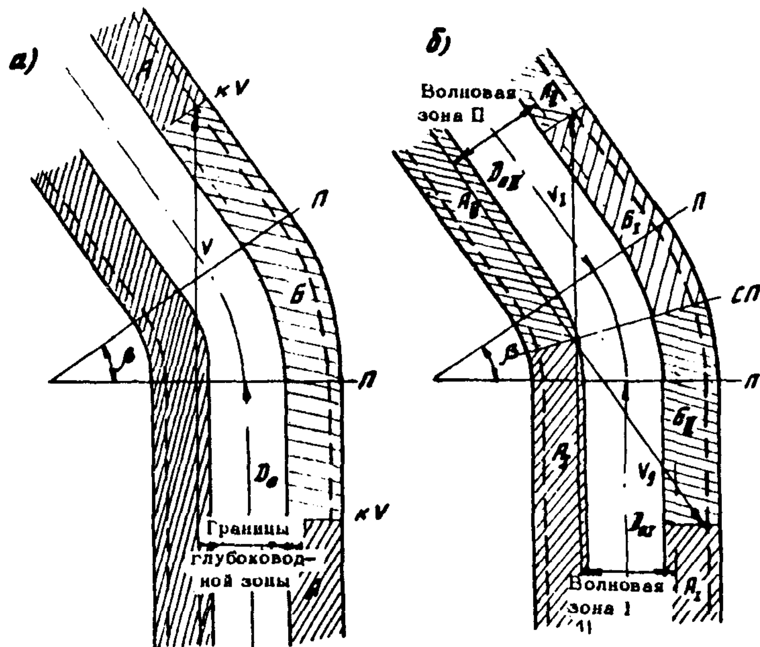
**Рис.2. Схема распределения зон крепления откосов канала:**
