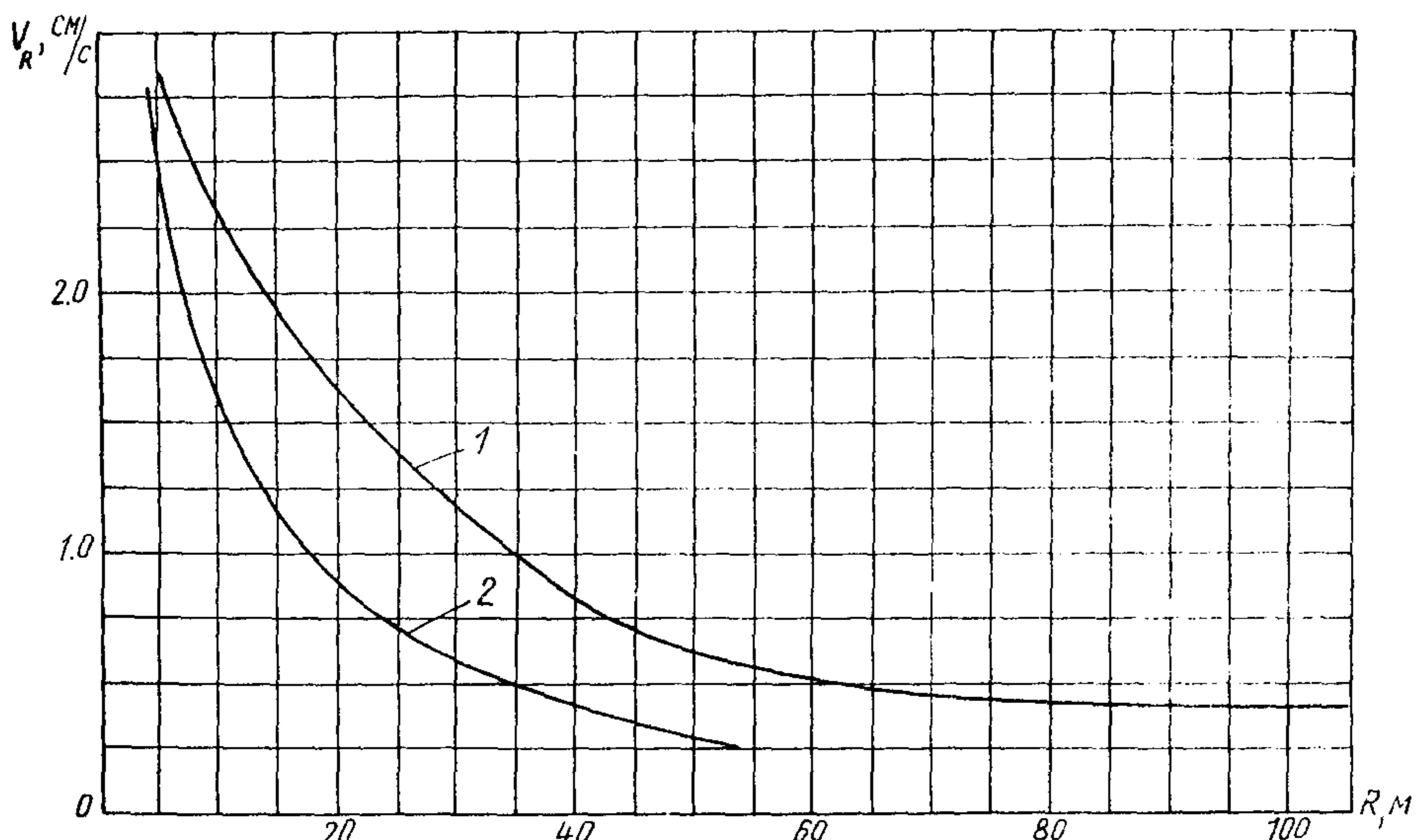
Зависимости максимальных амплитуд виброскорости колебаний поверхности грунта  $V_R$  от расстояния  $R$  до погружаемых свай или шпунта: 1 - при погружении свай вибропогружателями мощностью 60-200 кВт при частоте 5-9 Гц; 2 - при погружении свай или шпунта вибропогружателями мощностью до 60 кВт при частоте 5-25 Гц
