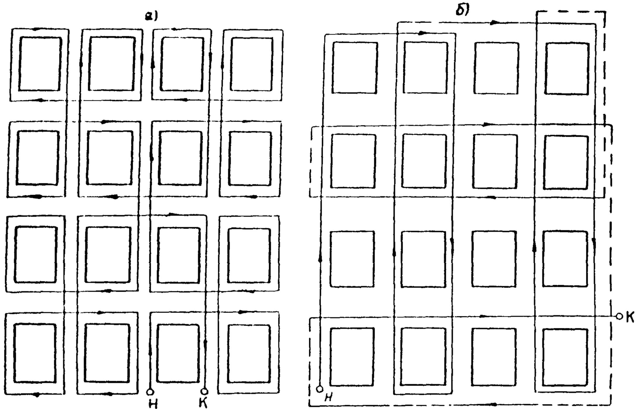
Рис. 2. Пример маршрута сбора ТБО с остановками для загрузки отходов:
