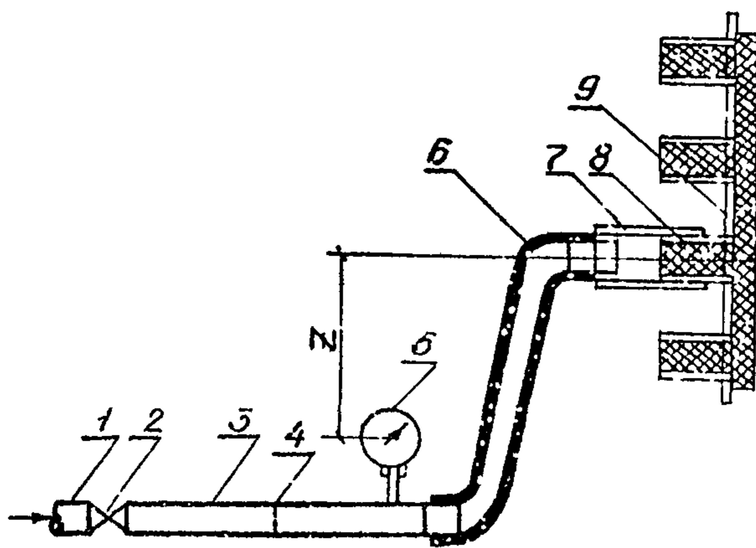
Рис. 2. Схема установки для контроля гидравлического сопротивления дренажных плит типа 4:
