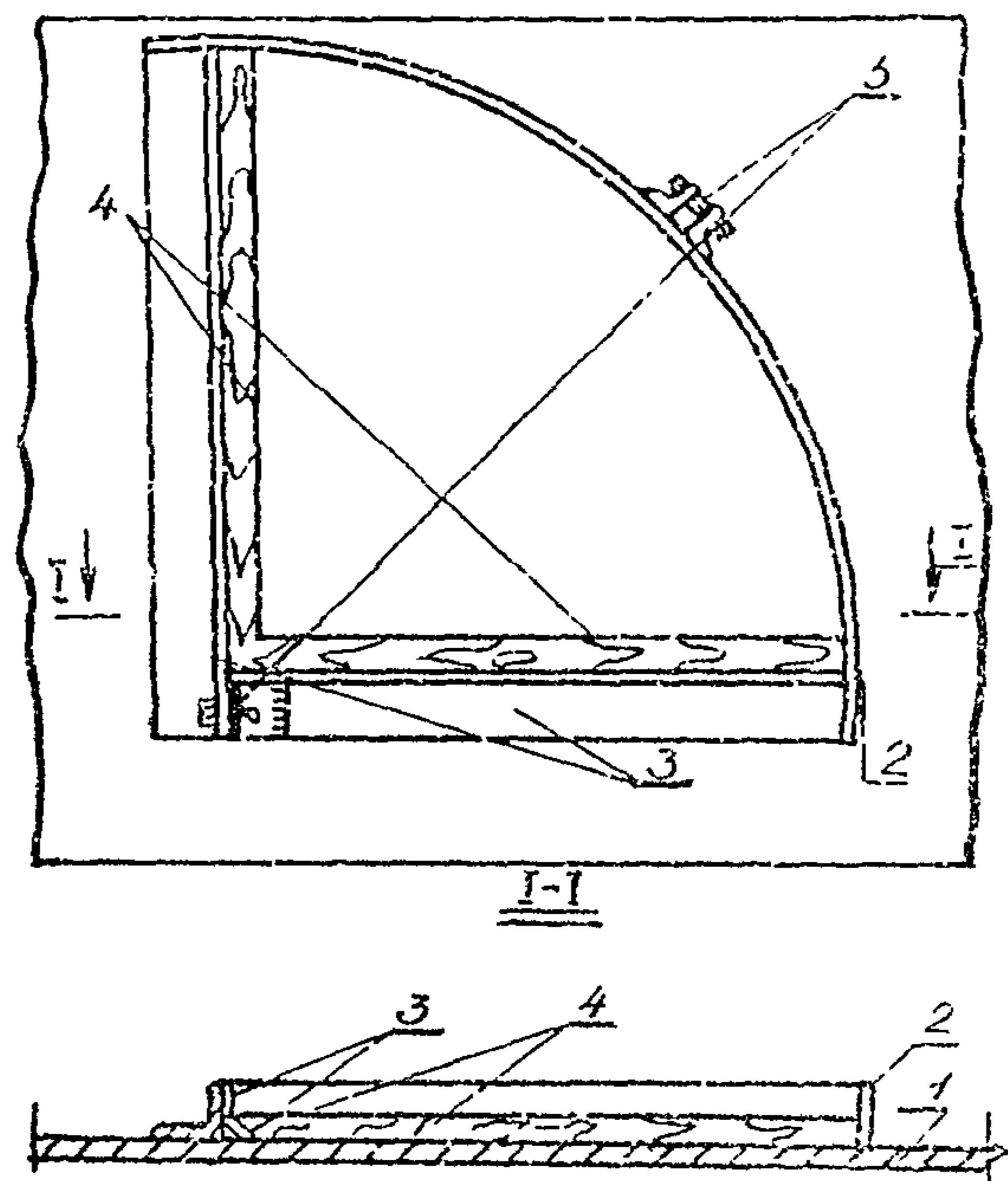
Рис. 7. Вариант формы для изготовления дренажных плит типа 3:
