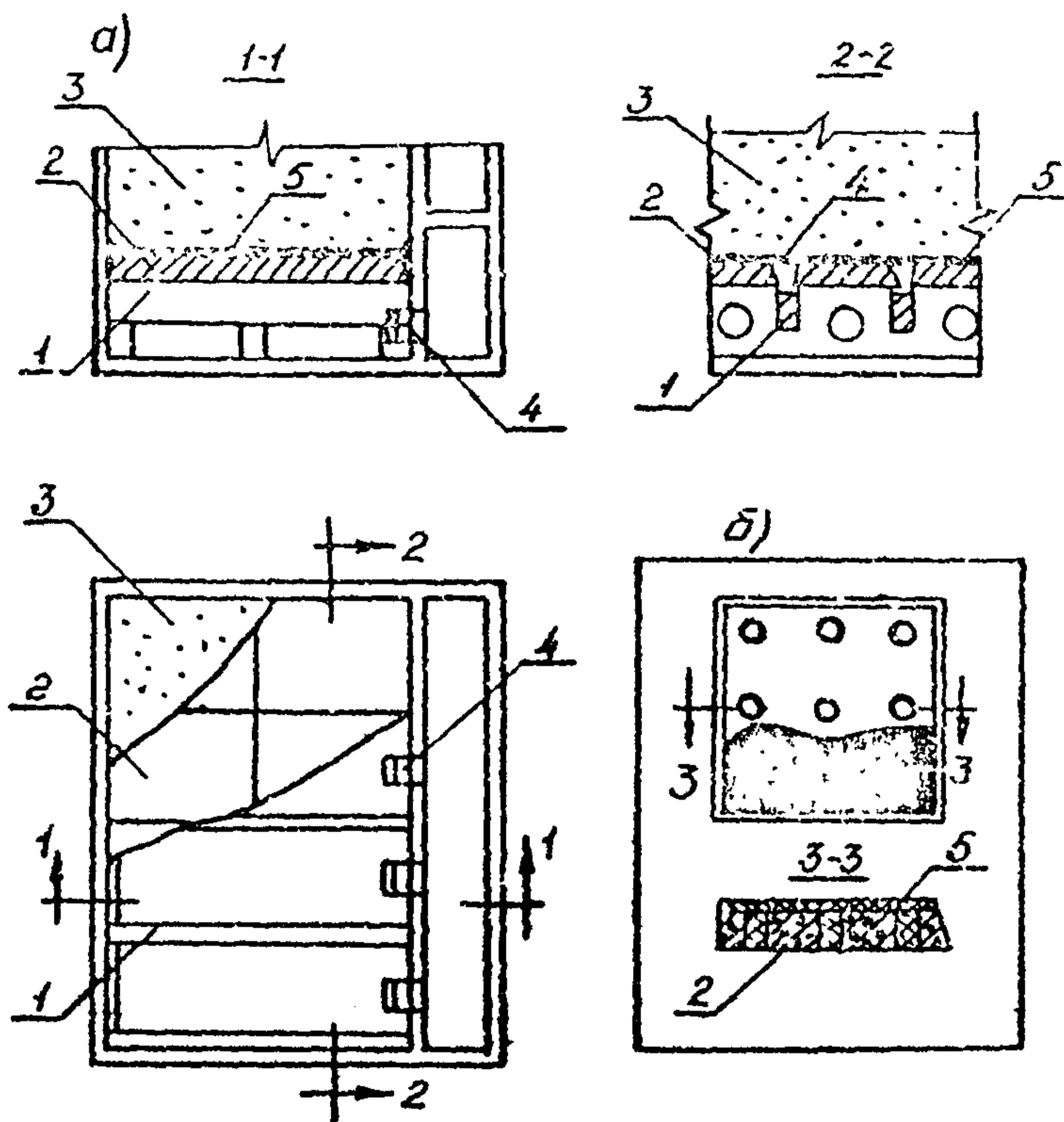
Рис. 2. Схема дренажа открытых фильтров (тип 2):
