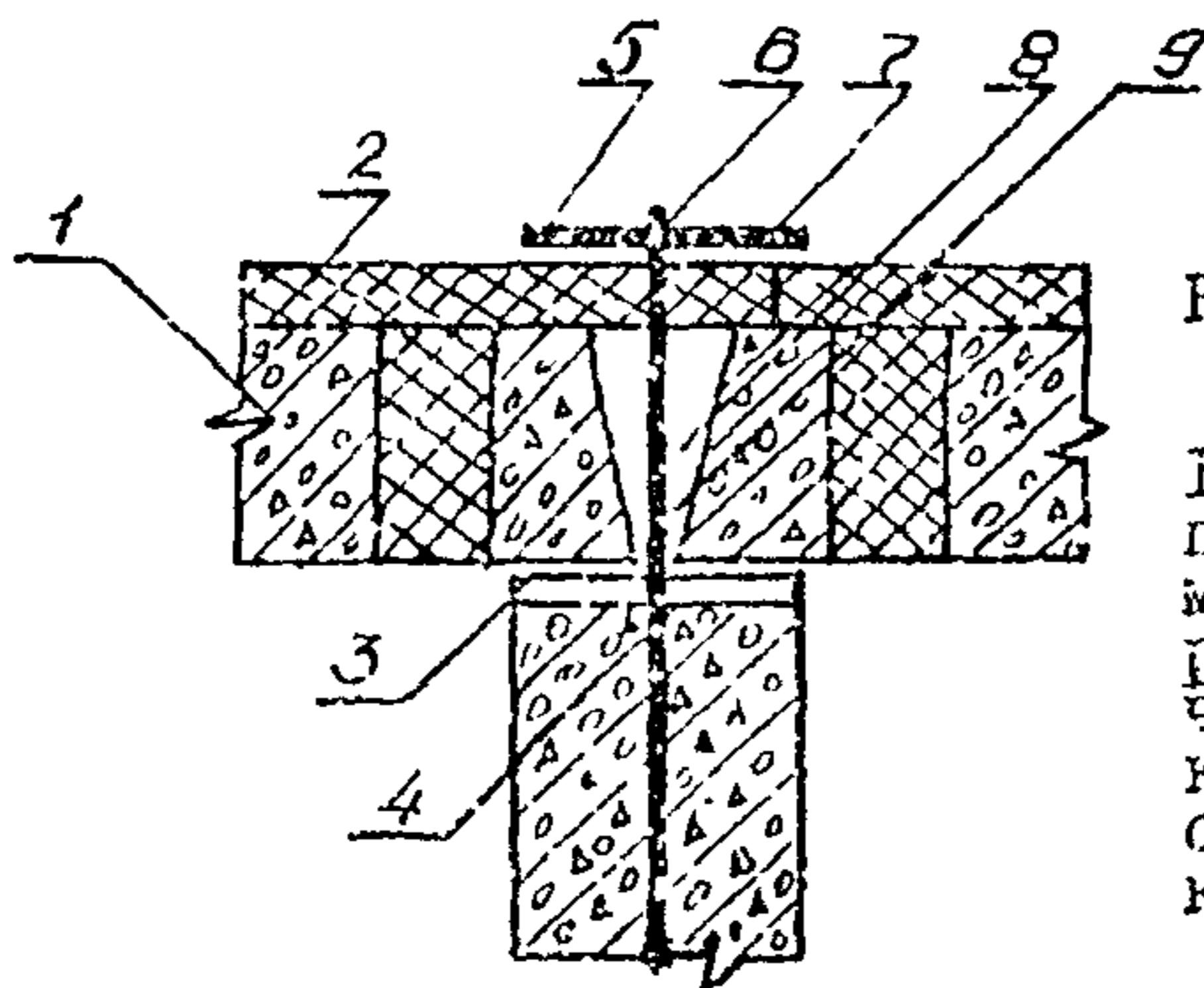
Рис. 8. Схемастыка дренажных плит типа 2:
