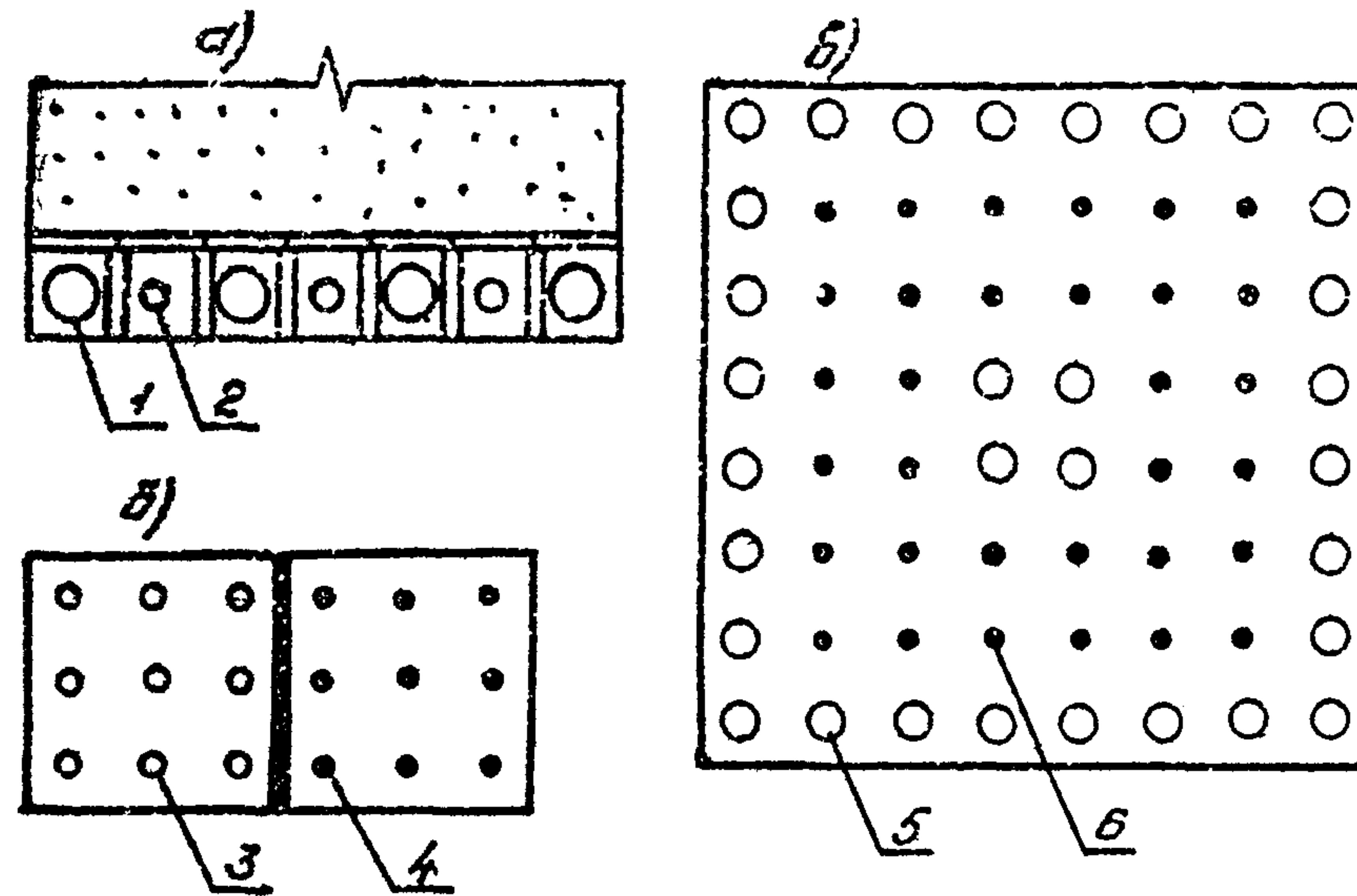
Рис. 3. Схемы дренажей открытых фильтров при чередующейся промывке:
