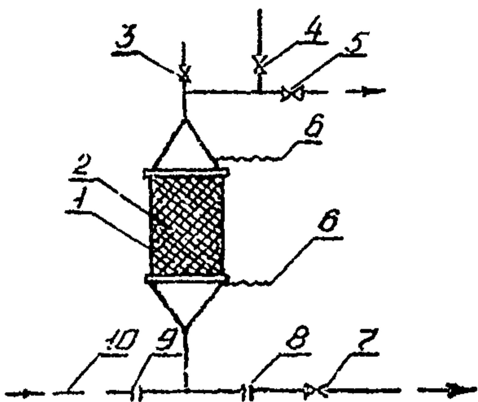
Схема установки для контроля гидравлического сопротивления полимербетона:
