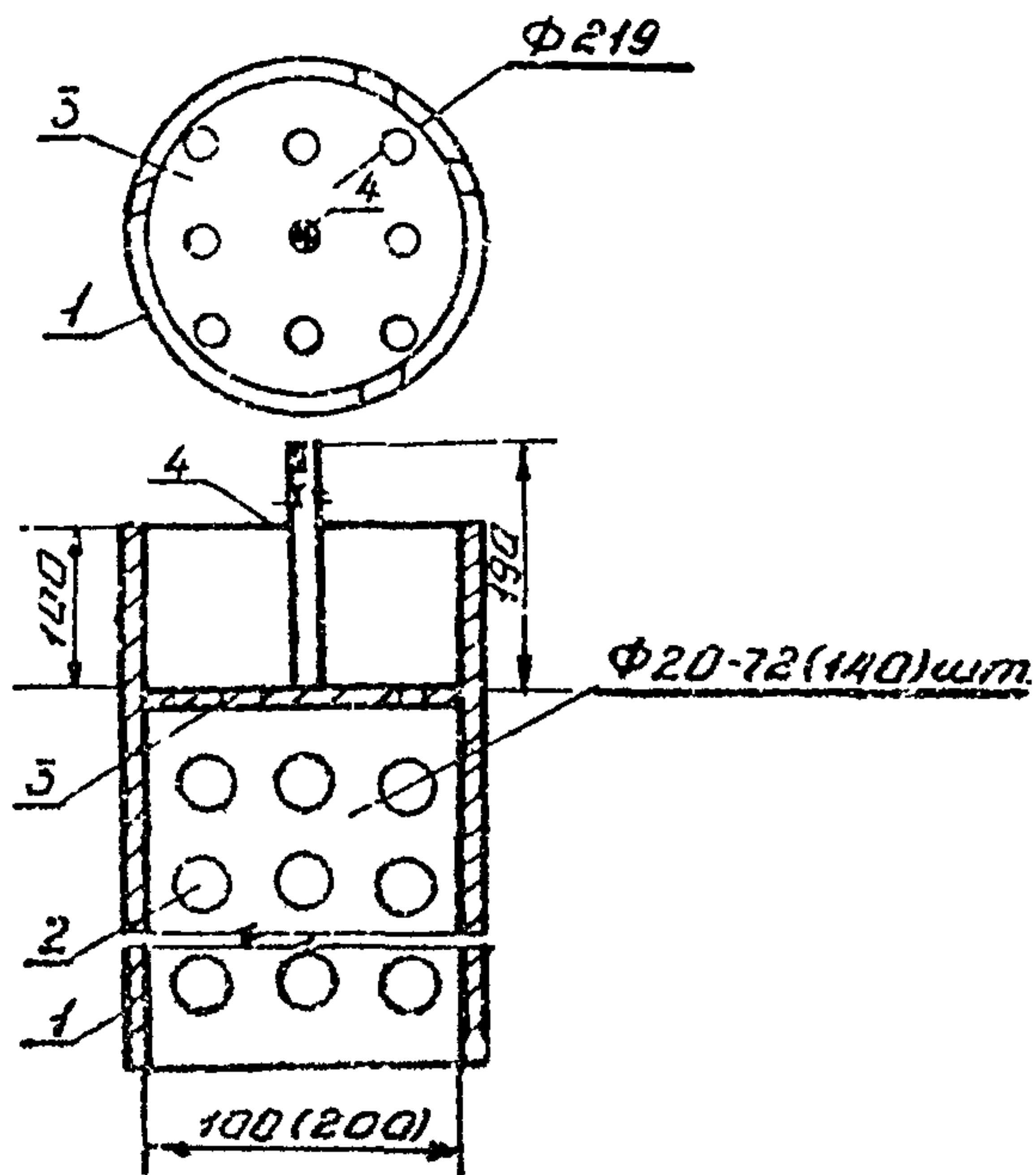
Рис. 6. Центральный патрубок фильтра заводского изготовления для дренажа типа 3 (даны размеры для фильтра диаметром 1 м, а в скобках - для диаметра 2 м):
