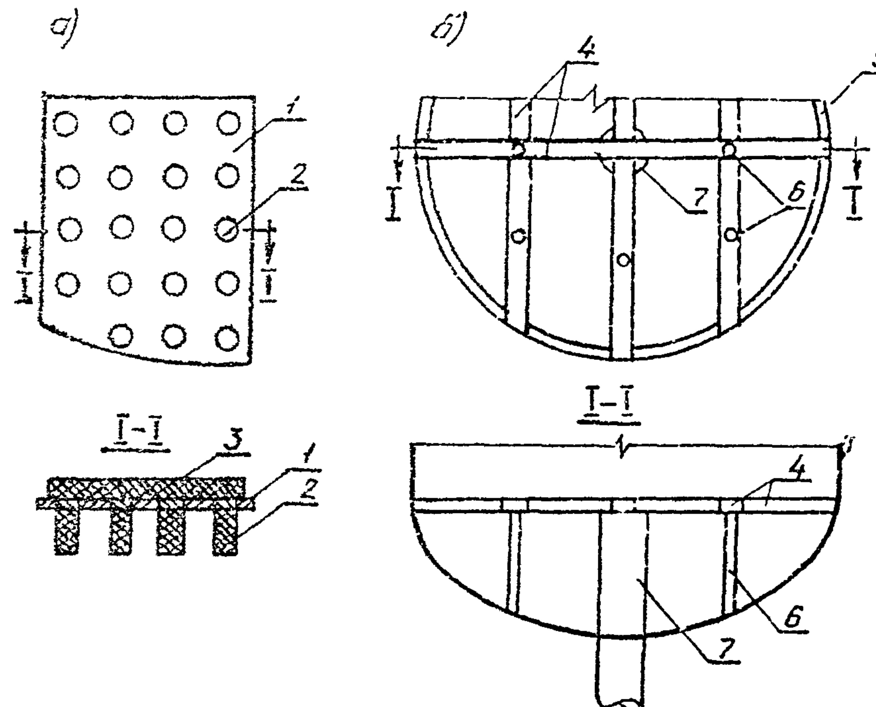
Рис. 4. Схема конструкции дренажа типа 4 фильтра заводского изготовления:
