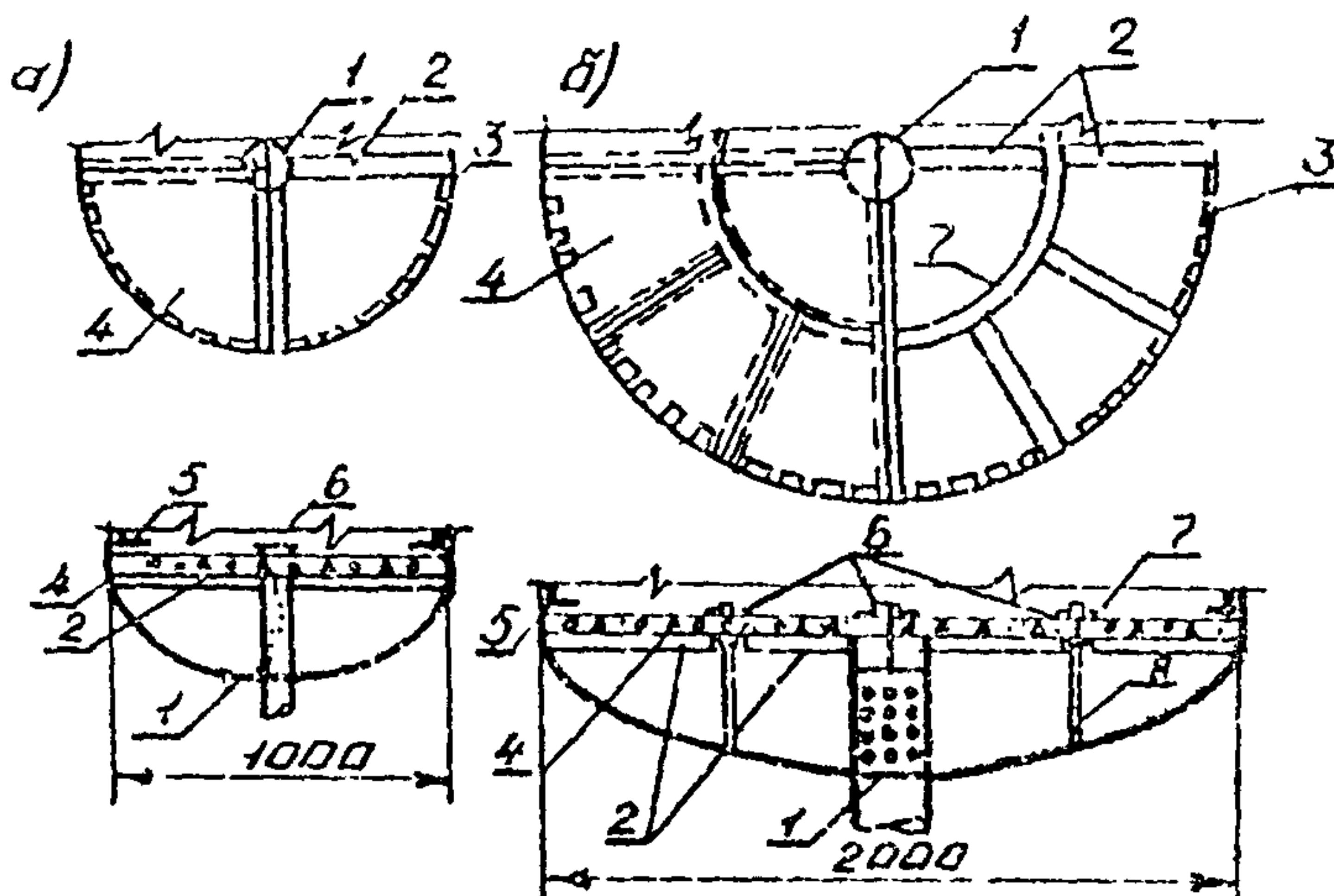
Рис. 5. Схема дренажа фильтров заводского изготовления (тип 3):
