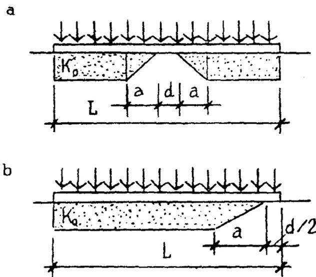
Расчетная схема для решения контактной задачи при возможных положениях провала под серединой здания (a) и с краю (b):  $a$  – ширина ослабленной зоны основания вблизи провала;  $k_0$  – коэффициент постели ненарушенного основания;
