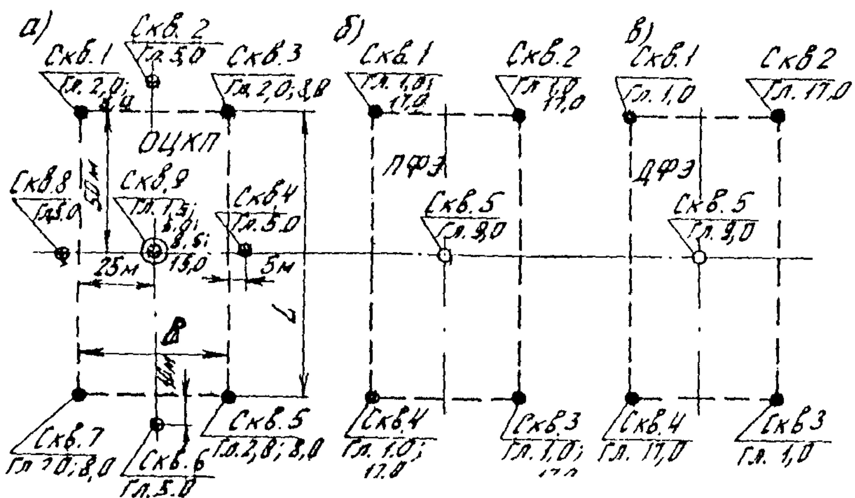
Расположение точек опробования на площадке 100x50 м при планировании:
