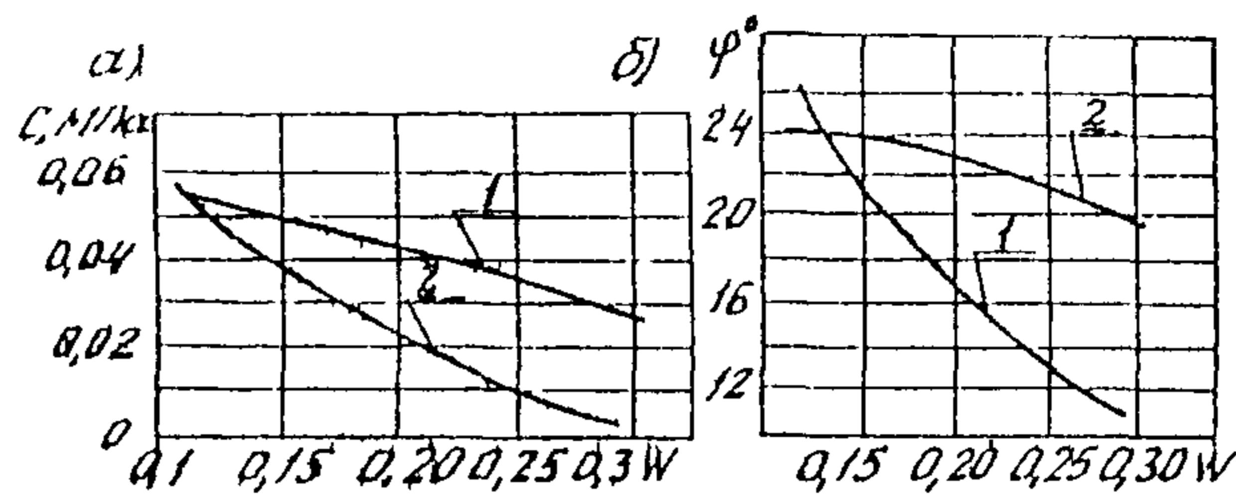
Рис. 12. Зависимость удельного сцепления (а) и угла внутреннего трения (б) от влажности грунтов района г. Ташкента;
