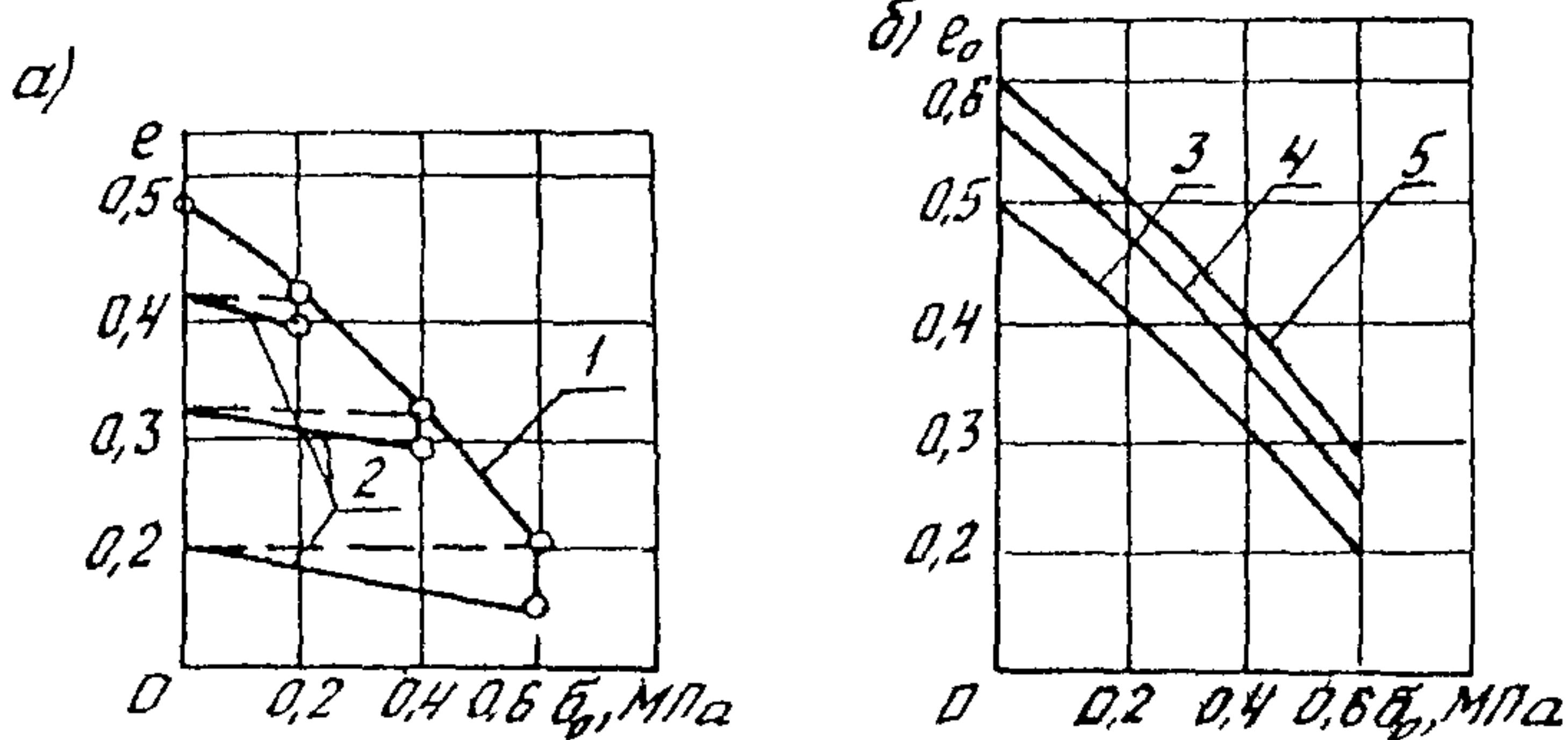
Рис. 15. Комплексная характеристика упругой компрессии лессовидного суглинка (а) и номограмма для определения плотности, обеспечивающей упругую работу насыпей из суглинков (б):
