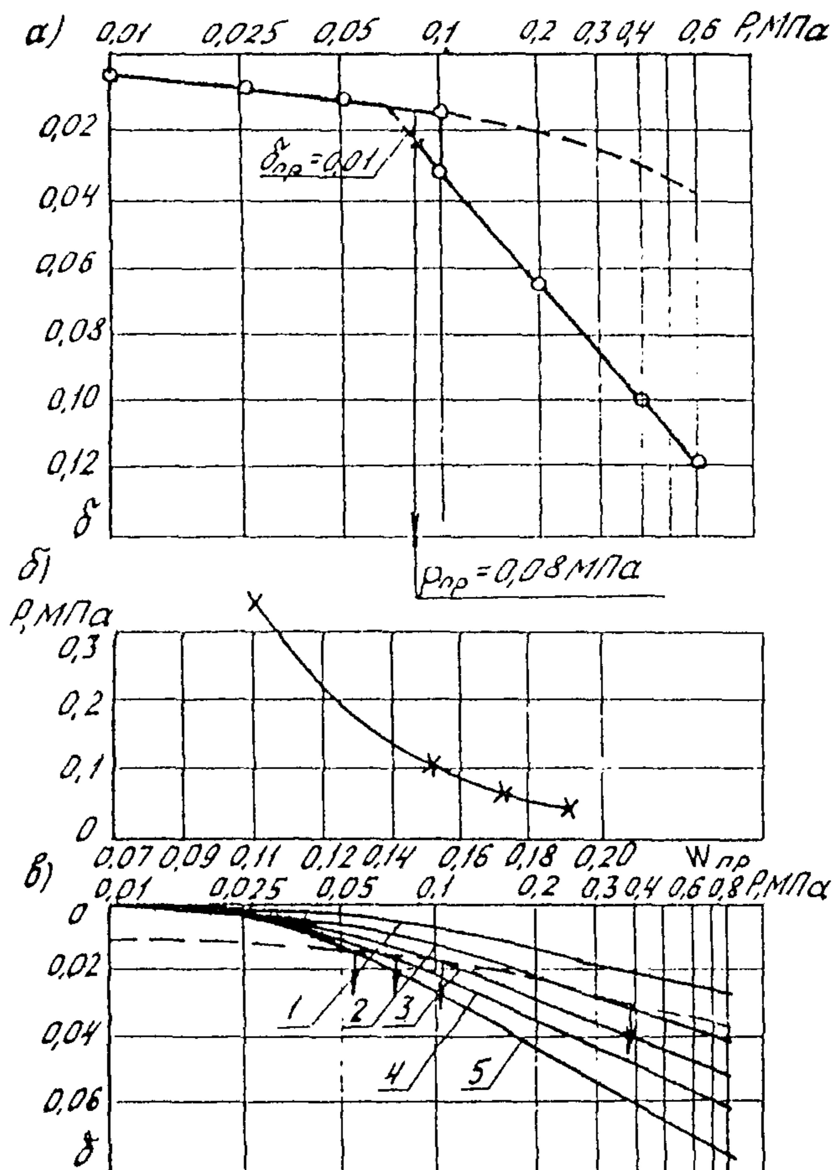
Рис. 8. Определение начального просадочного давления (а) и начальной просадочной влажности (б, в) по результатам компрессионных испытаний:
