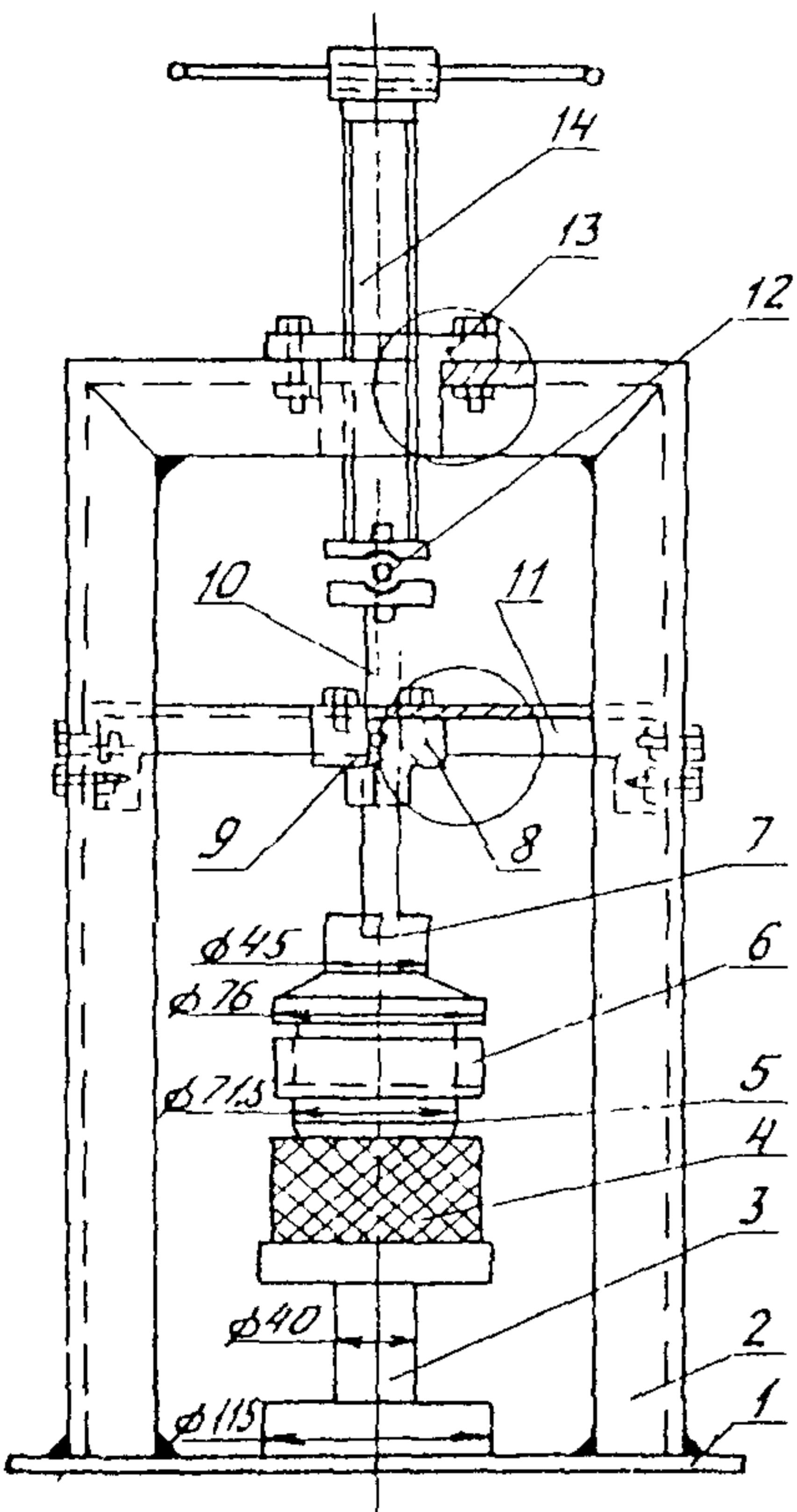
Рис. 7. Пресс для вырезания колец из монолитов грунта
