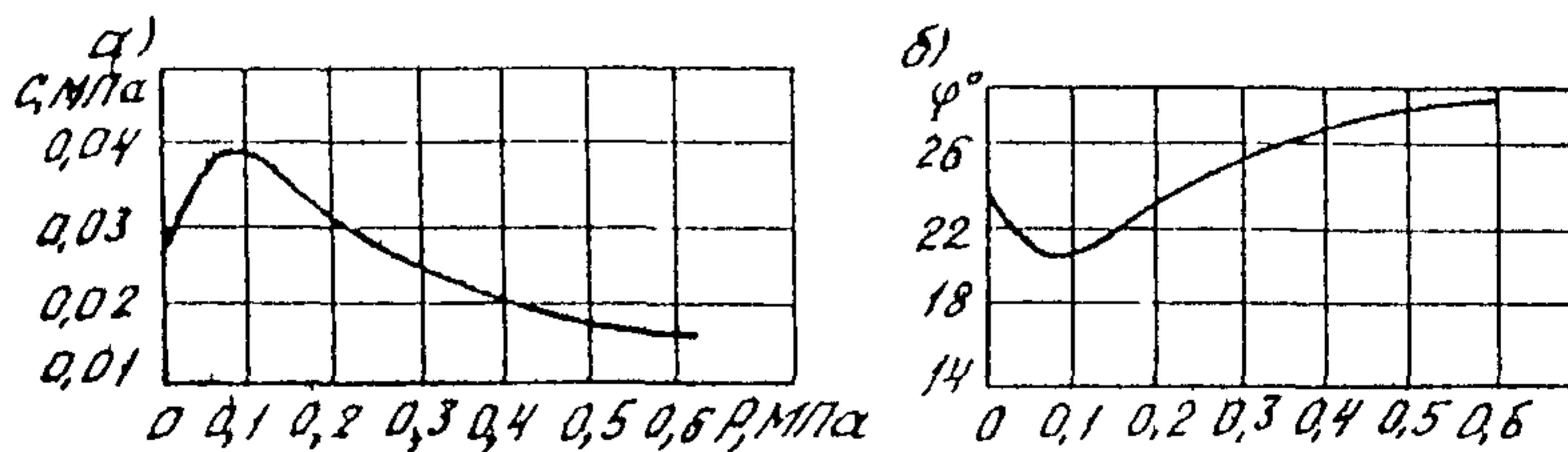
Рис. 13. Зависимость удельного сцепления (а) и угла внутреннего трения (б) от давления предварительного уплотнения для лесовых суглинов (по В.И.Крутову)
