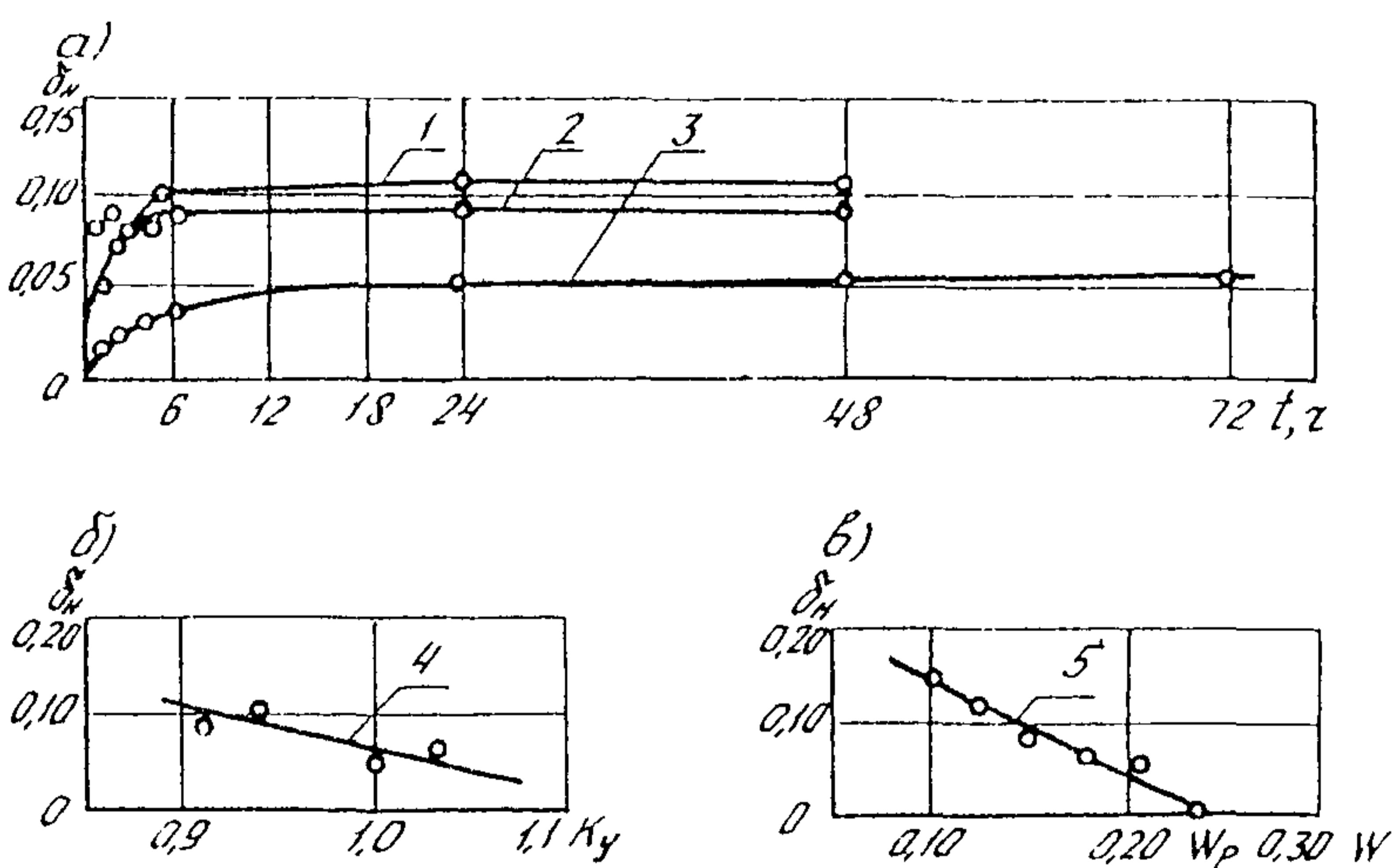
Рис. 5. Результаты испытания уплотненного лессового грунта на набухание в зависимости от времени (а), степени уплотнения (б) и начальной влажности (в):
