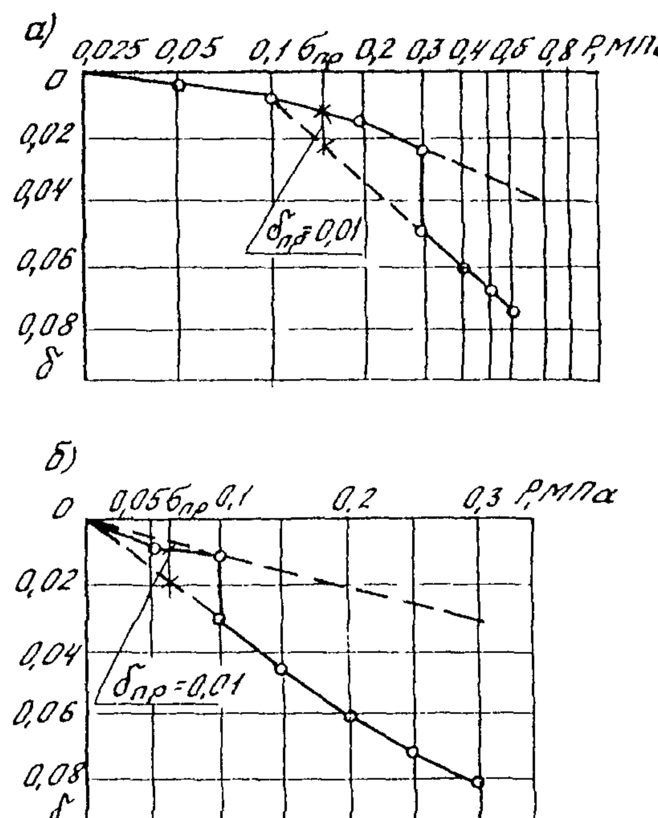
Рис. 9. Упрощенные методы компрессионного определения просадочности лесовых грунтов:
