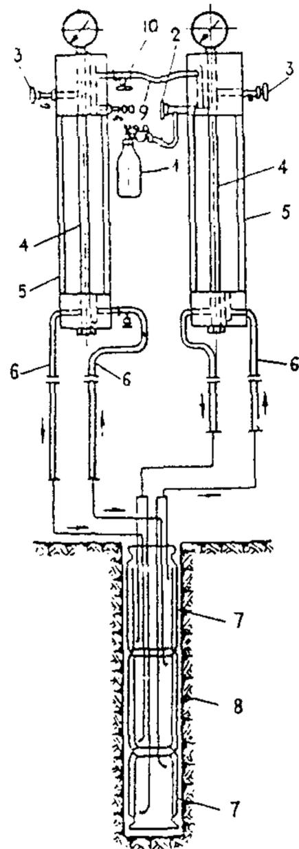
Рис.1. Схема прессометра ПС-1 конструкции
