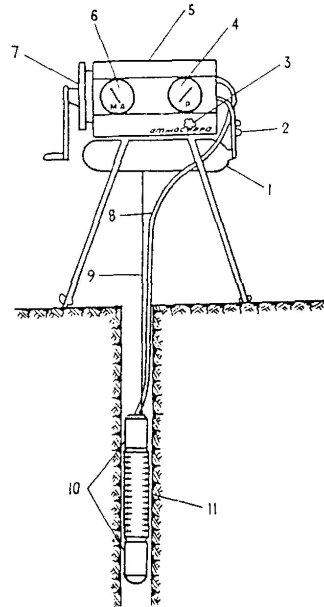
Рис.2. Схема прессометра ИГЦ-21 конструк-
