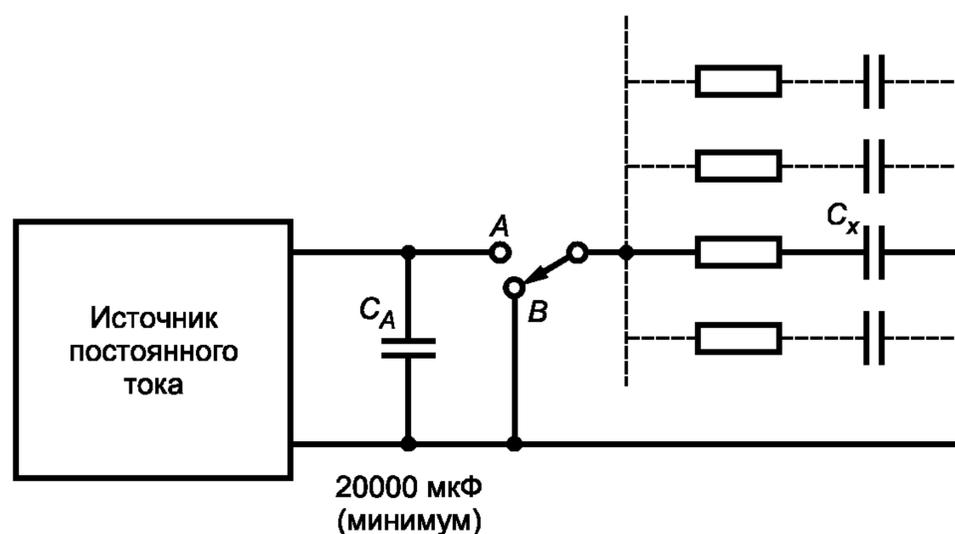
$C_x$  — испытуемый конденсатор;  $C_A$  — зарядный конденсатор;  $A, B$  — положения переключателя
