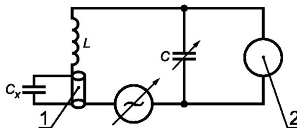
1 — закорачивающая перемычка; 2 — куметр
