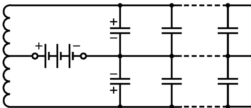
Рисунок 10 — Схема испытания электролитических конденсаторов
