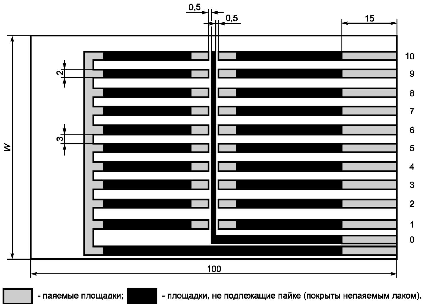
Допускаемые отклонения размеров — средние.
