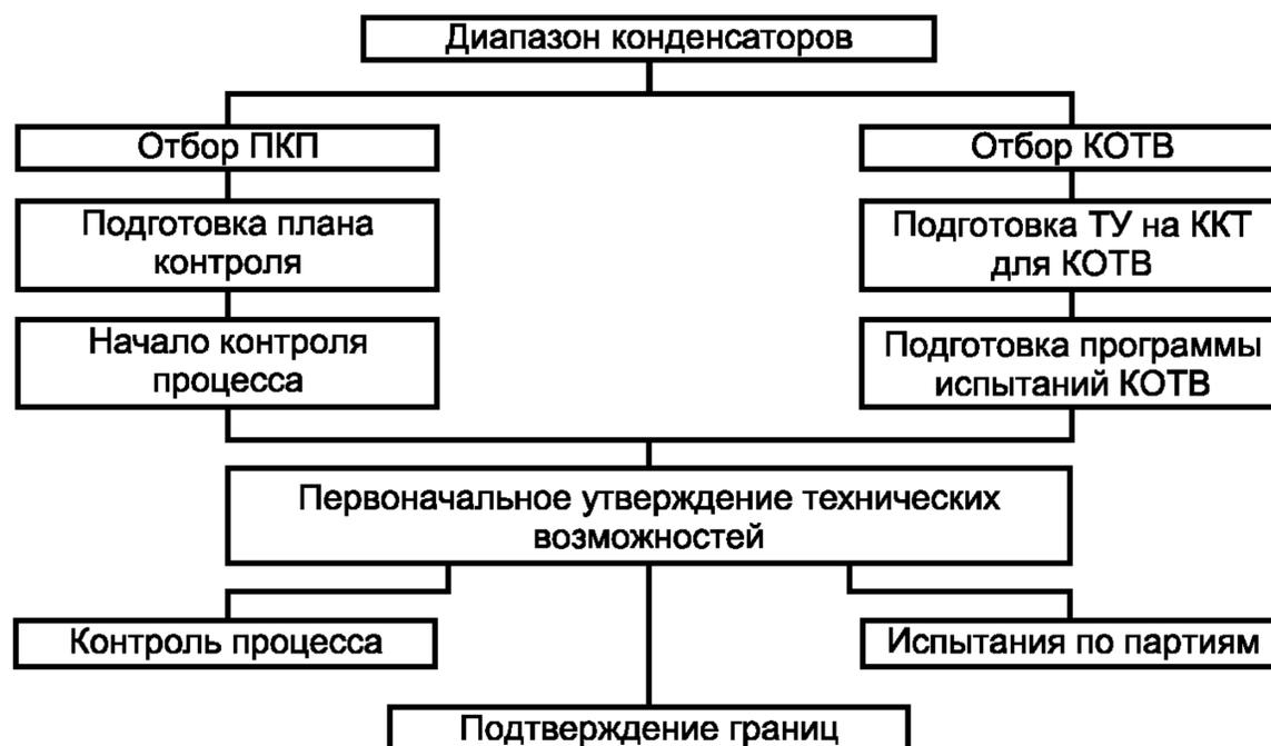
Рисунок 2 — Общая схема утверждения технических возможностей
