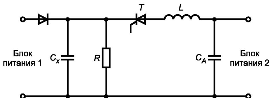
$C_x$  — испытуемый конденсатор;  $C_A$  — зарядный конденсатор;  $R$  — резистор;  $T$  — тиристор;
