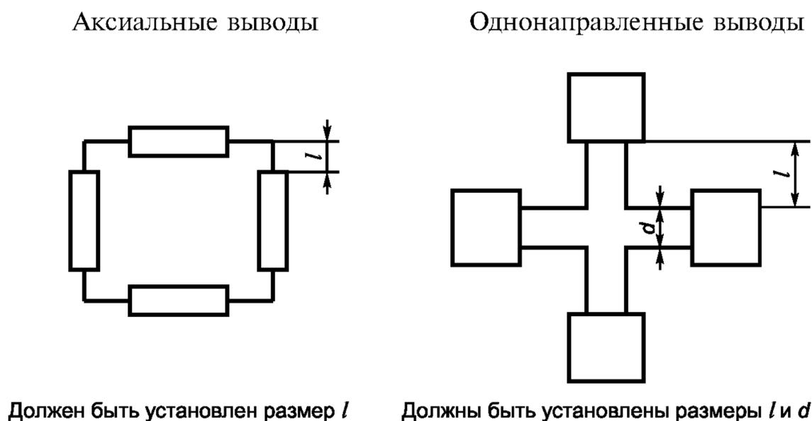
Рисунок 5 — Схема монтажа конденсатора
