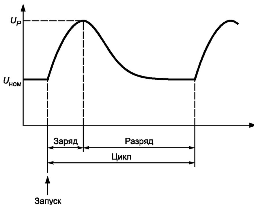
Рисунок 19 — Кривая напряжения
