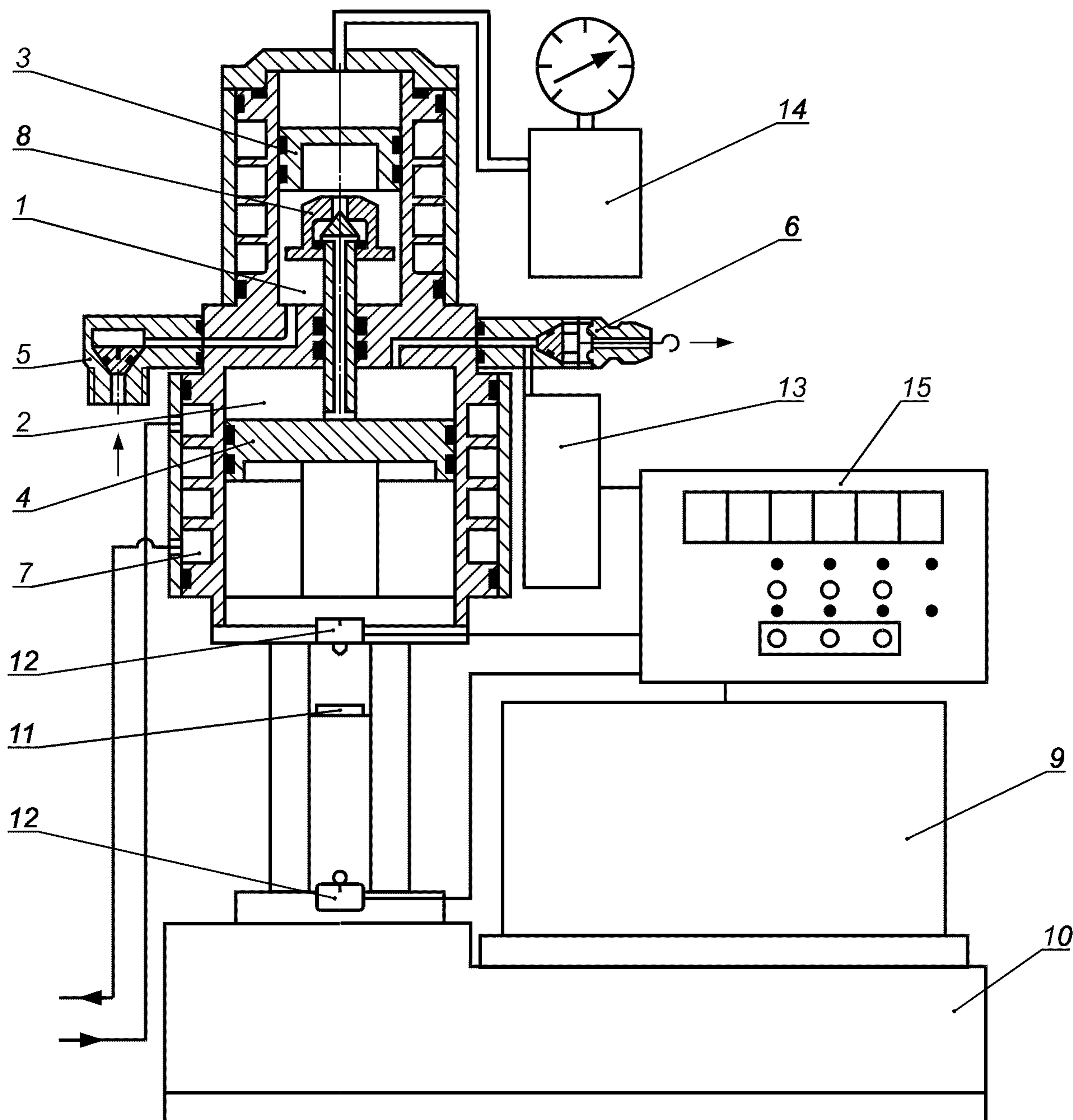
1 — пробоотборная камера; 2 — измерительная камера; 3, 4 — поршни; 5 — входной клапан; 6 — выходной клапан; 7 — термостатирующая «рубашка»; 8 — впрысковой клапан; 9 — двигатель; 10 — редуктор; 11 — визир; 12 — микровыключатели; 13 — датчик давления; 14 — подпорная газовая камера; 15 — блок управления (панель прибора)
