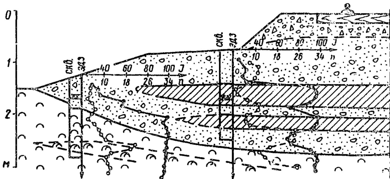
Рис. 4. Определение величин осадки насыпи в торфе
