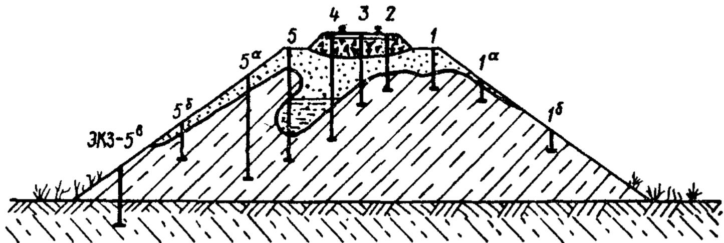
Рис. 13. Схема расположения и порядок нумерации точек ЭКЗ при обследовании насыпи однопутной линии
