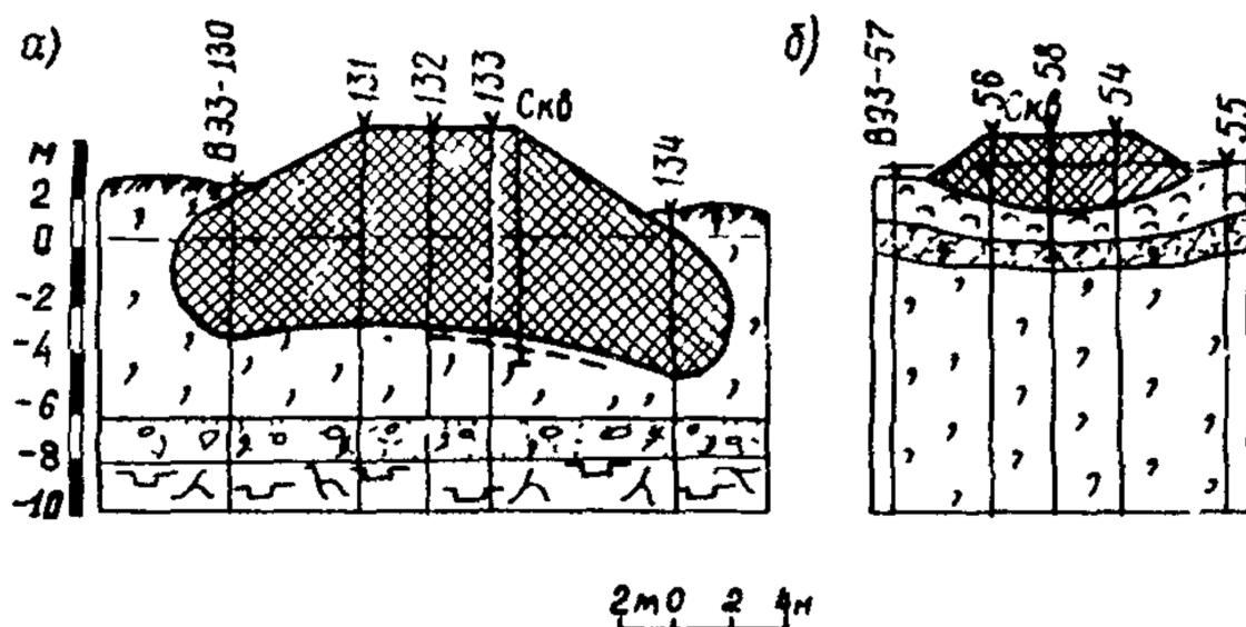
Рис.7. Схема расположения ВЭЗ на насыпи, возведенной на слабых грунтах:
