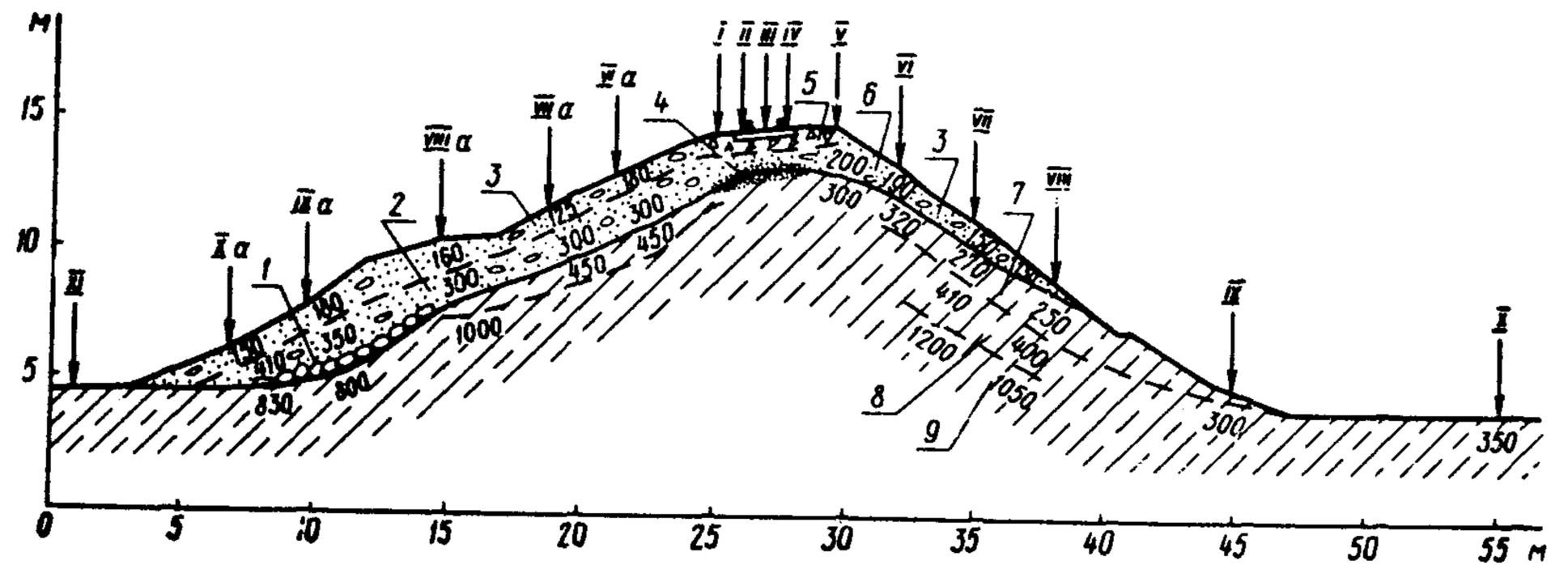
Рис. I. Сейсмический разрез насыпи одного из участков Юго-Западной железной дороги:
