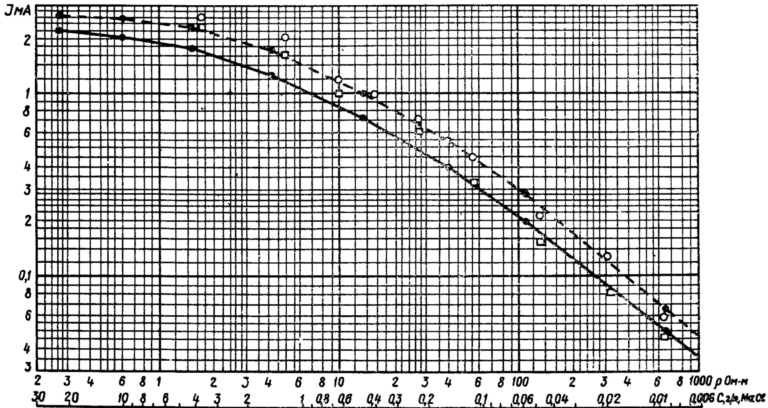
Рис. 15. Графики зависимости силы тока от удельного электрического сопротивления раствора  $NaCl$  для двухконтактных наконечников с разным диаметром контактов, мм (сопротивление раствора  $NaCl$  приведено для  $t = 18^\circ C$ ): --- график полученный при  $d=12$ ; — при  $d=9$ ;  $\circ$  - сила тока и сопротивление образца грунта при  $d=12$ ;  $\square$  - то же при  $d=9$
