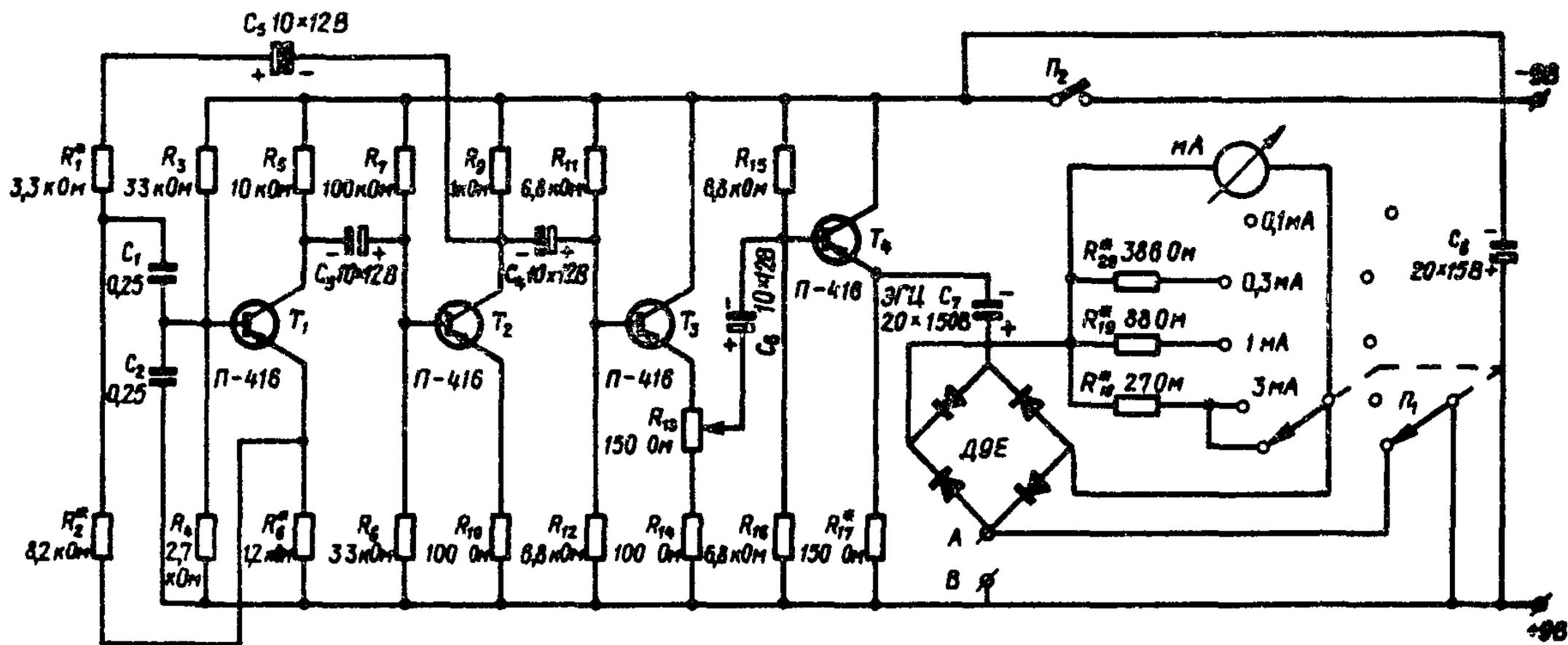
Электрическая схема измерительного прибора ИТ-73
