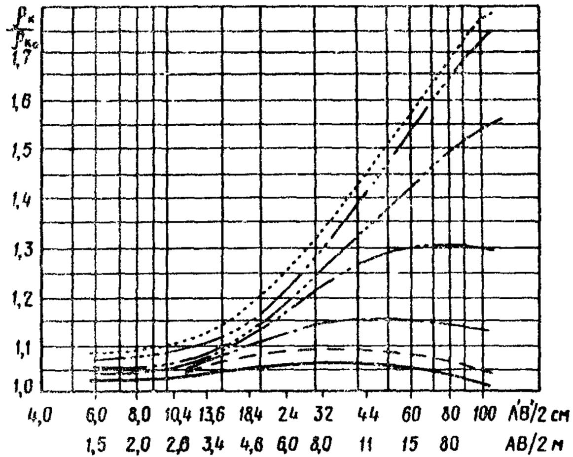
Рис. I. Зависимость  $\frac{\rho_k}{\rho_{k0}}$  от высоты насыпи и полуразносов питающих линий  $\frac{AB}{2}$  м:
