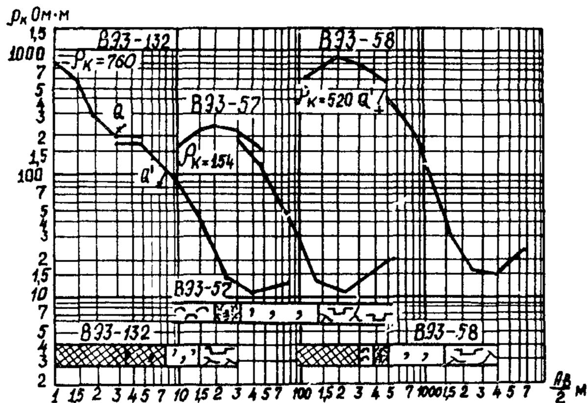
Рис. 8. Кривые ВЭЗ-132 и -58, полученные на оси насыпи, возведенной из крупнообломочного материала на слабых грунтах, и кривая ВЭЗ-57, полученная на торфе
