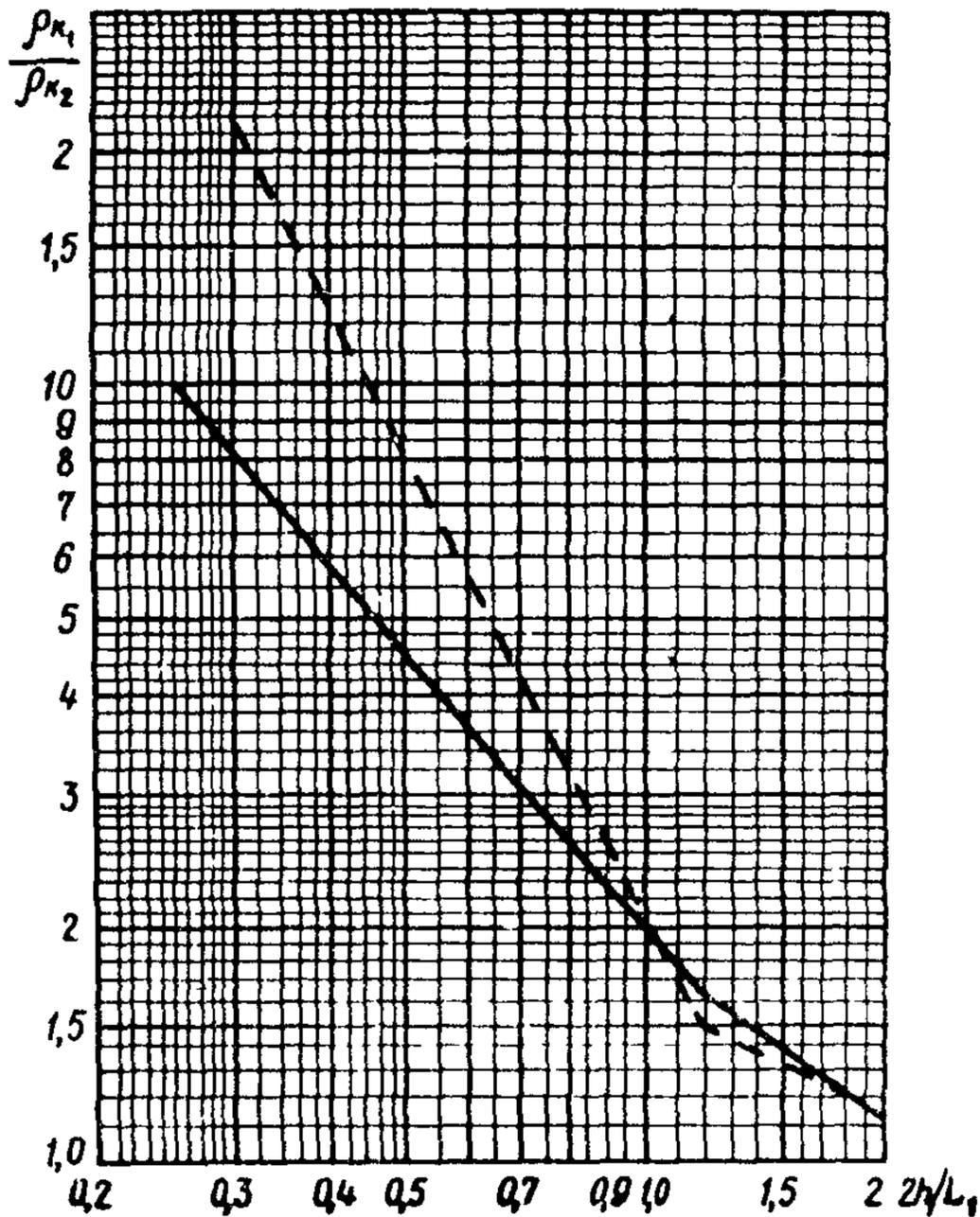
Рис. 10. График зависимости  $h = f\left(\frac{\rho_{k1}}{\rho_{k2}}, L_1, L_2\right)$  при  $\frac{L_2}{L_1} = 2$  (по Гершковскому В. Ч.)
