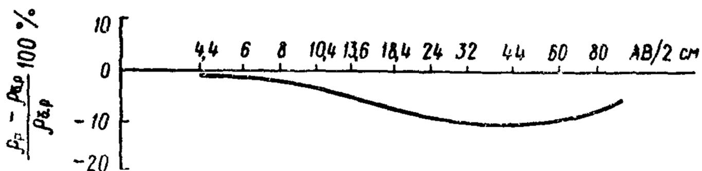
Рис. 4. Влияние рельсовых нитей на результаты электрометрических измерений:
