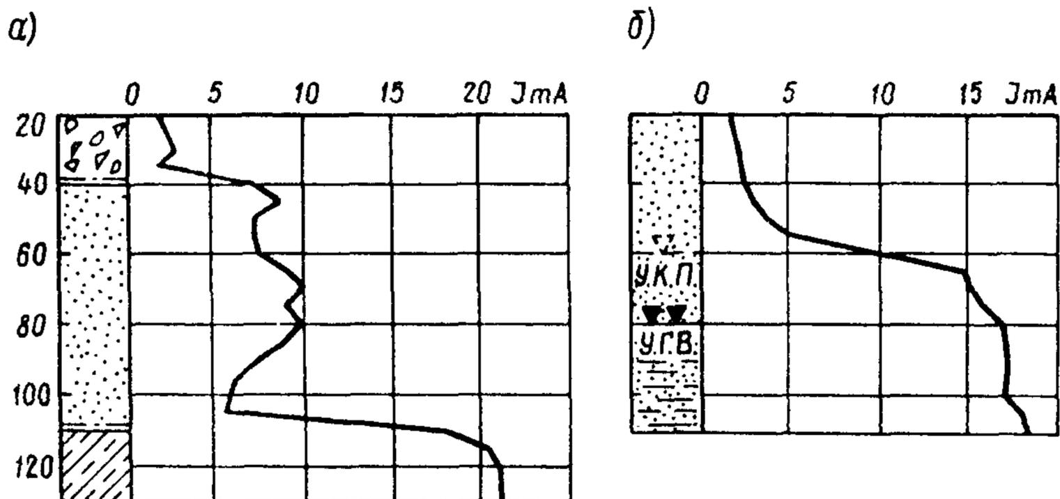
Рис. 14. Определение мощности балластного слоя (а) и уровня капиллярного поднятия грунтовых вод (б) по результатам зондирования с одноконтakтным накопечником
