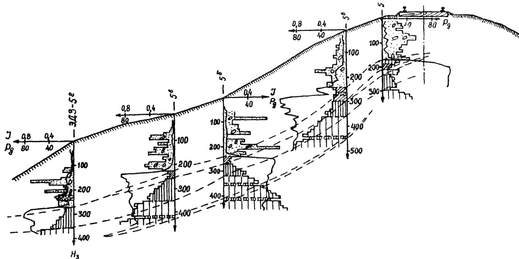
Рис.2. Результаты обследования насыпи методом ЭДЗ
