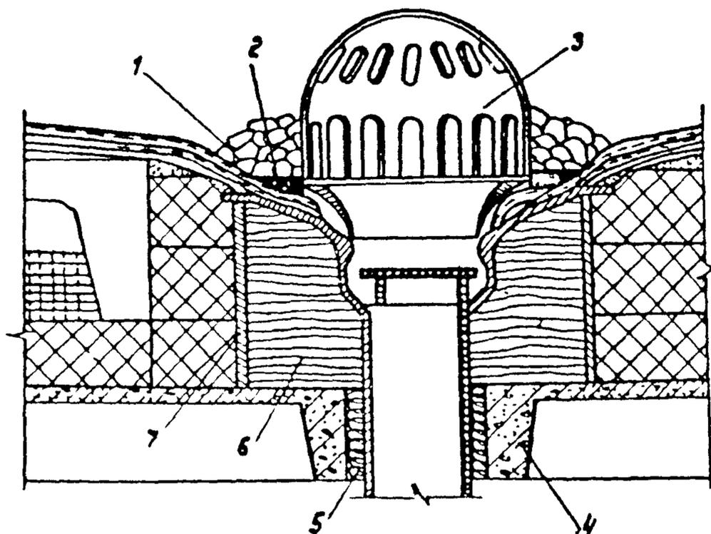
Рис. 12. Примыкание кровельного ковра к воронке
