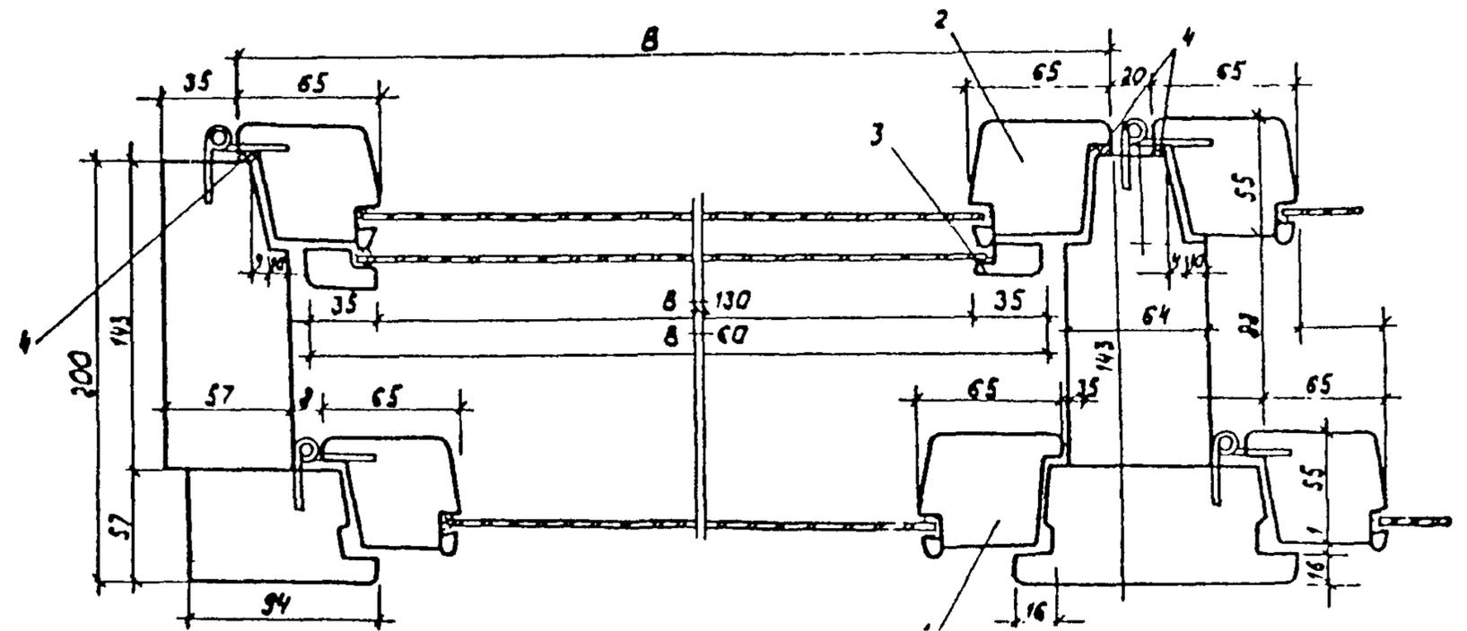
Рис. 40. Установка доп. тепленькой створки.
