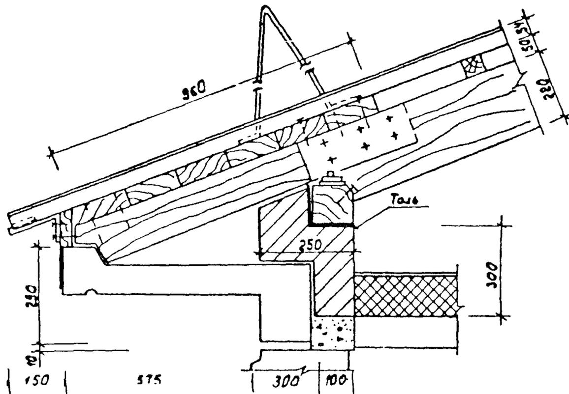
Рис. 19. Устройство бесчердачной крыши на чердачном
