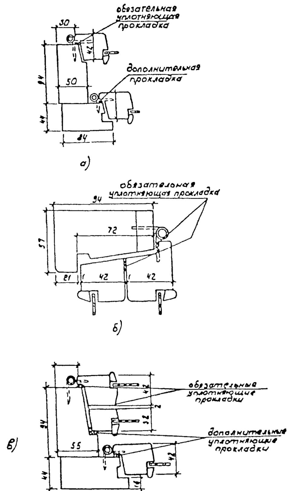
Рис. 37 Установка уплотняющих прокладок в окнах с наплавом.
