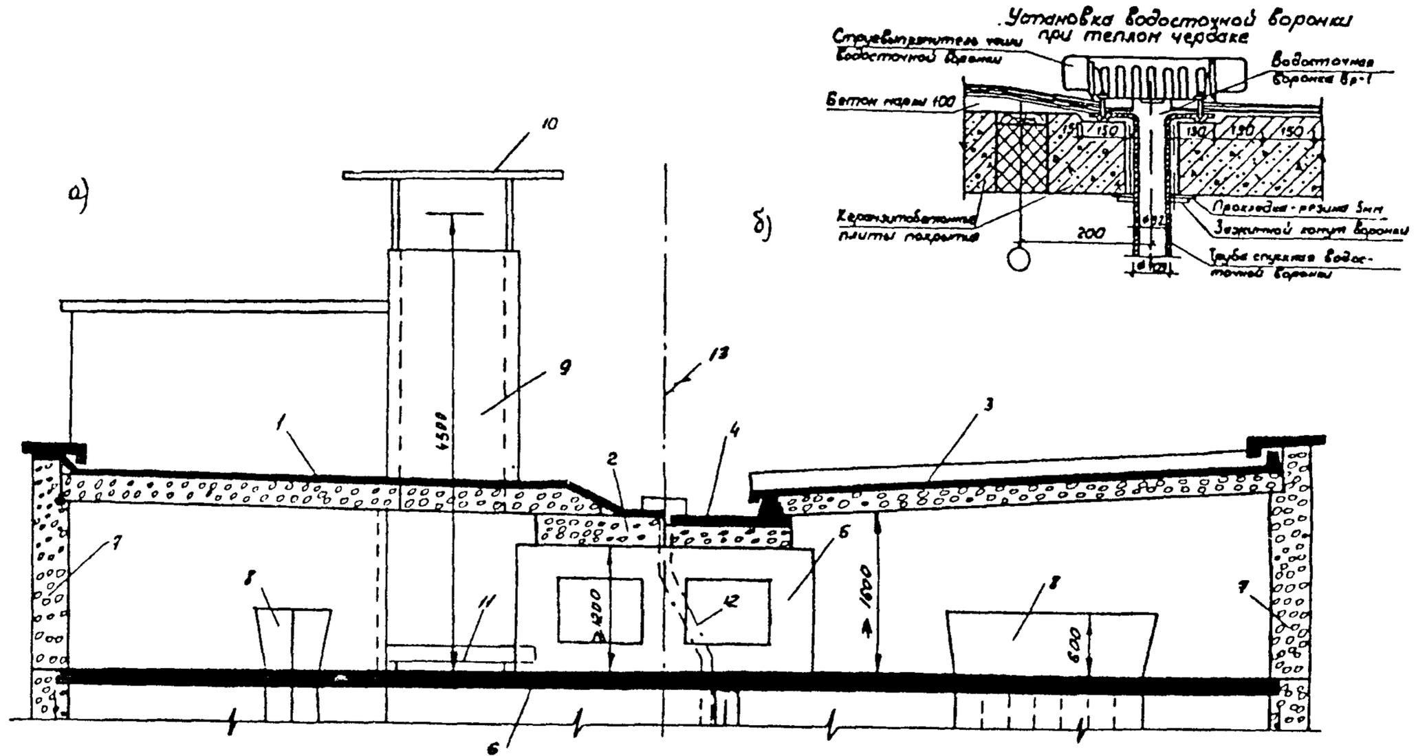
Рис. 20. Схема крыши с теплым чердаком.
