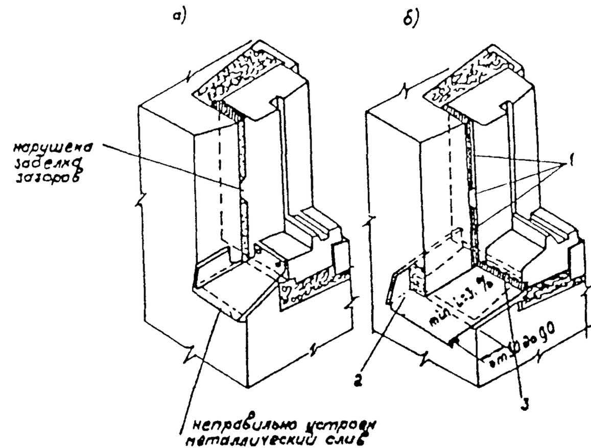
Рис. 35. Герметизация прижима оконного блока.
