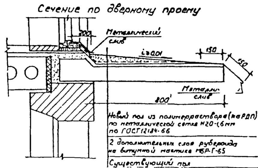
Рис. 32. Ликвидация обратного уклона балкона
