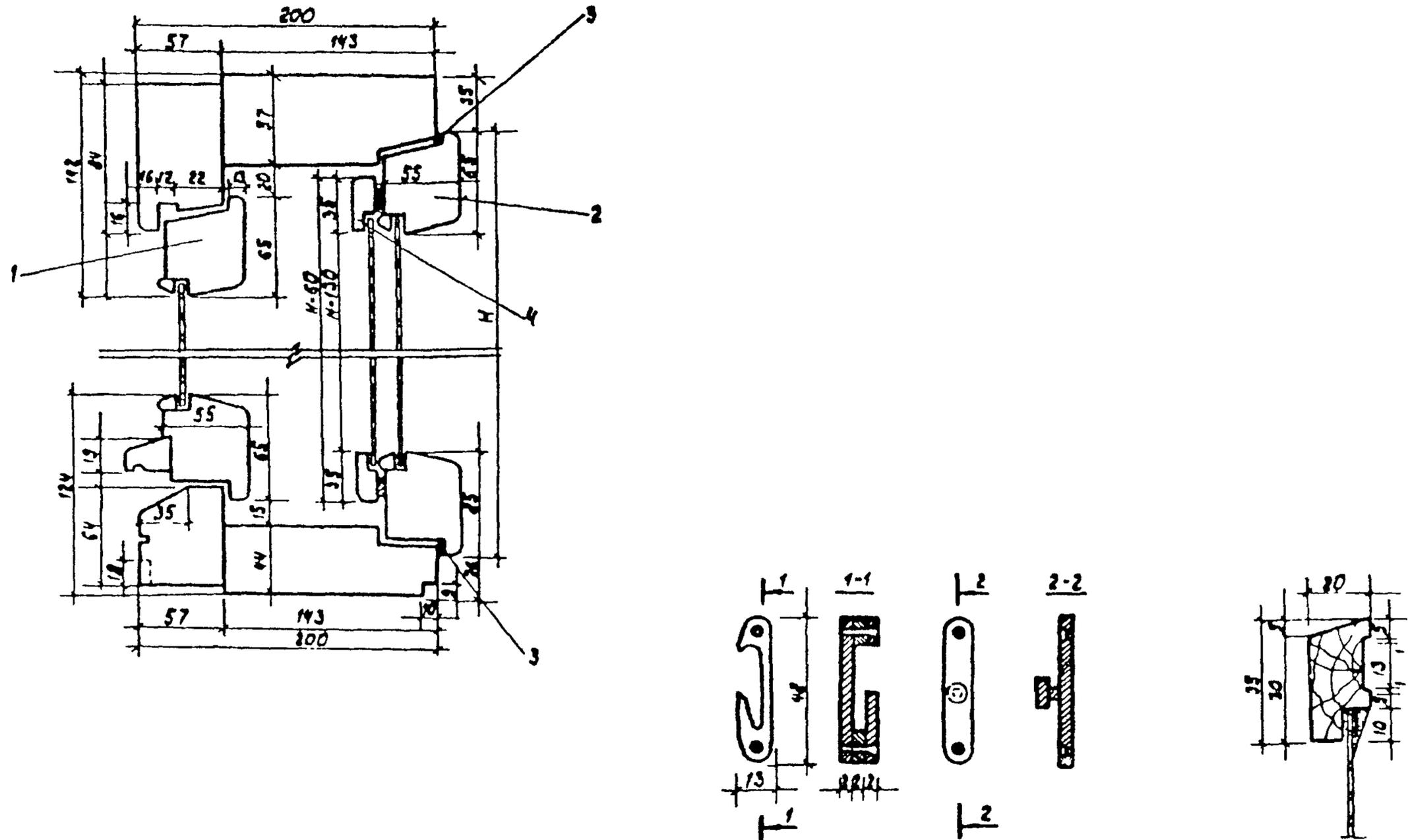
Рис. 39 Установка дополнительной створки на оконный блок с отдельными переплетами.
