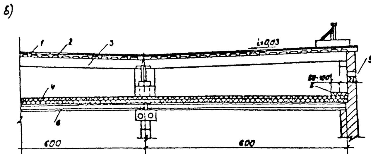
Рис. 1. Крыша с наружным (а) и внутренним (б) отводом воды.
