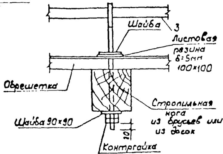
Спецификация элементов для крепления страховочной веревки в расчете на 10 п.м. конька кровли
