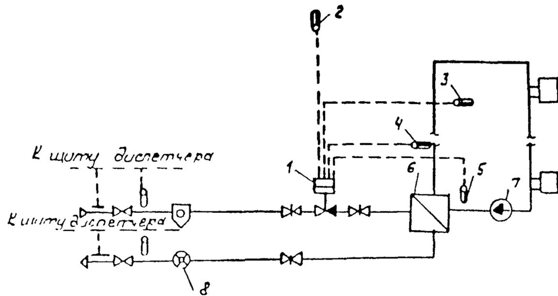
Рис. 44. Технологическая схема автоматизации системы отопления с независимым присоединением.
