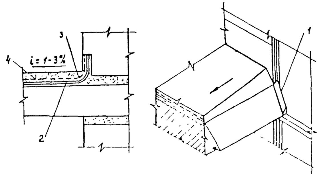
Рис. 33. Восстановление слива из оцинкованной стали
