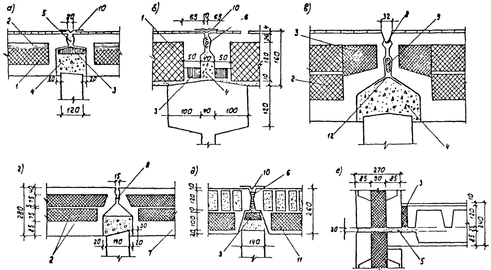
Рис. 26. Примеры конструктивных решений многослойных стен крупнопанельных зданий.
