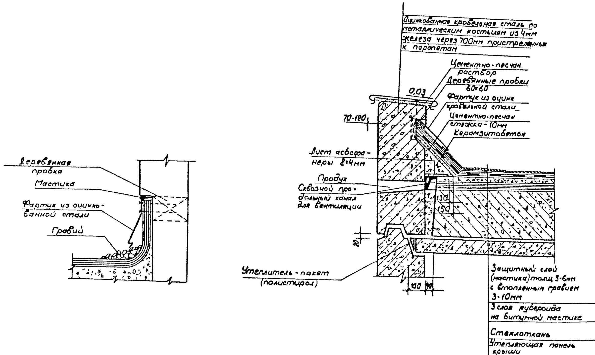
Рис 14 Ремонт прижимания кровельного ковра к стене.
