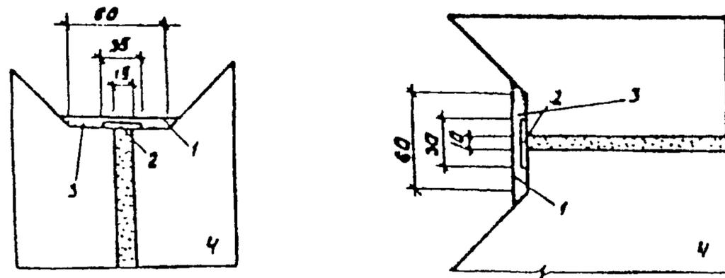
Рис. 29 Герметизация стыка.
