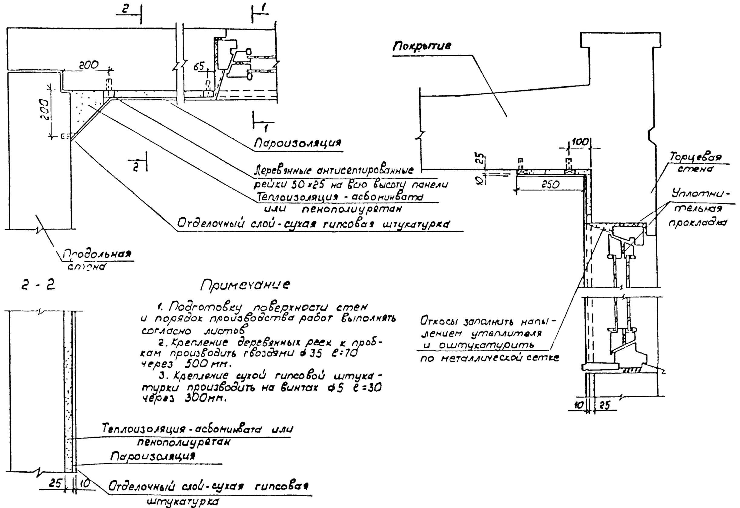
Рис. 22. Утепление стен
