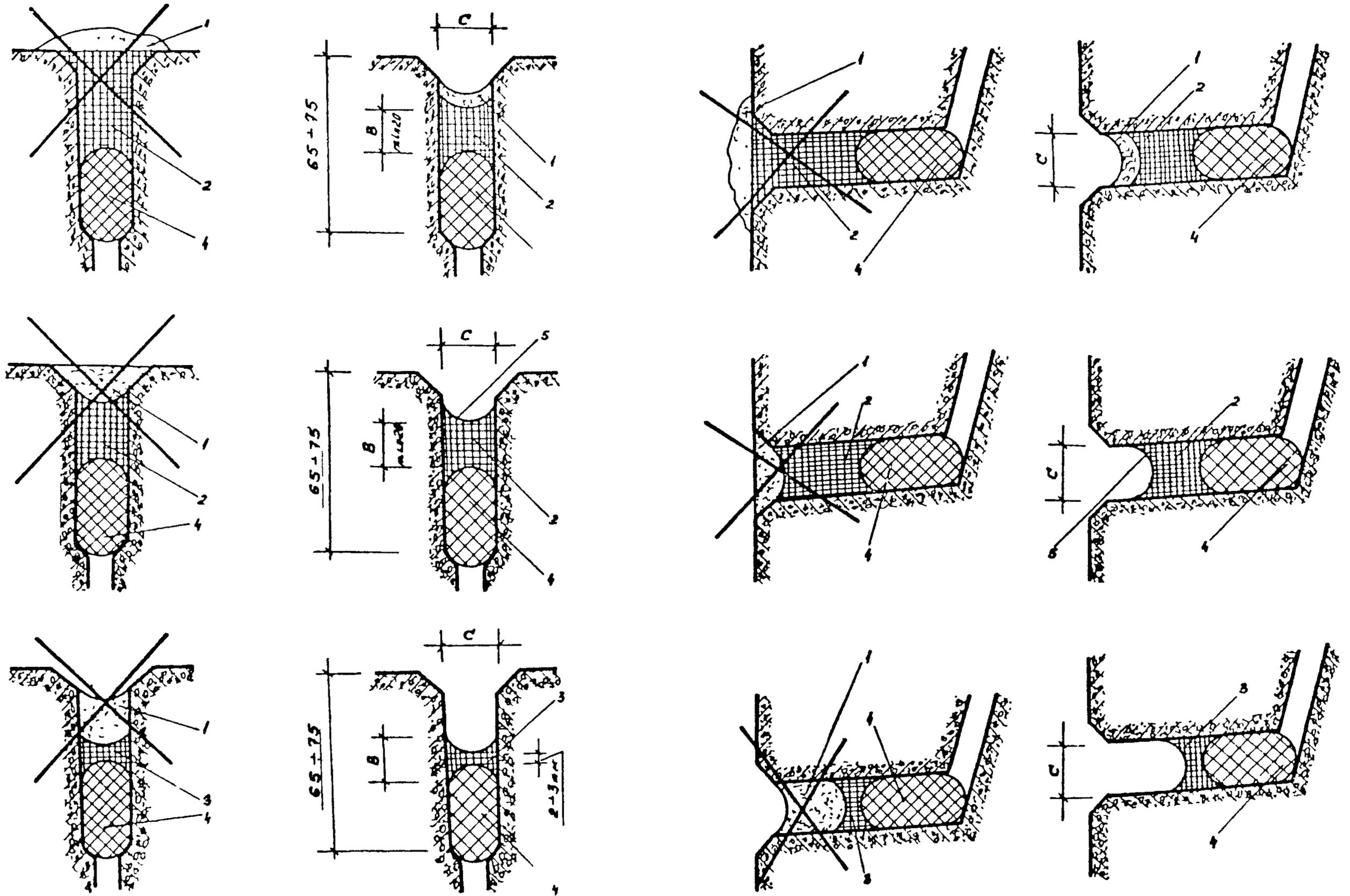
Рис. 31 Ремонт стыков
