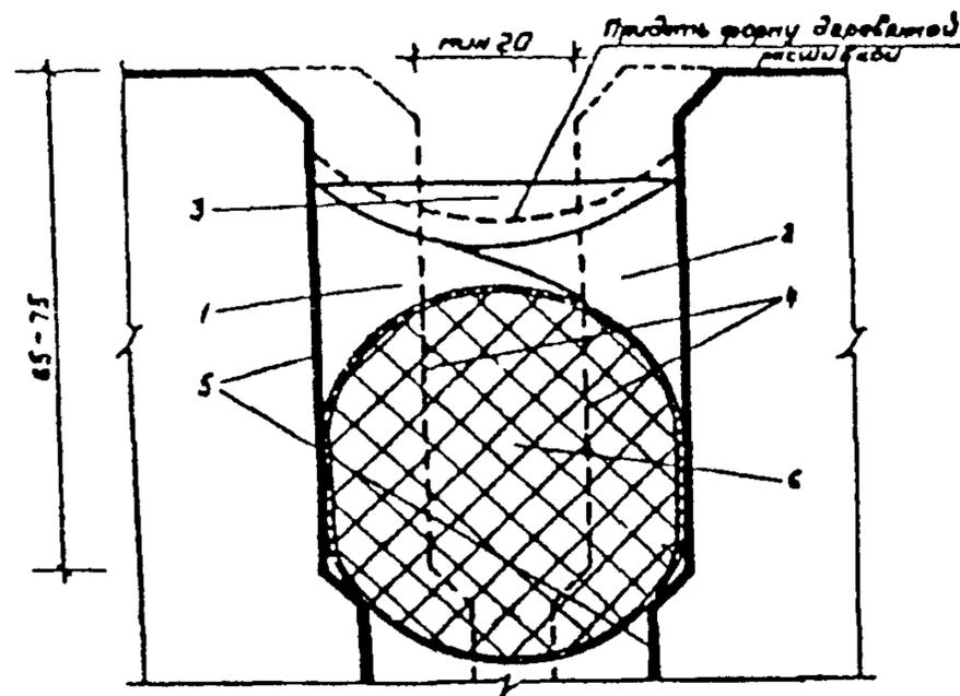
Рис. 27.2. Герметизация стыков большой ширины
