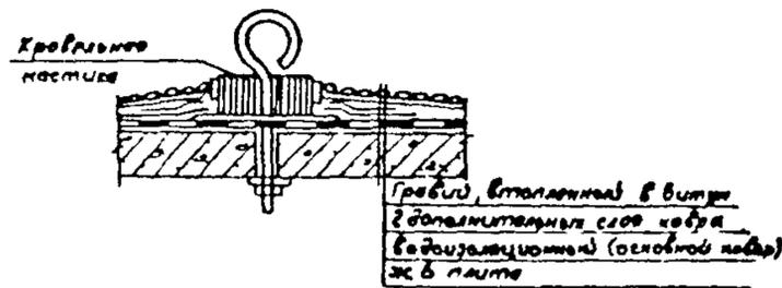
Рис. 16 Установка крюка для крепления растяжек
