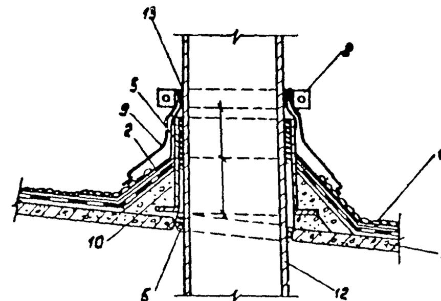
Рис. 13. Примыкание кровельного ковра к трубам.
