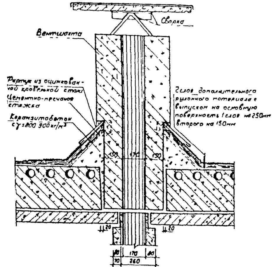
Рис. 18 Детали сопряжения крыши с вентиляхтой
