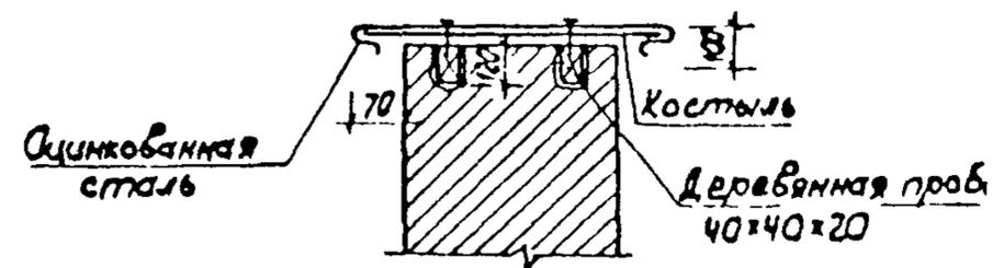
Рис. 5. Детали при пропусках через кровлю инженерных устройств
