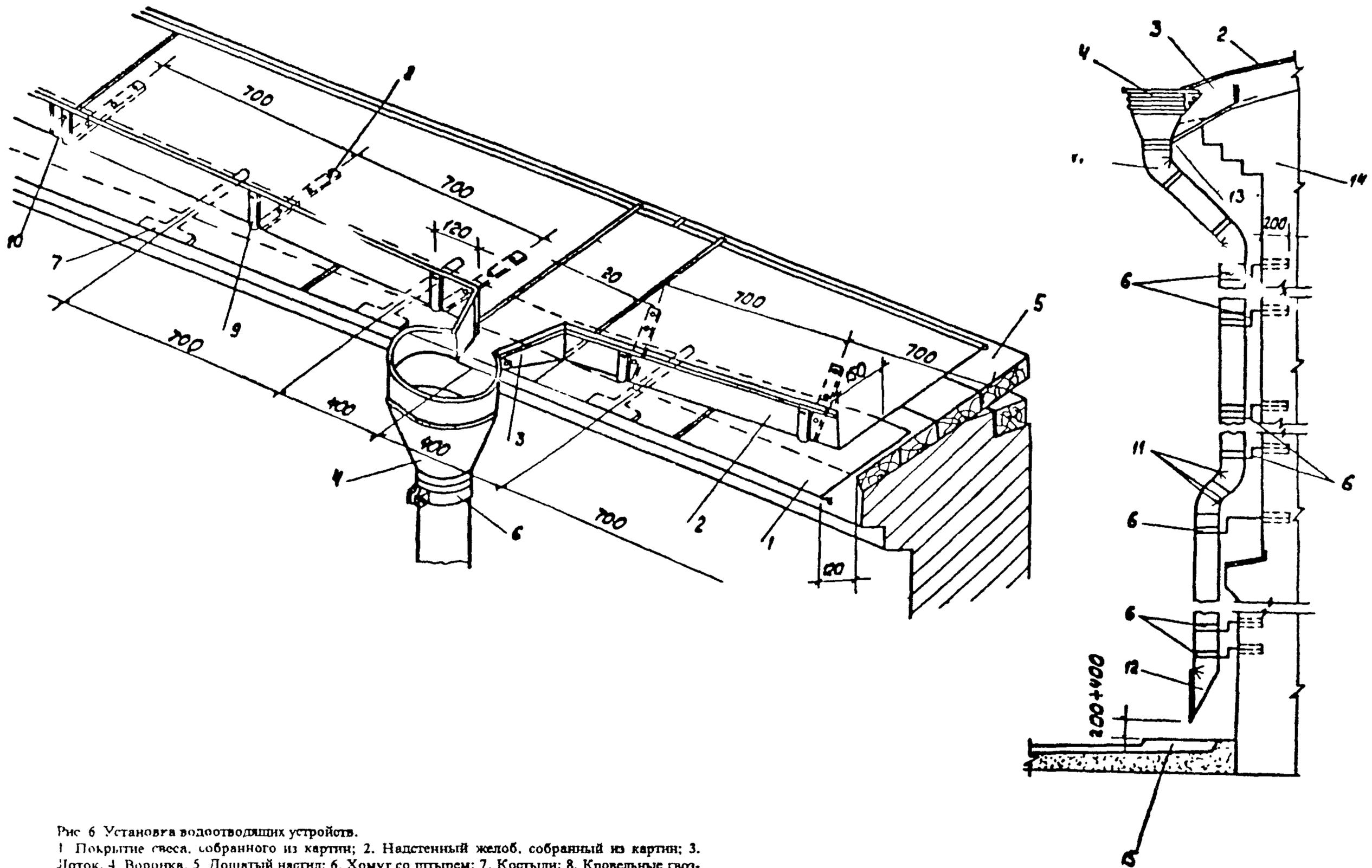
Рис 6 Установка водоотводящих устройств.
