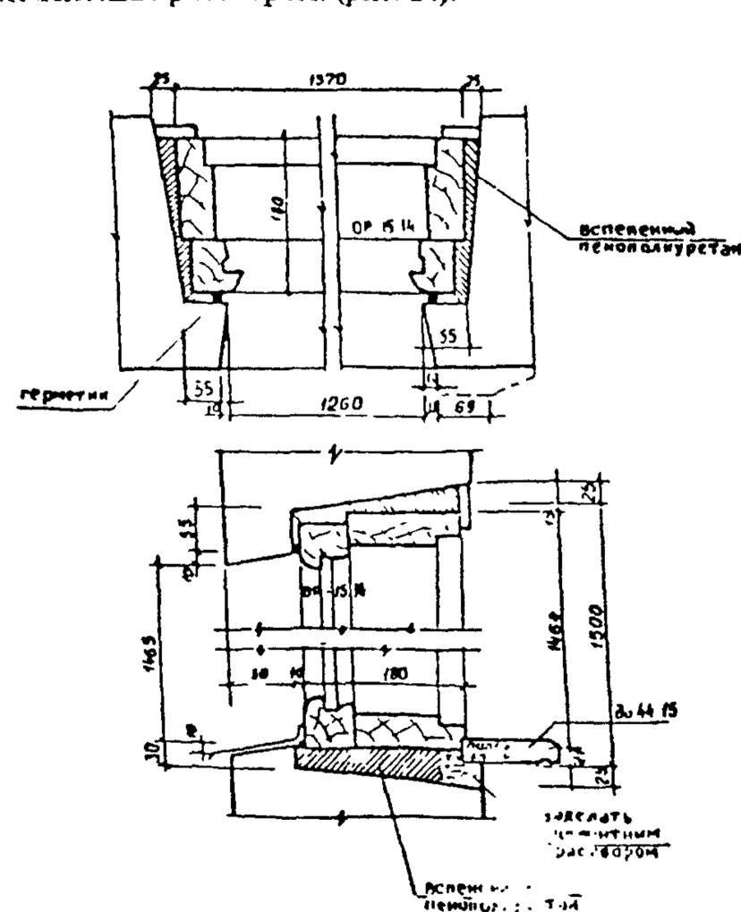
Рис. 24. Утепление оконного блока.
