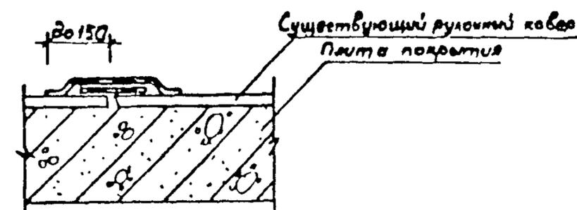
Рис. 7. Ликвидация пробоя и разрывов.
