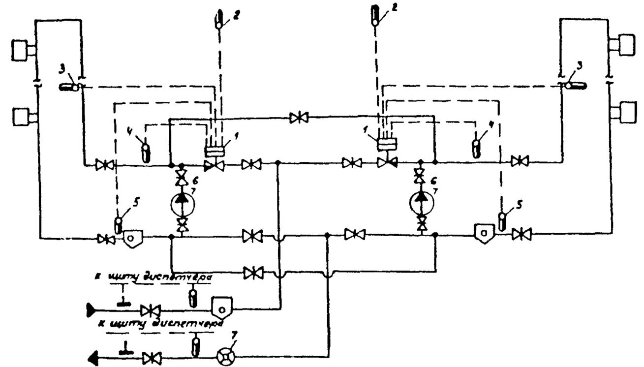
Рис. 47. Технологическая схема пофасадной автоматизации системы отопления с насосом на подающем трубопроводе
