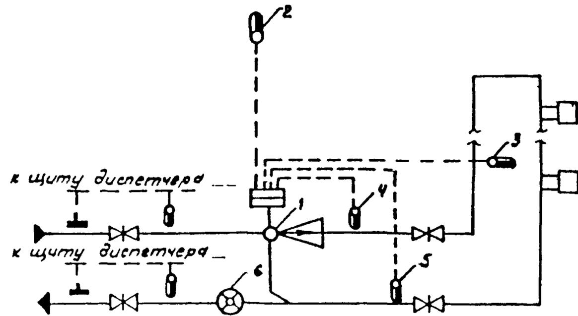
Рис. 41 Технологическая схема автоматизации систем отопления с элеватором с регулируемым сечением сошла
