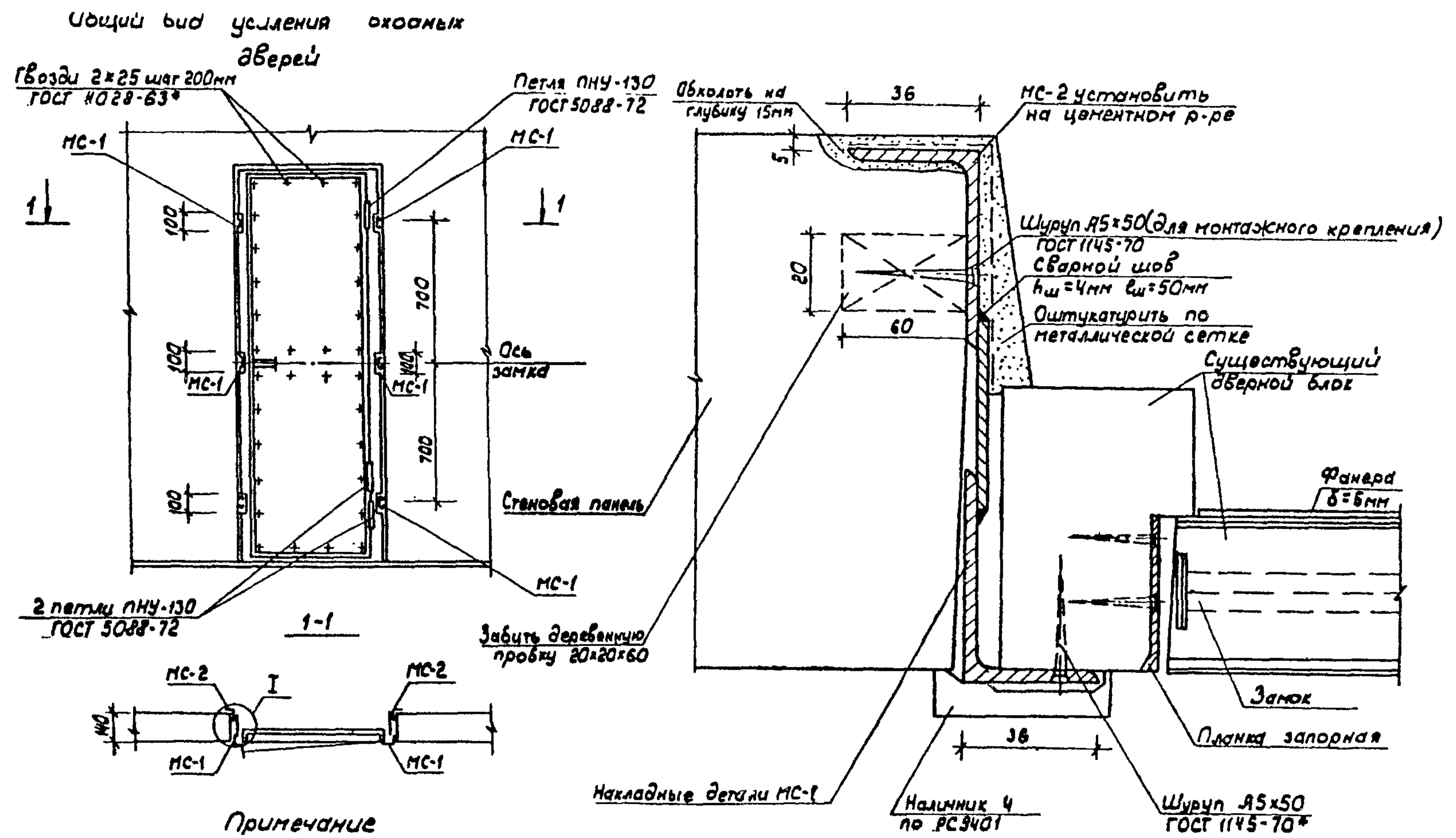
1. Конструктивное решение усиления крепления существующих обернок блоков разработано из условия приводства работ без снятия обернок блоков.
