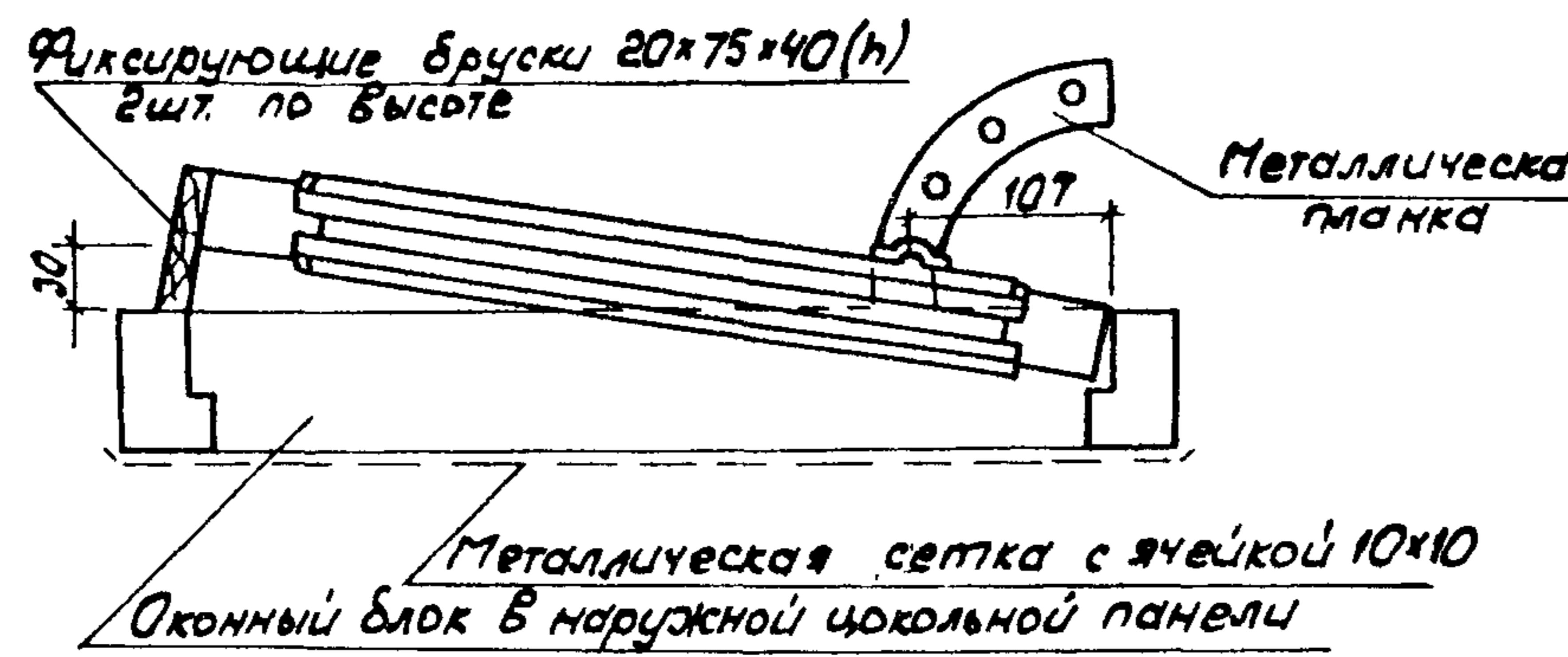
Металлический фиксатор со скобой
