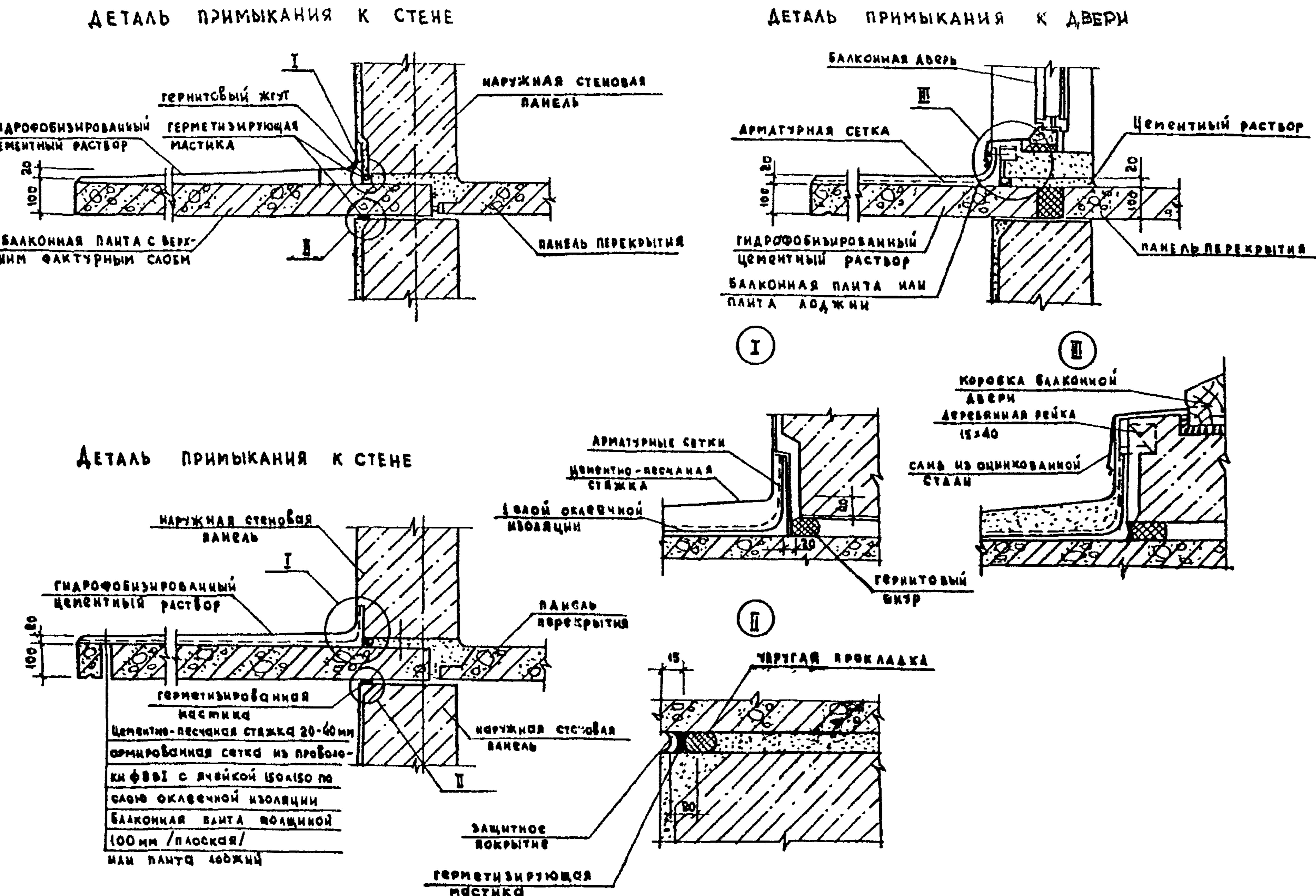
Рис. 10. Детали ремонта балконов и лоджий
