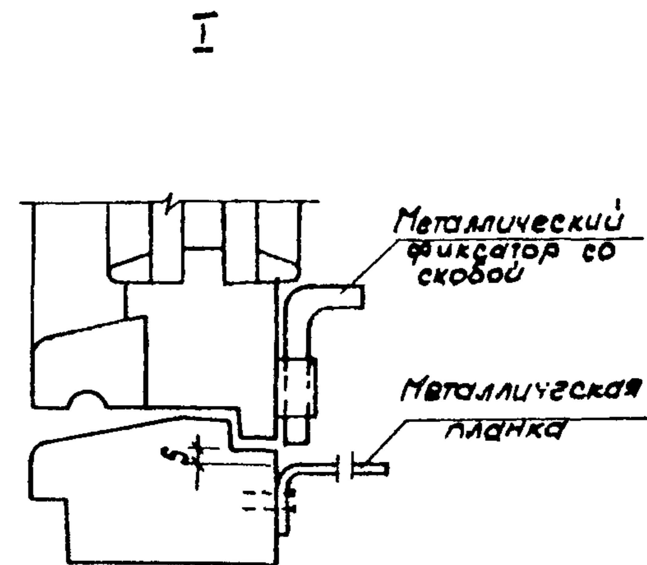
Рис. 2 Узлы устройства предуха для вентиляции подполья.
