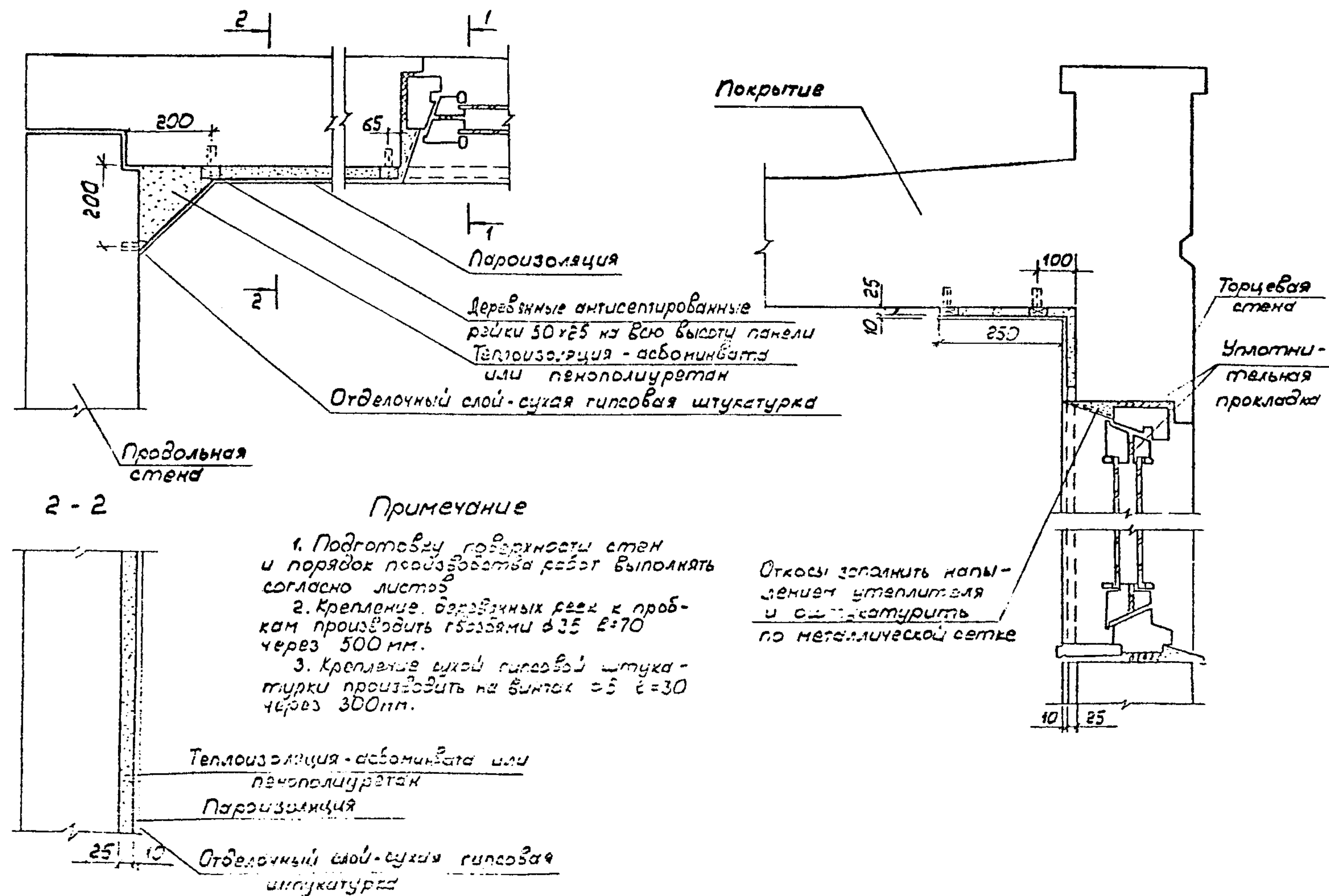
Рис. 6. Угепление промерзающих конструкций изнутри помещения.
