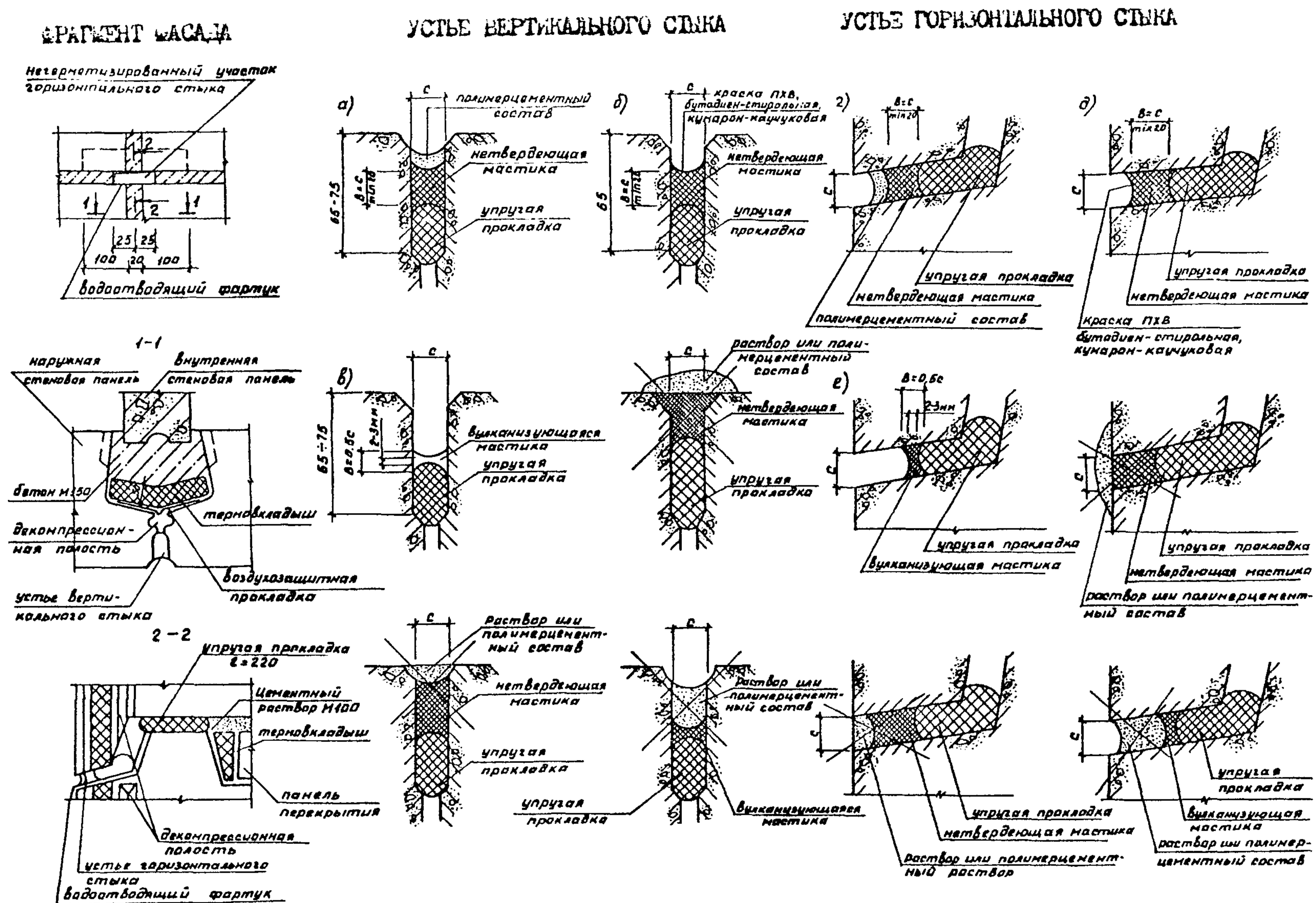
Рис. 12. Герметизация стыков панелей наружных стен.
