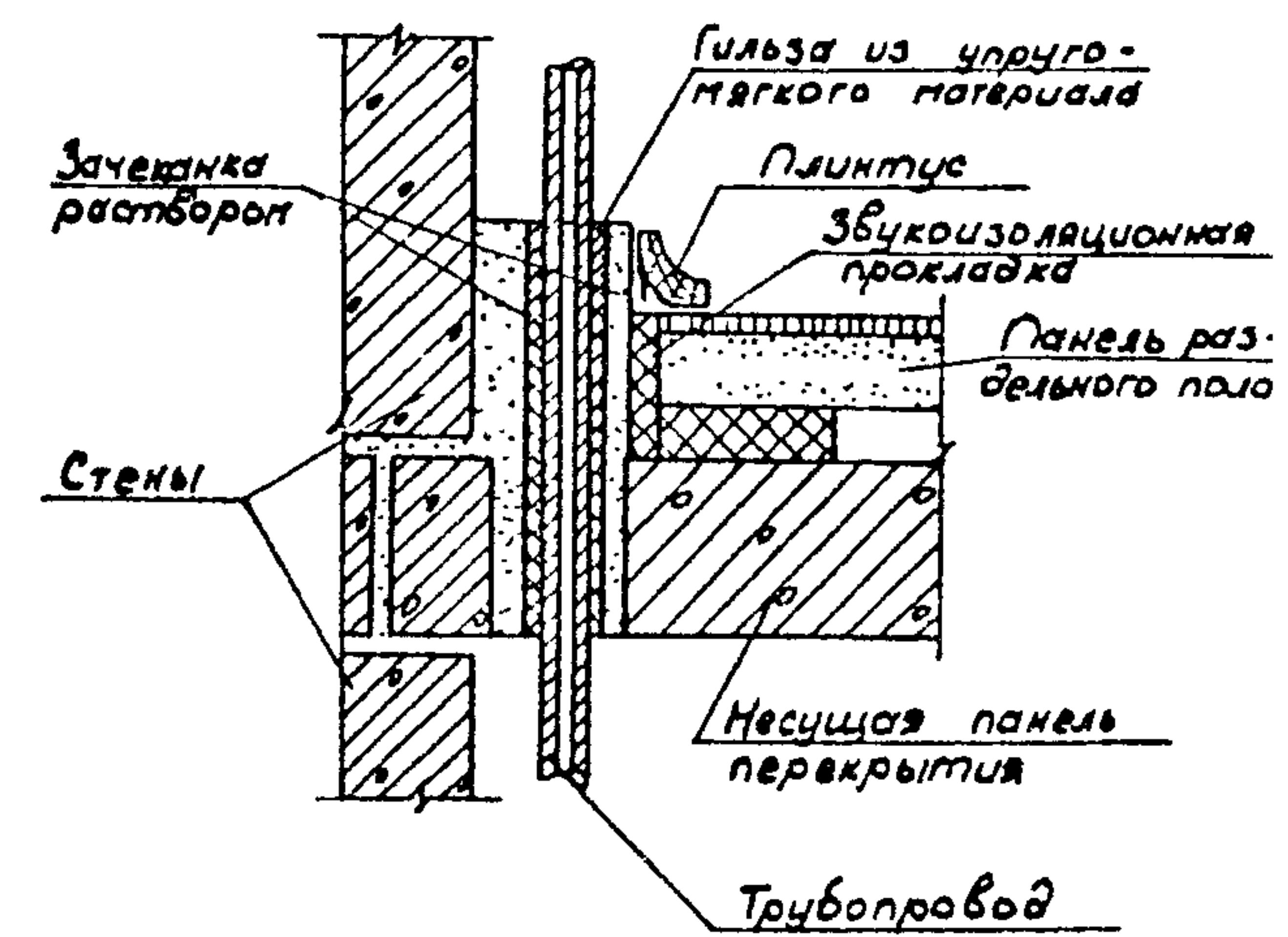
Рис. 23. Детали полов при панелях перекрытия толщиной 100 мм
