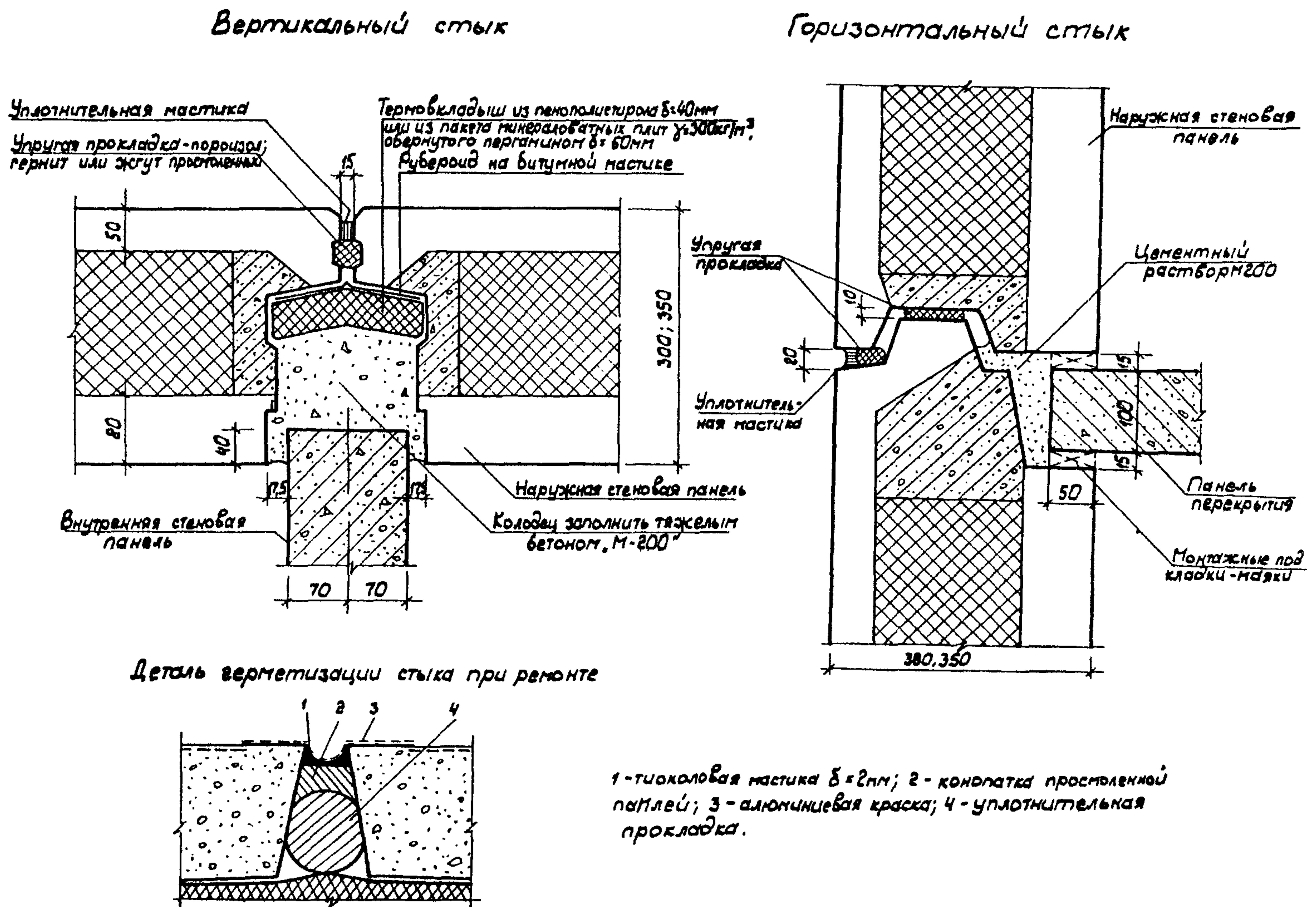
Рис. 11. Герметизация стыков.
