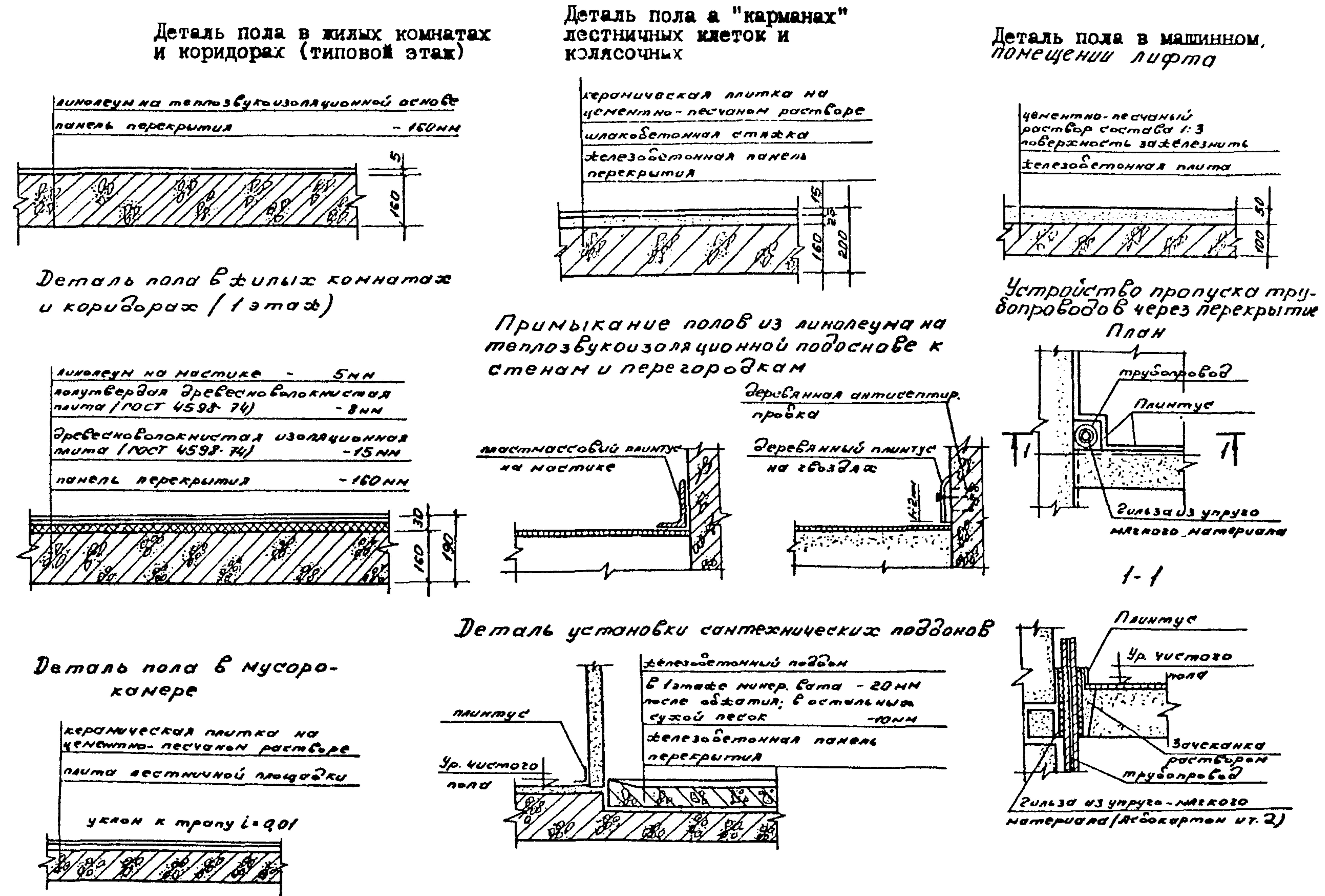
Рис. 25. Детали полов при панелях перекрытия толщиной 160 мм.
