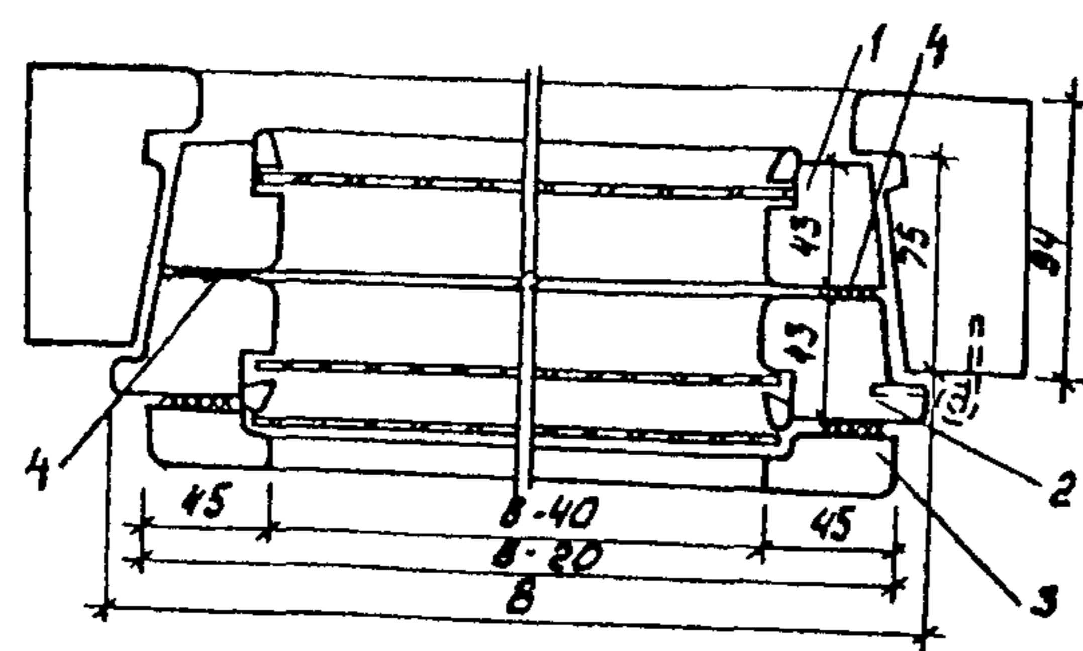
**Установка дополнительной створки на внутреннем переплете**
