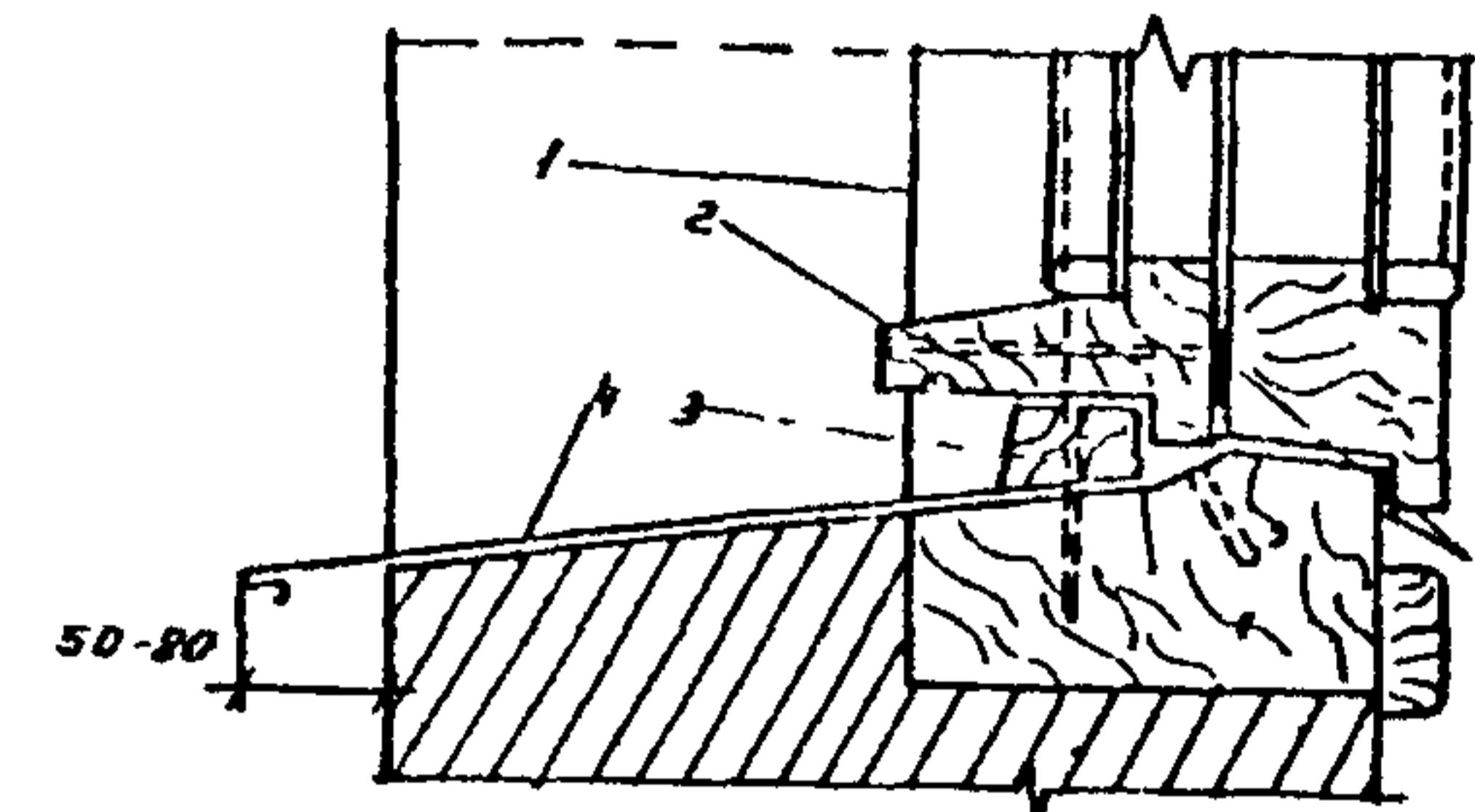
1 трещина между коробкой и стеной заделывается
