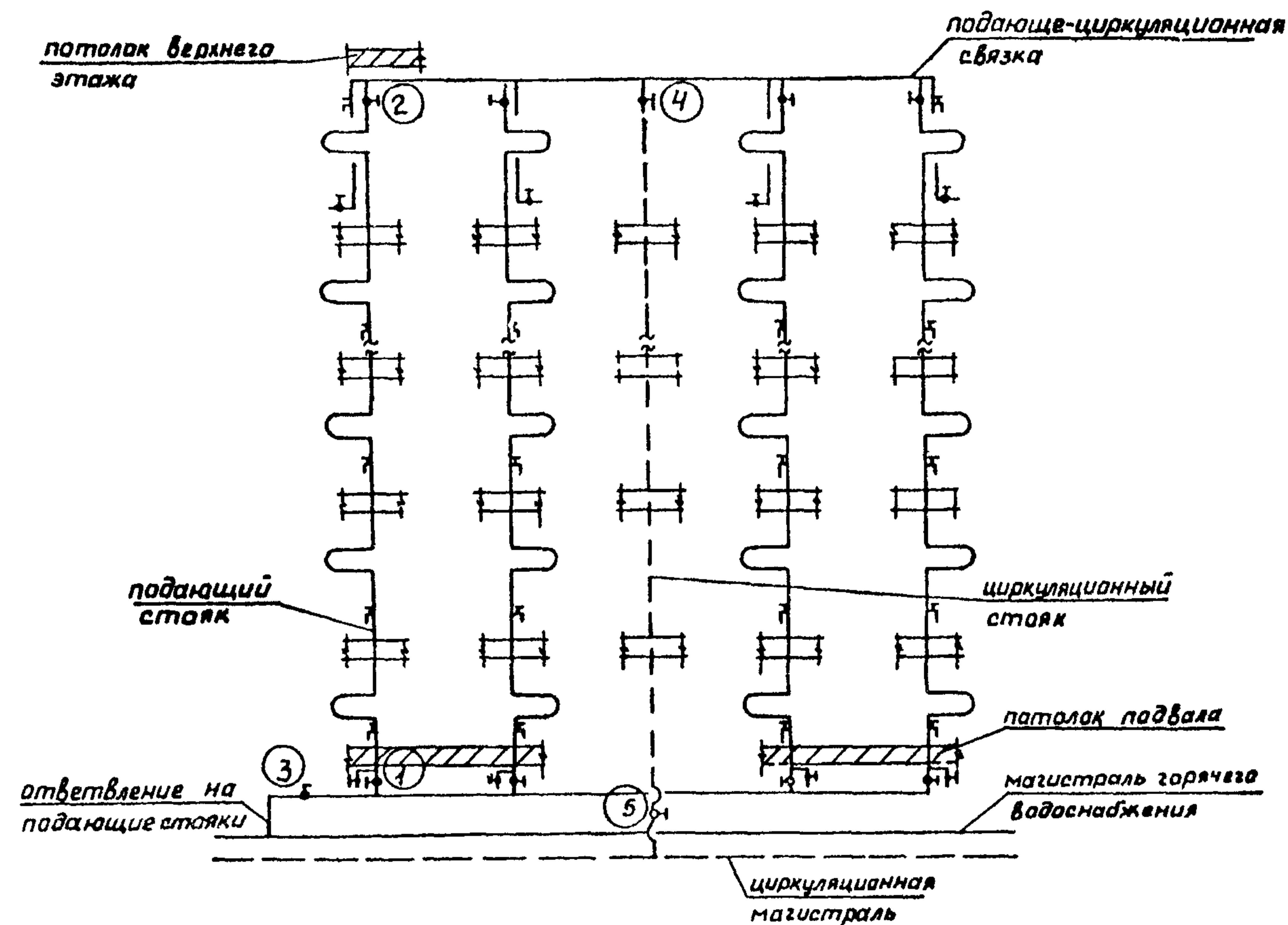
Рис. 27. образец выполнения принципиальной схемы секционного узла системы горячего водоснабжения.
