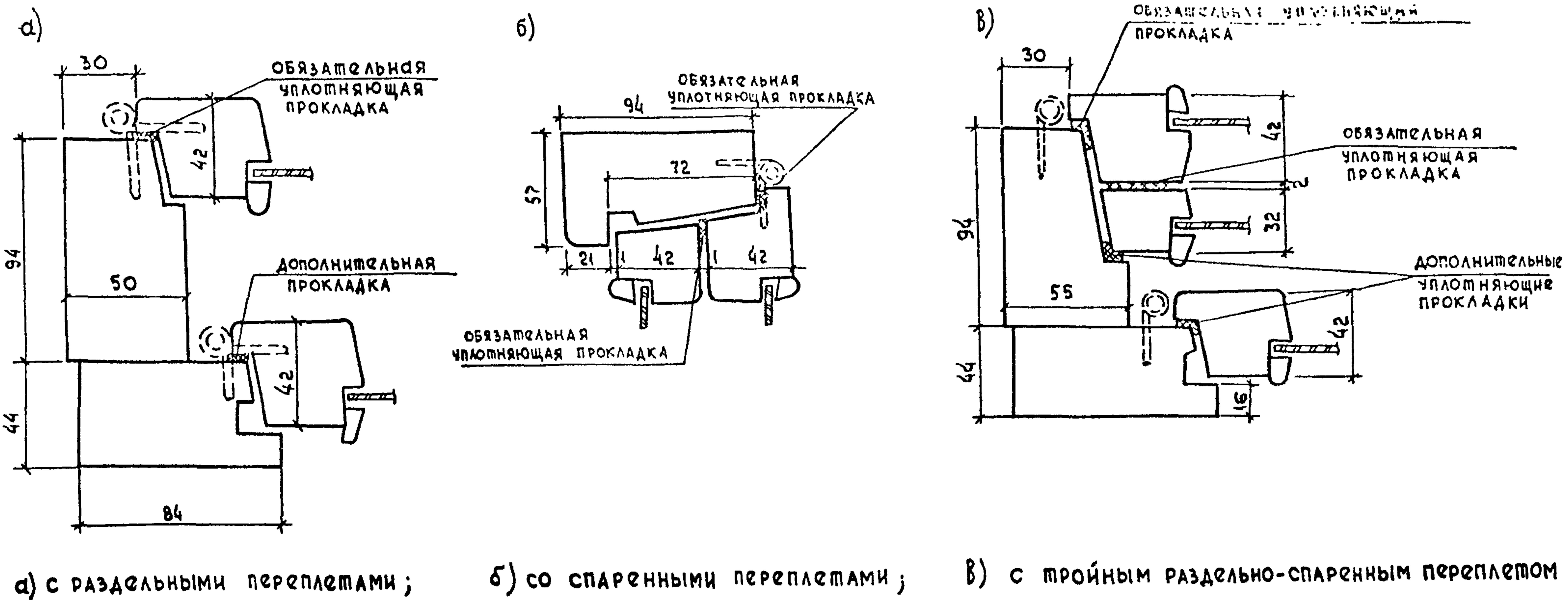
Рис. 15. Установка уплотняющих прокладок в окнах с наплавом.
