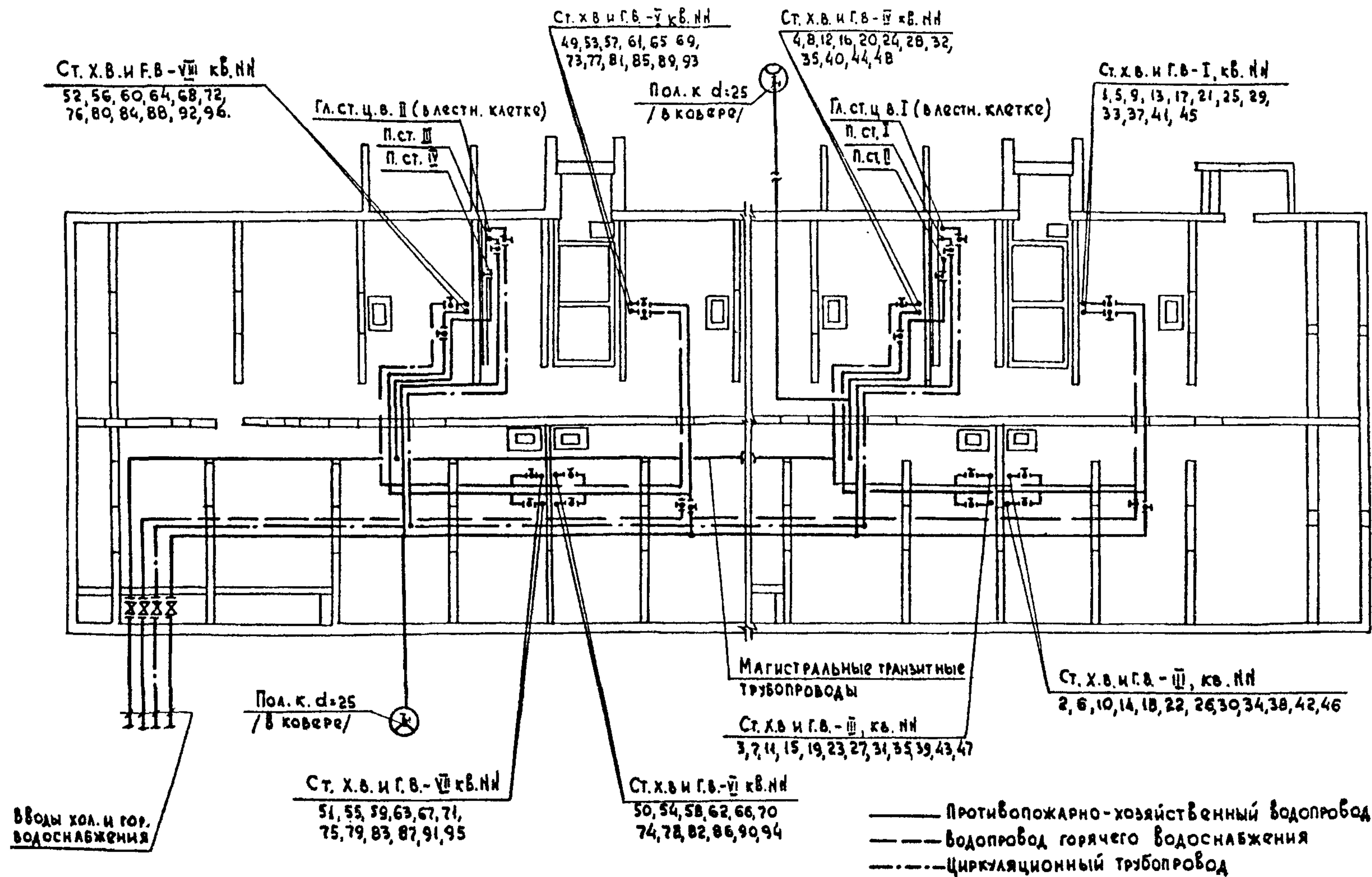
Рис. 26. Образец выполнения плана технического подполья.
