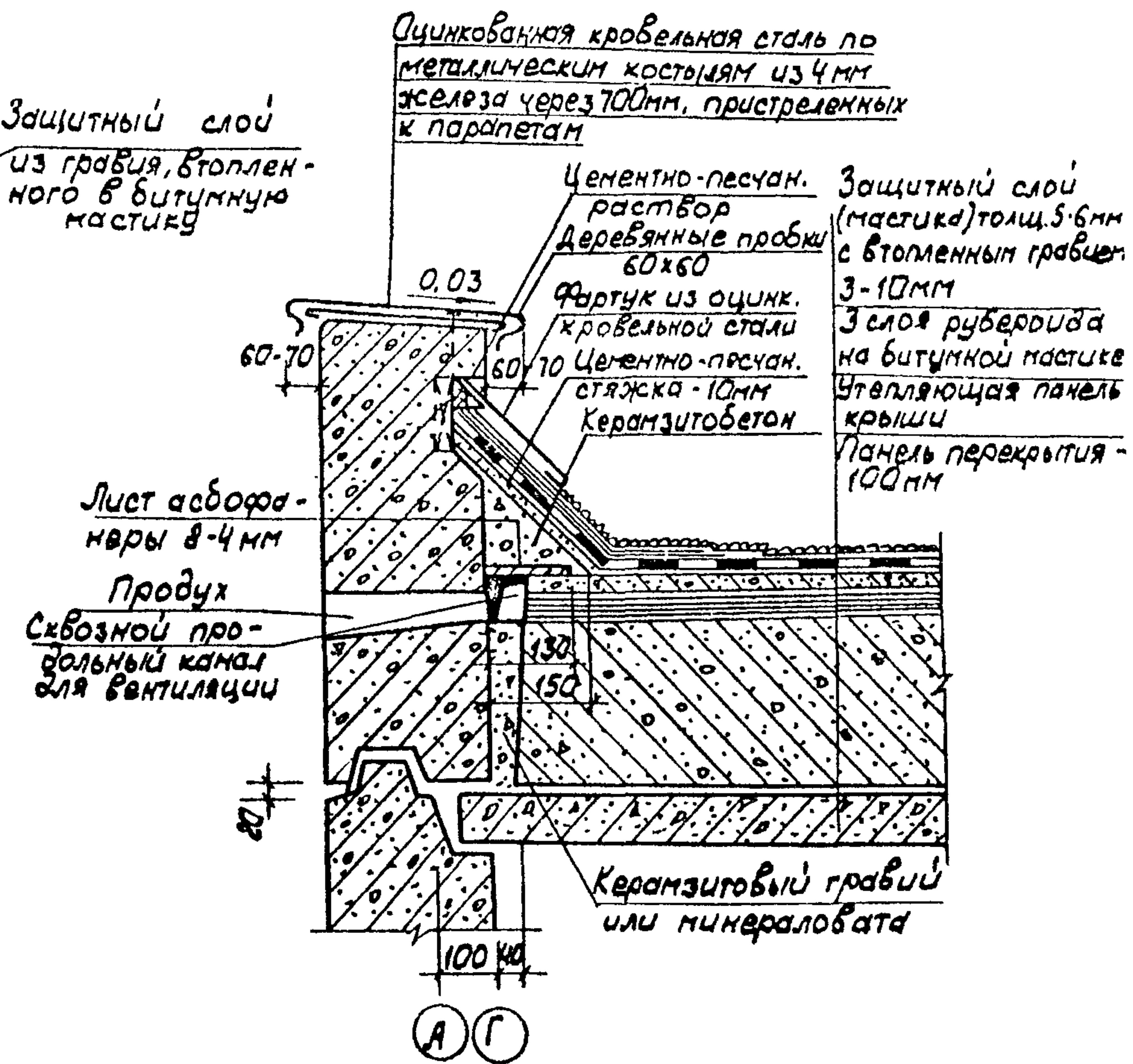
Рис. 19. Детали кровли.
