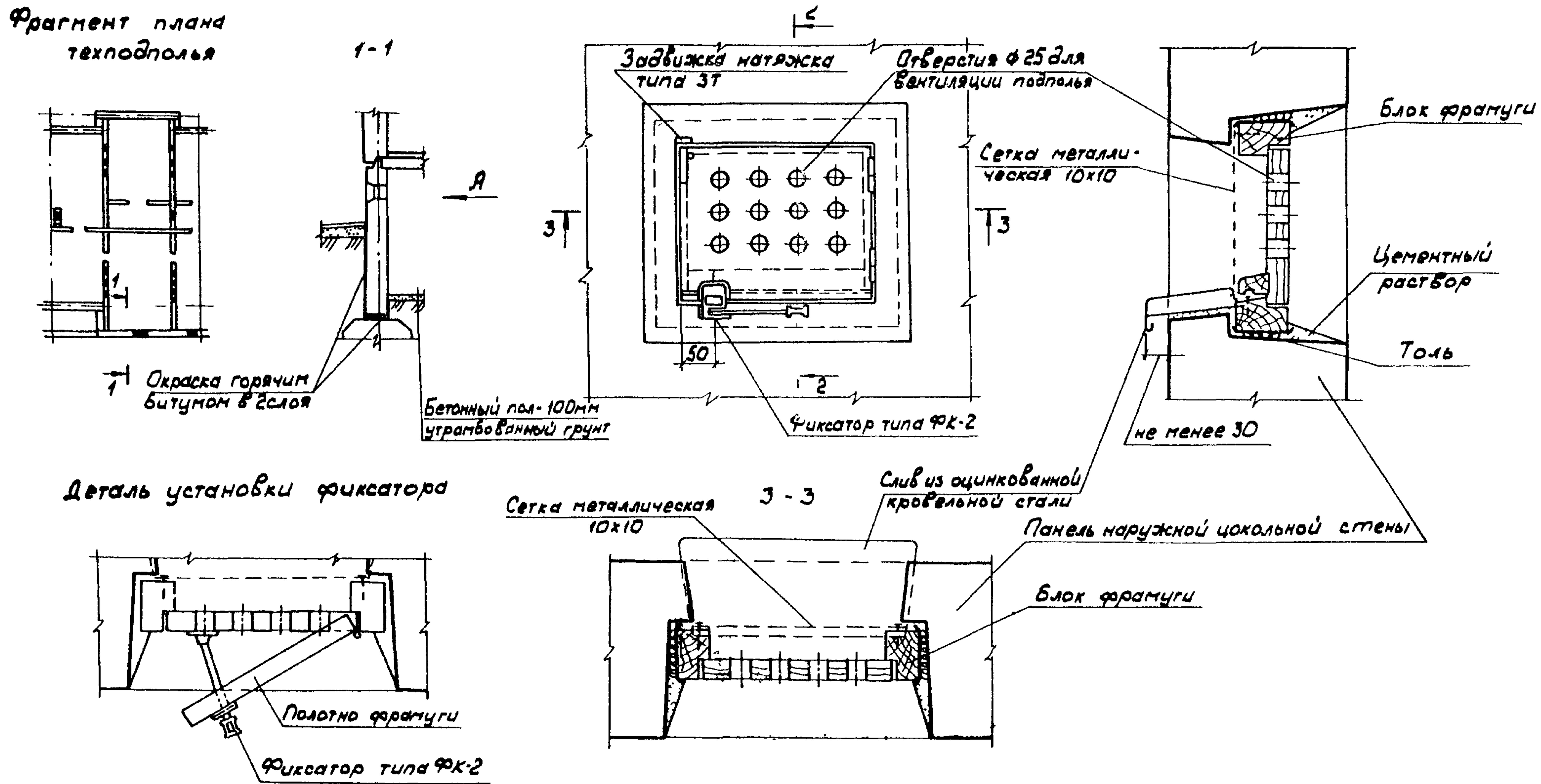
Рис. 1. Узлы устройства продуха для вентиляции подполья
