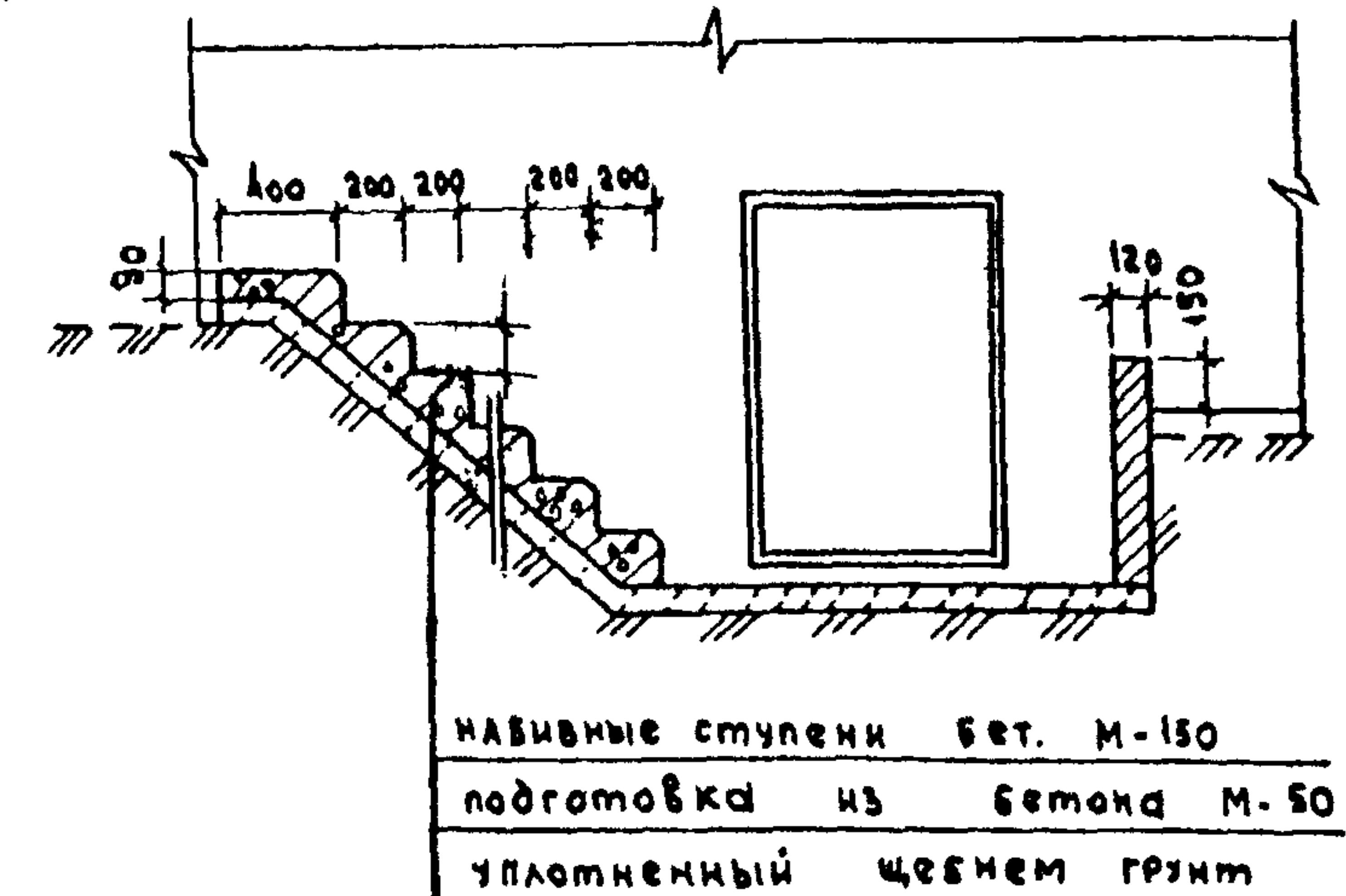
Рис. 3. Деталь устройства прохода технического подполья.
