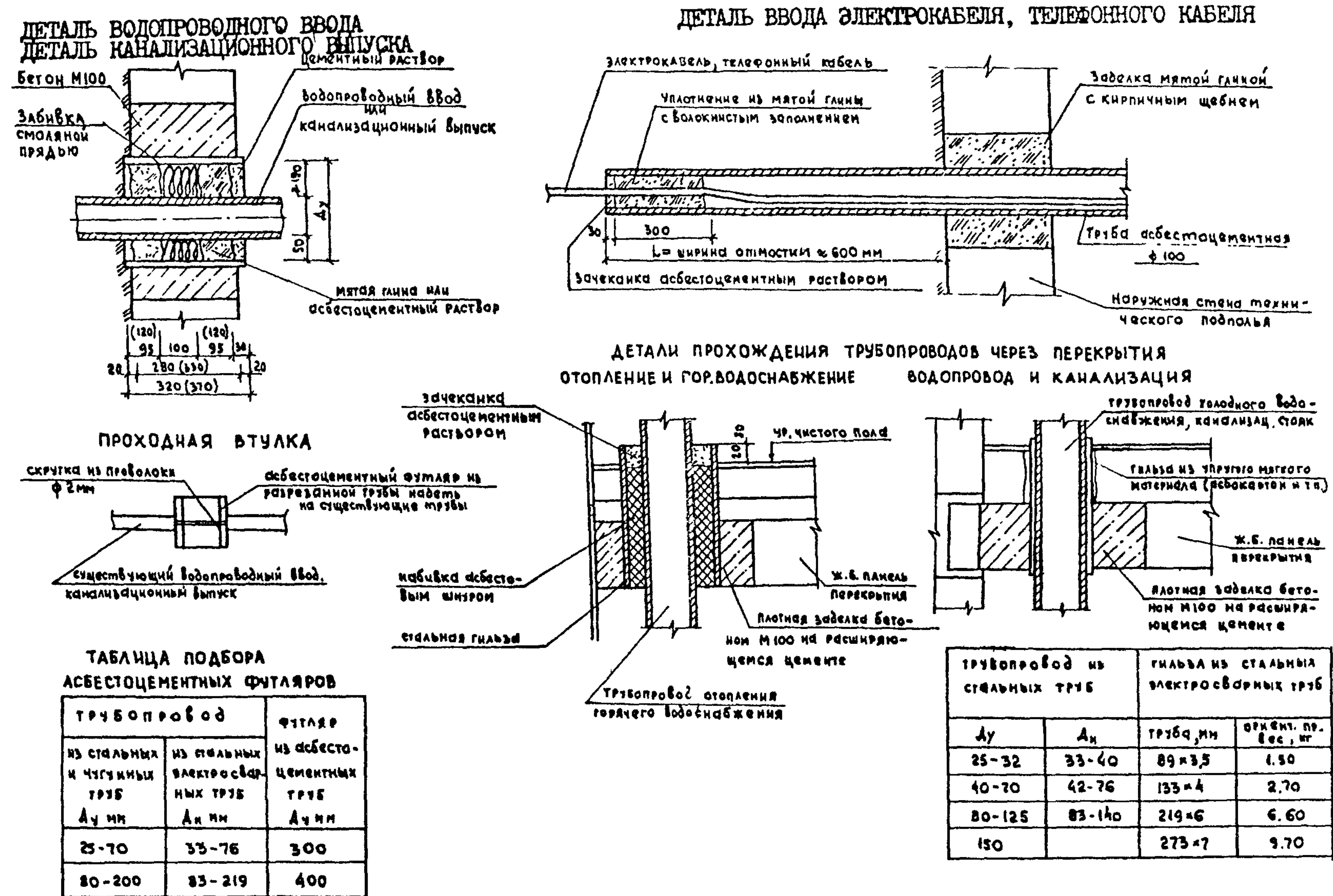
Рис. 5. Детали ввода водопровода, электро и телефонного кабелей, канализационного выпуска, прохождения трубопровода через перекрытия.
