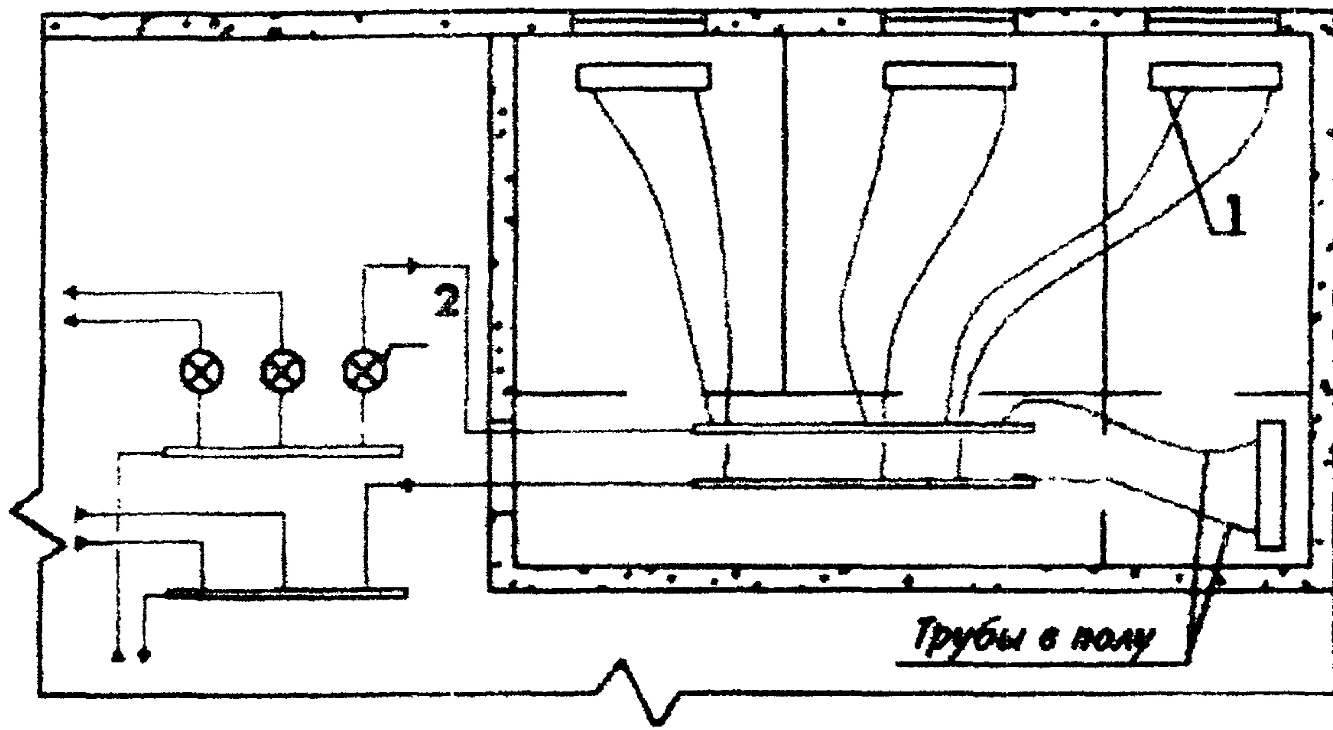
Схема 1. Лучевая схема системы отопления
