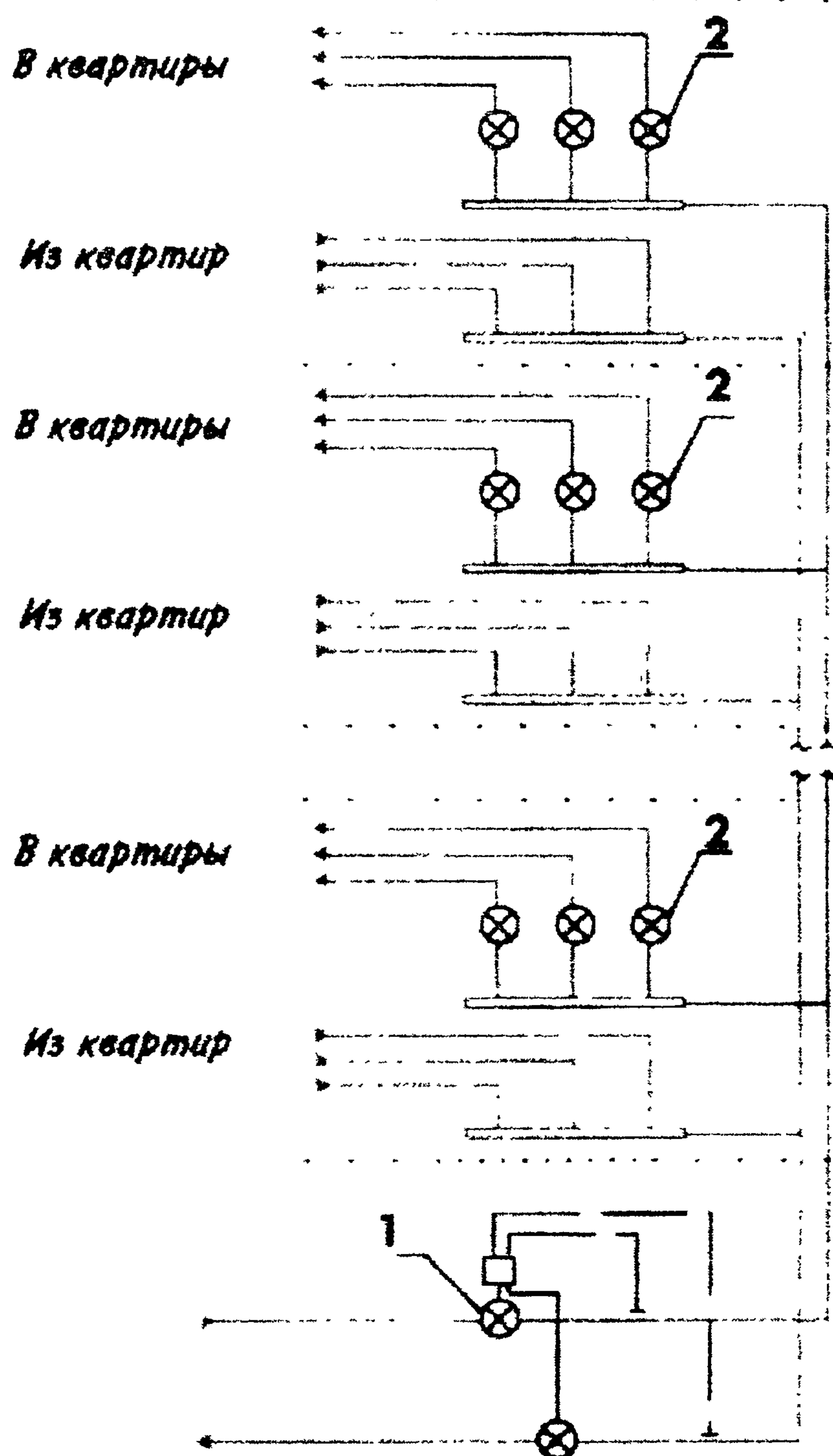
Схема 3. Схема поквартирного учета тепла
