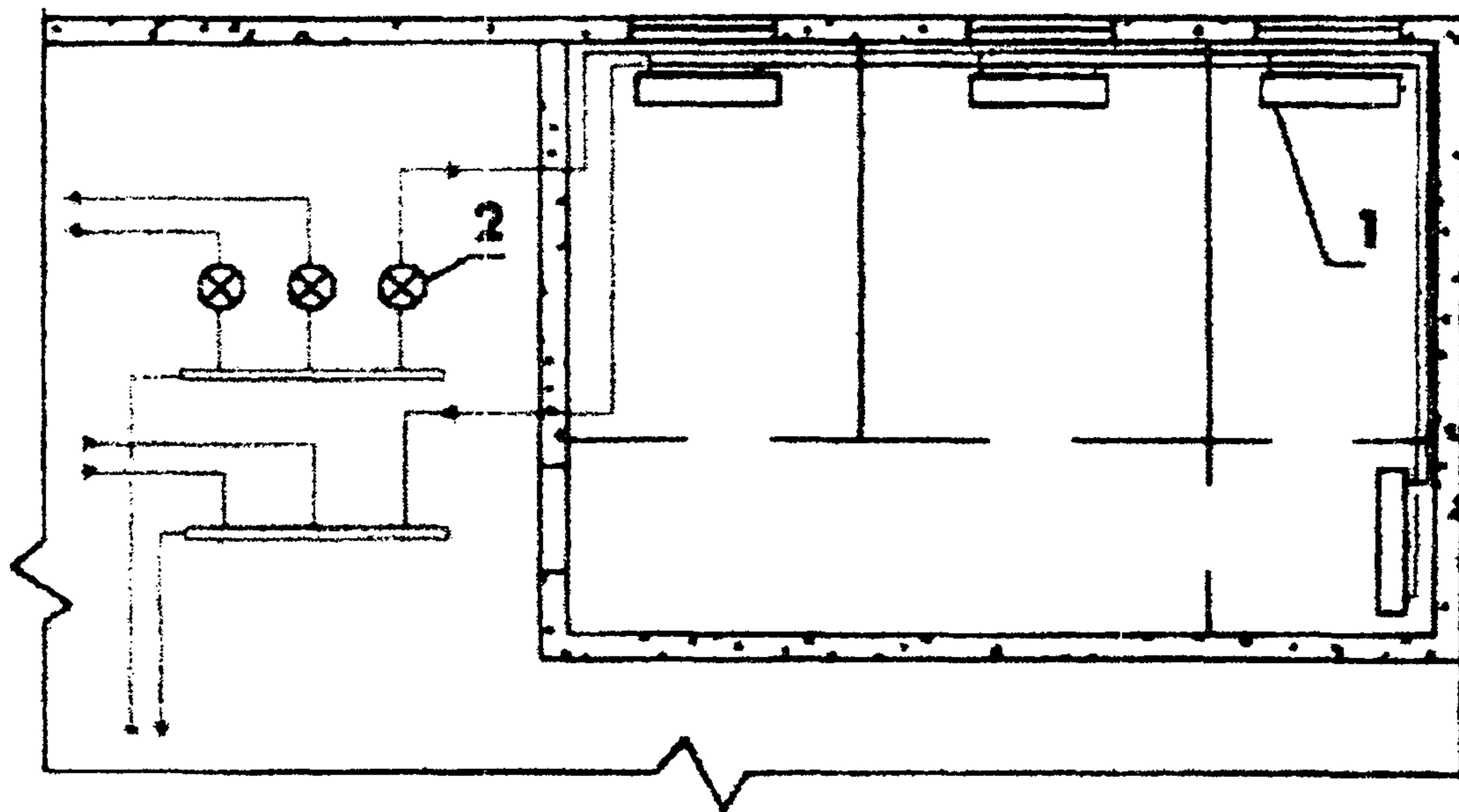
Схема 1. Периметральная схема системы отопления
