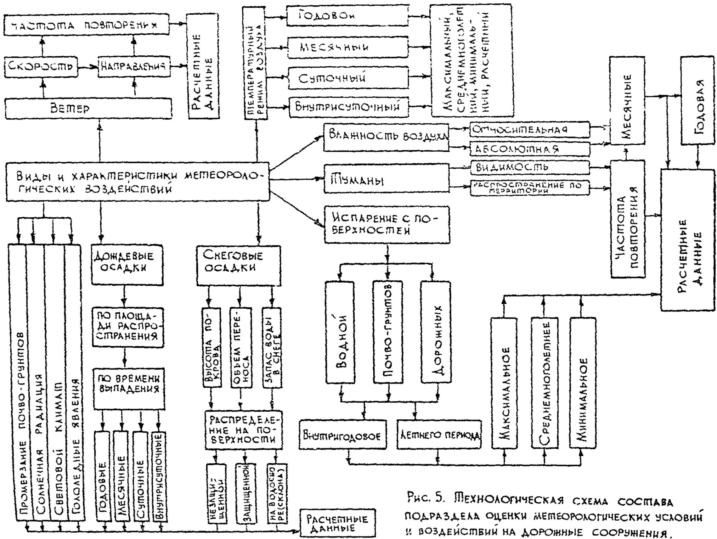
Рис. 5. Технологическая схема состава подраздела оценки метеорологических условий и воздействий на дорожные сооружения.
