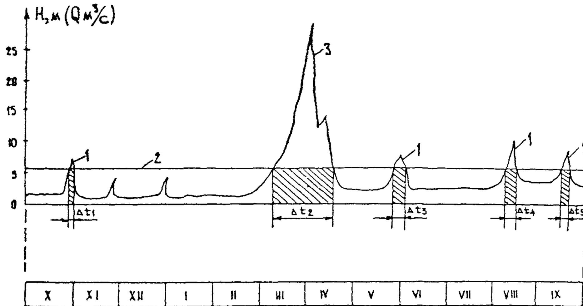
Рис. 14. Схема гидрографа к определению суммарной длительности стояния воды при рабочем уровне во внепаводочный период: 1 - поднятие уровней воды во внепаводочный период; 2 - рабочий уровень воды, заданный ВП; 3 - гидрограф паводка;  $\Delta t_1, \Delta t_2, \Delta t_3, \Delta t_4, \Delta t_5$  - длительность стояния от во внепаводочном периоде.
