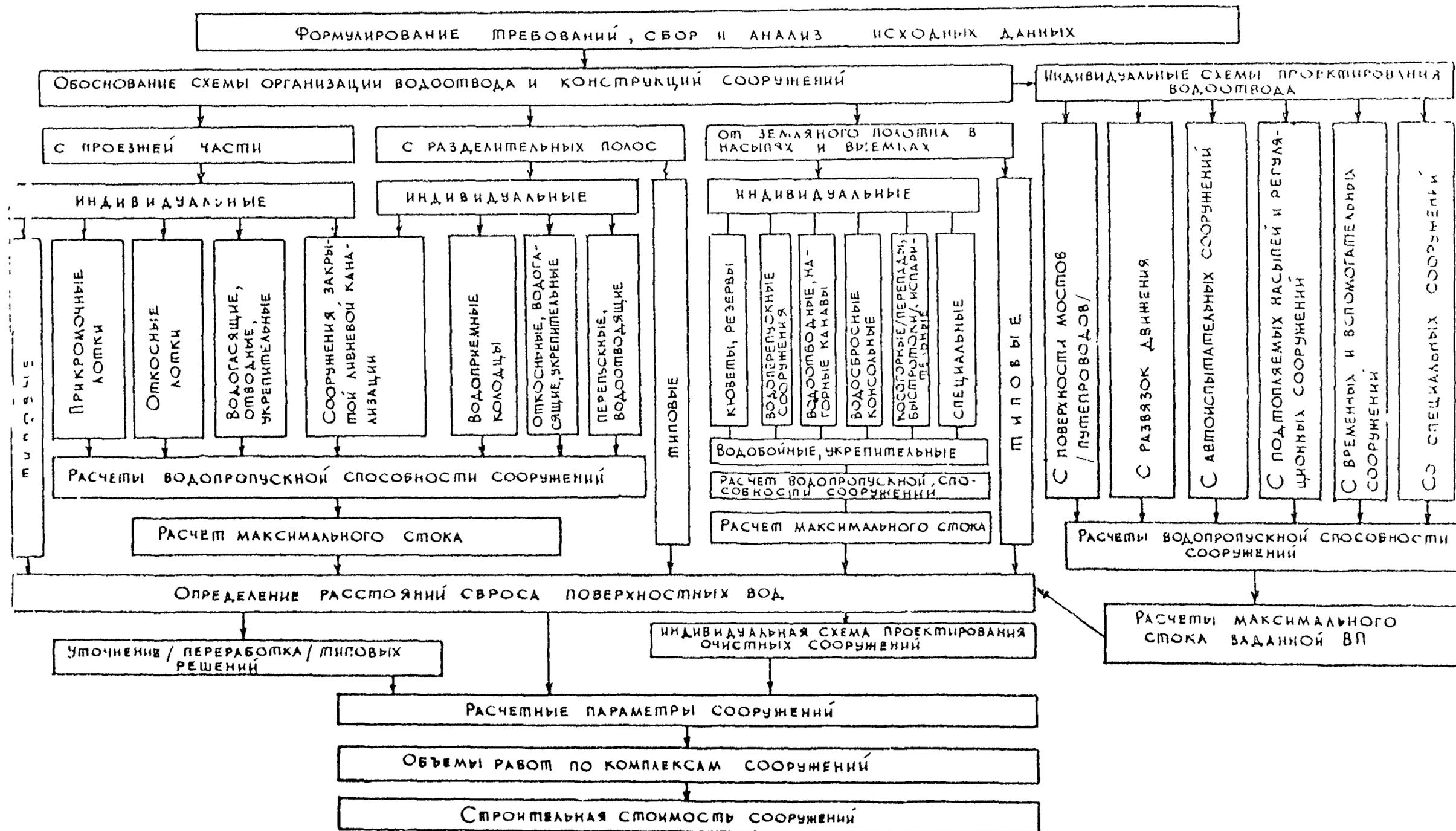
Рис 10 Технологическая схема раздела IV автоматизированного проектирования водоотвода.
