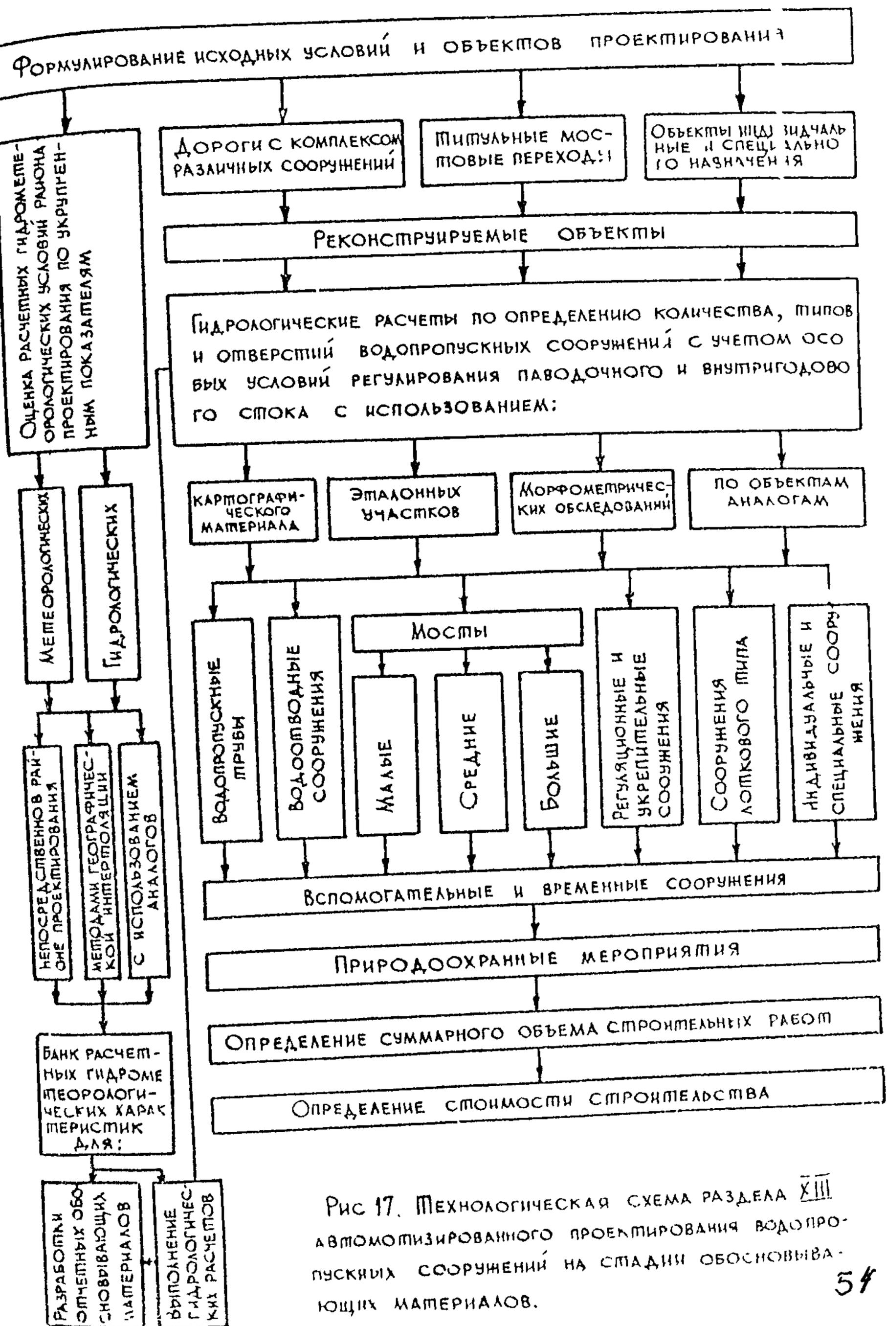
Рис 17. Технологическая схема раздела XIII автоматизированного проектирования водопропускных сооружений на стадии обосновывающих материалов.
