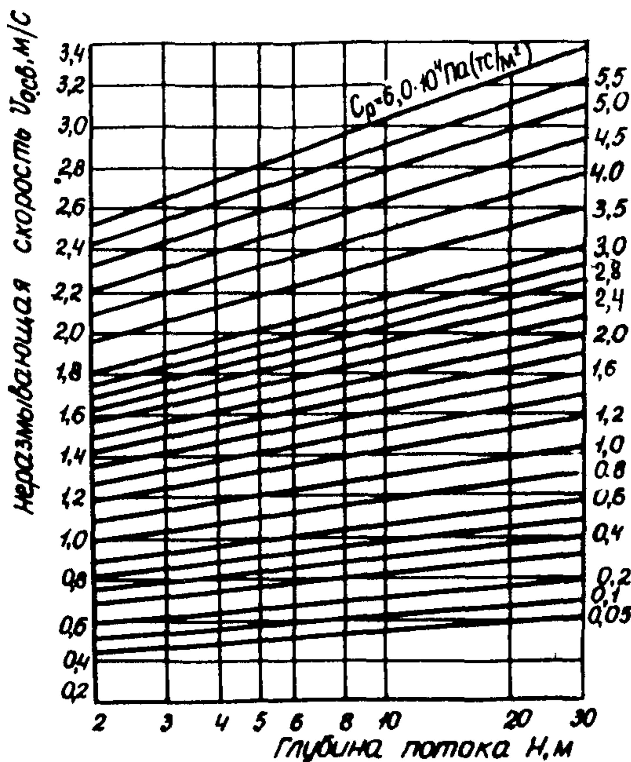
Рис.6. График для определения неразмывающей скорости  $U_{0.\text{сб}}$  связных грунтов при  $\varepsilon = 1,4$
