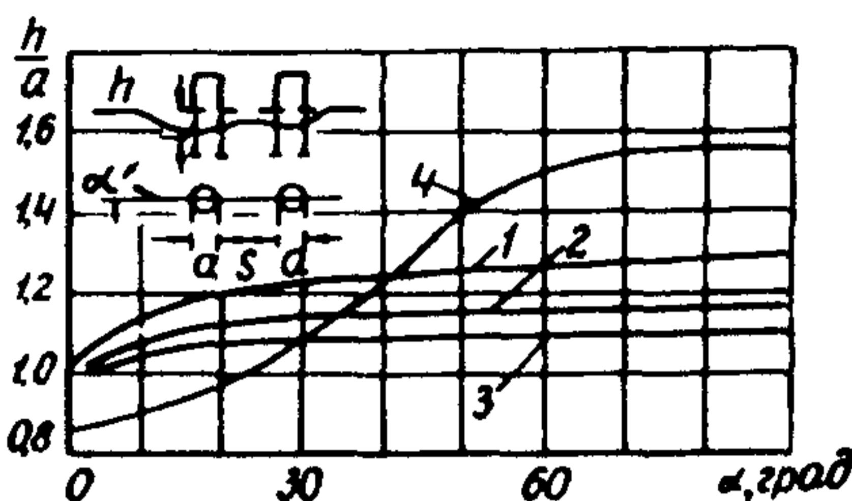
Рис.5. Изменение относительной глубины размыва  $h/a$  в зависимости от косинуса потока для свай-оболочек: 1 -  $S/a = 0,5 + 1,0$ ; 2 -  $S/a = 2,0$ ; 3 -  $S/a = 3,0$ ; 4 -  $S/a = 0$
