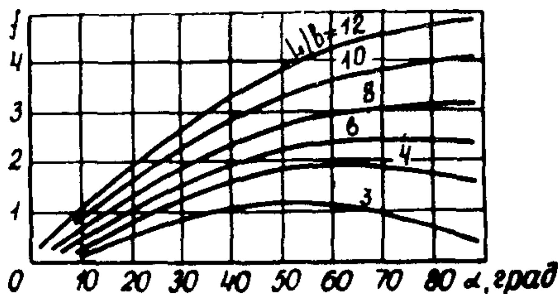
Рис.5. График для определения коэффициента  $f$  в формуле коэффициента косинуса  $K_\alpha$
