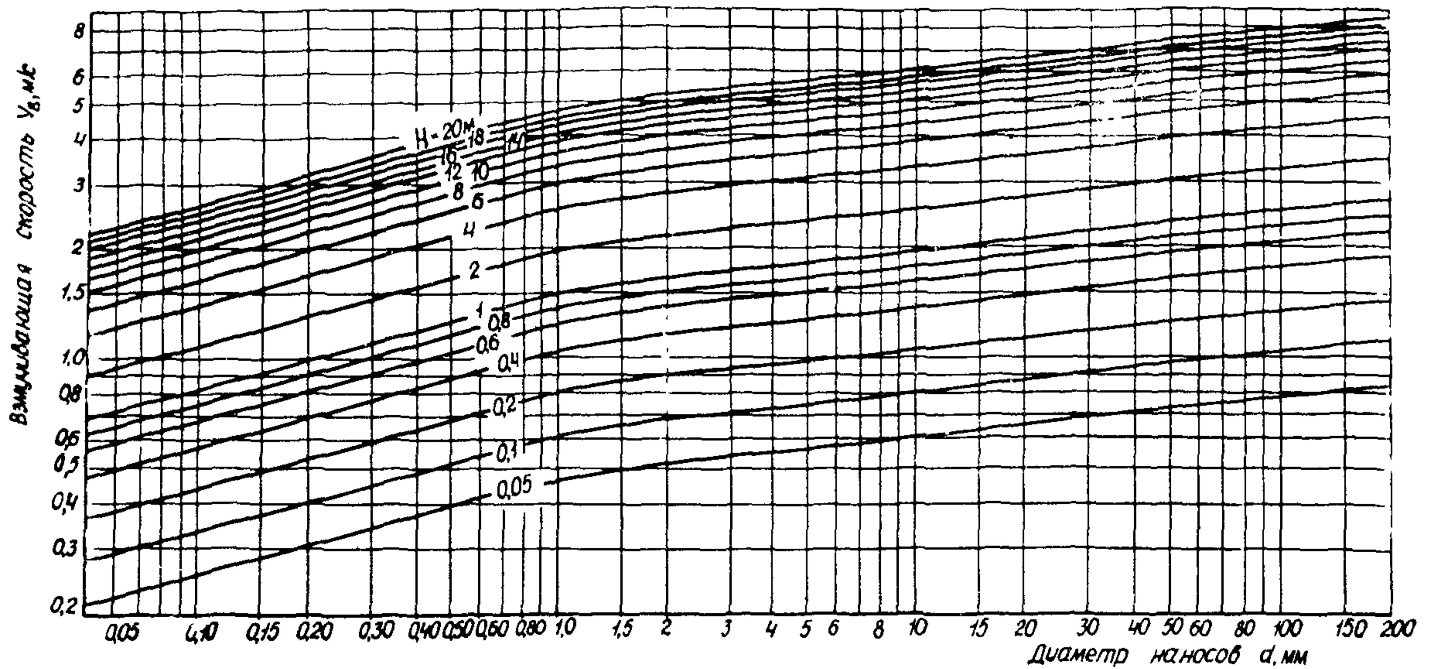
Рис.4. График для определения средней взмучивающей скорости  $V_g$  для несвязных грунтов
