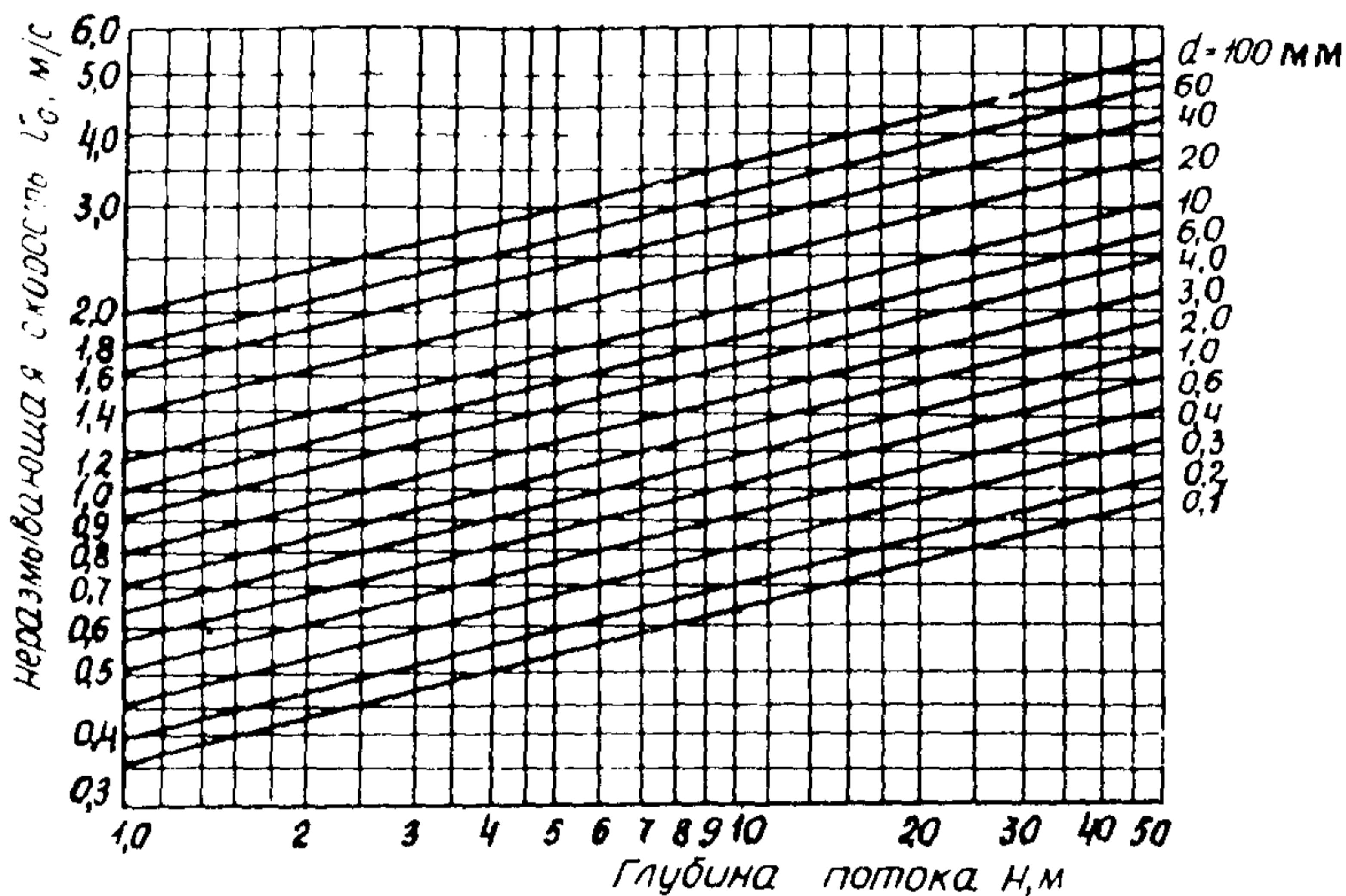
Рис. 3. График для определения неразмывающей скорости  $v_o$  для несвязных грунтов
