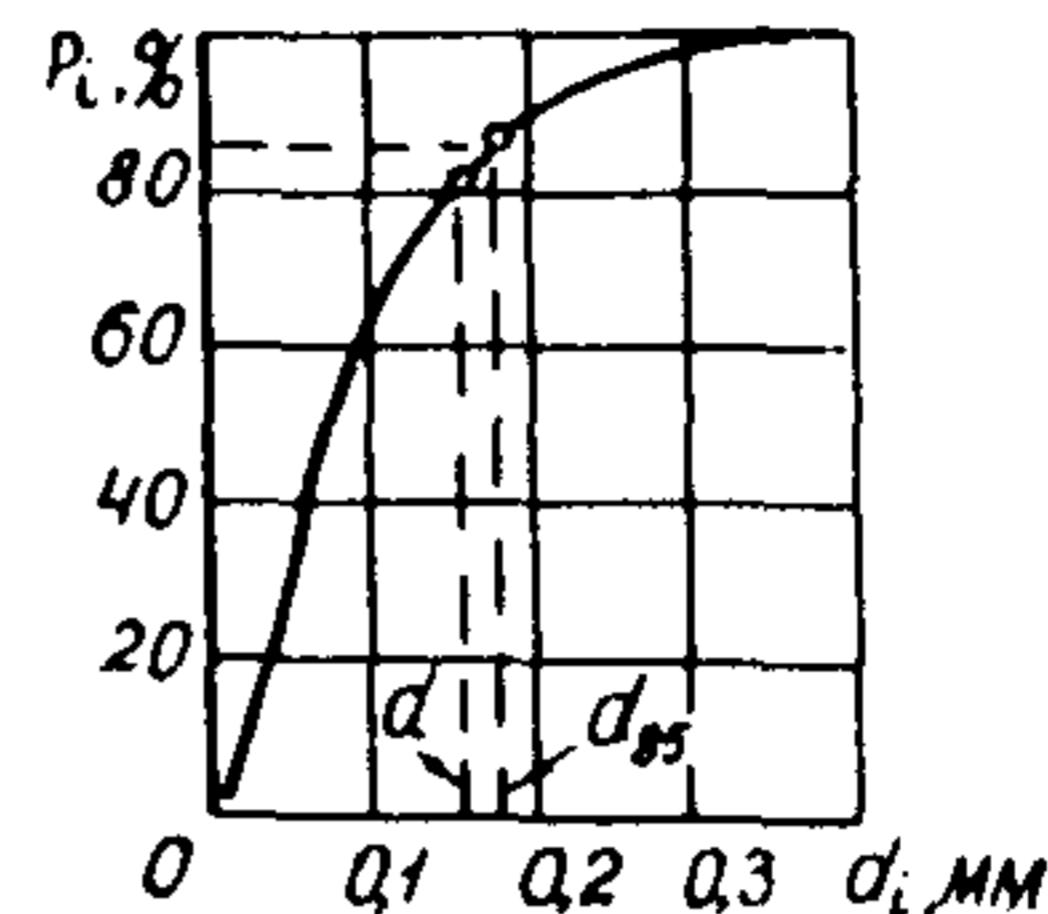
Рис. 1. График гранулометрического состава мелкого песка
