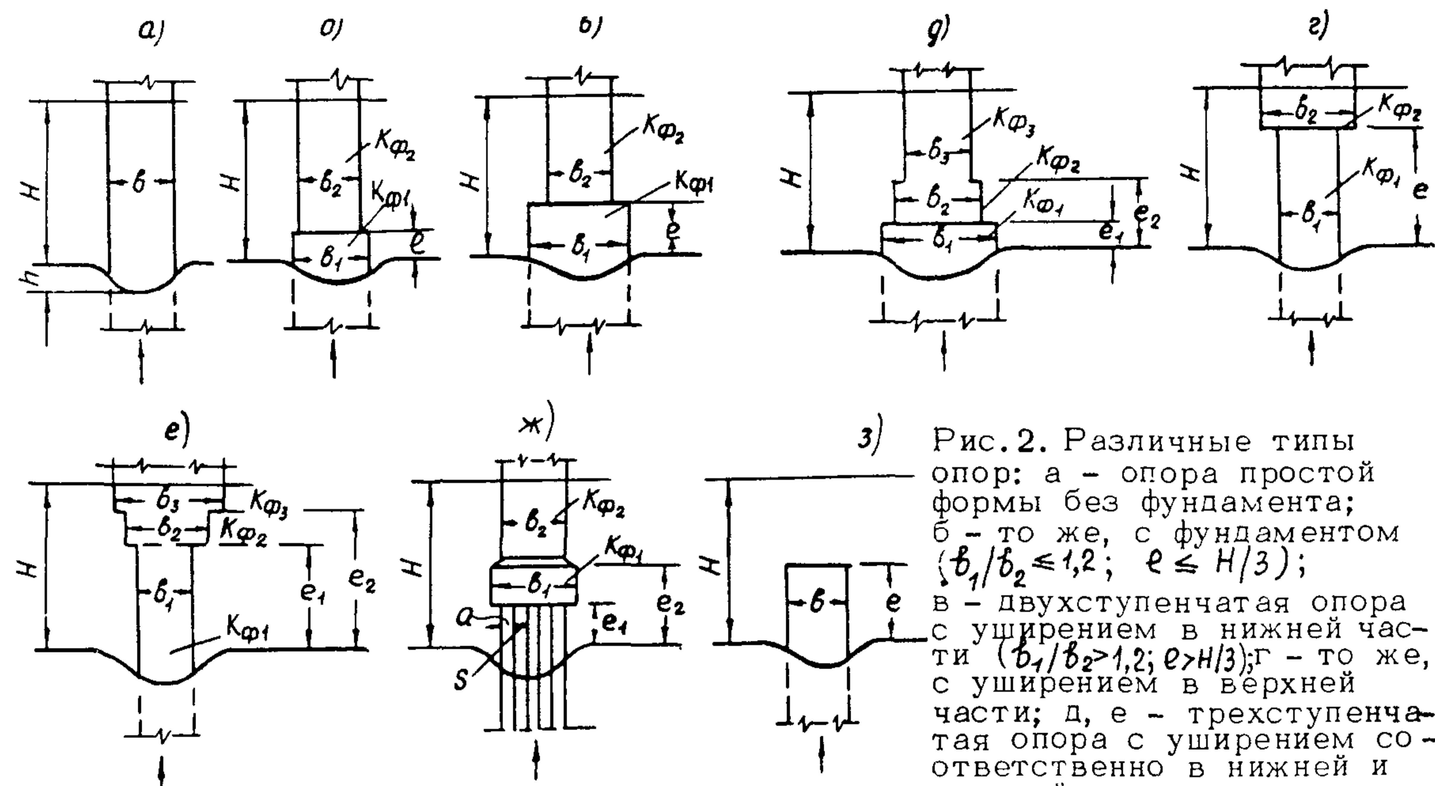
Рис. 2. Различные типы опор: а - опора простой формы без фундамента; б - то же, с фундаментом ( $b_1/b_2 \leq 1,2$ ;  $e \leq H/3$ ); в - двухступенчатая опора с уширением в нижней части ( $b_1/b_2 > 1,2$ ;  $e > H/3$ ); г - то же, с уширением в верхней части; д, е - трехступенчатая опора с уширением соответственно в нижней и верхней части; ж - опора на высоком ростверке; з - затопленная преграда
