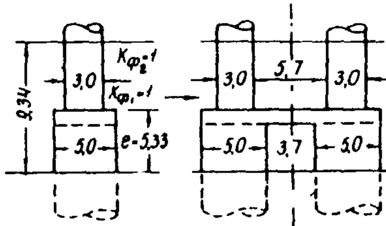
Рис.4. Схема двухстолбчатой опоры
