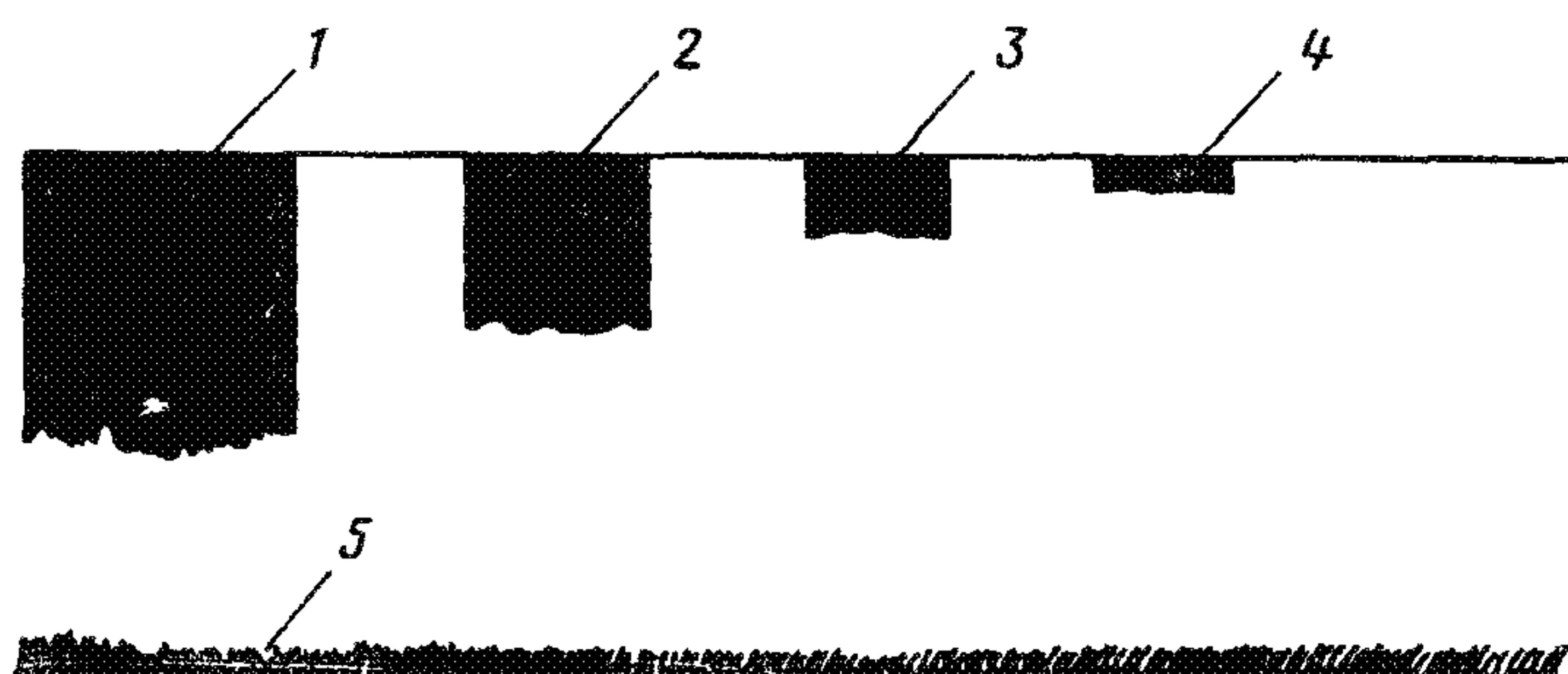
Рис. 9. Зависимость уширения начальной линии от толщины льда:
