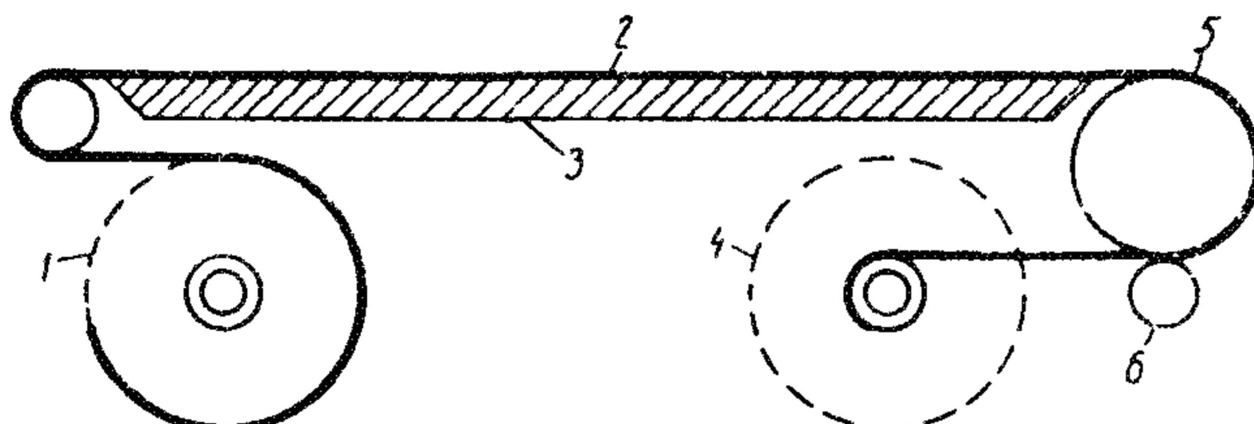
Рис. 2. Схема зарядки самописца электротермической бумагой:
