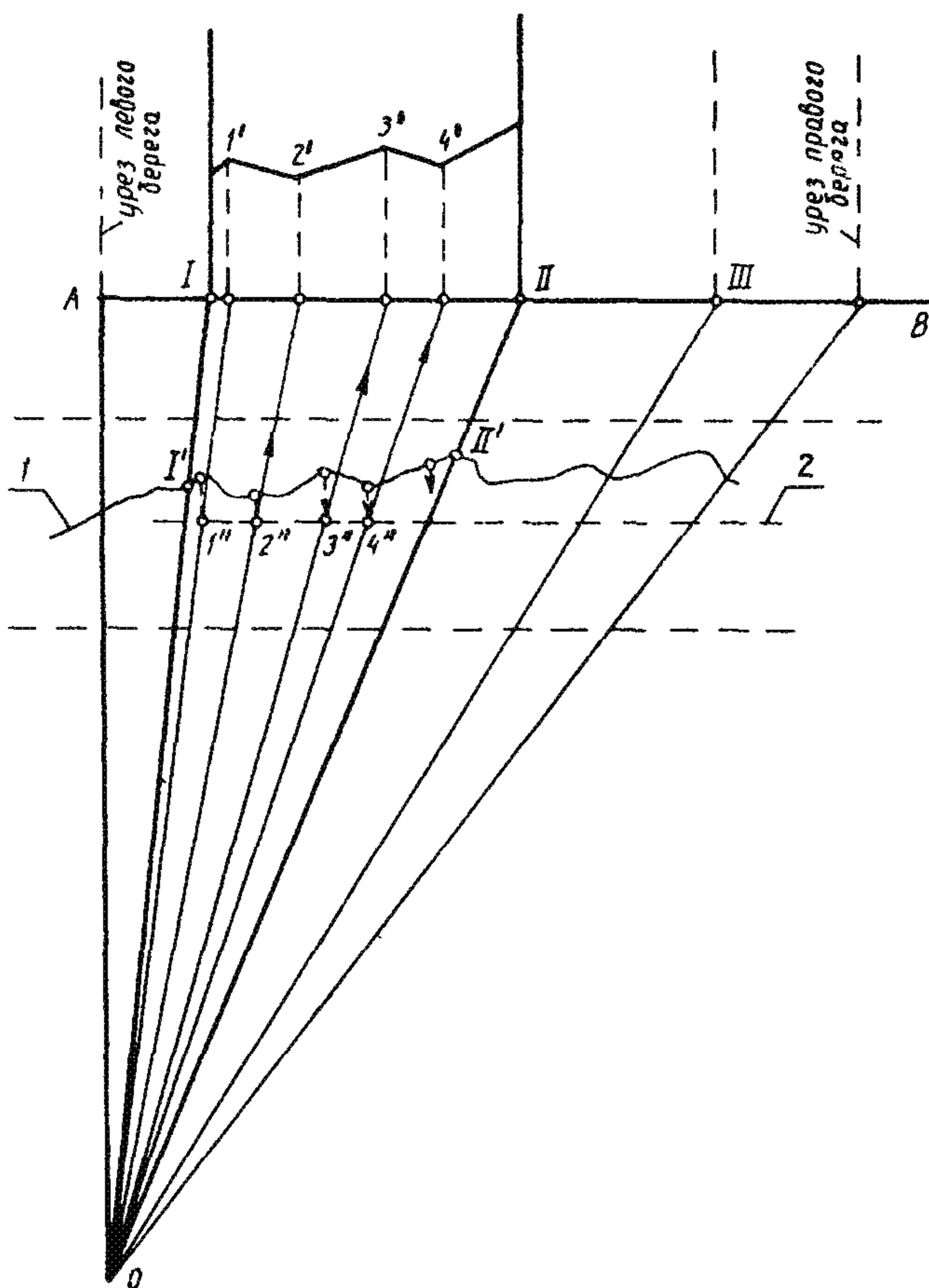
Рис. 14. Перенос отметок на план с помощью восковки:
