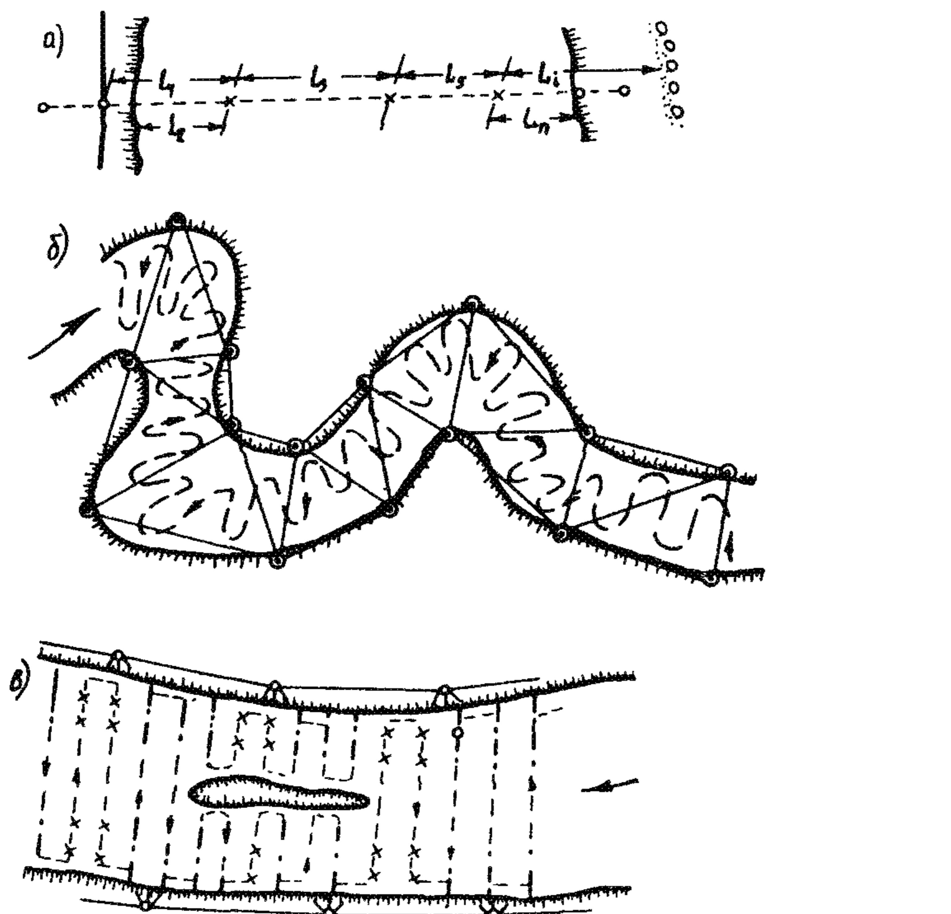
Рис. I. Схемы размещения плановой основы при про-
