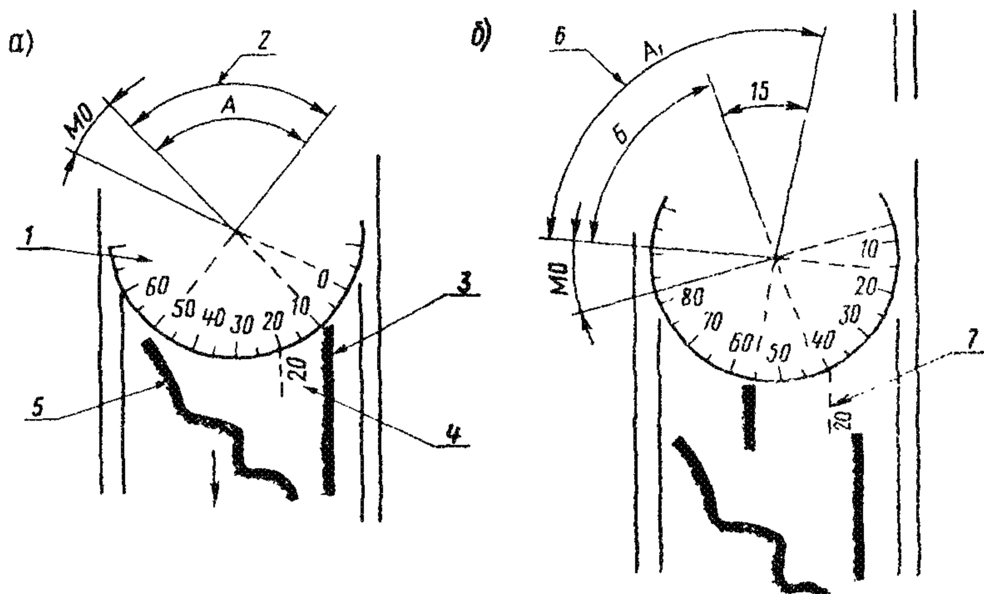
Рис. 5. Отсчеты глубин более 20 м при отсутствии на батиграмме нулевой линии:
