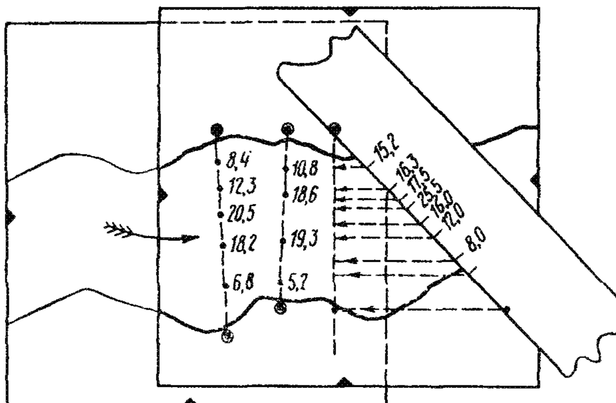
Рис. 8. Перенос отметок глубин с батиграммы на аэроснимок
