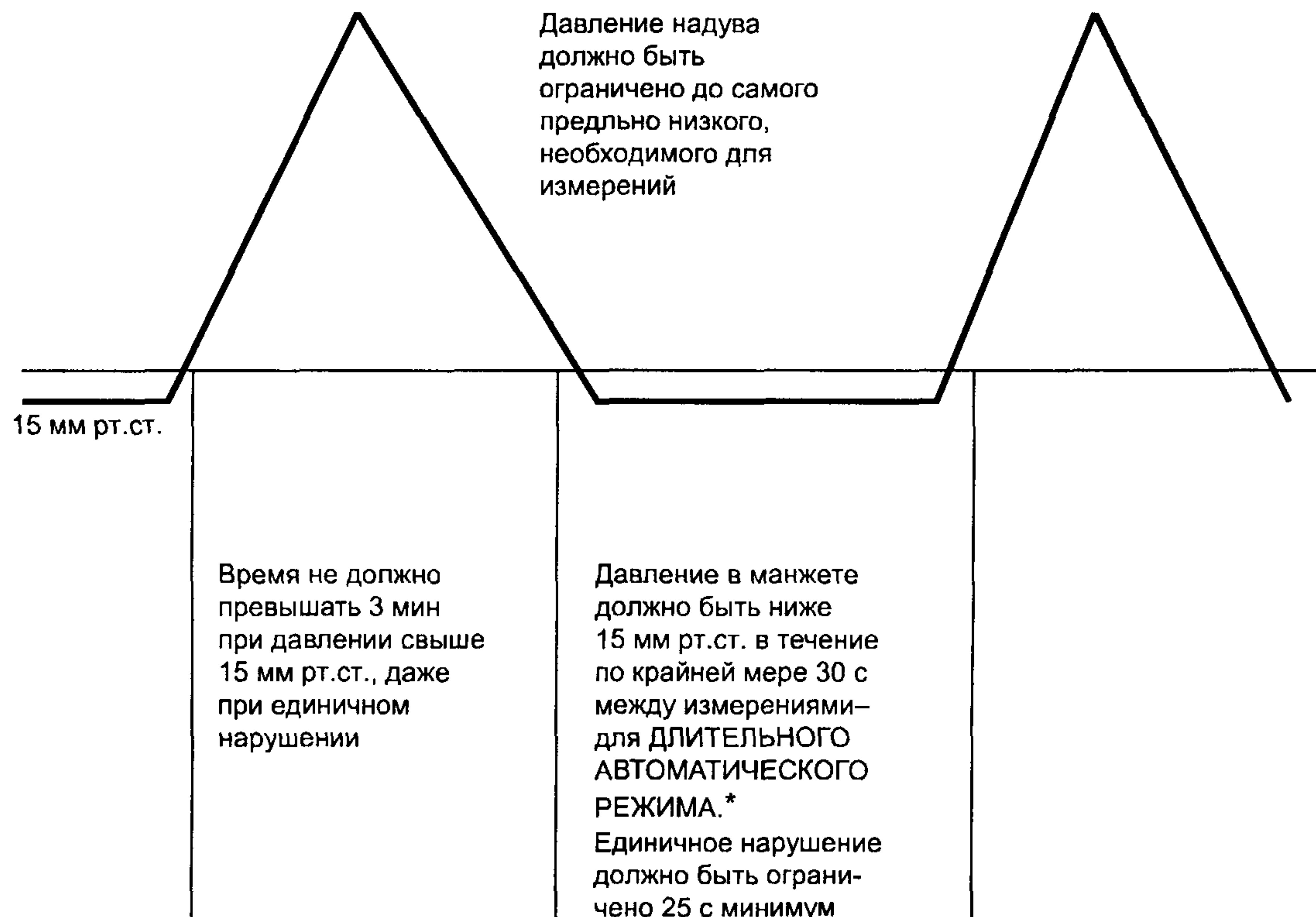
\* Может быть обеспечен КРАТКОВРЕМЕННЫЙ АВТОМАТИЧЕСКИЙ РЕЖИМ. Он должен быть ограничен 15 минутами или менее, при этом давление в манжете снижается до 15 мм рт. ст. (или ниже) по крайней мере один раз в каждые 3 мин; минимальное время снижения не оговаривается.
