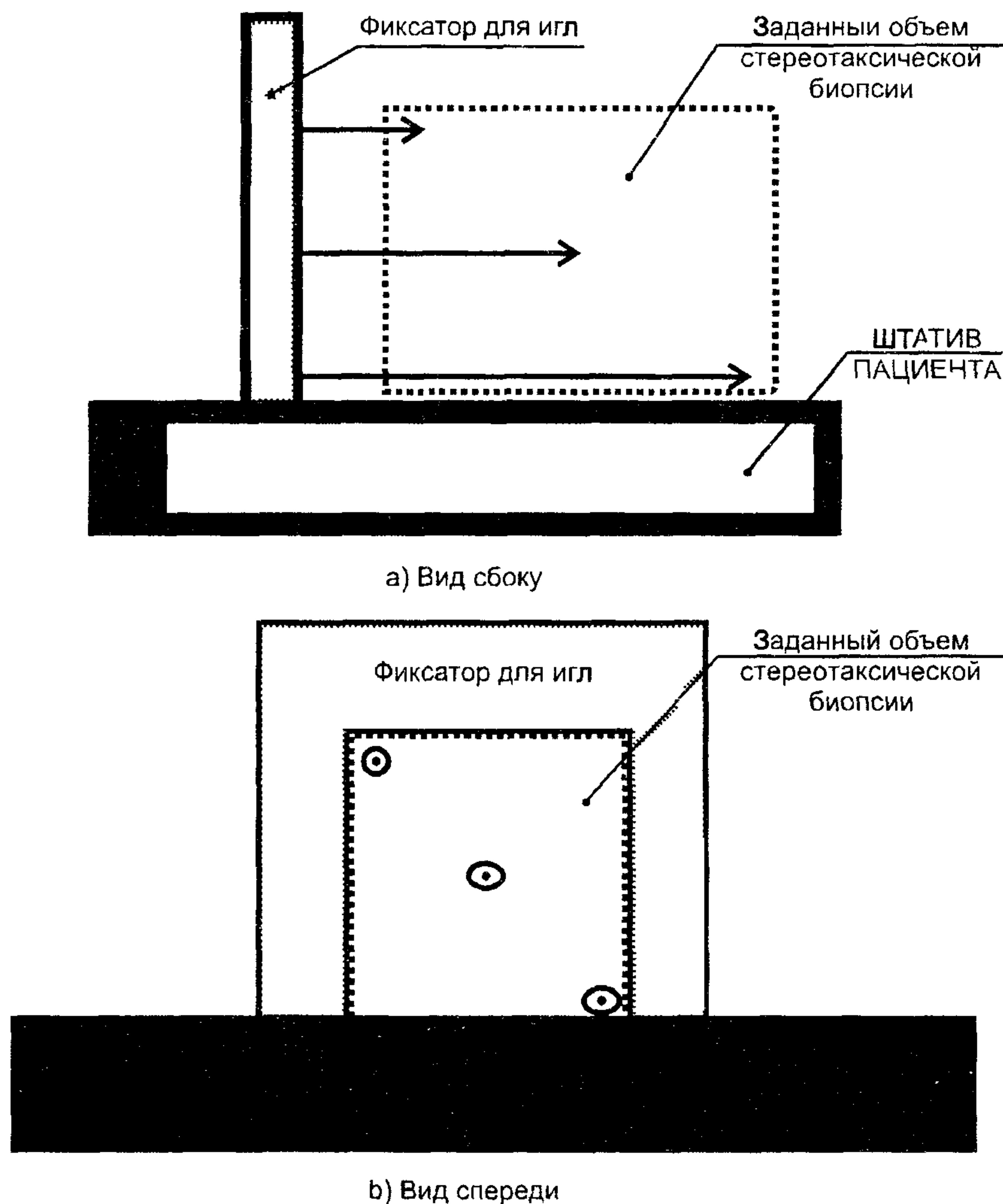
Рисунок 1 — Пример ТЕСТ-ОБЪЕКТА для испытаний МАММОГРАФИЧЕСКИХ УСТРОЙСТВ
