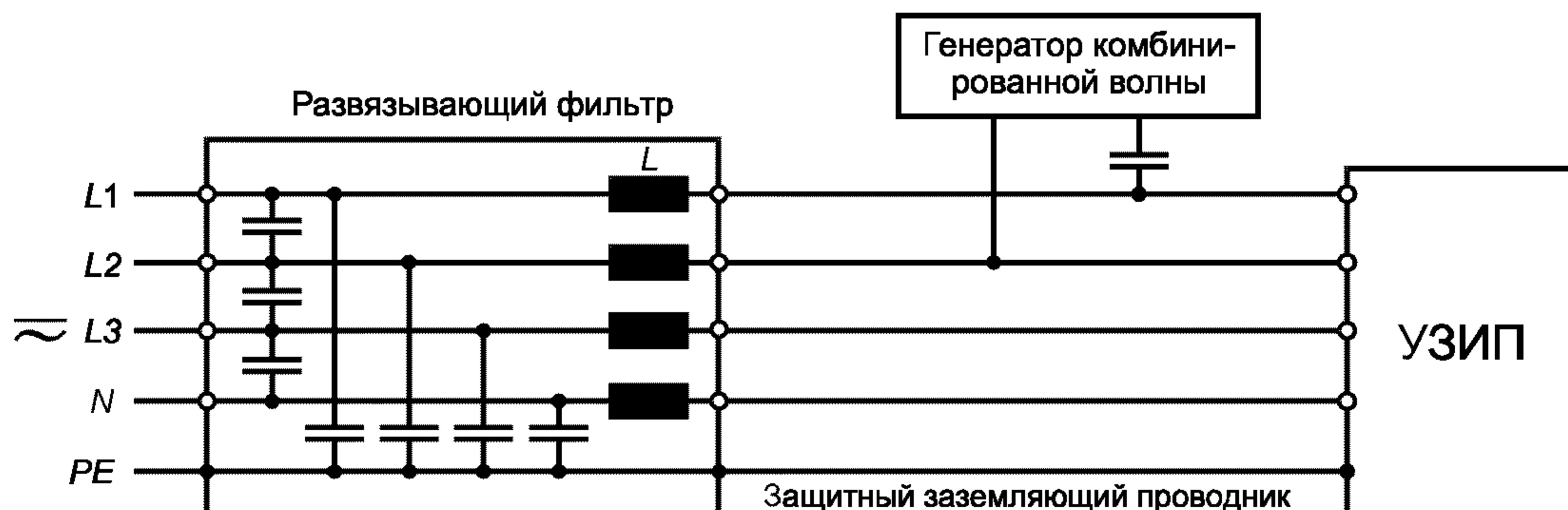
Рисунок 2 — Пример развязывающего фильтра для трехфазной сети
