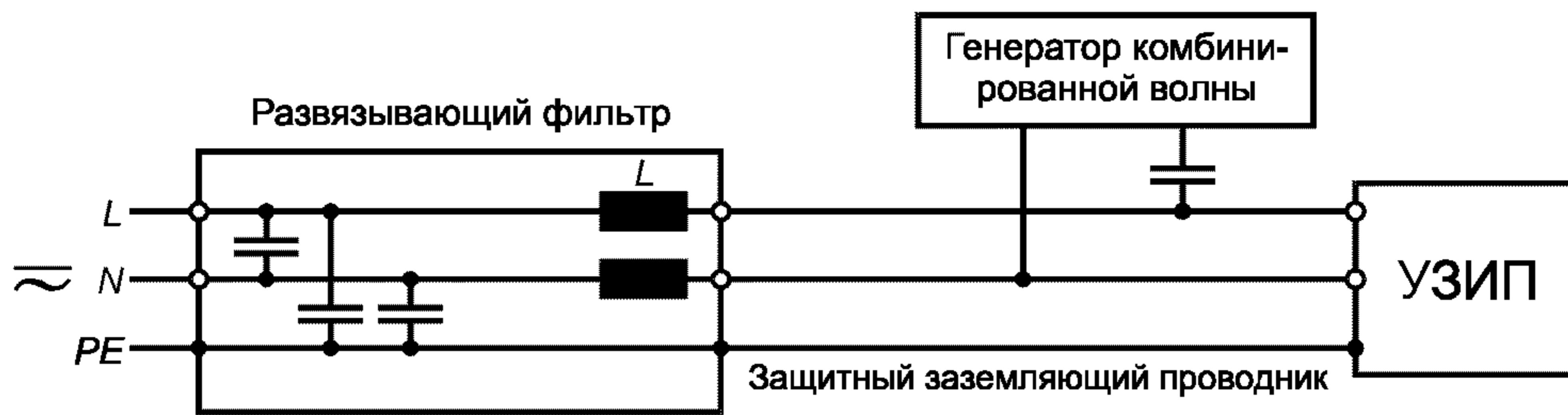
Рисунок 1 — Пример развязывающего фильтра для однофазной сети
