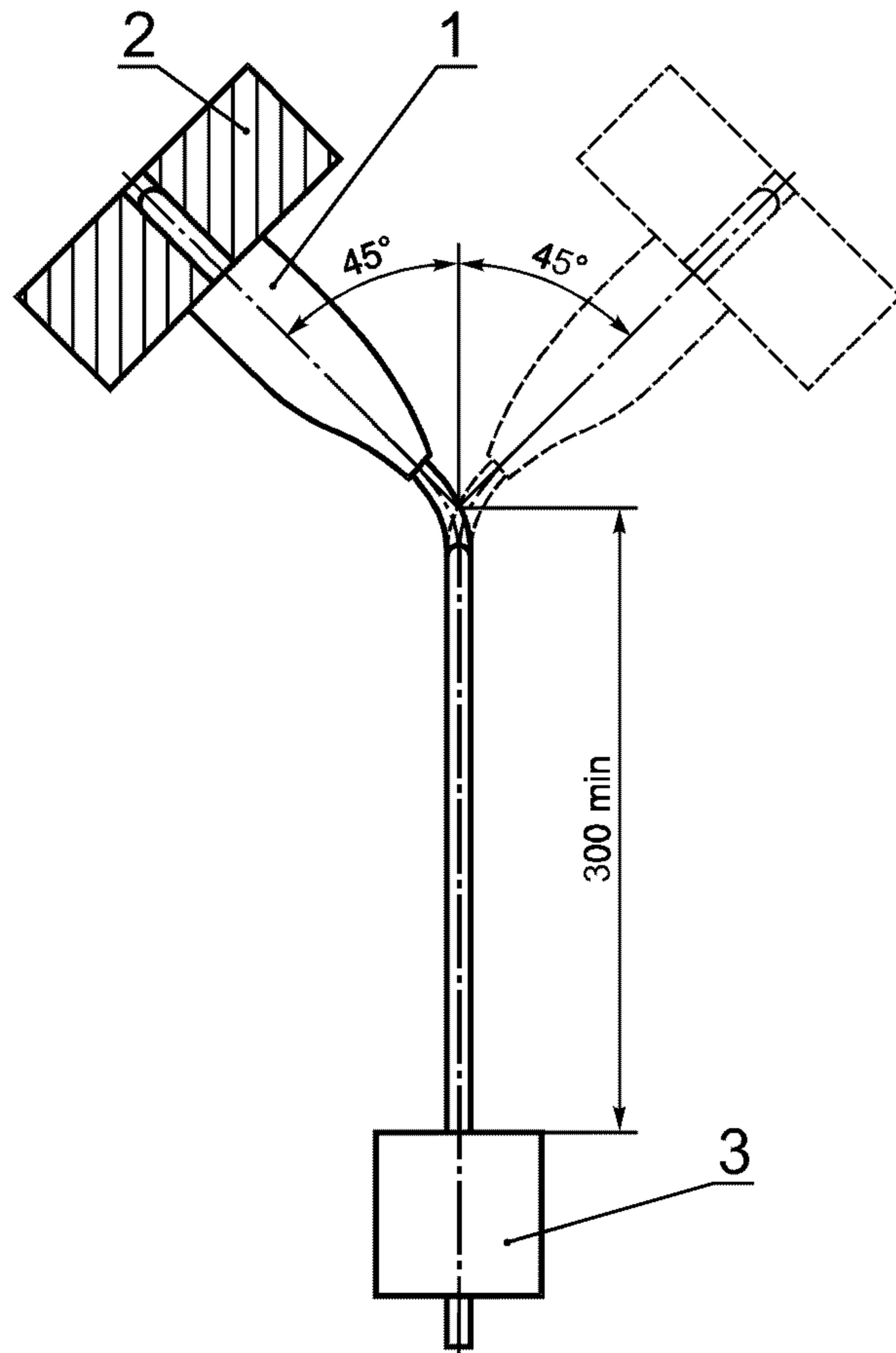
1 — образец; 2 — устройство для крепления образца;
