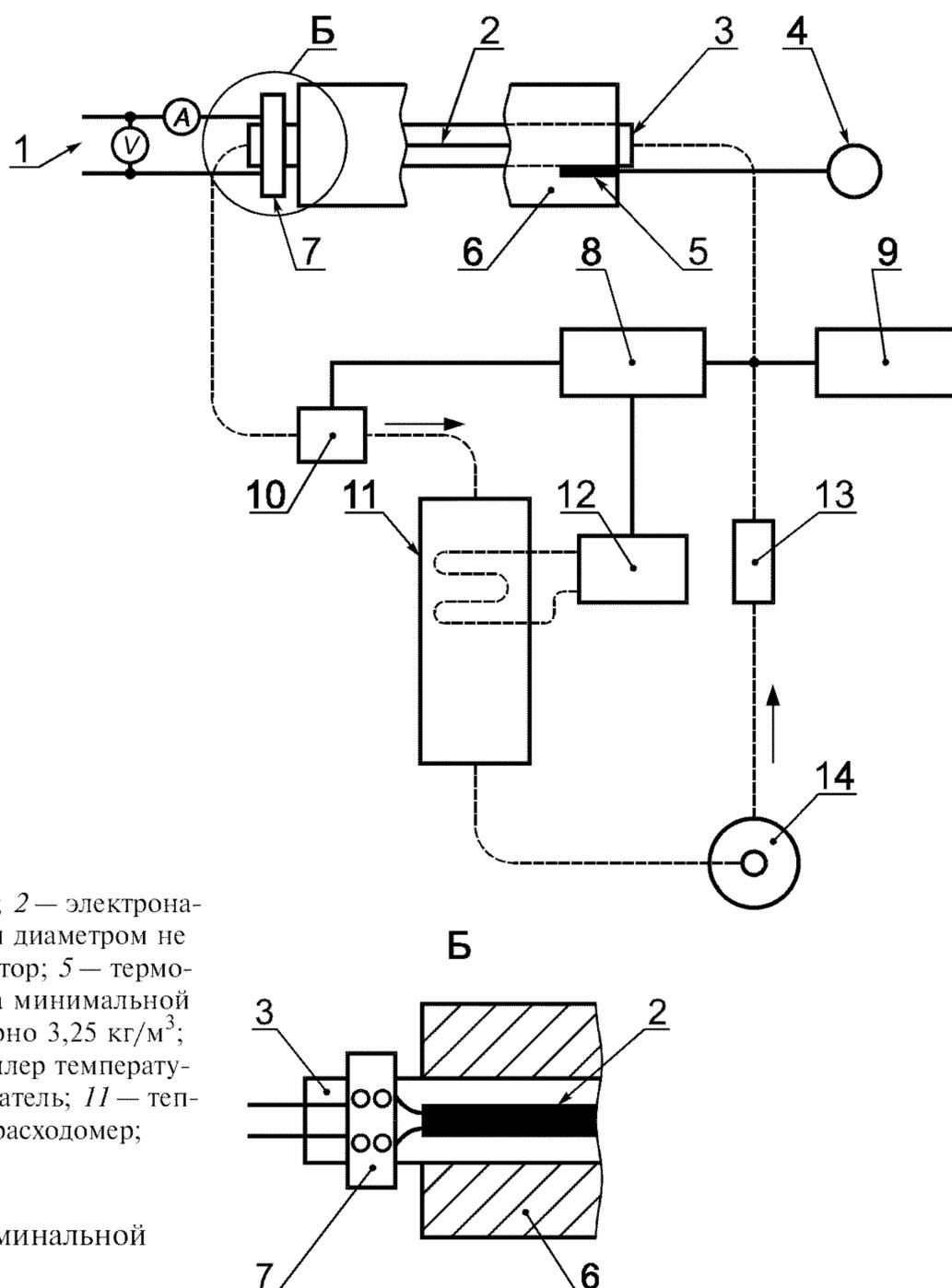
1 — источник регулируемого напряжения; 2 — электронагреватель; 3 — стальная труба внешним диаметром не менее 50 мм; 4 — температурный индикатор; 5 — термопара; 6 — изоляция из стекловолокна минимальной толщиной 25 мм и плотностью примерно 3,25 кг/м<sup>3</sup>; 7 — электрические выводы; 8 — контроллер температуры; 9 — датчик температуры; 10 — нагреватель; 11 — теплообменник; 12 — охладитель; 13 — расходомер; 14 — насос
