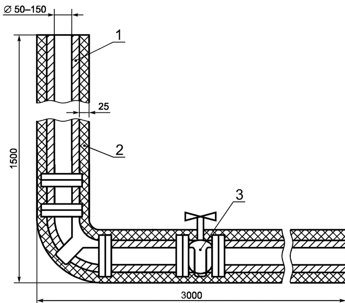
1 — стальная труба; 2 — теплоизоляция из стекловолкна плотностью примерно 3,25 кг/м<sup>3</sup>; 3 — задвижка
