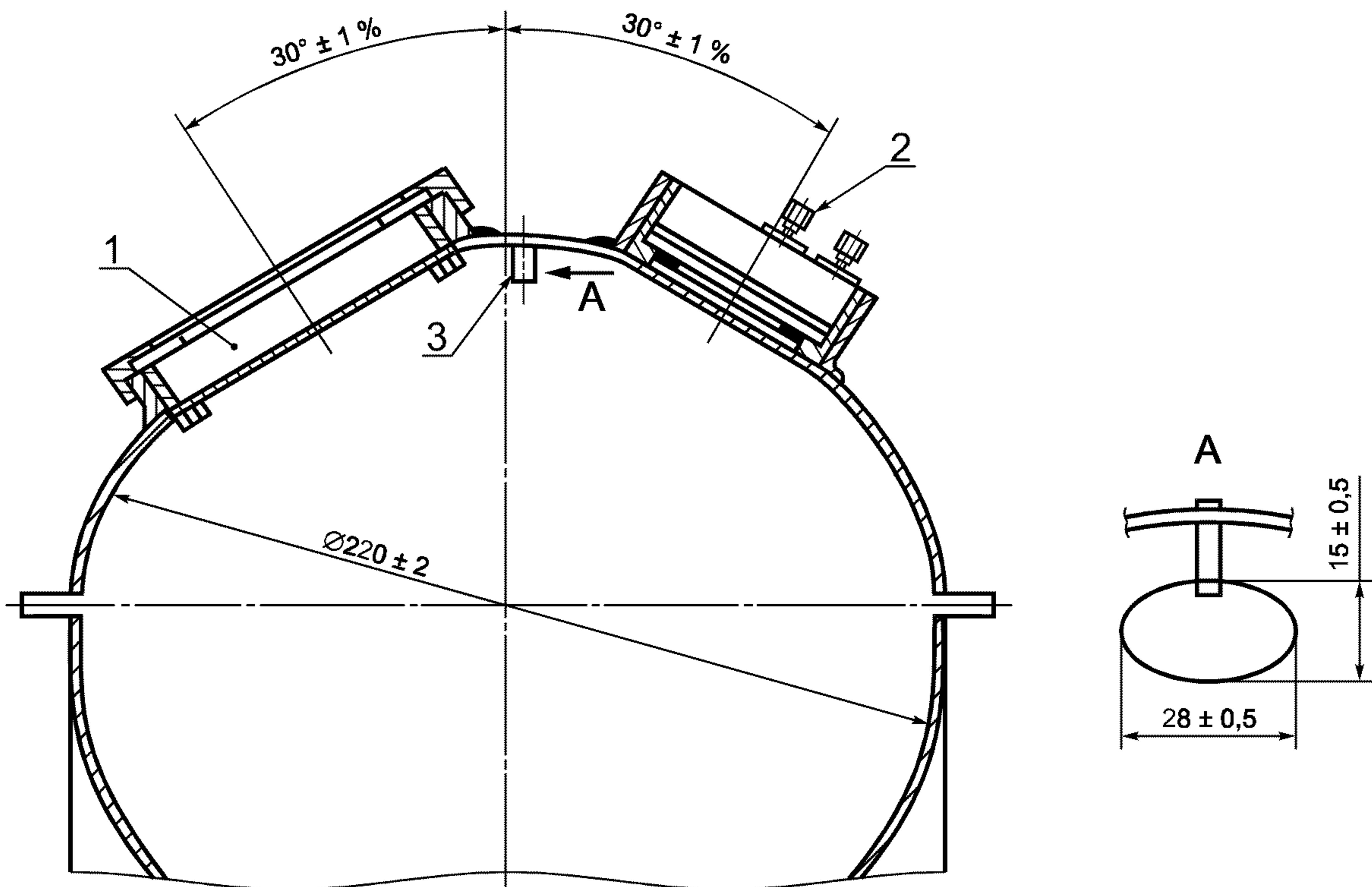
1 — апертура фары; 2 — фотоэлемент; 3 — дефлектор
