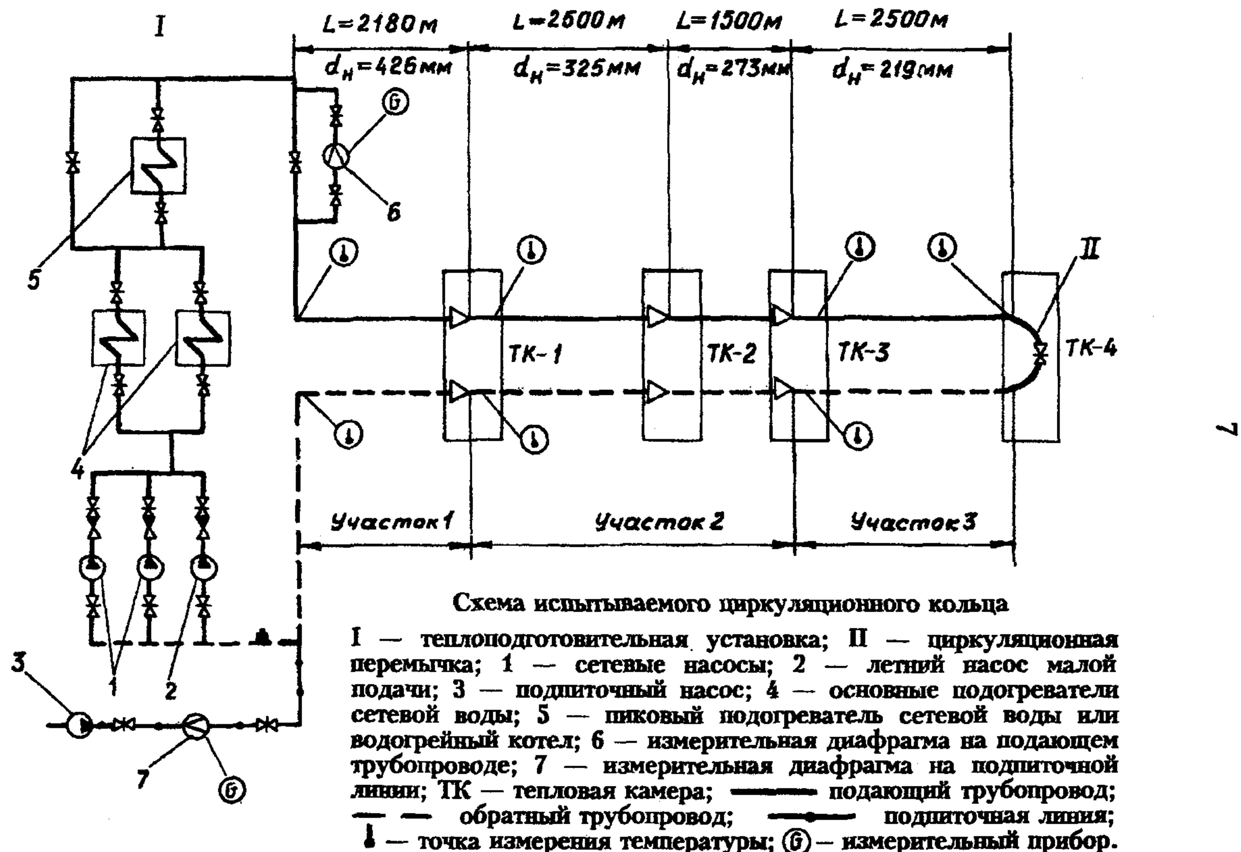
Понижение температуры воды при этом по мере ее прохождения по циркуляционному кольцу обусловлено тепловыми потерями трубопроводов и арматуры в окружающую среду, которые могут быть определены исходя из измеренных во время испытаний расхода воды и снижения температуры.
