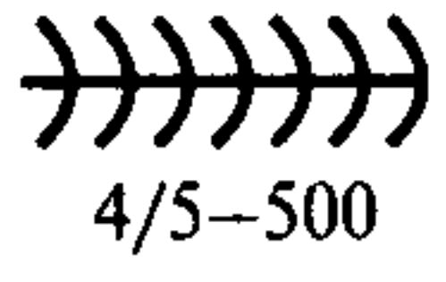
4/5—500 | Обнаженная, прогнутая арматура                 | Выход арматуры на поверхность при деформации (осадке) ствола с изгибом вертикальной арматуры. Количество изогнутых стержней/стрела прогиба — длина изогнутых стержней |
