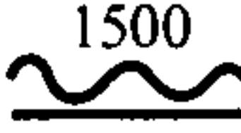
1500    | Разрушающийся шов                              | Шов бетонирования с признаками разрушения: расслоением бетона, образованием каверн и т.д.                                                                             |
