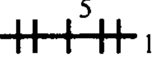
5 1     | Обнаженная, непрогнутая арматура               | Выход арматуры на поверхность. Цифрами показано количество стержней: сверху — вертикальных, сбоку — горизонтальных                                                    |
