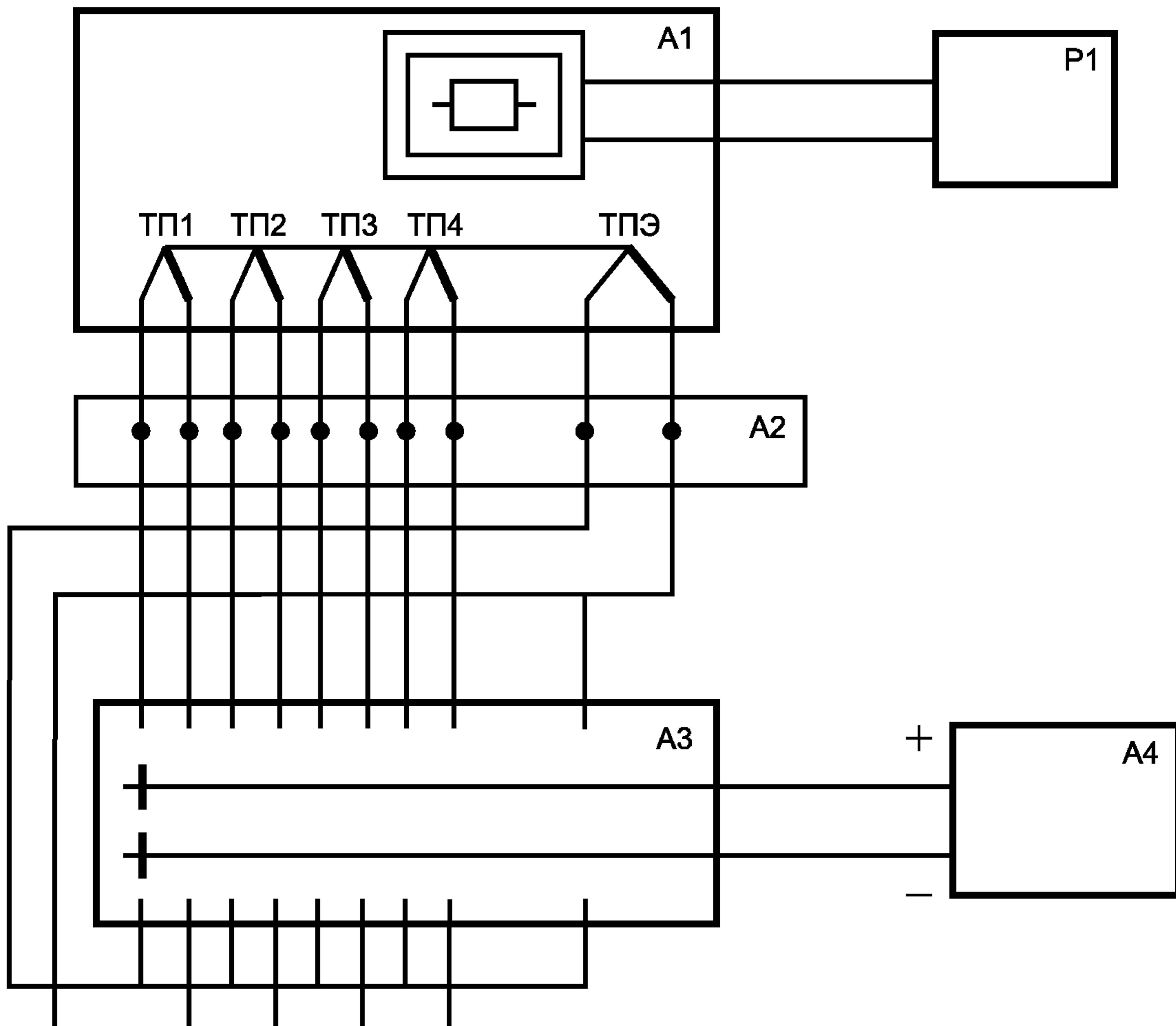
A1 — печь; A2 — термостат для свободных концов ЧЭ ТП; A3 — бестермоточный переключатель; A4 — измерительный потенциометр постоянного тока; Р1 — регулятор напряжения; ТП1, ..., ТП4 — поверяемые термопреобразователи; ТПЭ — эталонный термопреобразователь
