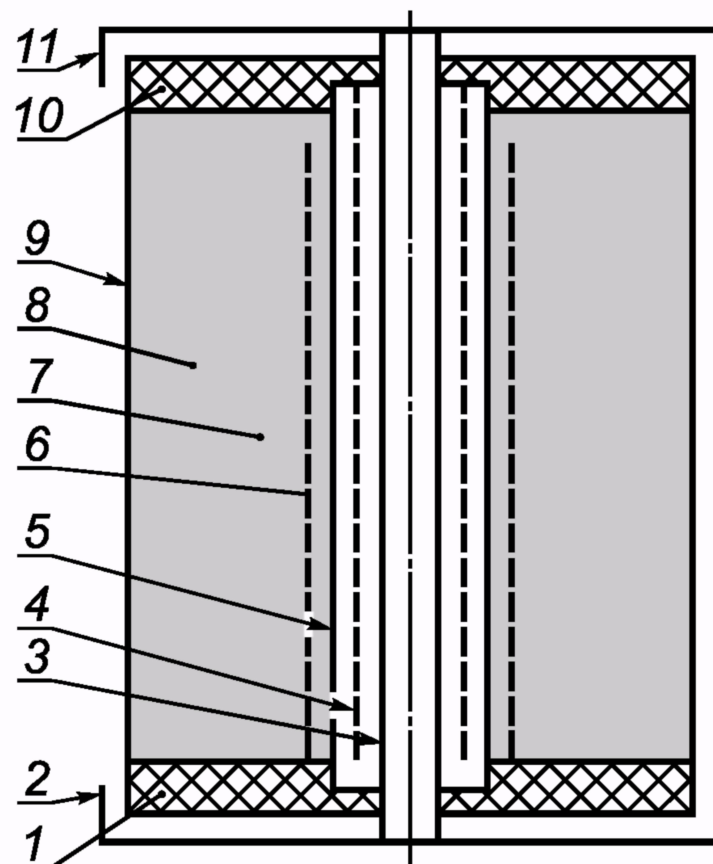
Рисунок А.1 — Схематический разрез вертикальной печи сопротивления
