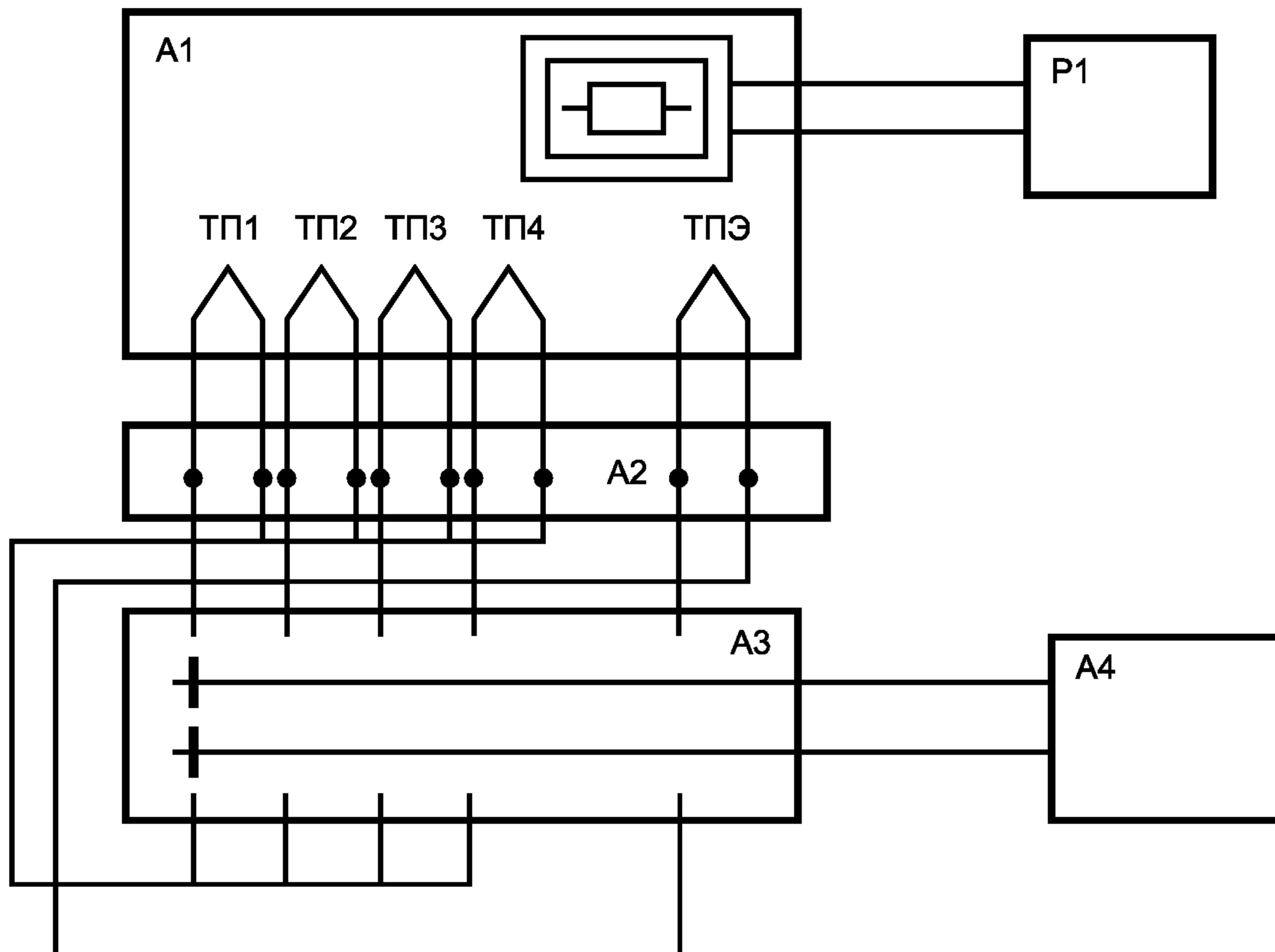
A1 — печь; A2 — термостат для свободных концов ТП (ЧЭ); A3 — бестермоточный переключатель; A4 — измерительный потенциометр постоянного тока; Р1 — регулятор напряжения; ТП1, ..., ТП4 — поверяемые термопреобразователи; ТПЭ — эталонный термопреобразователь
