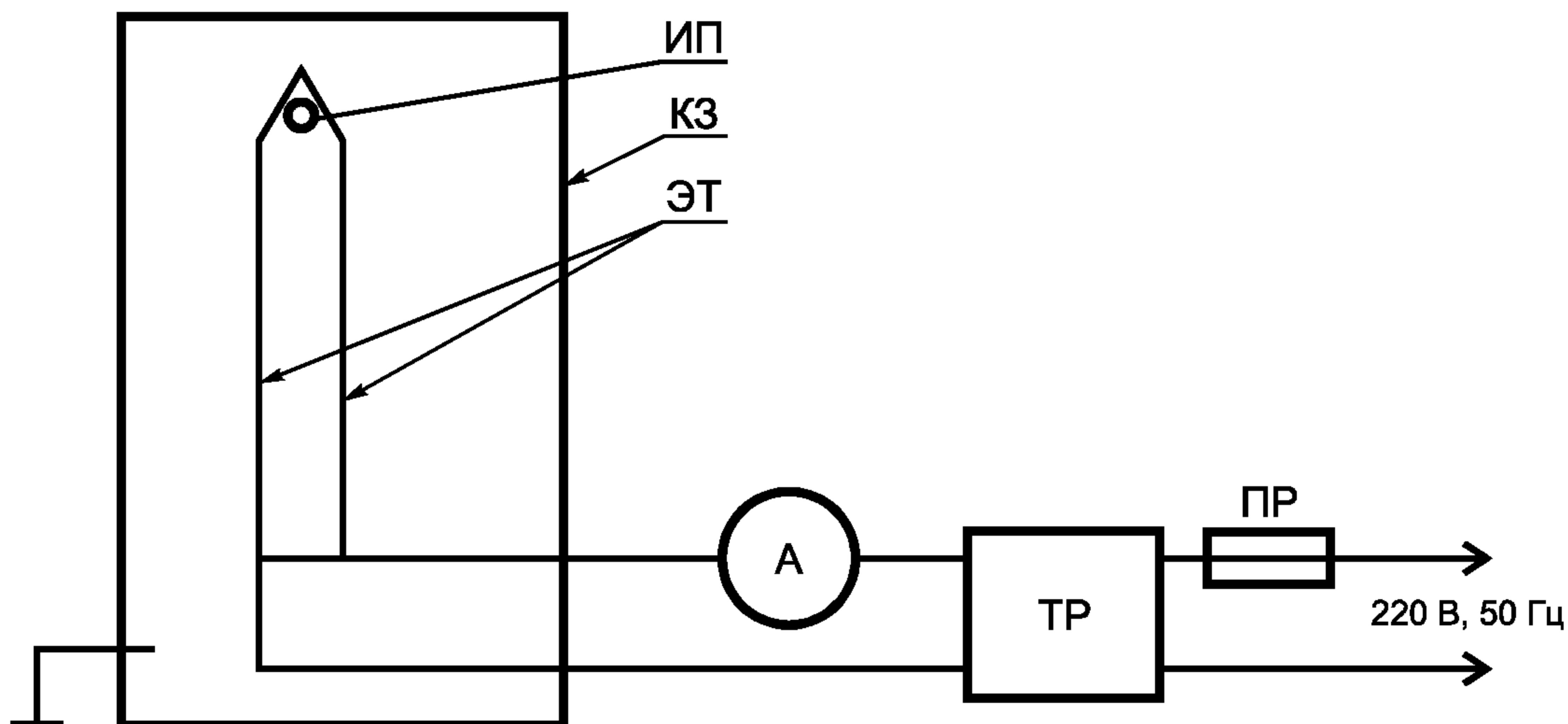
А — амперметр; ИП — изоляционные подвески; КЗ — защитный кожух; ПР — предохранитель;
