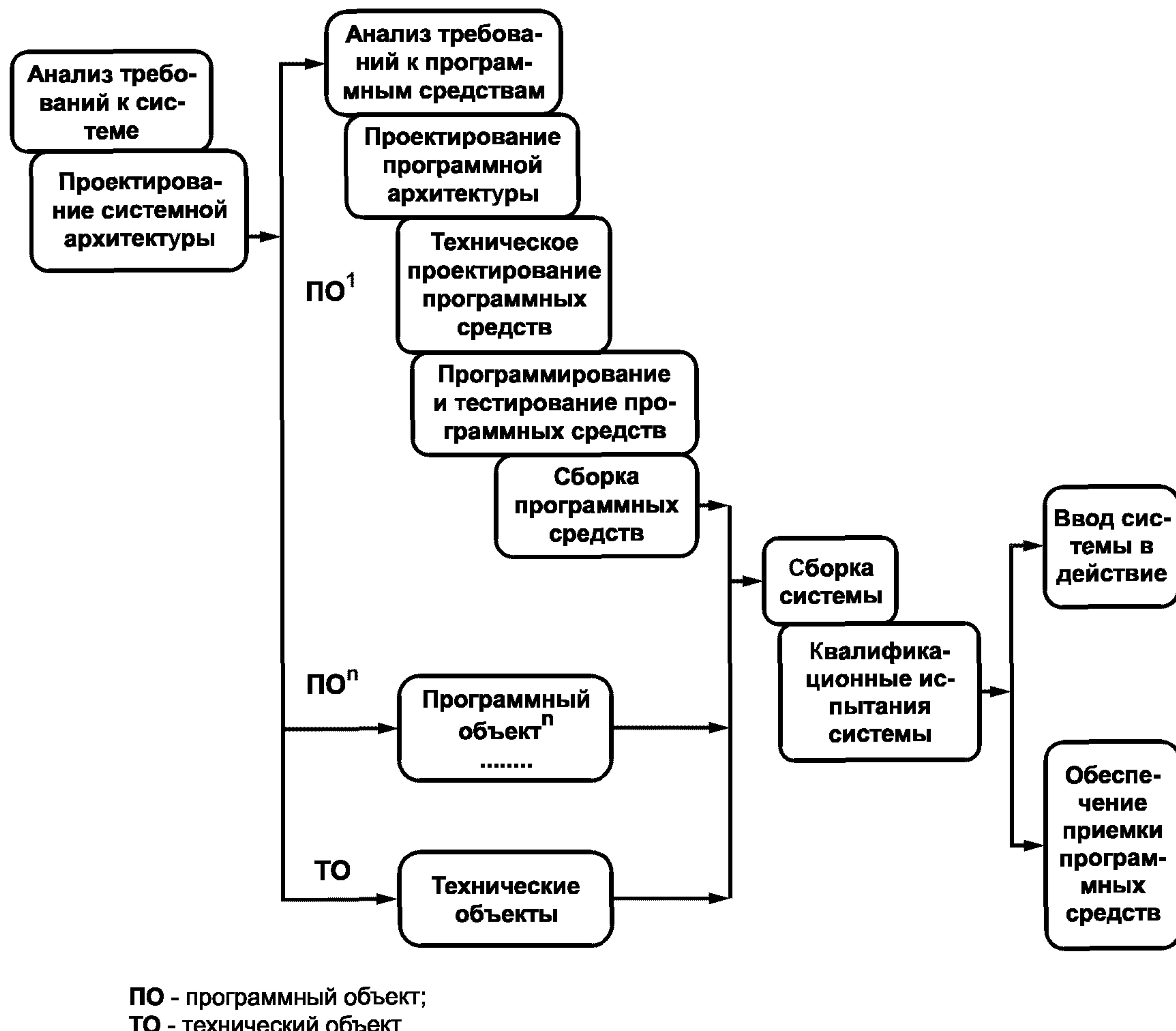
Рисунок С.1 — Пример каскадной модели
