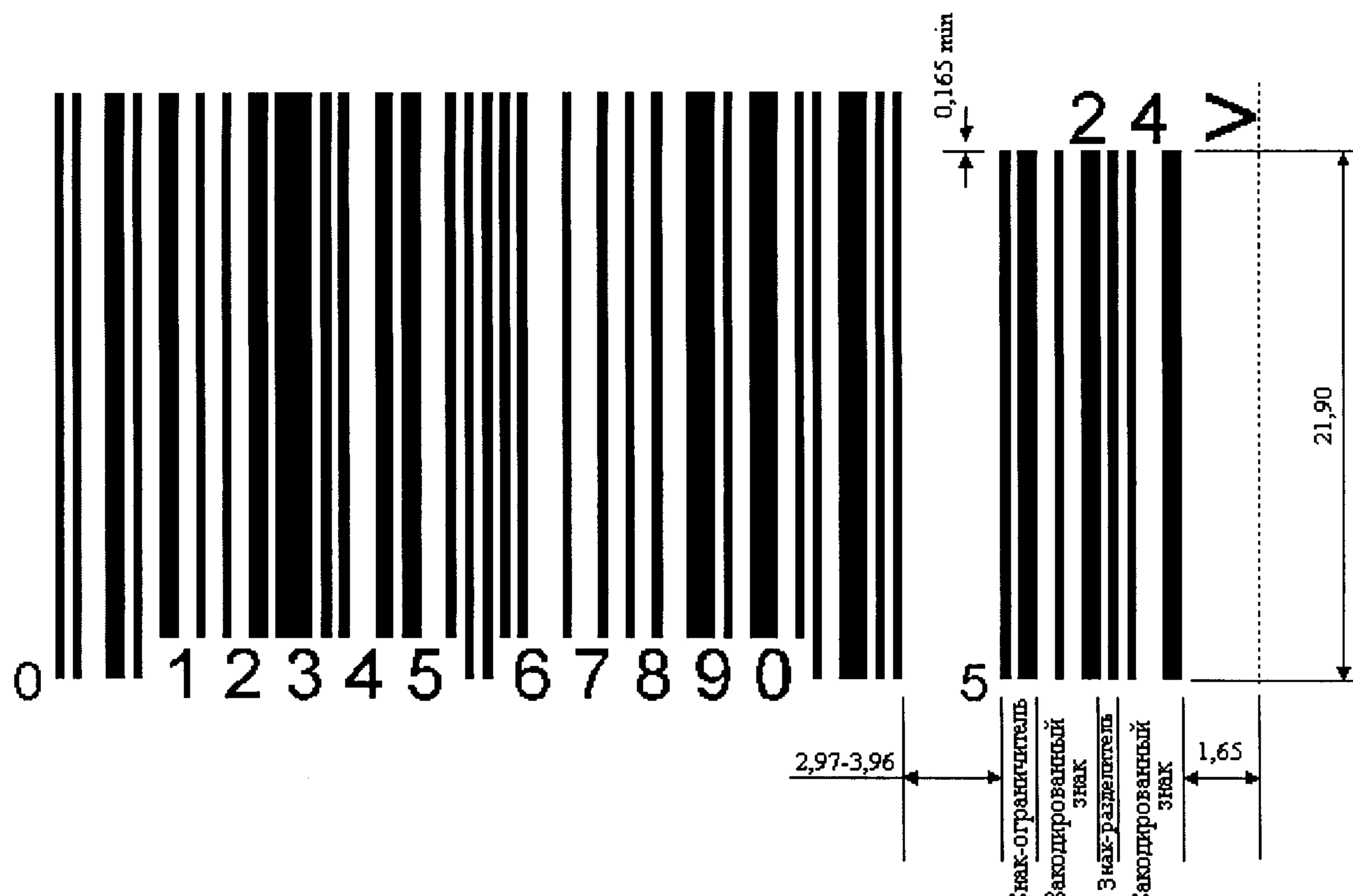
Рисунок Е.6 — Символ UPC-A с 2-разрядным дополнительным символом
