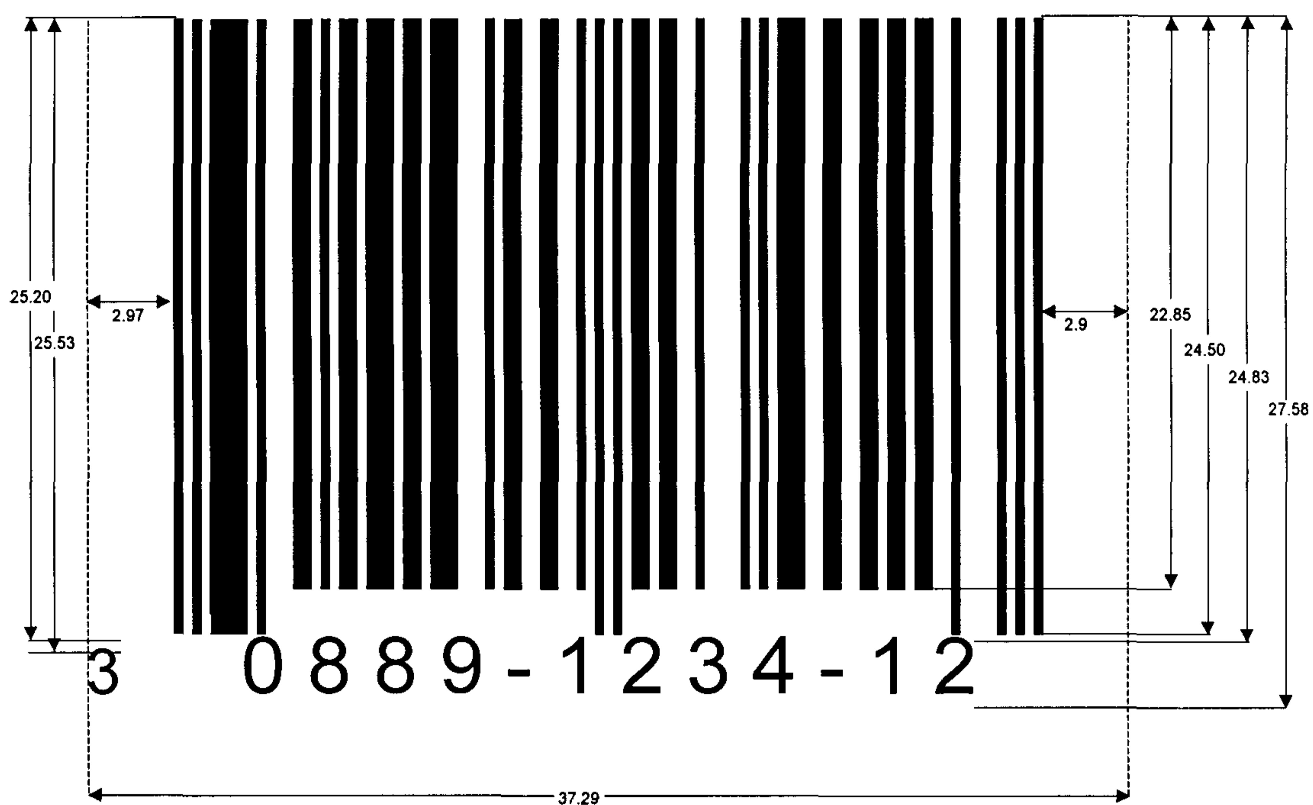
Рисунок Е.3 — Пример вариации символа UPC-A
