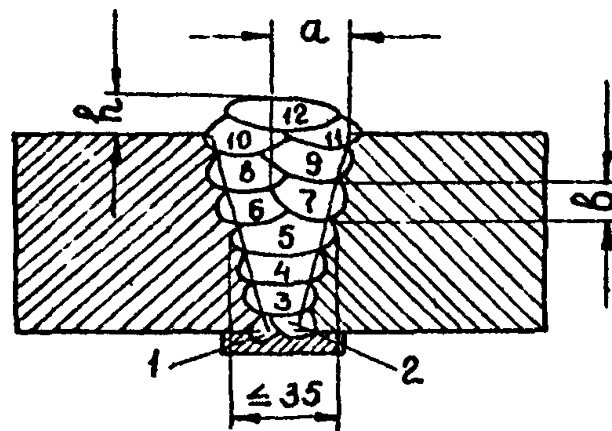
Рис. I. Схема определения размеров валика (слоя):
