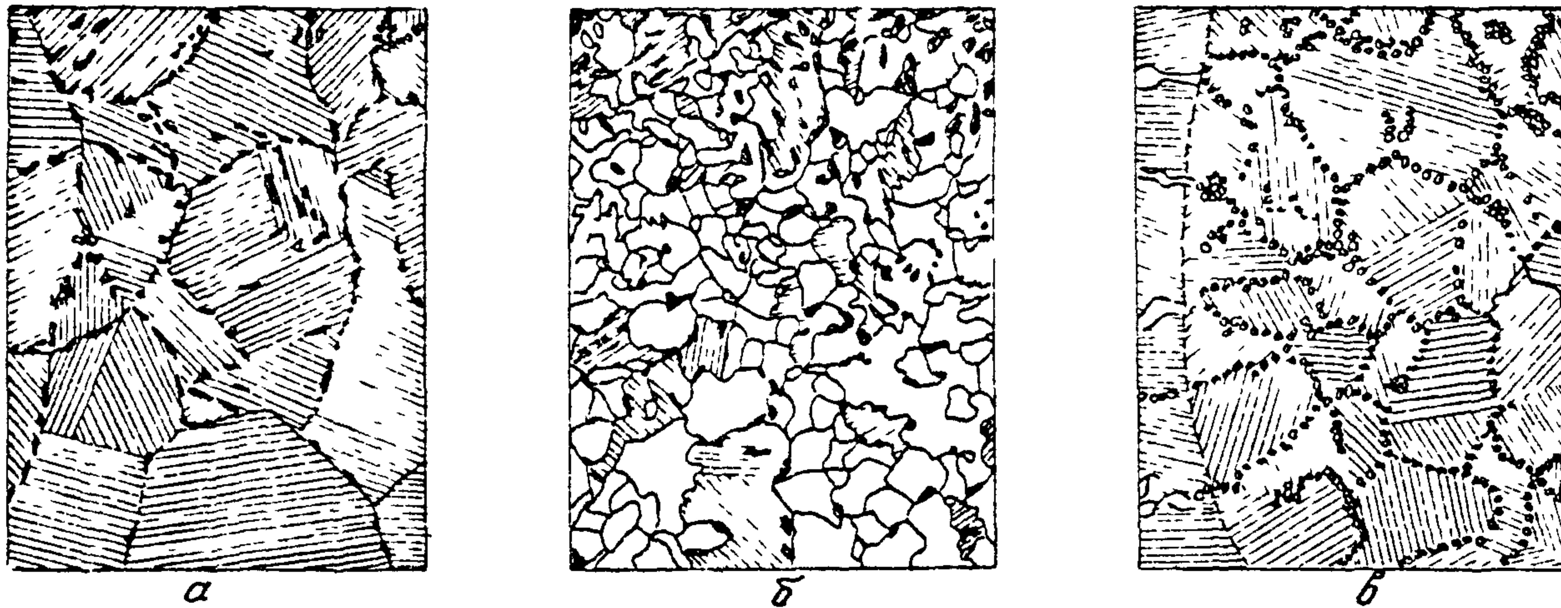
Рис.3. Структуры в зоне термического влияния (ЗТВ)
