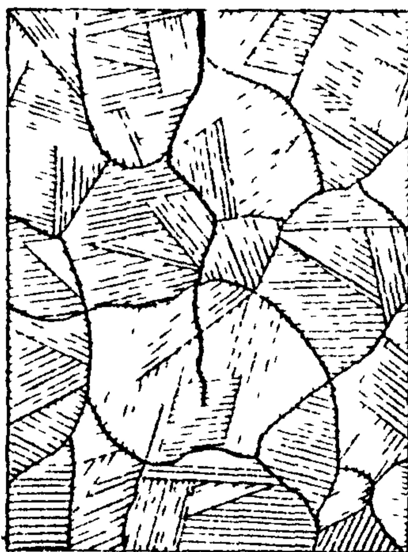
Рис. 5. Холодные трещины на участке перегрева ЗТВ. Х100
