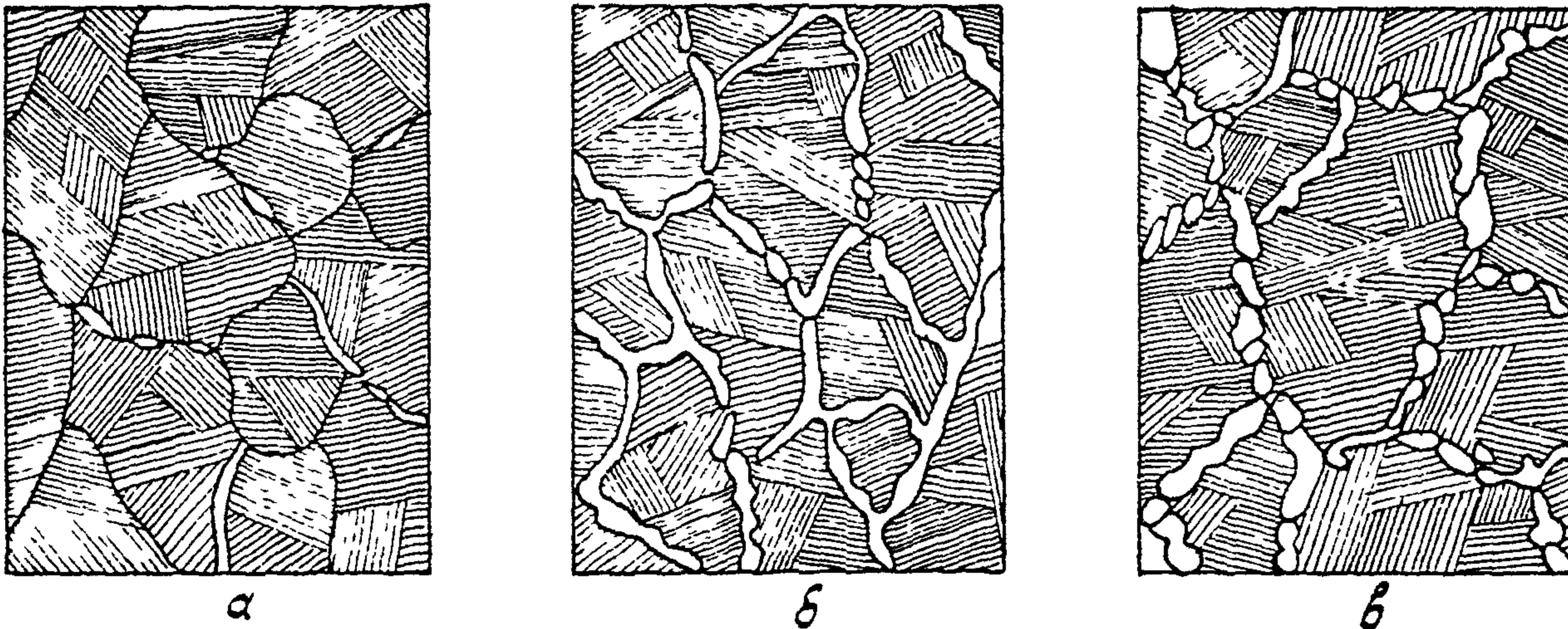
Рис.2. Шкала для определения балла структуры металла шва. Х100:
