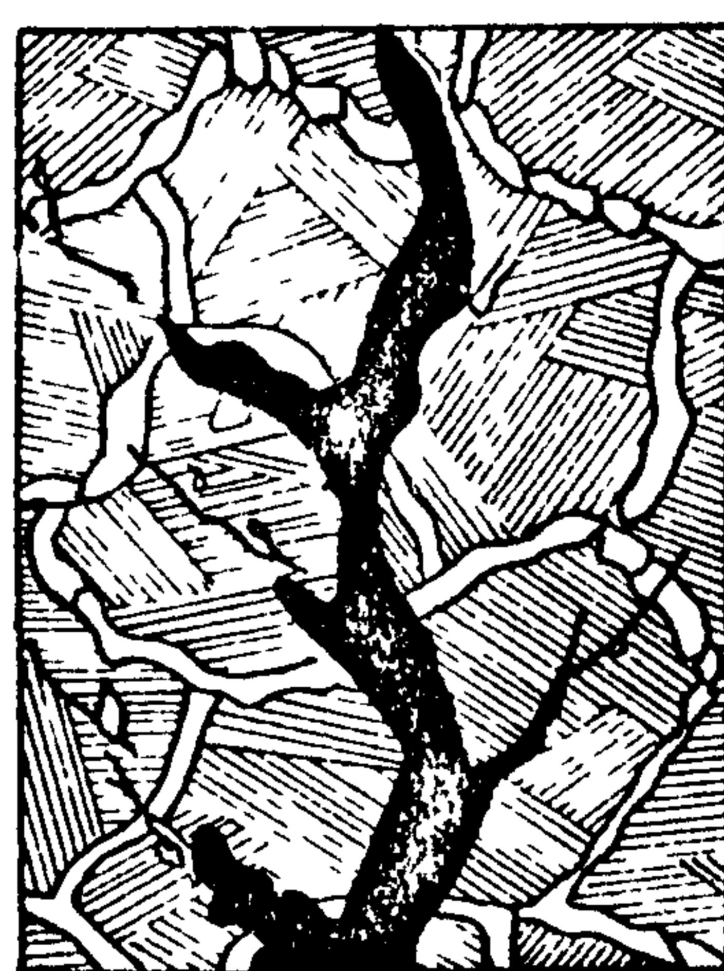
Рис. 8. Трещины, обусловленные действием ударных нагрузок. X100
