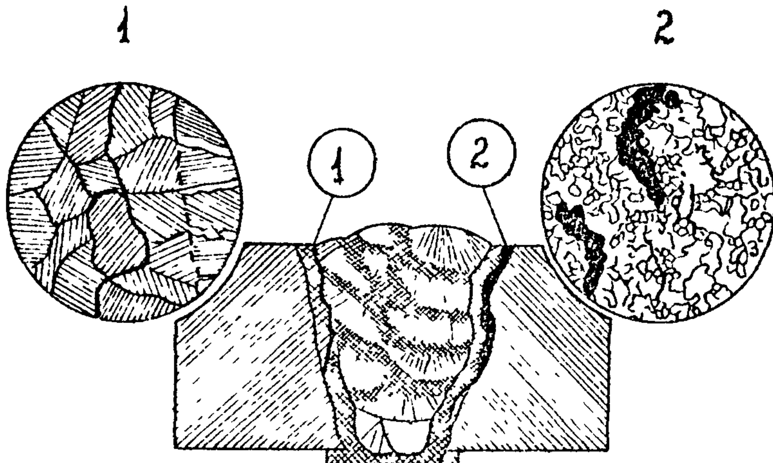
**Рис.6.** Трещины, обусловленные некачественным отпуском после сварки (1) и длительной статической перегрузкой (2). Штриховкой – граница сплавления; двойной штриховкой обозначены зоны термического влияния в основном металле и в многослойном шве
