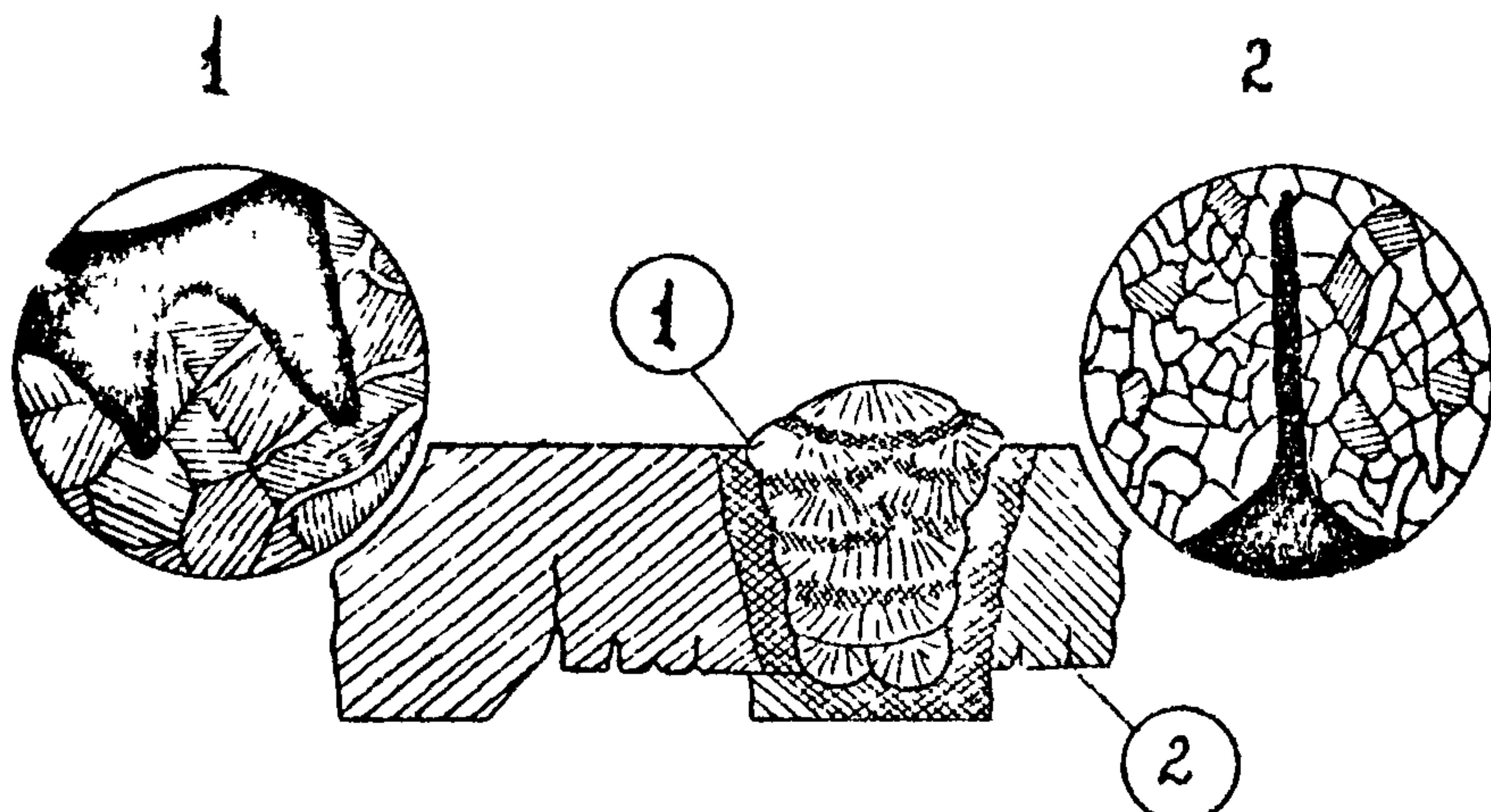
**Рис.7.** Усталостные трещины. Х100:
