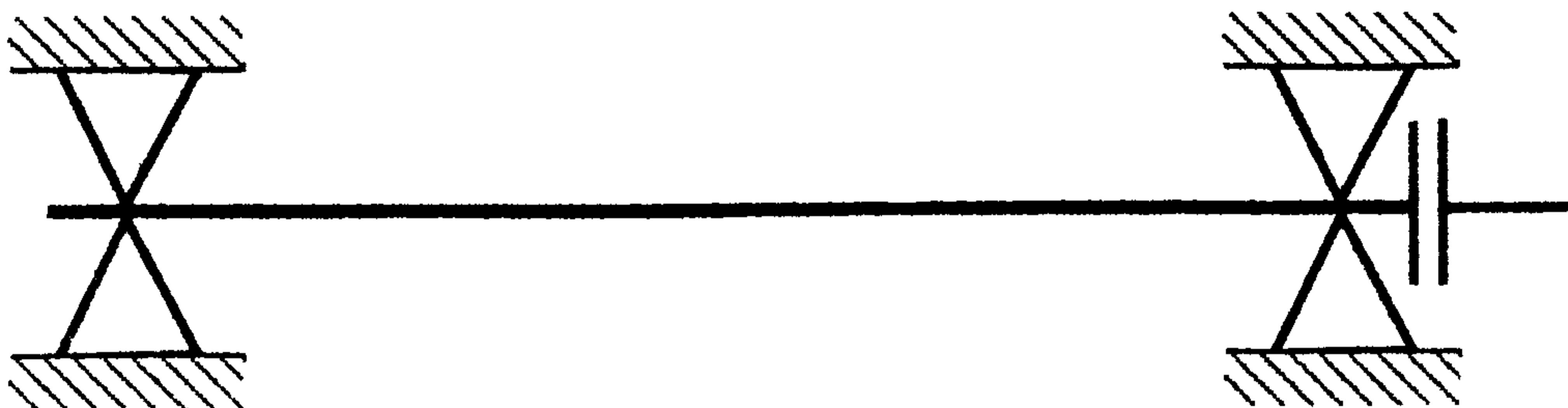
Рис. 10. Схема возникновения задеваний в проточной части из-за коробления цилиндра в вертикальной плоскости ( $\Delta t_{\text{справа-слева}} - \text{выше нормы}$ )
