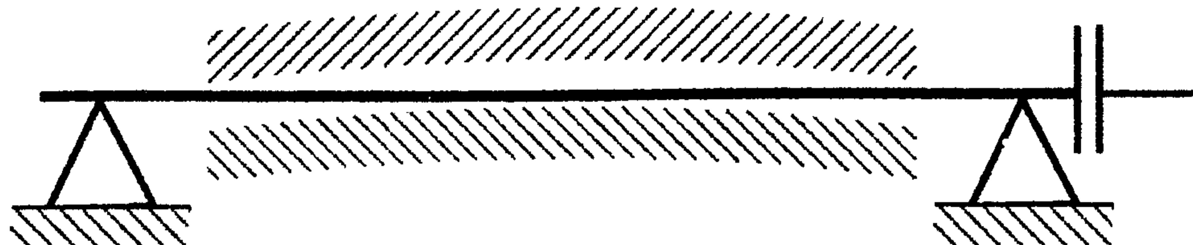
Рис. 9. Схема возникновения задеваний в проточной части из-за коробления цилиндра в горизонтальной плоскости ( $\Delta t_{\text{верх-низ}} - \text{выше нормы}$ )
