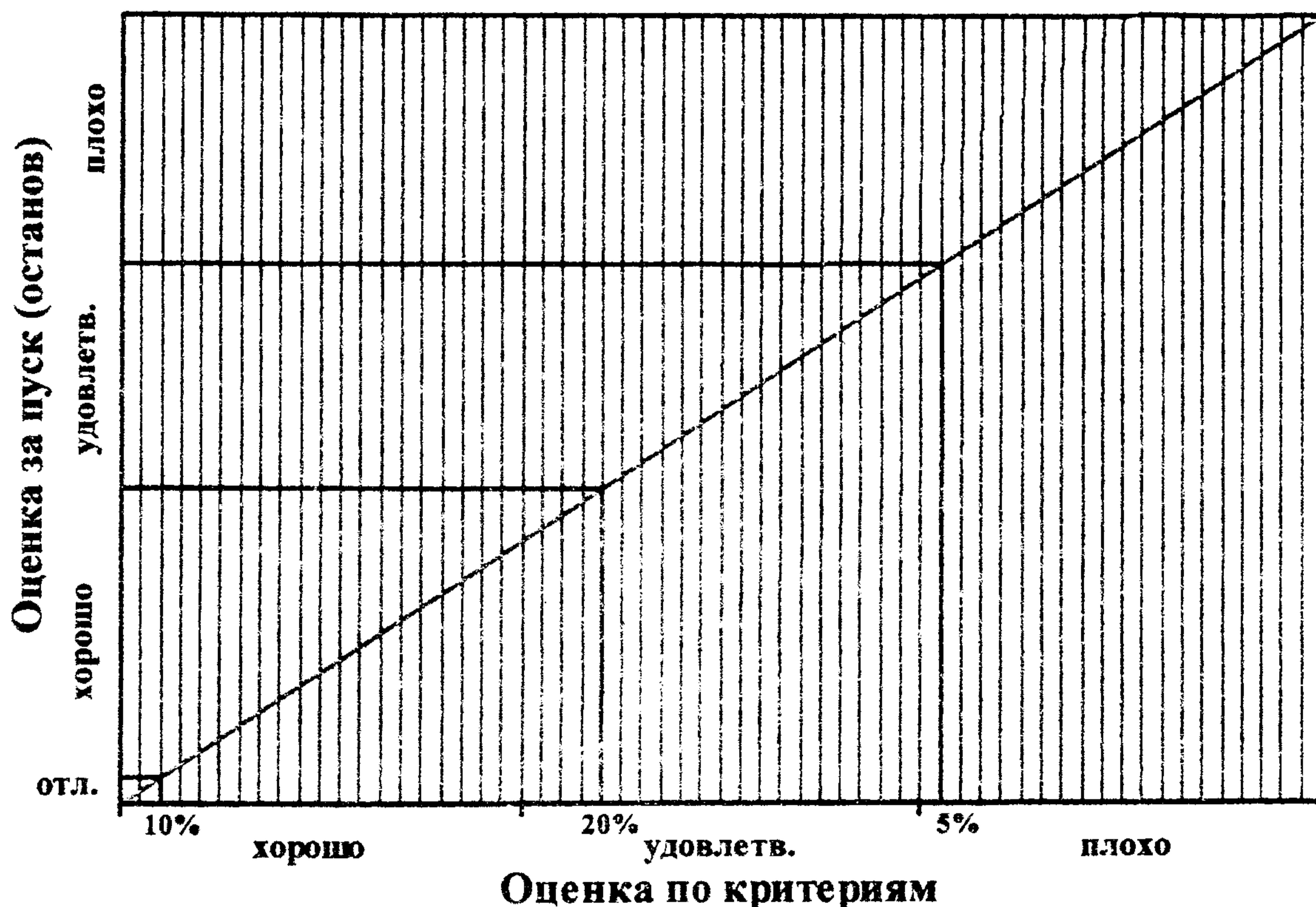
Рис. 3. График определения оценки за качество пуска (останова) в зависимости от оценок по дополнительным критериям
