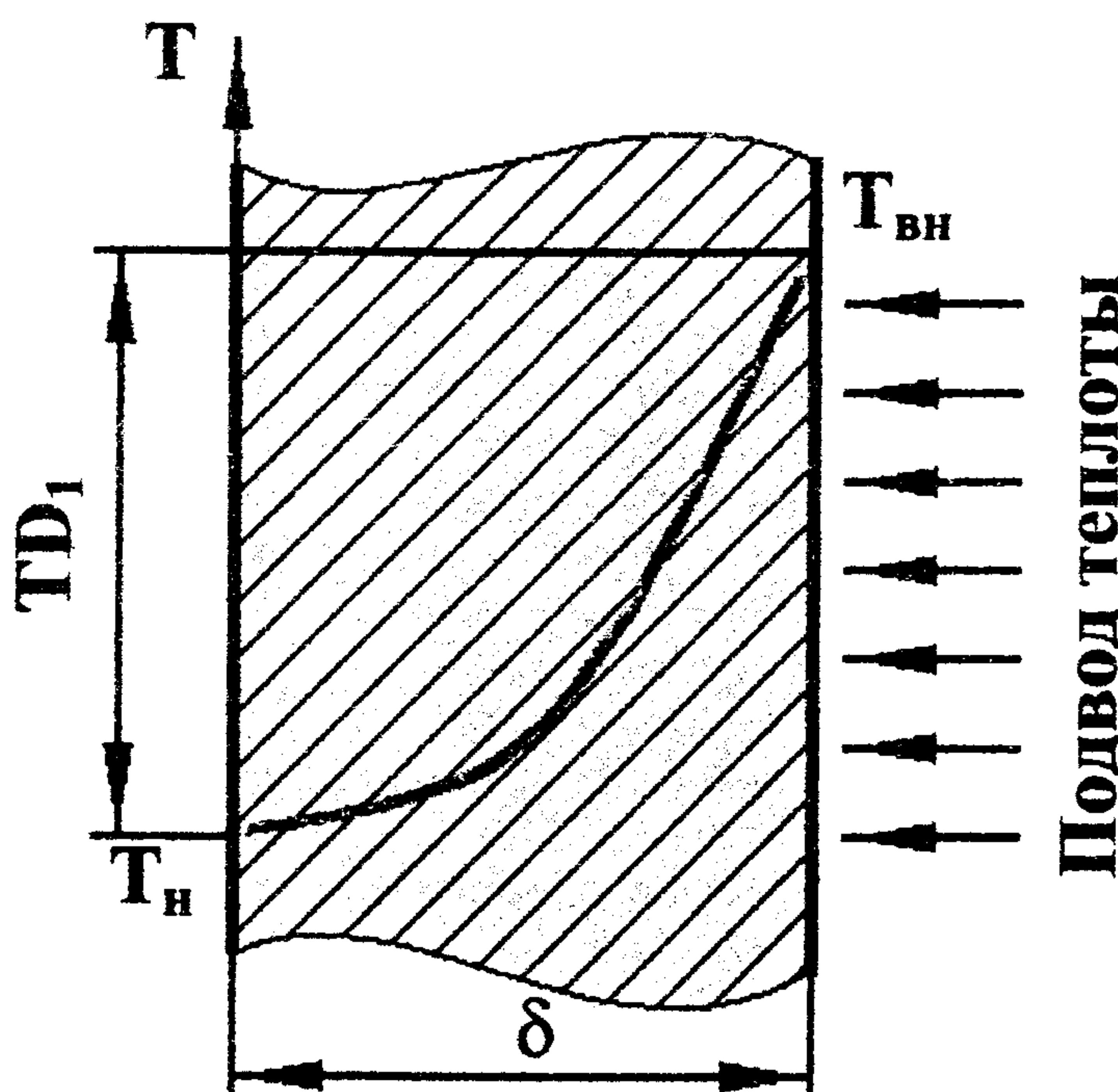
Рис. 4. Изменение температуры в стенке при прогреве барабана
