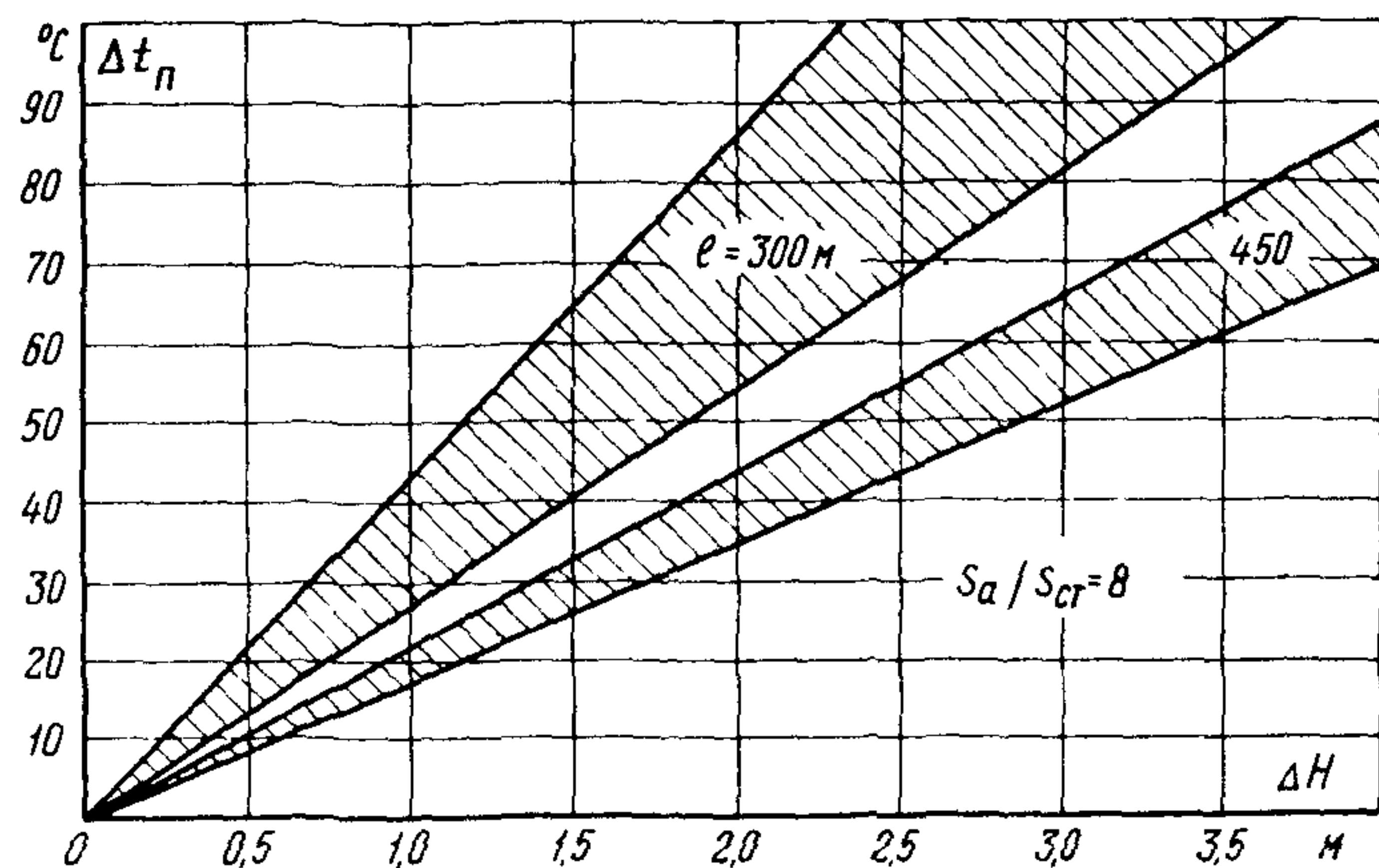
Зависимость увеличения  $\Delta H$  в середине пролета от температуры провода и длины пролета для сталяалюминиевых проводов с соотношением сечения алюминия к стали ( $S_a/S_{ct}$ ), равным 6 и 8:
